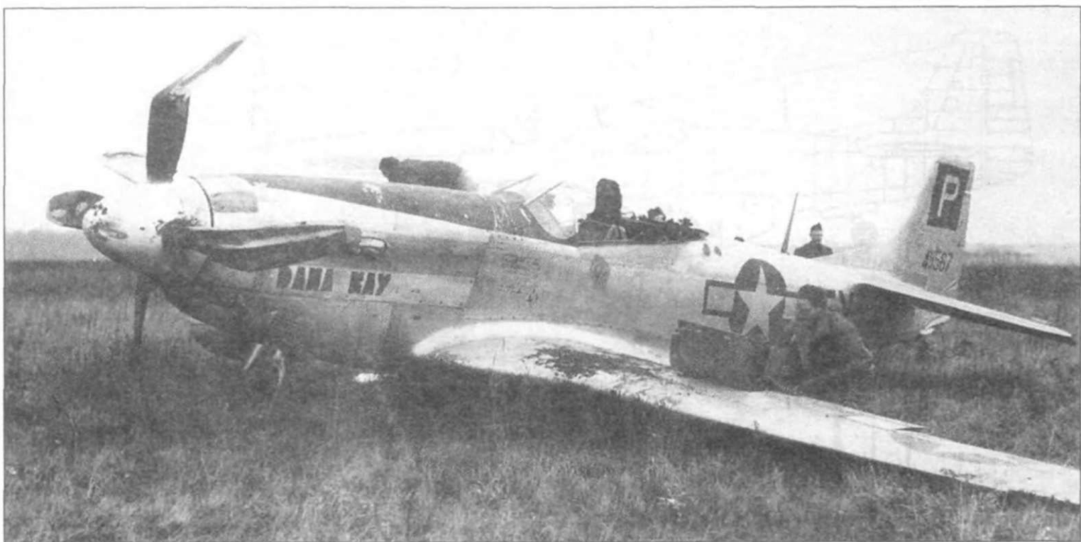
Поврежденный зенитной артиллерией при штурмовке целей в Германии 15 января 1945 года, P-51D DANA KAY, который принадлежал 383-й эскадрилье 364-й группы, тем не менее, благополучно вернулся на свой аэродром Хонингтон в Суффолке. На борту слегка поврежденного самолета остались неиспользованные боеприпасы и оружейникам эскадрильи пришлось извлекать их перед тем, как отправить машину в ремонт.
