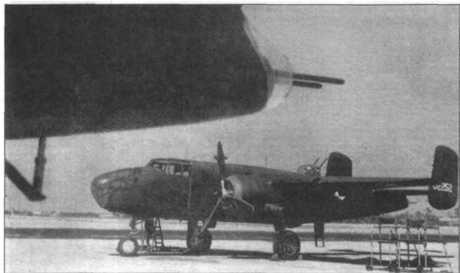
В-25 на базе Эглин-Филд. Идет подготовка к налету. Обратите внимание, с самолета снят носовой пулемет. Торчащее сзади дуло - всего лишь макет пулемета.
