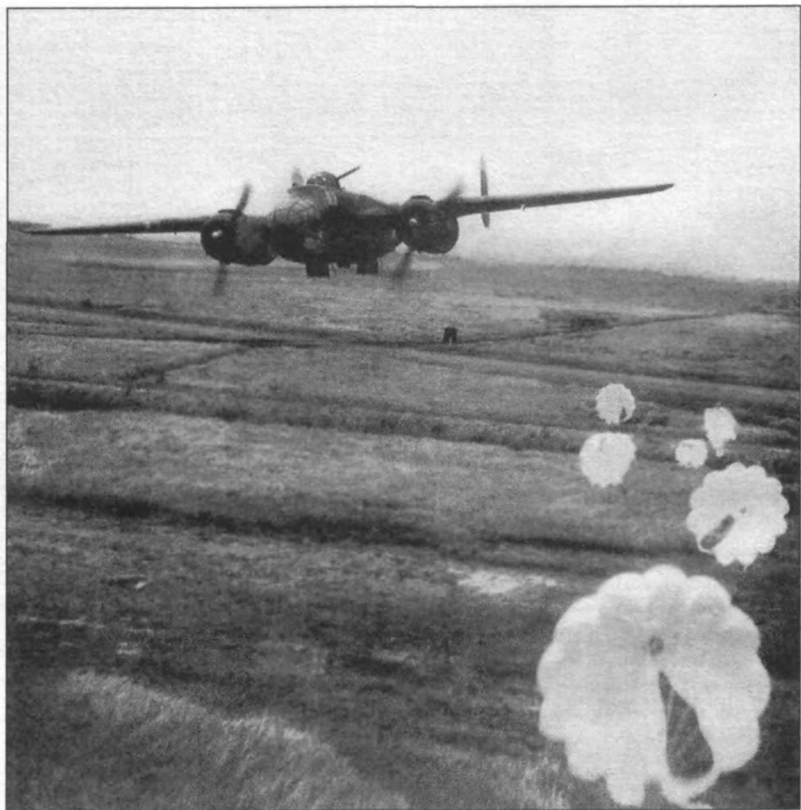
В-25J из 71st BS, 38th BG, 5th AF сбрасывает «парафраги», Филиппины, декабрь 1944 года. Эти маленькие осколочные бомбы на парашютах были страшным средством против стоящих на земле самолетов. В бомбоотсек В-25 мог брать 72 такие бомбы, каждая из которых весила около 10 кг (23 фунта).
