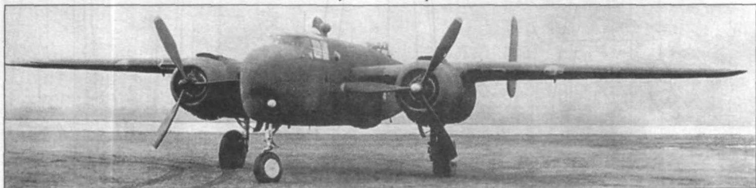
XB-25G (41-13296), переделанный из последнего серийного В-25С-1. Обратите внимание на желтый колпак на стволе 75-мм пушки, выступающий за пределы фюзеляжа самолета. На серийных машинах такой колпак отсутствовал.
