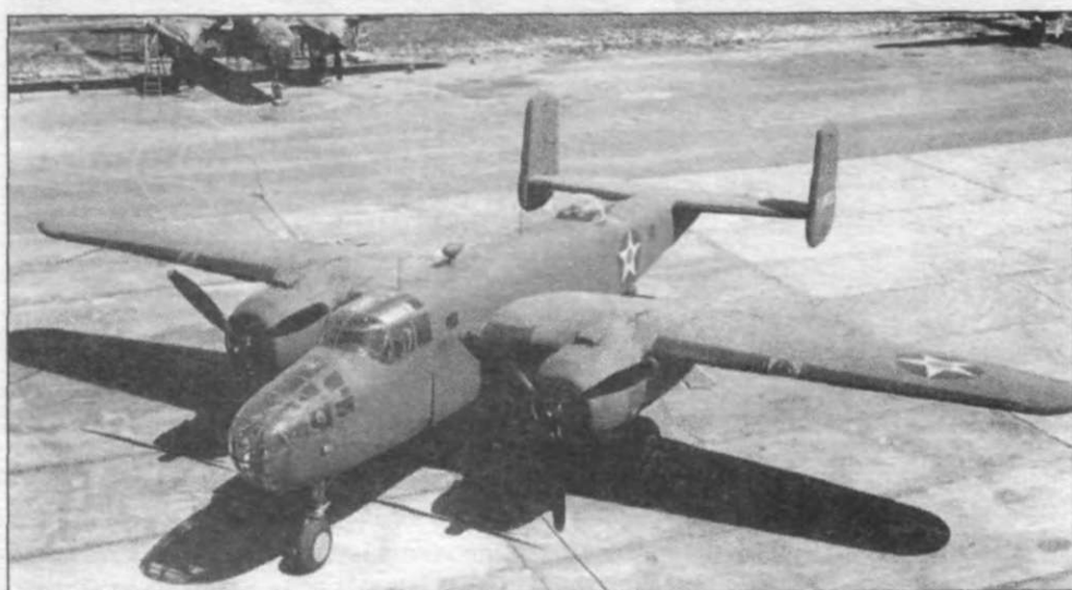
Три снимка В-25С (41-12633), двухсортый самолет модификации. Выхлопные трубы собраны в общий коллектор. Узкий воздухозаборник для карбюратора Holley. Опызнавательные знаки старого образца, на нижней стороне крыльев надпись «US ARMY», 1941 год.
