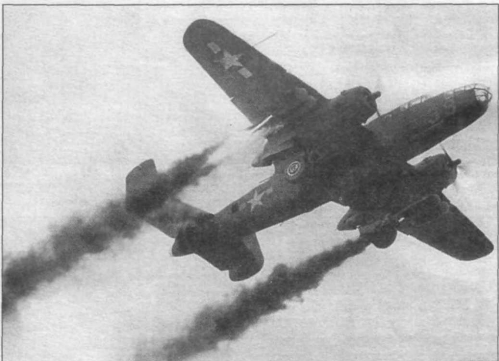
В-25С или D во время взлета с использованием ракетных ускорителей (JATO - Jet Assisted Take-Off). Ускорители парами подвешены под каждым крылом. С помощью JATO предполагалось облегчать взлет бомбардировщиков с коротких ВПП полевых аэродромов на островах Тихого океана.
