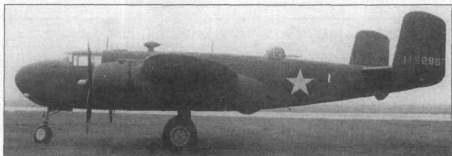
XB-25G (41-13296). Обратите внимание на желтый колпак на стволе 75-мм пушки. На серийных B-25G колпак отсутствовал.
