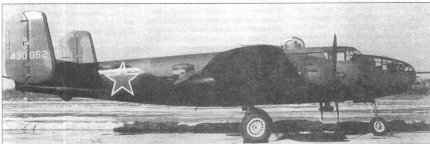
В-25J-25 (44-30052) в камуфляже в виде пятен Olive Drab/Field Drab/Slate Gray на верхних и боковых поверхностях. Снизу самолет целиком выкрашен черной краской.
