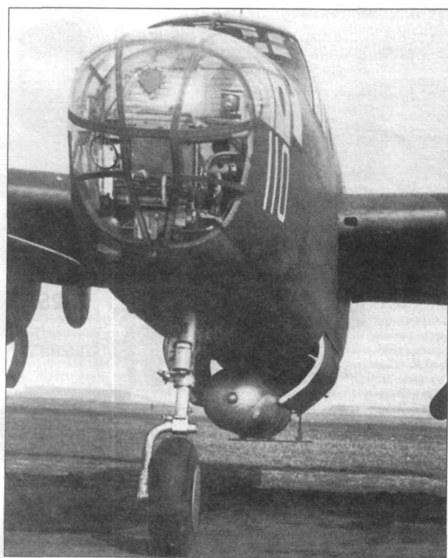
В-25В (40-2274) с торпедой Mk 13. Хотя торпеда была очень короткой, она все равно не вмещалась в бомбоотсек самолета, поэтому ее приходилось подвешивать снаружи. Торпеда снижала максимальную скорость самолета примерно на 20 км/ч. Обратите внимание на специальный фанерный стабилизатор, прикрепленный к хвосту торпеды. В остекленном носовом обтекателе видно заделанное окно для курсового пулемета.
