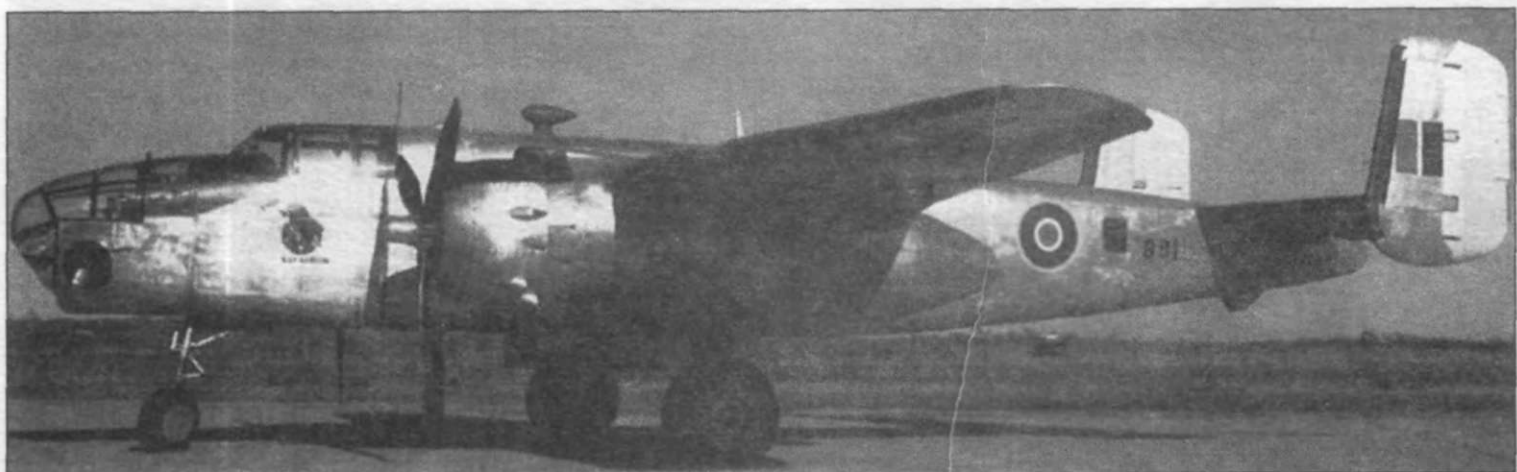
В-25D-1 (41-29886), переделанный в F-10. Этот самолет вместе с тремя другими F-10 действовал в составе RCAF. Видны фотокамеры, установленные в носовой части машины.
