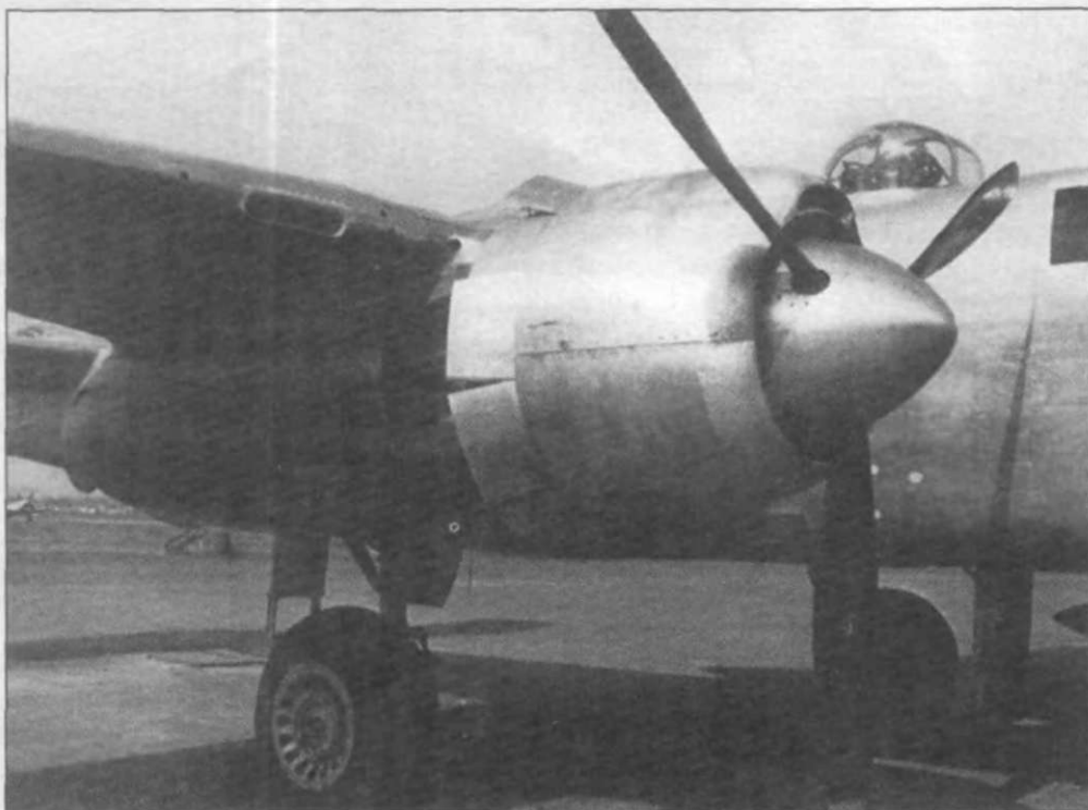
NA-98X с экспериментальным капотом двигателя.
