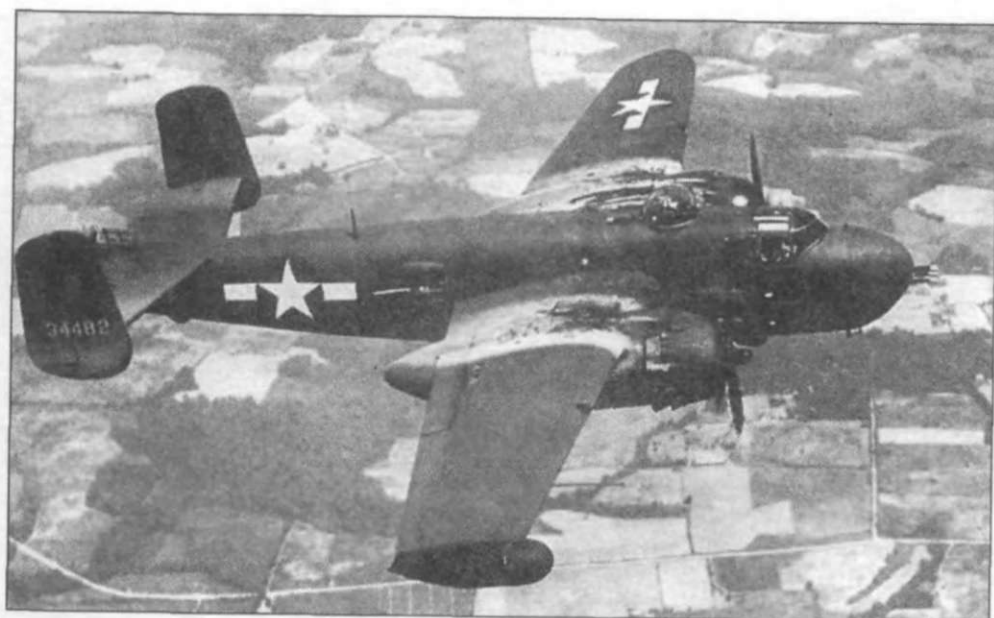
РВJ-1Н (43-4482) в полете, 1944 год. Вместо оконцовки правого крыла установлен ра- дар AN/APG-23. Остался незакрашенный серийный номер USAAF.
