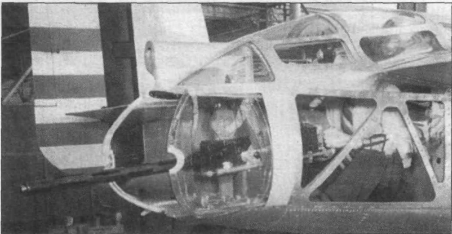
Хвостовая огневая точка, типовая для первых 64 В-25 и В-25А. За плексигласовыми створками виден 12,7-мм пулемет Colt-Browning, оснащенный телескопическим прицелом.
