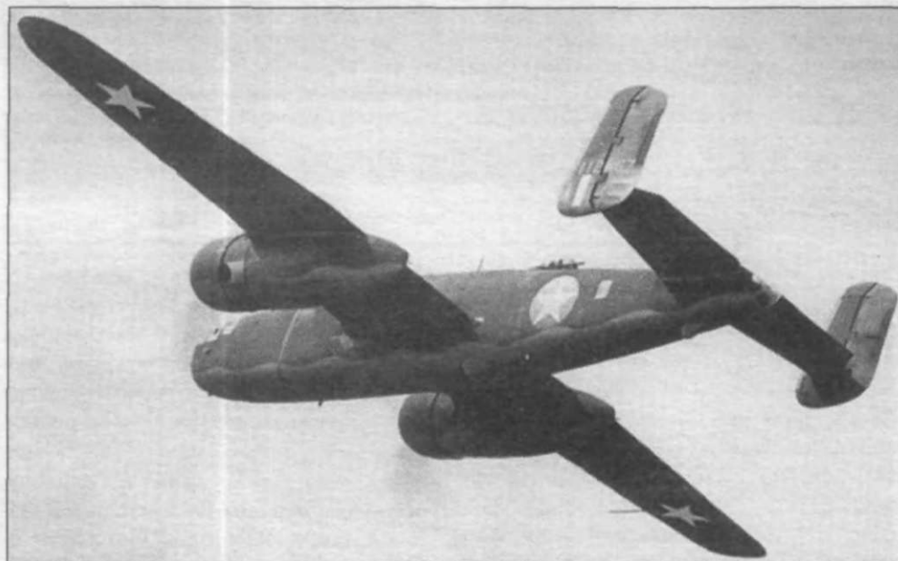
В-25С (41-12667) с опознавательными знаками без красных кругов. На борту фюзеля- жа видна красная полоса, указывающая на расположение плоскости винта. Обратите внимание на волнистую границу между верхним и нижним камуфляжем.
