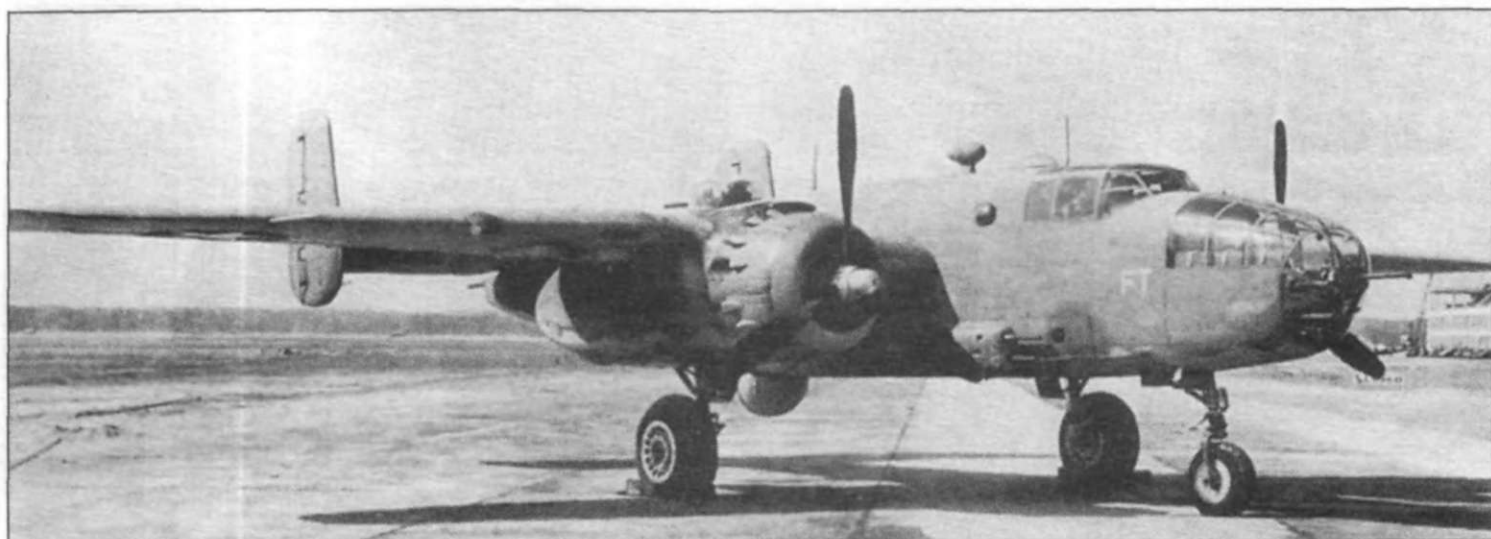
РВJ-1В - морской аналог В-25В, 31 мая 1945 года. Под фюзеляжем виден обтекатель радара. Желтые литеры «FT» на носу самолета указывают, что машина предназначена для летных испытаний. Обратите внимание на позднейшие переделки: пулеметы в носу, пулеметы в обтекателях типа «Townsville» по бокам носа и двигатели с пламегасителями Clayton «S».
