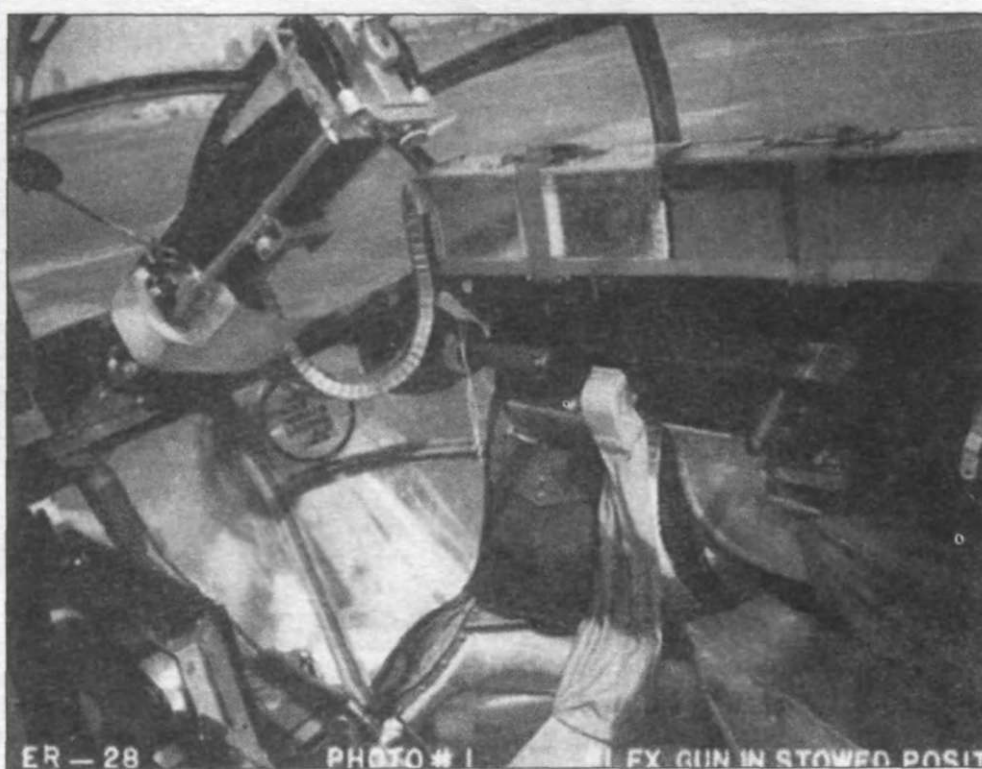
Два снимка. Носовое вооружение В-25С с неподвижным и наводимым пулеметами калибра 7,62 мм, вид изнутри и снаружи кабины. На снимке 864-й самолет модификации (42-53322).
