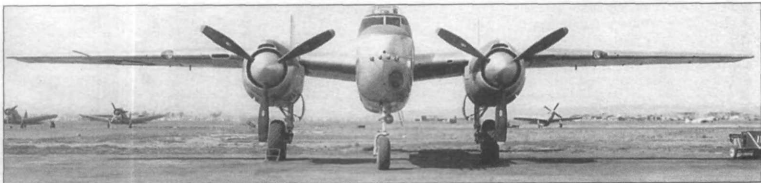
NA-98X, переделанный из стандартного B-25H-5, с двигателями Pratt & Whitney R-2800-51 и капотами двигателей от A-26. Этот самолет разбился.
