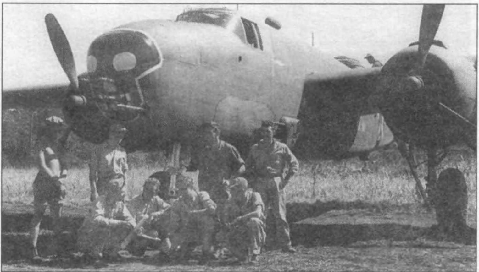
Одна из полевых модификаций В-25D. Видны накладки перед боковыми пулеметами в установках «Townsville», которые защищали обшивку от воздействия пороховых газов. Стандартный камуфляж Olive Drab/Neutral Gray. Череп на носу был эмблемой 13th BS, 3rd BG, Порт-Морсби, Новая Гвинея, середина июня 1943 года.
