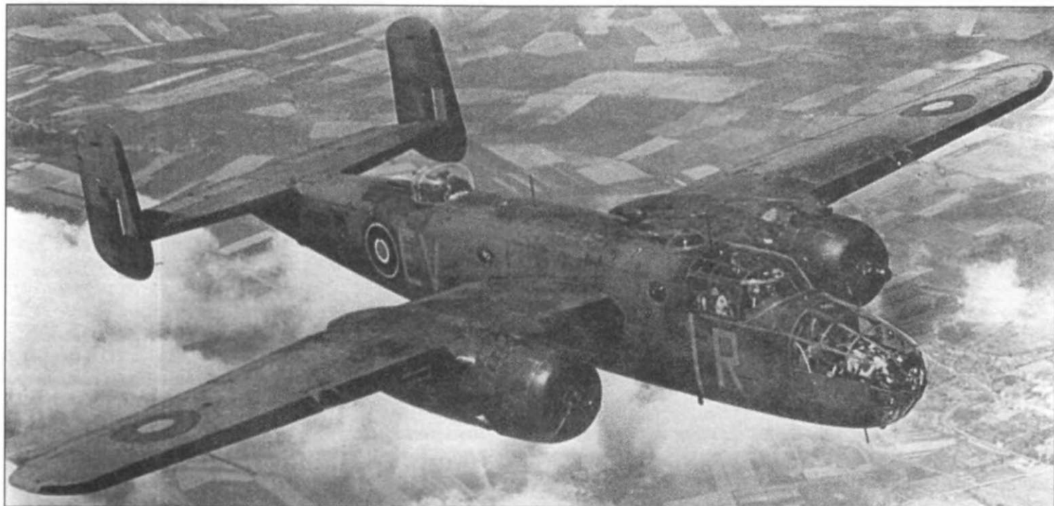
«Mitchell II» из 180-й эскадрильи RAF в английском камуфляже Dark Earth/Dark Green/Sky. Литеры тактических обозначений красного цвета. «Fin flash» нанесен на обе стороны хвостовых шайб.
