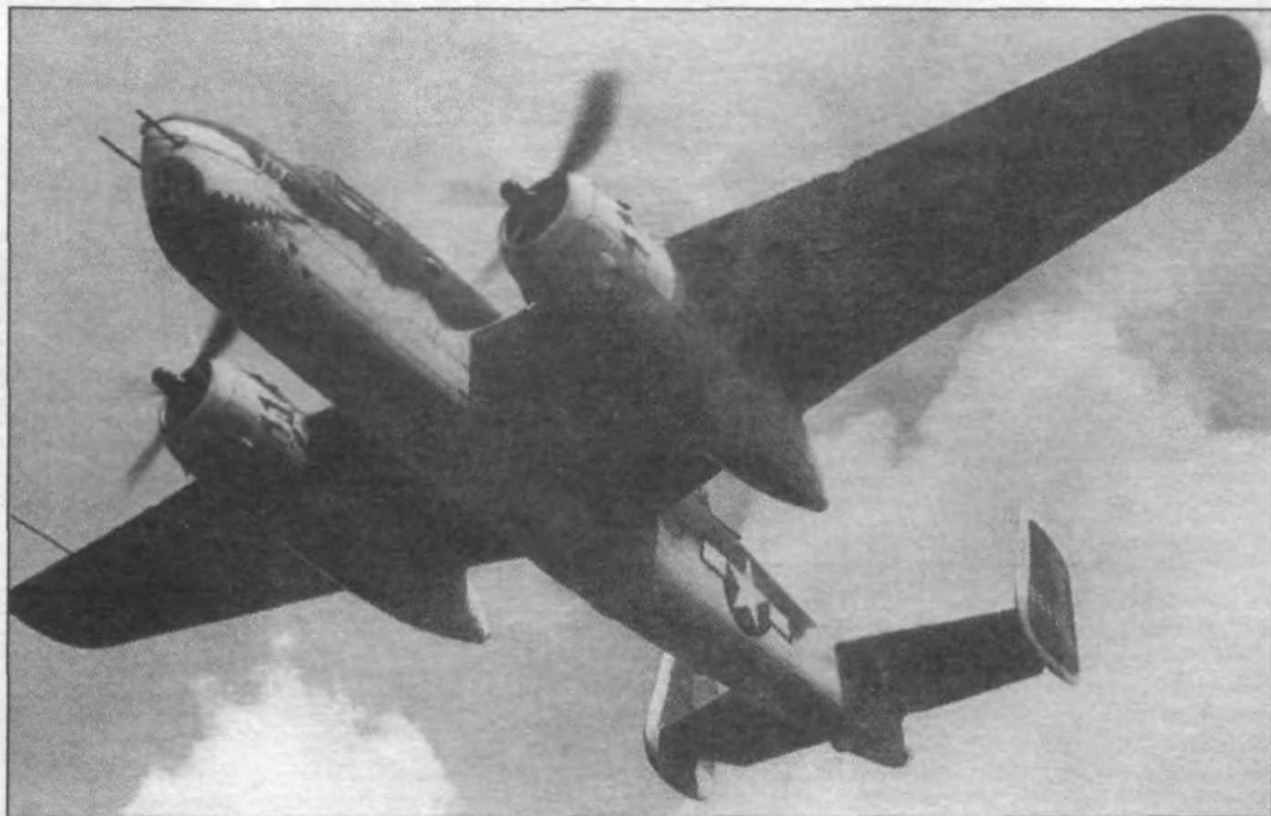
В-25G в камуфляже типа Sea-Search - Olive Drab/White. Такой камуфляж накладывался на самолеты, занимавшиеся поиском подводных лодок противника.
