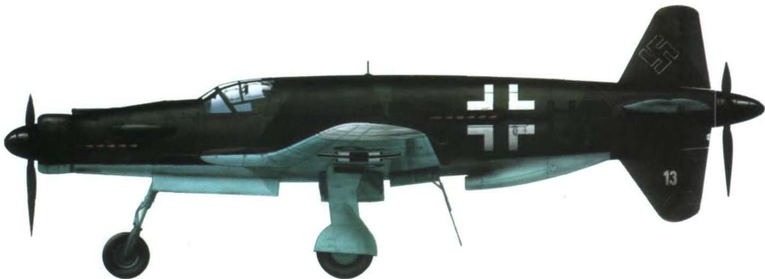
Do 335M13(B-2) (W.Nr. 230013), камуфляж RLM 81/82/65. Оконцовки крыльев не окрашены, прошпаклеваны RLM 02. На нижней стороне крыльев кресты шириной 1525 мм, на бортах фюзеляжа 1250 мм.
