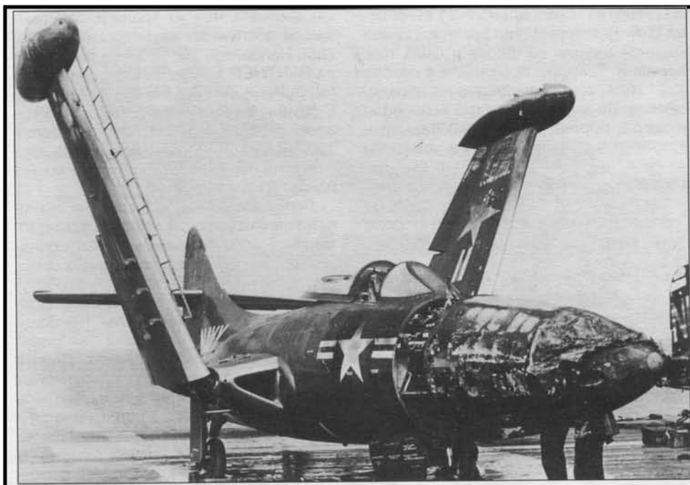
Во время пожара на палубе авианосца «Боксер» у этого F9F-2 сгорел обтекатель носовой части
