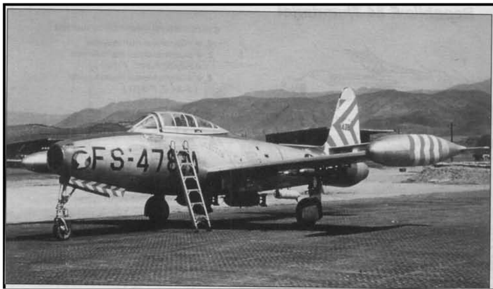
F-84E с двумя 454-кг бомбами, четырьмя НУР HVAR и стартовыми ускорителями JATO
