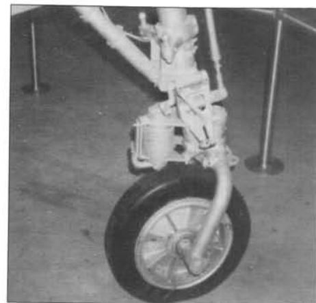
Передняя стойка шасси F-84. Хорошо виден цилиндр демпфера колебаний типа шимми
