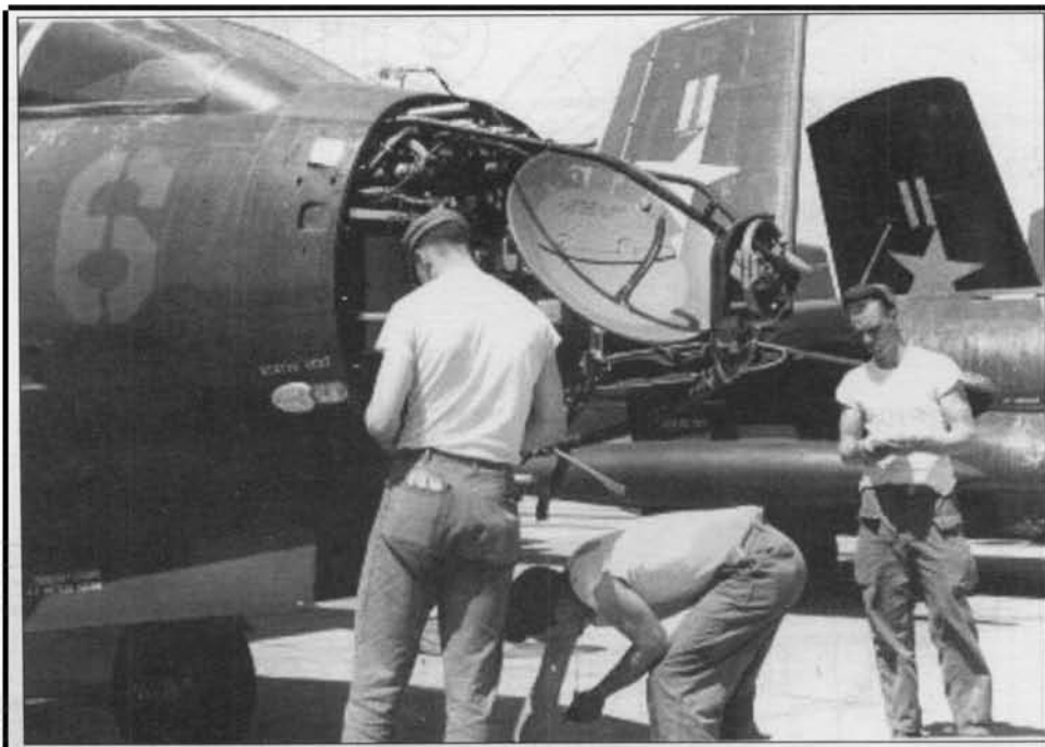
Носовая часть F3D-2 Skyknight со снятым обтекателем — на снимке хорошо видна «тарелка» антенны РЛС
