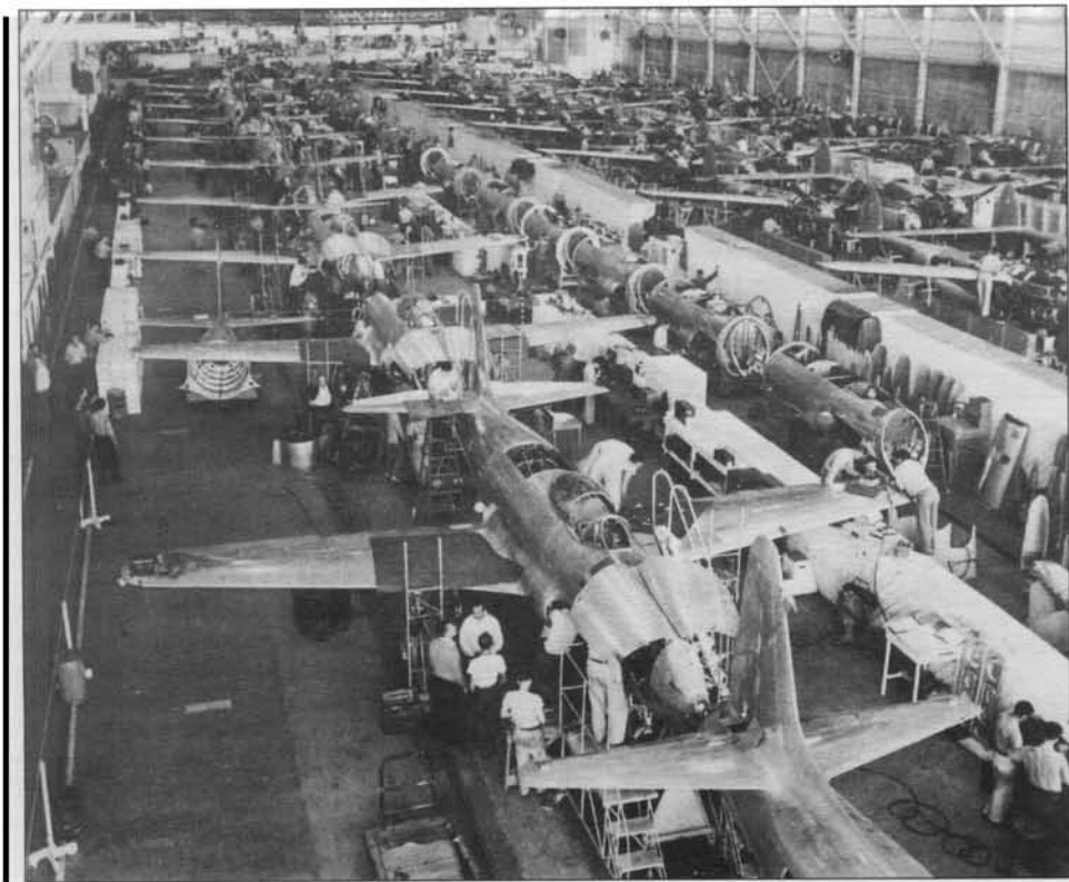
Сборочная линия F-80 на заводе фирмы Lockheed. Рядом собирают самолеты P-38
