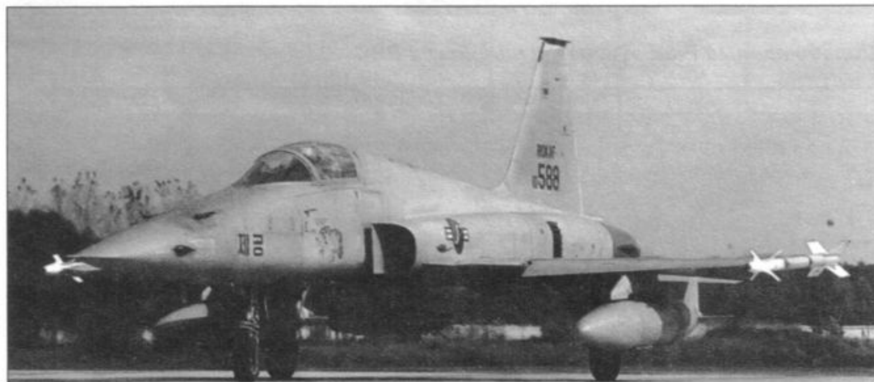
Южнокорейский F-5E поздней серии с овальным обтекателем РЛС
