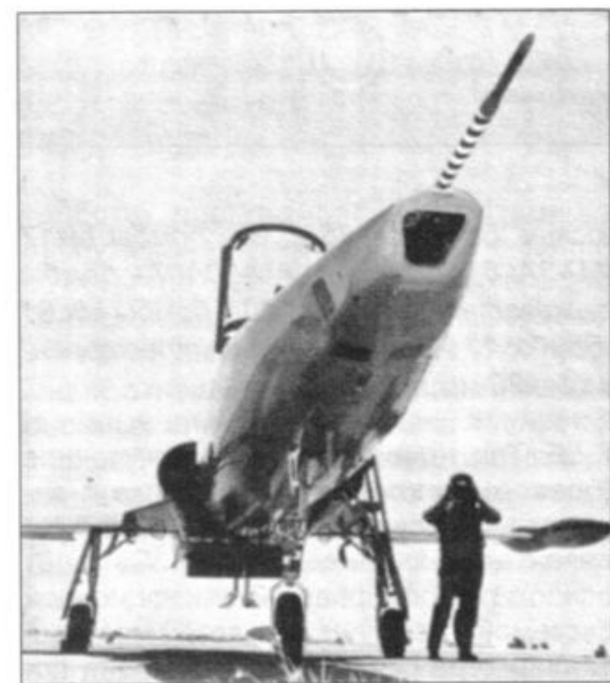
Разведчик RF-5A; хорошо видно остеклённое окно в носовой части фюзеляжа
