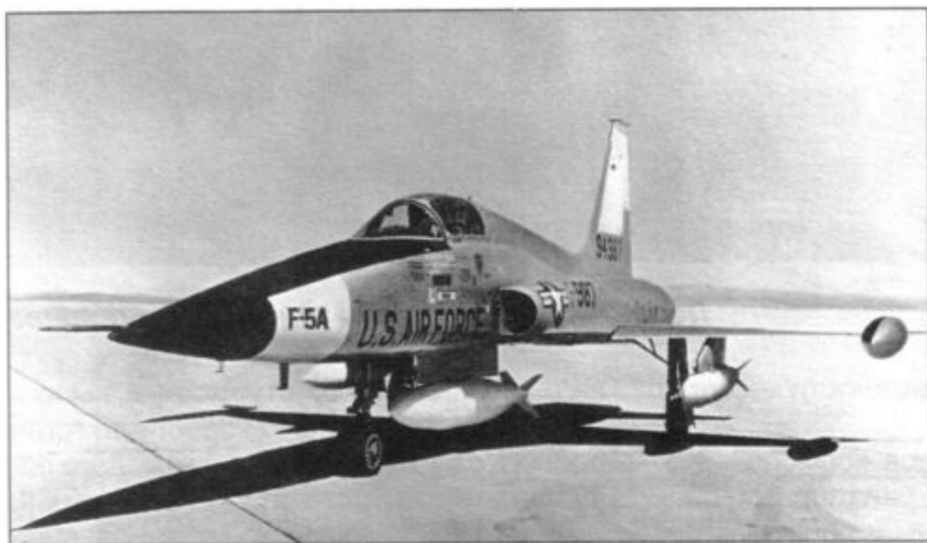
Первый опытный образец N-156F с тремя подвесными топливными баками
