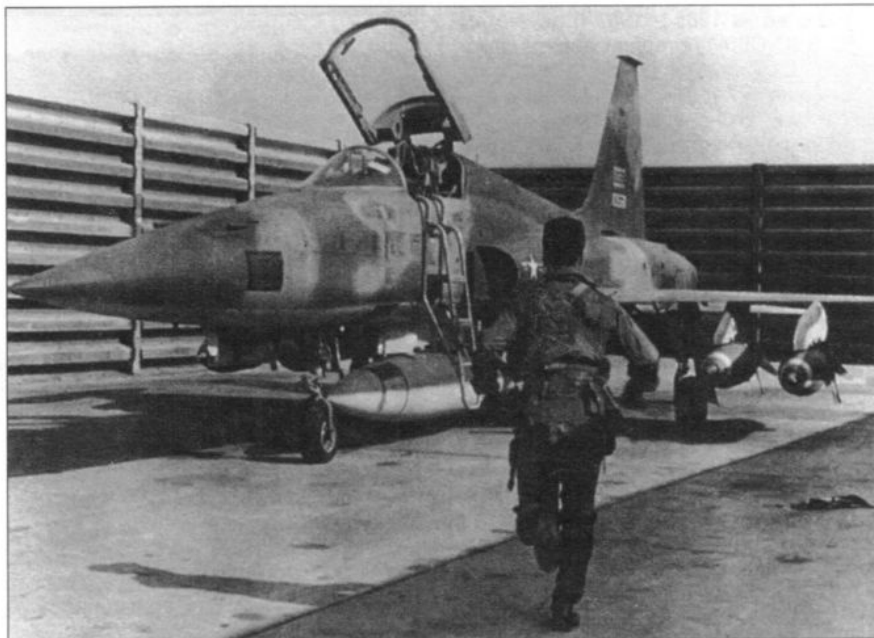
Пилот бежит к своему F-5C; под крылом подвешены четыре бомбы M117
