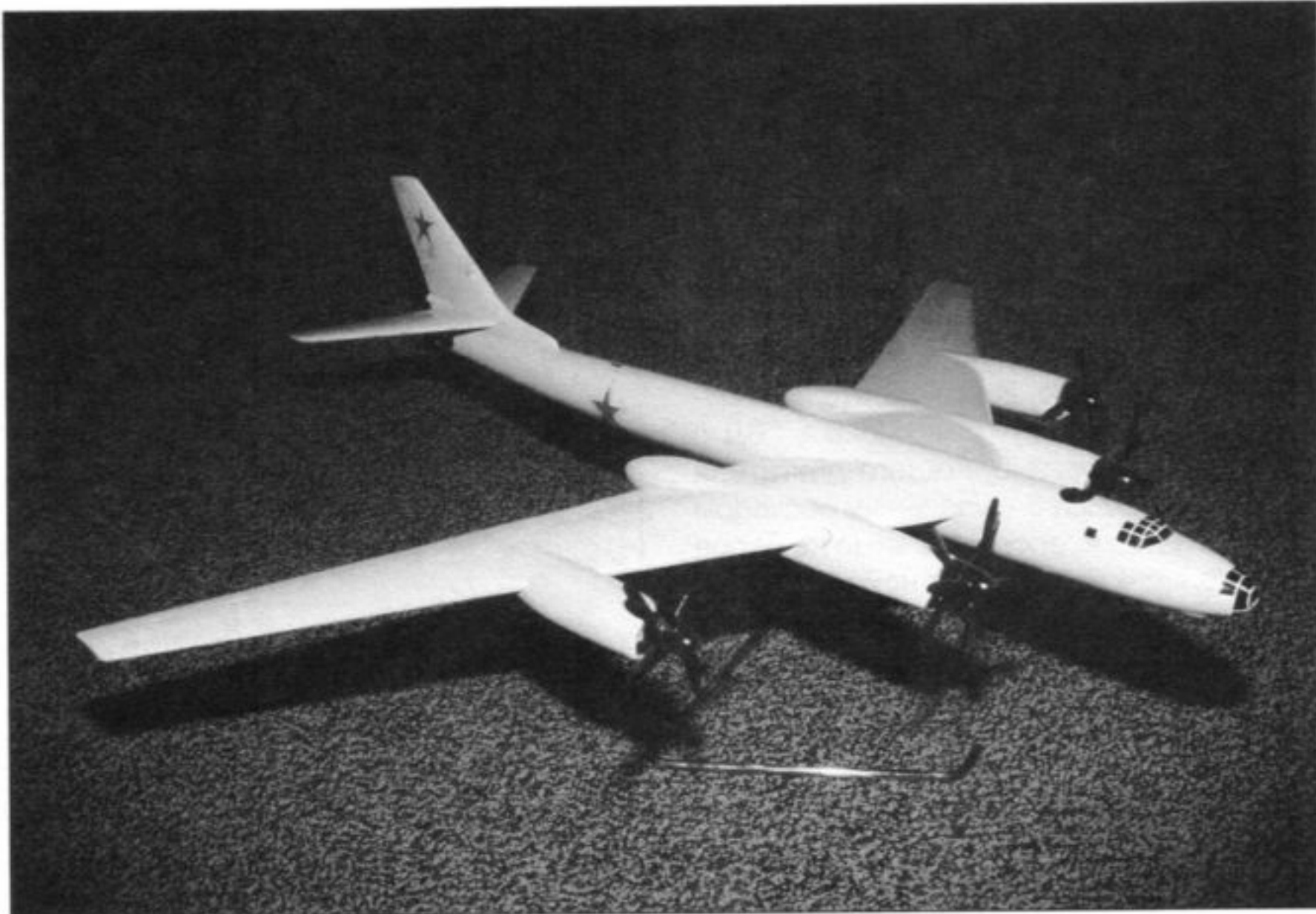
Модель первого образца Ту-95 с ТВД 2ТВ-2Ф
