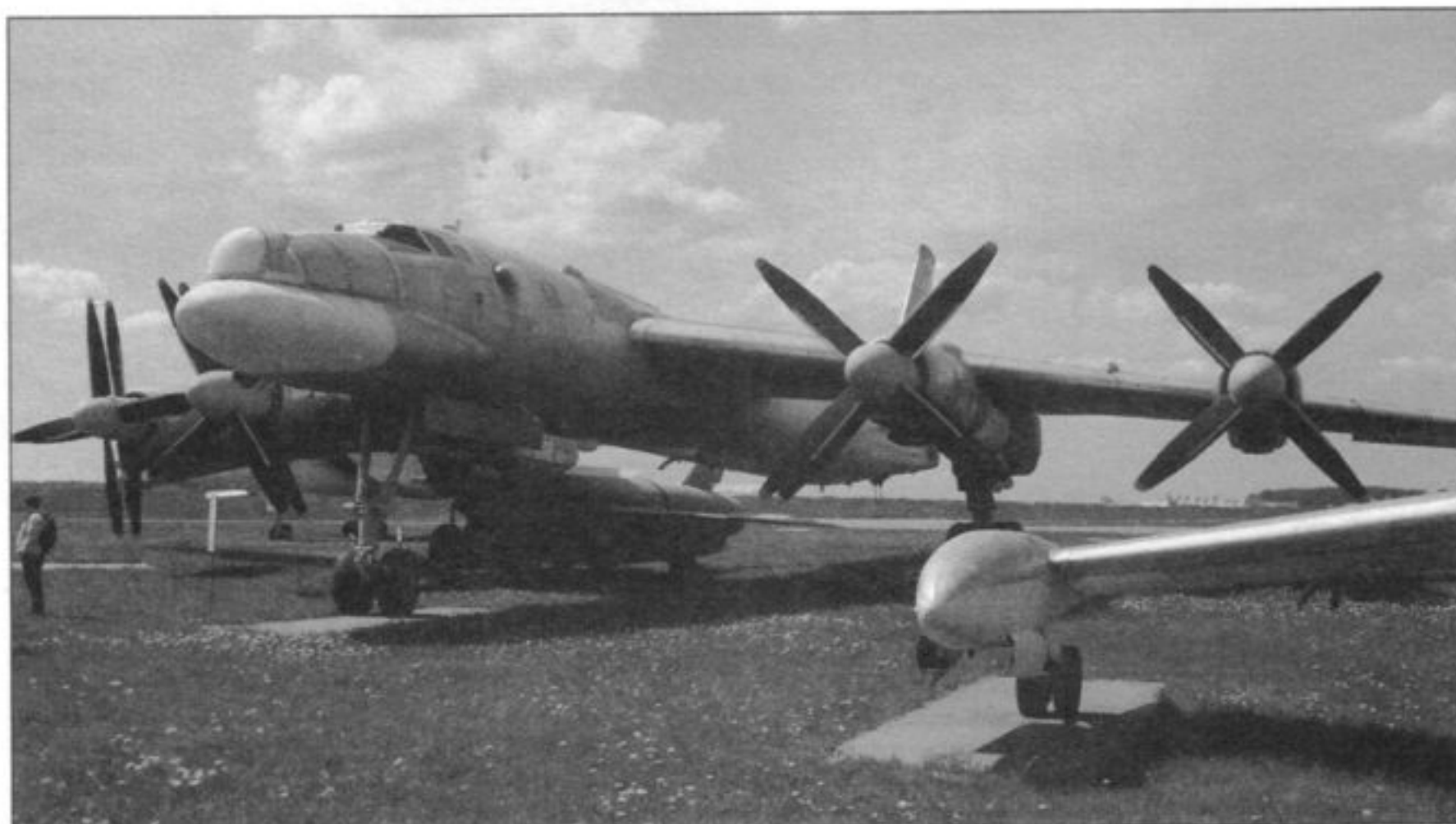
Ракетоносец Ту-95К в стандартной окраске. Обтекатель антенны РЛС в носовой части фюзеляжа — белый
