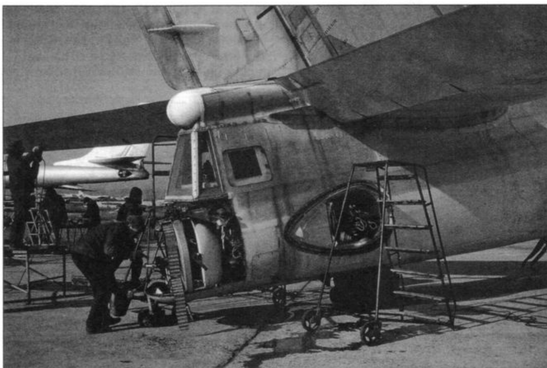
Ремонт кормовой пушечной установки
