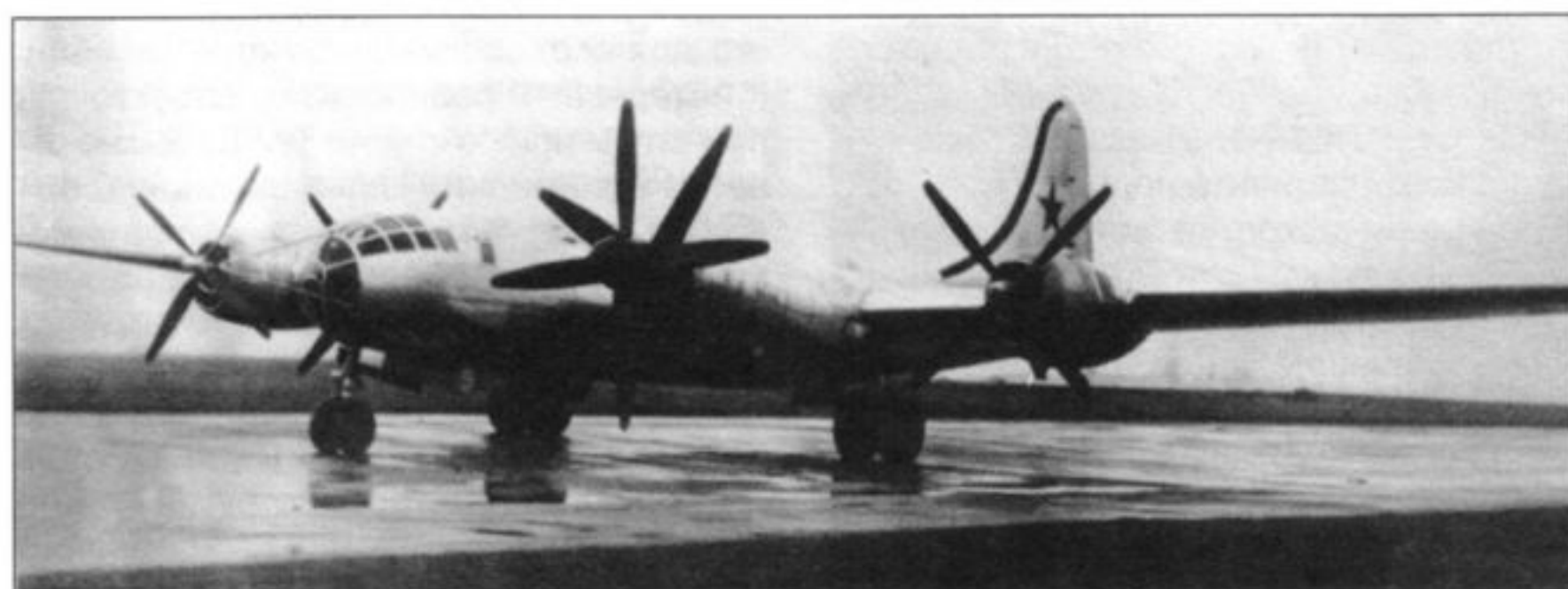
Летающая лаборатория Ту-4ЛЛ, на которой испытывали ТВД 2ТВ-2Ф
