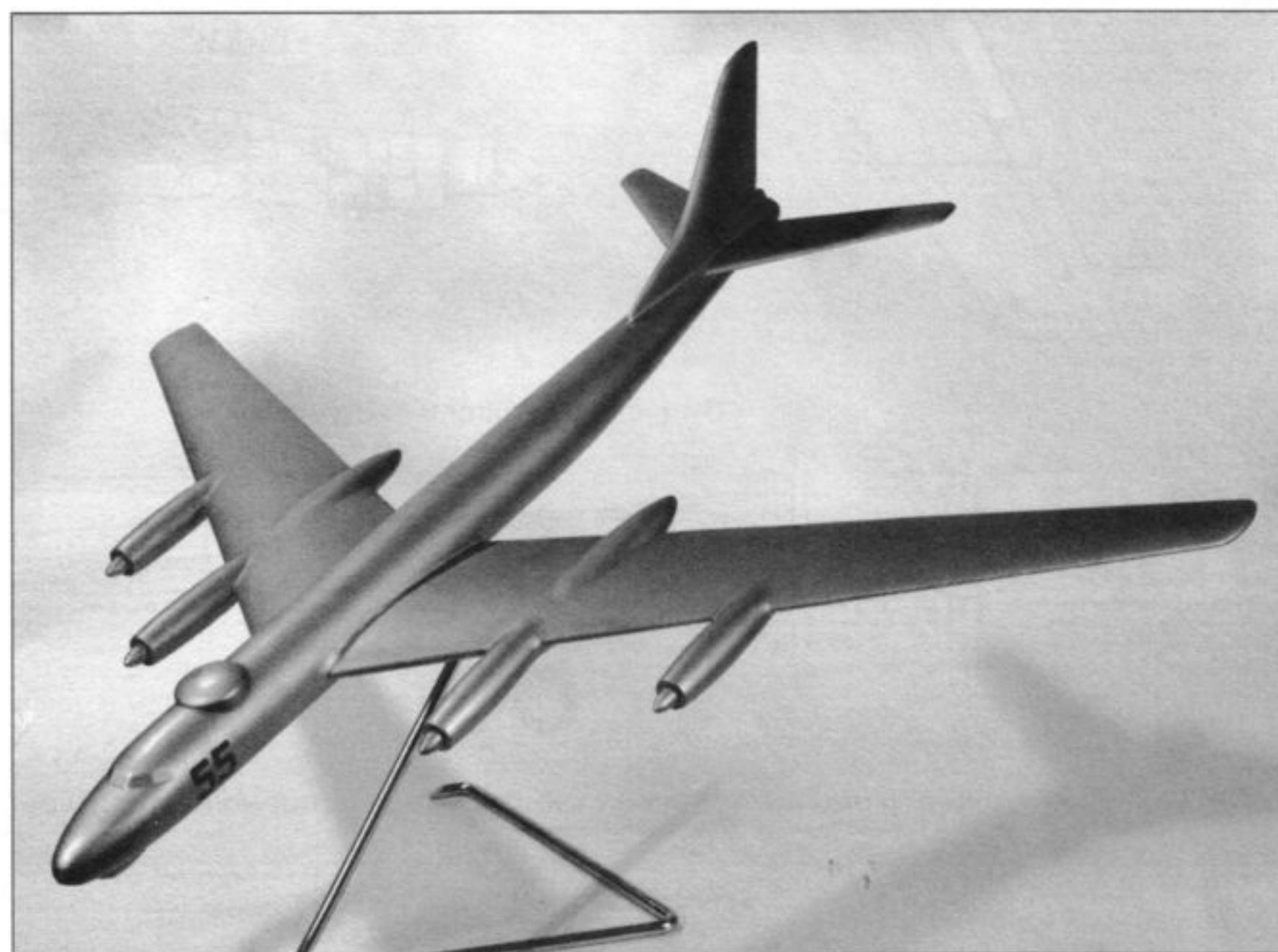
Модель одного из первых вариантов самолёта «119» с ядерной силовой установкой
