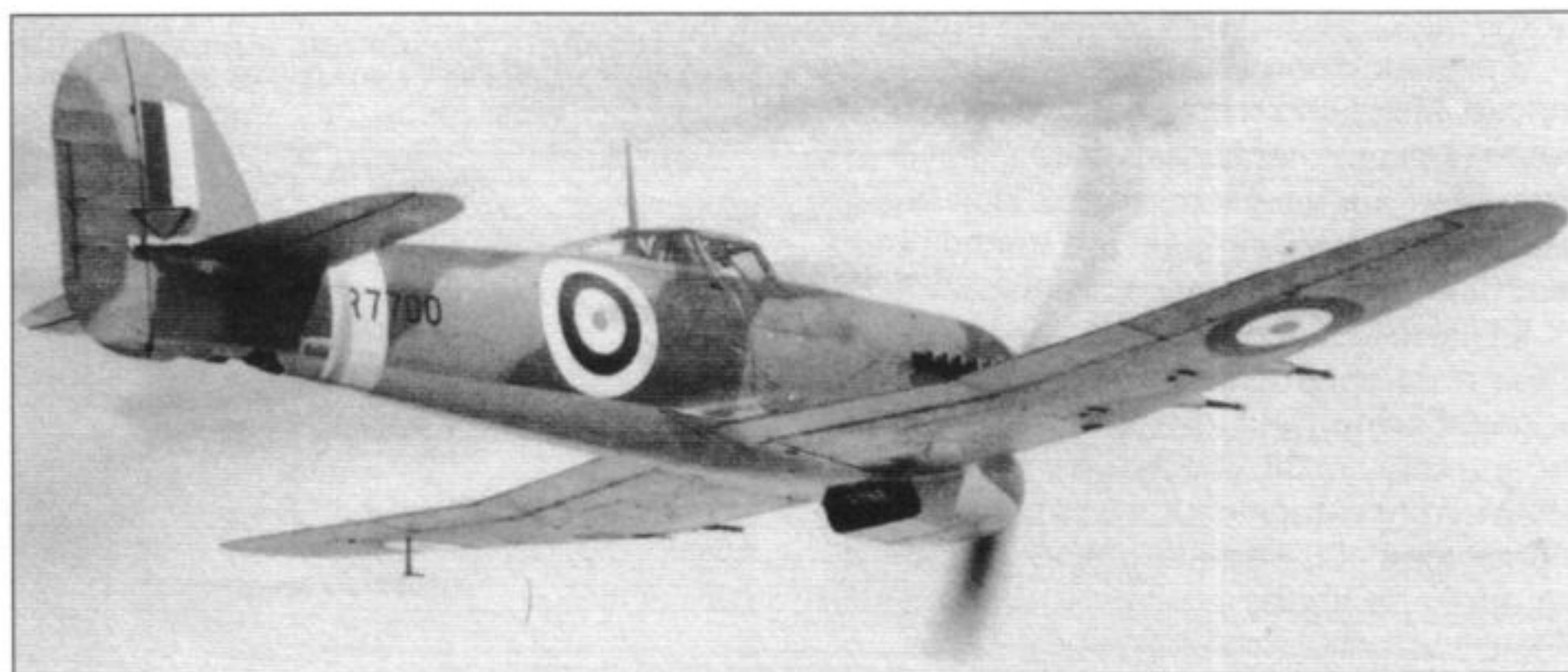
«Тайфун» IB во время испытаний в Боскомб-Дауне. На этом экземпляре отрабатывали способы уменьшить поступление угарного газа в кабину. На хвостовую часть фюзеляжа надето усиливающее стальное кольцо
