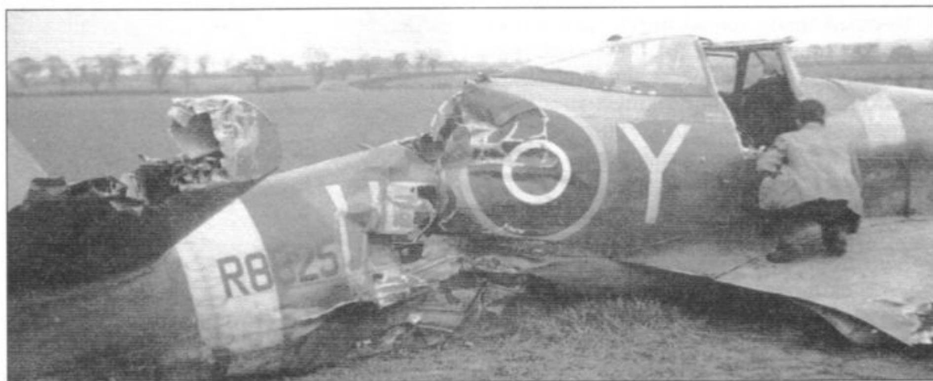
Этот «Тайфун» IB из 56-й эскадрильи столкнулся с обломками другого такого же истребителя, разрушившегося в воздухе. Правая дверь и крышка фонаря были сброшены лётчиком, когда он выпрыгивал из машины с парашютом
