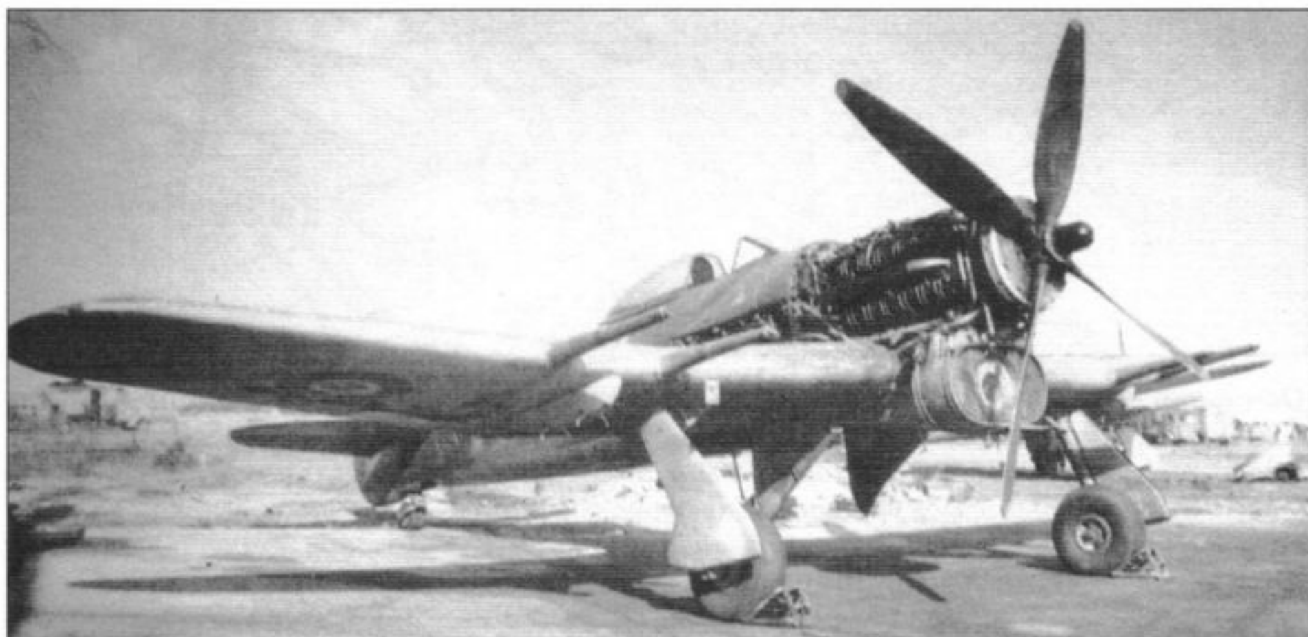
«Тайфун» позднего выпуска с раскапотированной мотоустановкой
