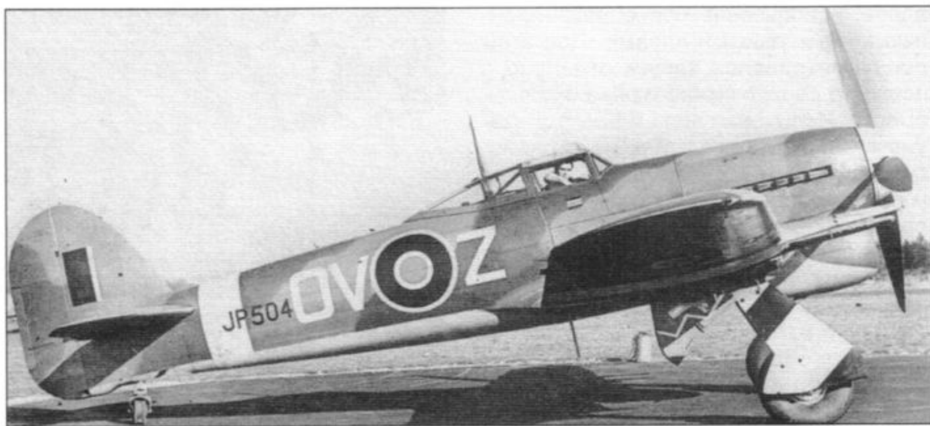
Серийный «Тайфун» IB с четырёхлопастным винтом, 197-я эскадрилья
