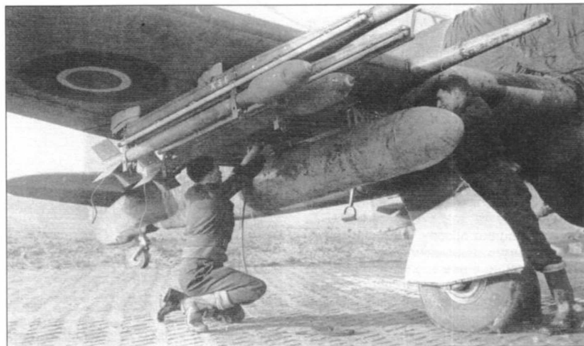
Сочетание подвески ракет и дополнительных топливных баков. Количество пусковых балок под каждым крылом уменьшено до двух
