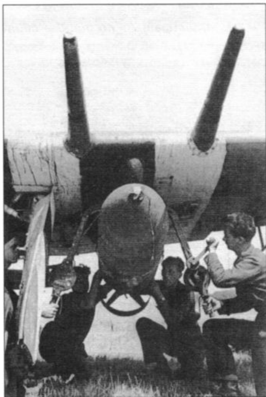
Подвеска 454-кг бомбы при помощи съёмных лебёдок; Франция, 1944 г.
