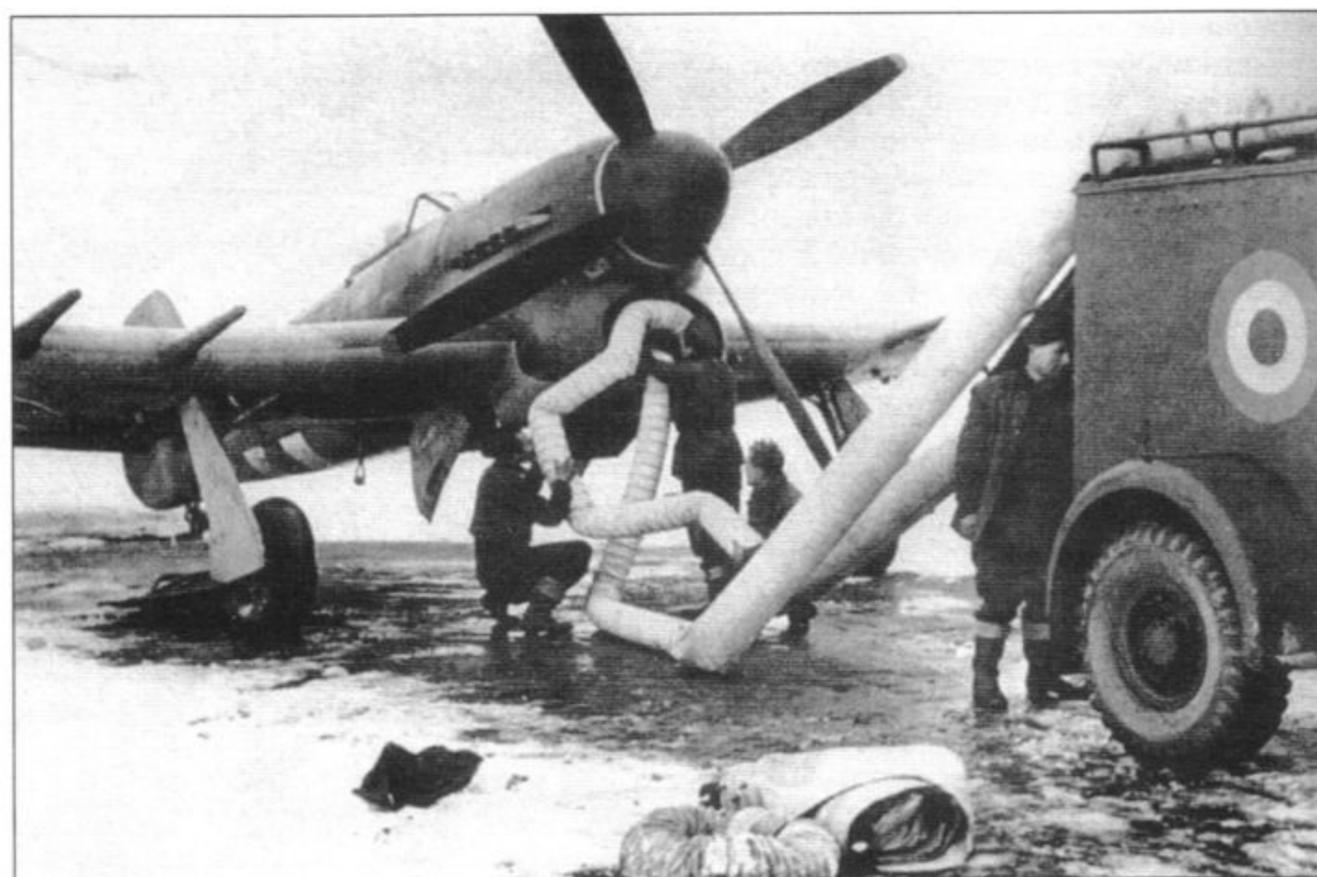
Прогрев радиатора на истребителе из 438-й эскадрильи, зима 1944/45 г.
