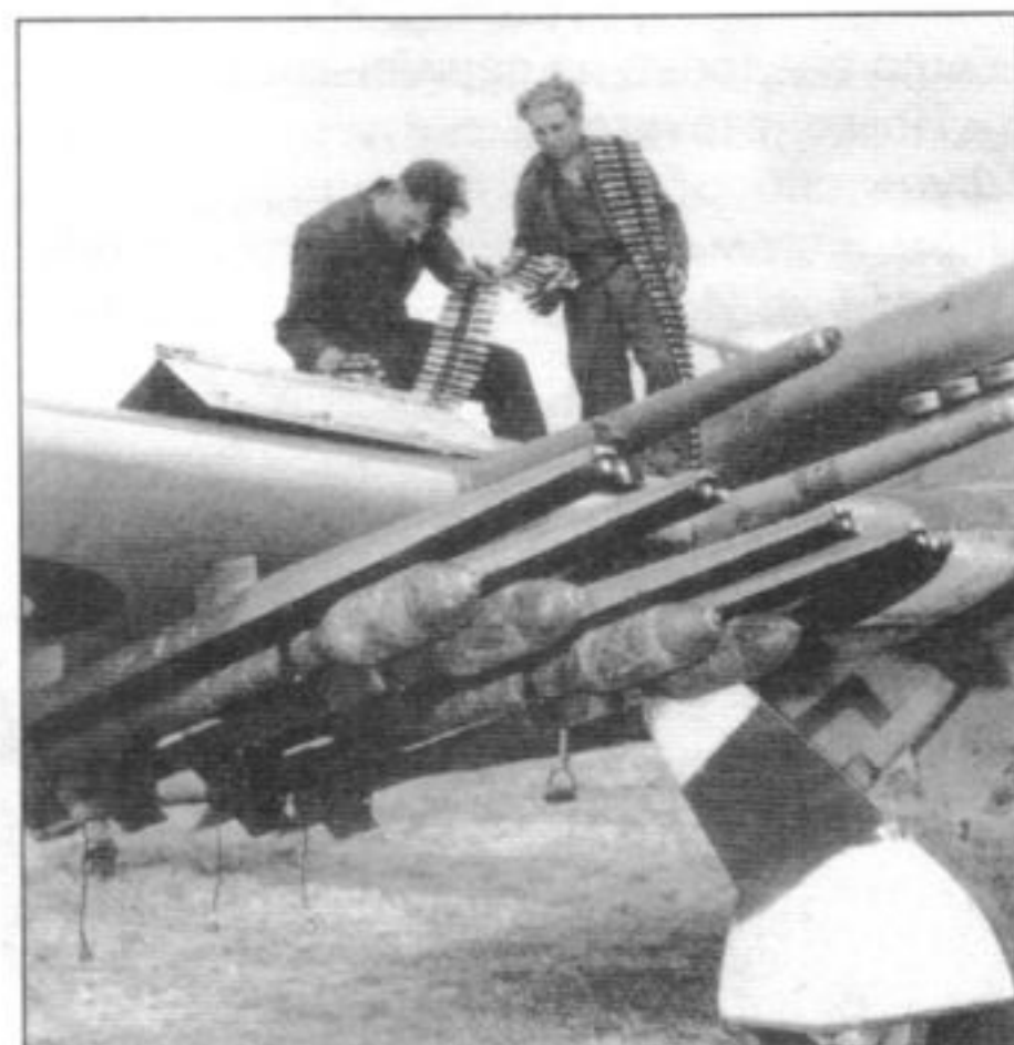
Оружейники укладывают боезапас для пушек в отсеки истребителя из 245-й эскадрильи. Самолёт оснащён балками типа Mk.1 для подвески ракет. Сами ракеты – с фугасной боевой частью
