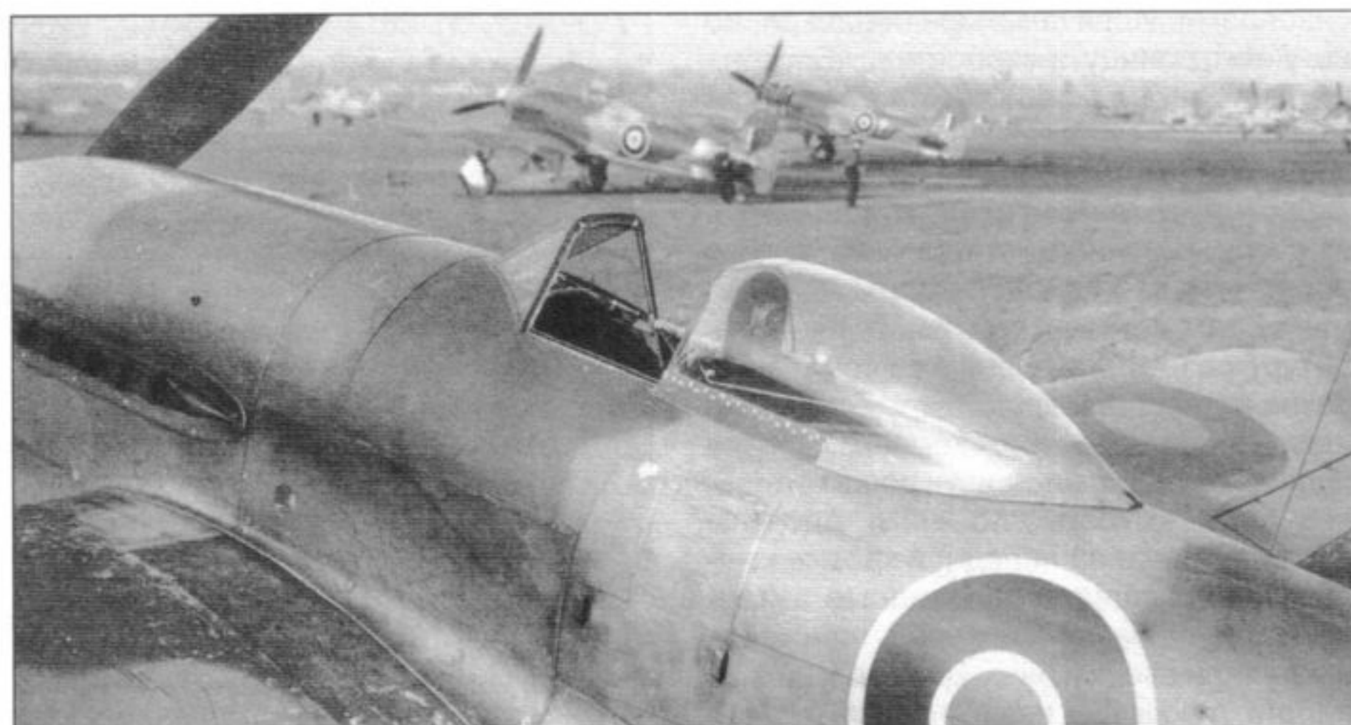
Новый фонарь кабины, задняя часть которого сдвигается назад. Видны заголовник бронеспинки и штыревая антенна
