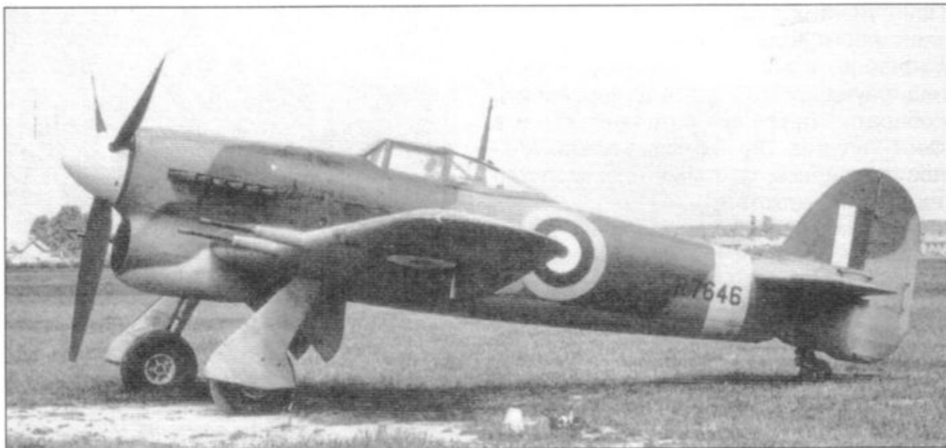
Самолёт R7646 – первый, получивший дополнительную секцию остекления вместо гаргрота. Он использовался фирмой «Хокер» для различных экспериментов
