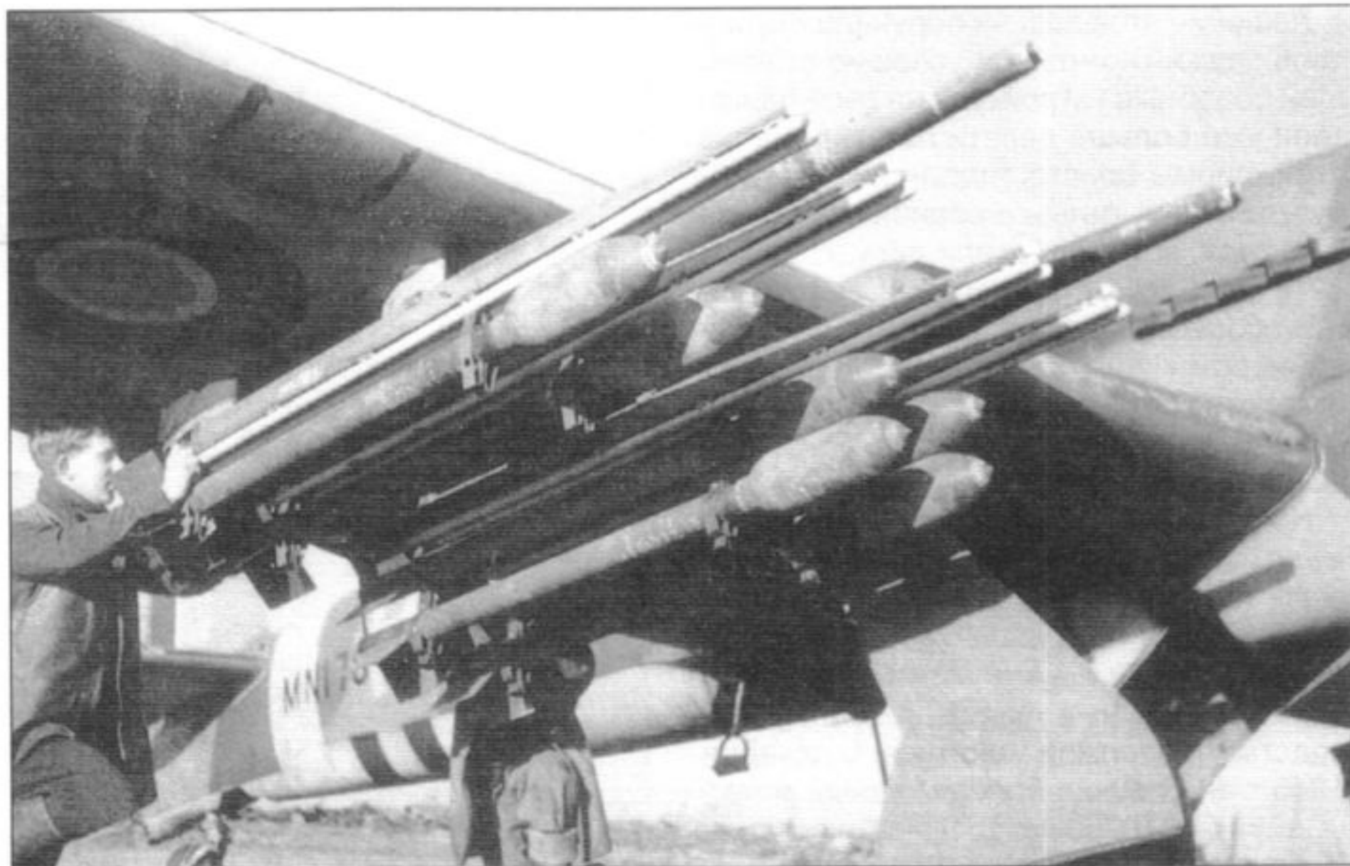
Двухрядная подвеска ракет на «Тайфуне» IV из 609-й эскадрильи
