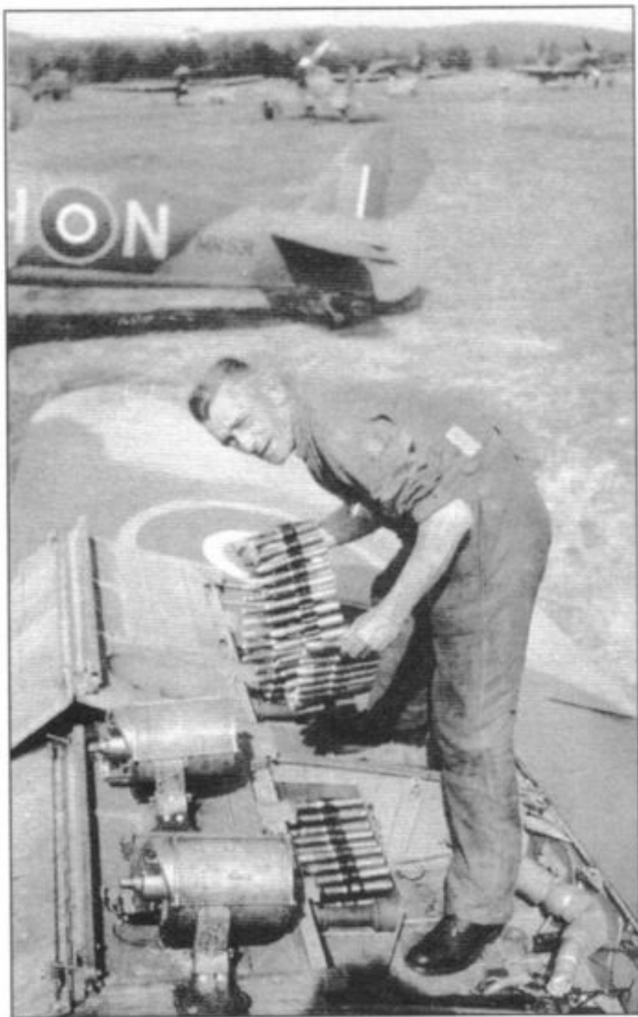
Укладка патронных лент для пушек на одном из самолётов 266-й эскадрильи
