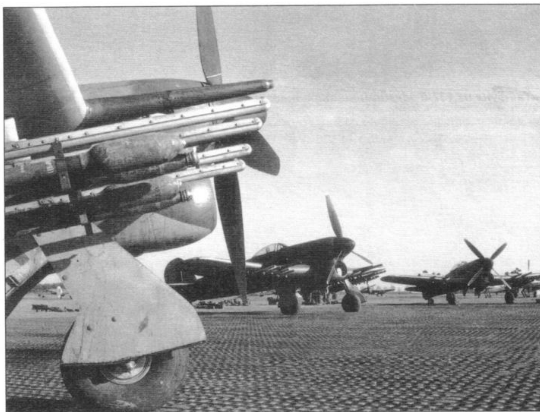
«Тайфуны» 175-й эскадрильи на аэродроме Гох, начало 1945 г. На самолёте слева установлены пусковые балки типа Mk.III, на которых подвешены ракеты с бронебойными и фугасными головными частями
