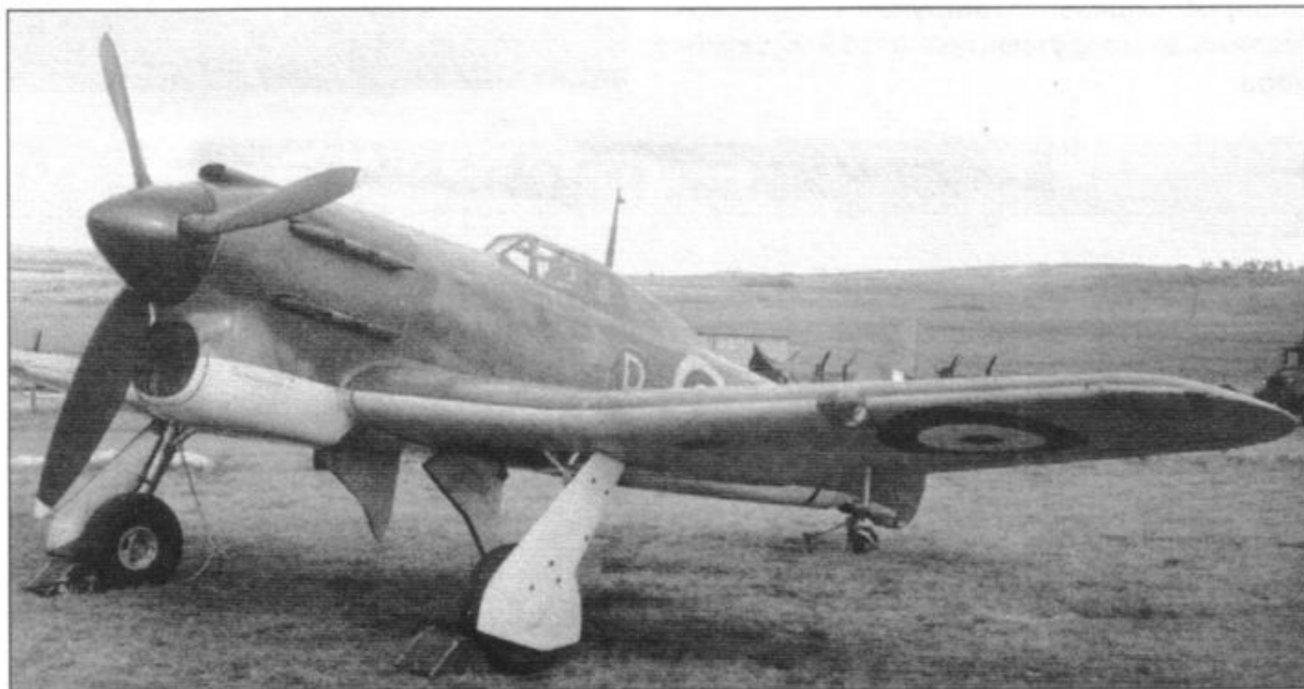
Второй образец «Торнадо» с окончательным вариантом щитков шасси
