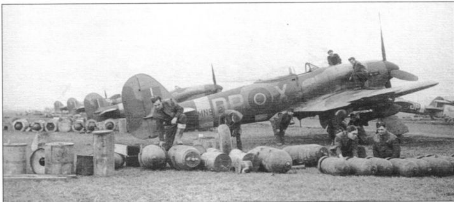
«Тайфуны» готовят к боевому вылету. Видны разложенные на земле бомбы по 227 кг и 454 кг
