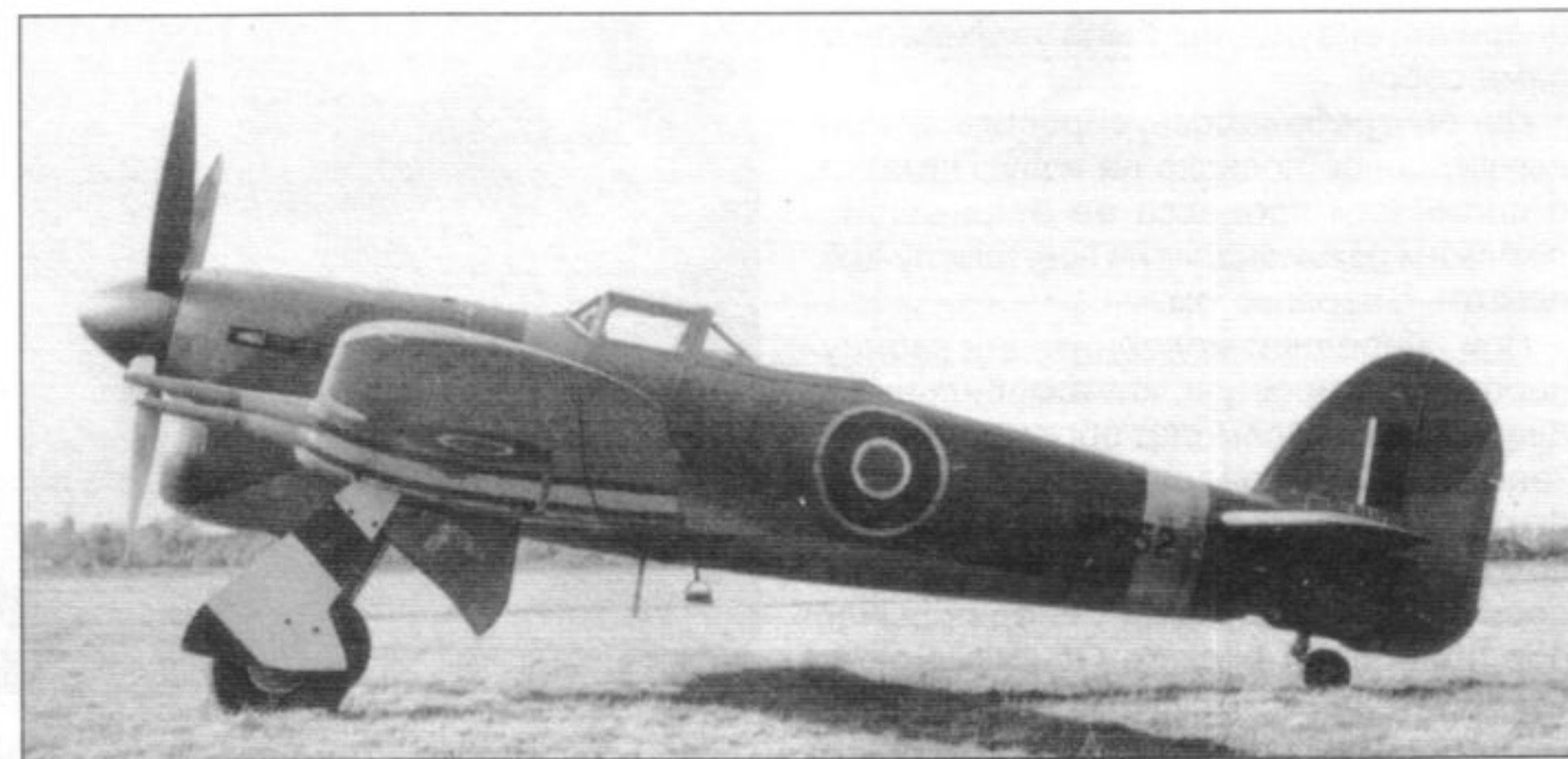
«Тайфун» IV на аэродроме в Лэнгли, сентябрь 1943 г. На этом самолёте опробовали четырёхлопастный пропеллер, штыревую радиоантенну и антенну СРО под фюзеляжем (рядом с выдвижной подножкой)
