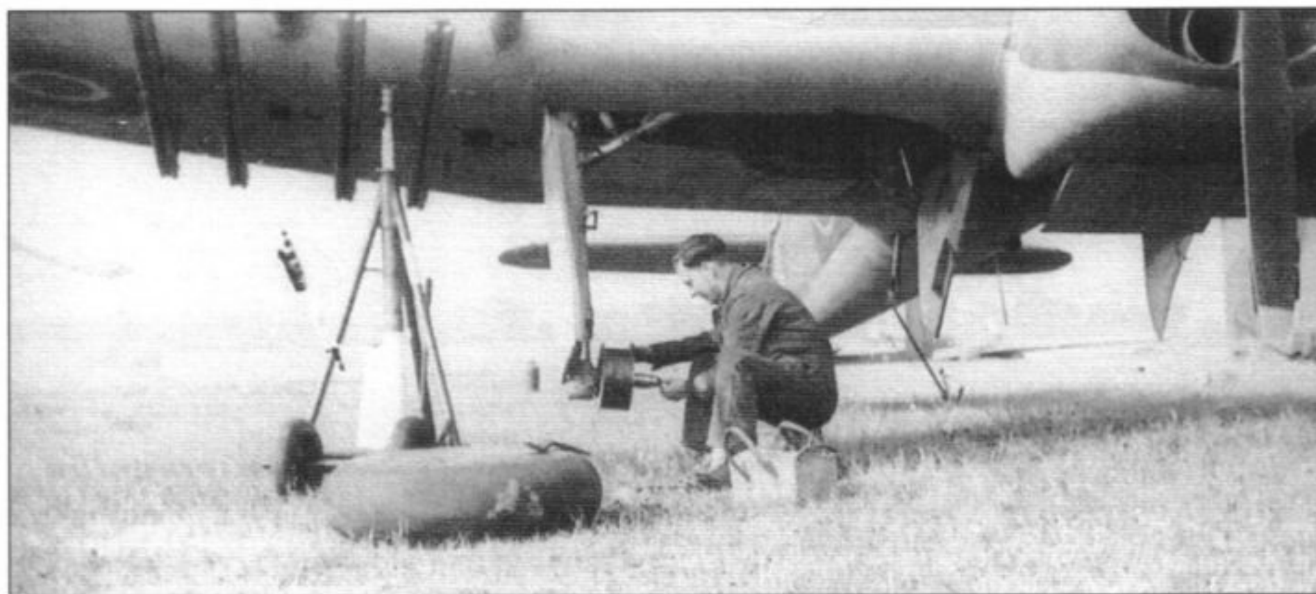
Ремонт шасси «Тайфуна»
