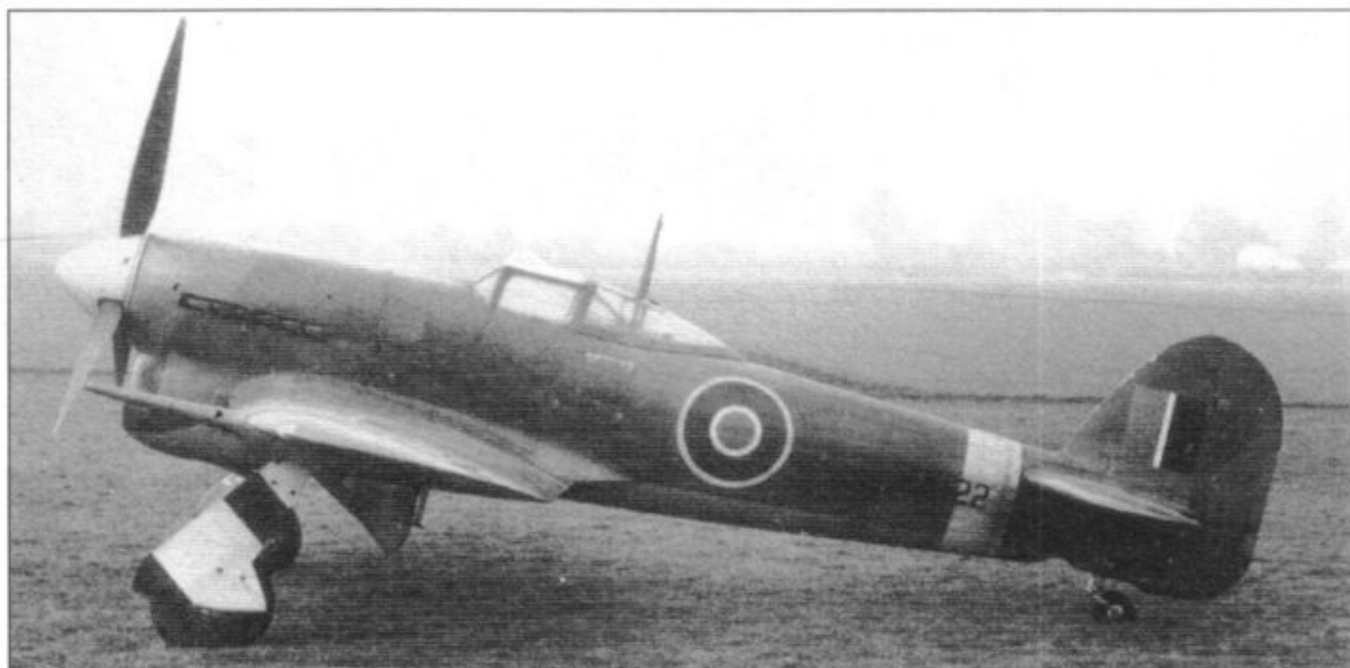
Серийный «Тайфун» IB, выпущенный весной 1943 г. Стволы пушек закрыты обтекателями, на крышке фонаря под блистером – зеркало для обзора назад
