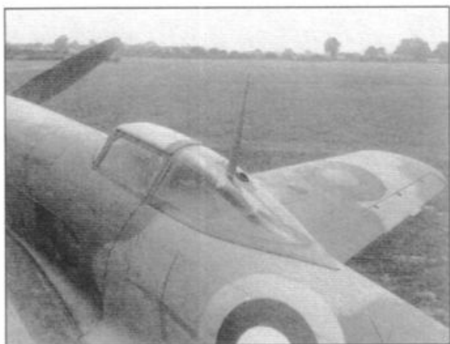
Фонарь кабины с дополнительной прозрачной секцией сзади. Хорошо видна проходящая через остекление мачта антенны
