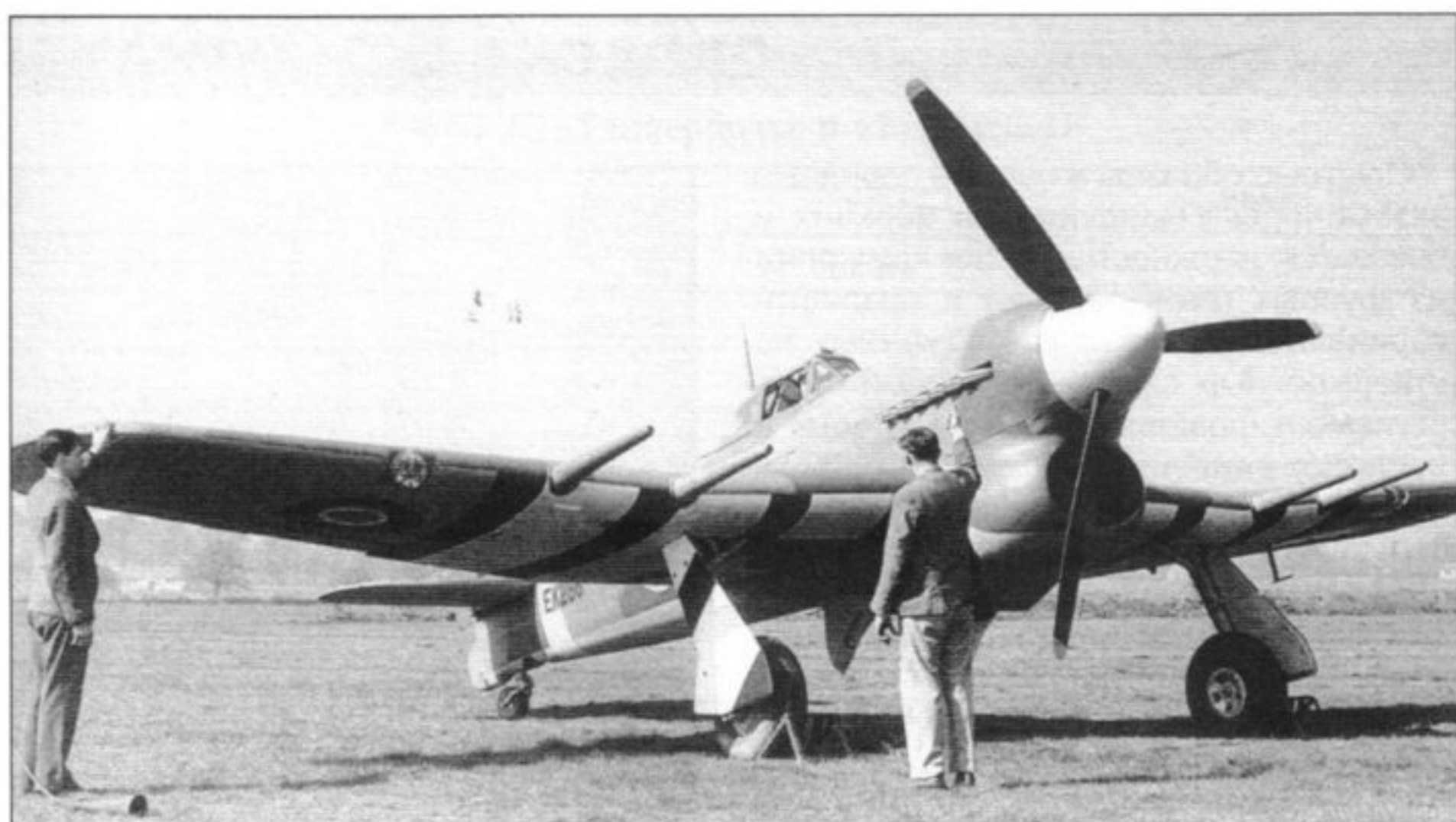
«Тайфун» IV с узкими чёрными и широкими белыми полосами под крылом
