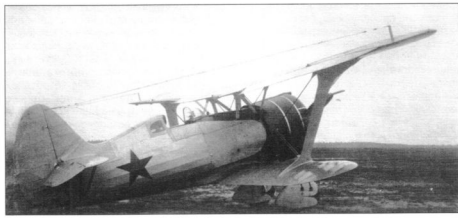
Первый опытный образец И-15бис на испытаниях. Он отличался увеличенным козырьком пилота, прицелом ПАК-1, небольшими окнами в гаргроте, радиостанцией РСИ и колесом-роликом на костьле
