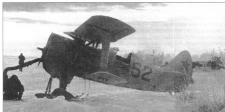
Подогрет мотора И-15бис перед вылетом, зима 1941/42 г.
