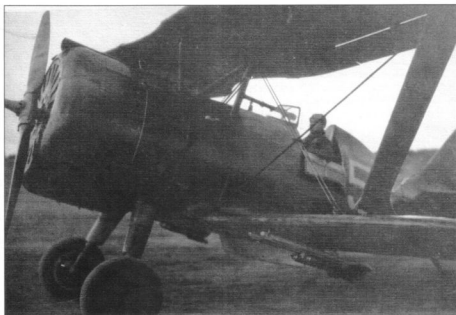
И-15бис с реактивными снарядами РС-82, 1943 г.
