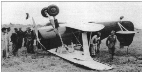
Скапотировавший китайский И-15бис. Обратите внимание, на костыле — хаотическое колесо
