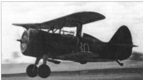
И-15бис из состава 71-го иап ВВС КБФ заходит на посадку. В кабине старший лейтенант В.Ф. Абрамов. Самолёт камуфлирован импровизированными чёрными пятнами и полосами
