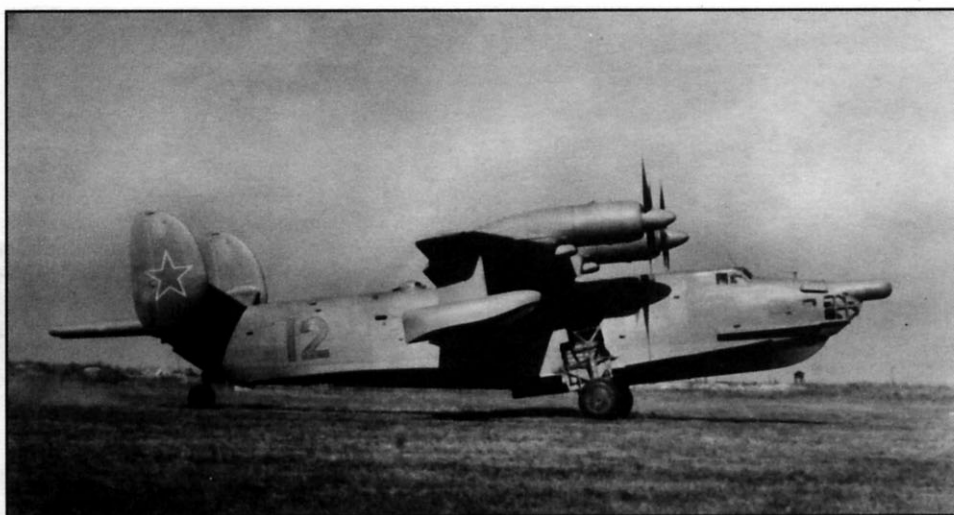
На втором опытном образце Бе-12 антенну РЛС «Инициатива-2Б» перенесли в носовую часть лодки
