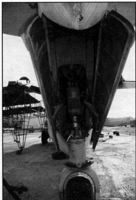
Ниша хвостовой опоры шасси
