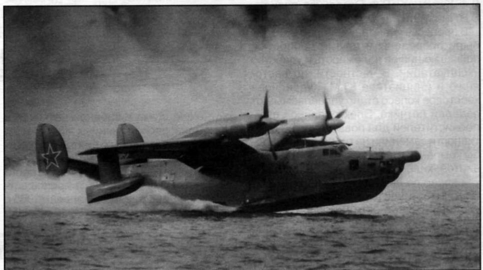
Второй опытный образец Бе-12 взлетает с воды. Обратите внимание на перелёт кабины штурмана, отличающийся от серийных машин
