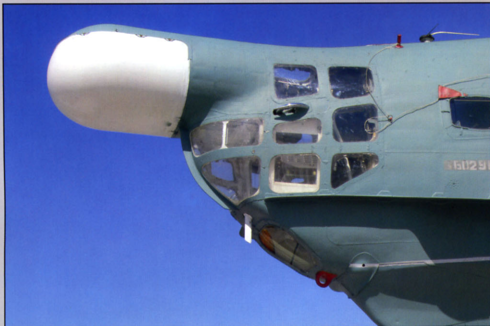
◀ Носовая часть фюзеляжа с кабиной штурмана и обтекателем РЛС «Инициатива 2Б»
