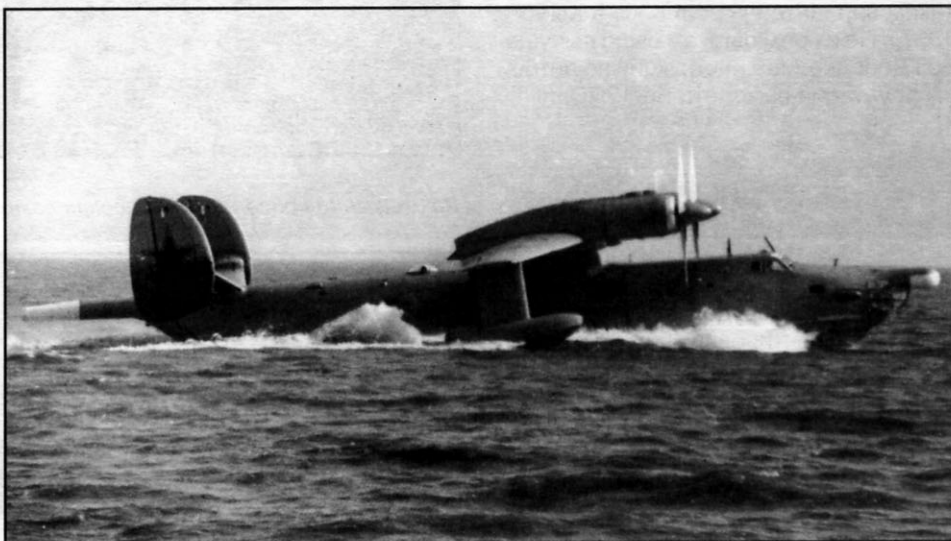
Поисково-спасательный самолёт Бе-12ПС, переоборудованный из серийной противолодочной машины, 1972 г.
