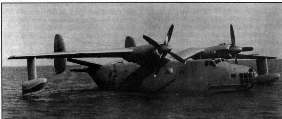
Первый опытный образец Бе-12 на плаву. На крышках ниш основных стоек шасси видны выколотки, отсутствовавшие на всех последующих экземплярах
