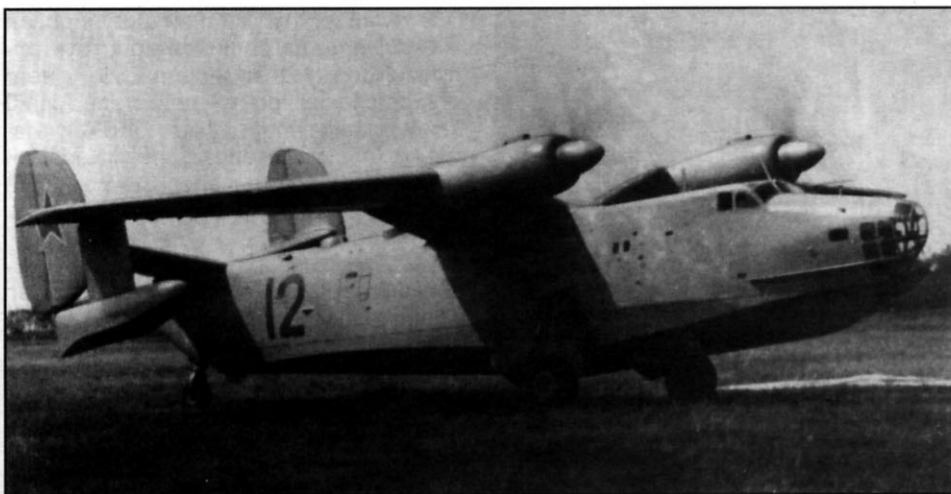
Первый опытный образец амфибии Бе-12 на заводском аэродроме в Таганроге. Хорошо видны установленные под крылом двигателя, палубная пушечная установка и полностью застеклённый нос лодки
