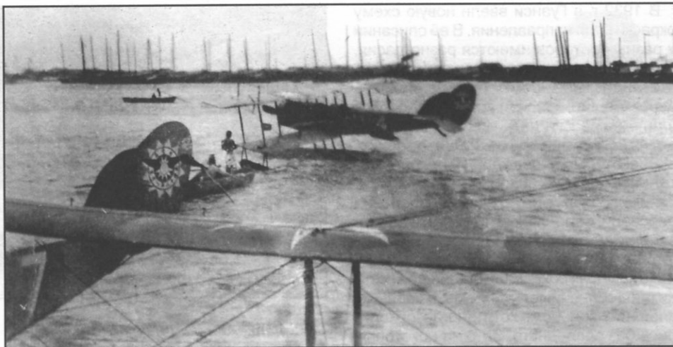
Гидросамолёты Кертис N-9C на плаву. Самолёты несут бортовые номера «7» и «14». Обратите внимание на эмблему на руле направления
