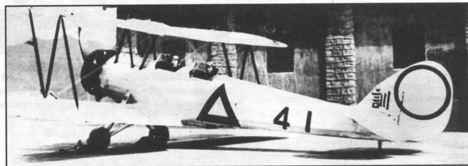
Самолёт Аэро 631 авиации провинции Гуанси. Треугольники, видимо, на обоих бортах фюзеляжа, а китайское «солнце» – на вертикальном оперении. Иероглиф на киле означает «учебный»
