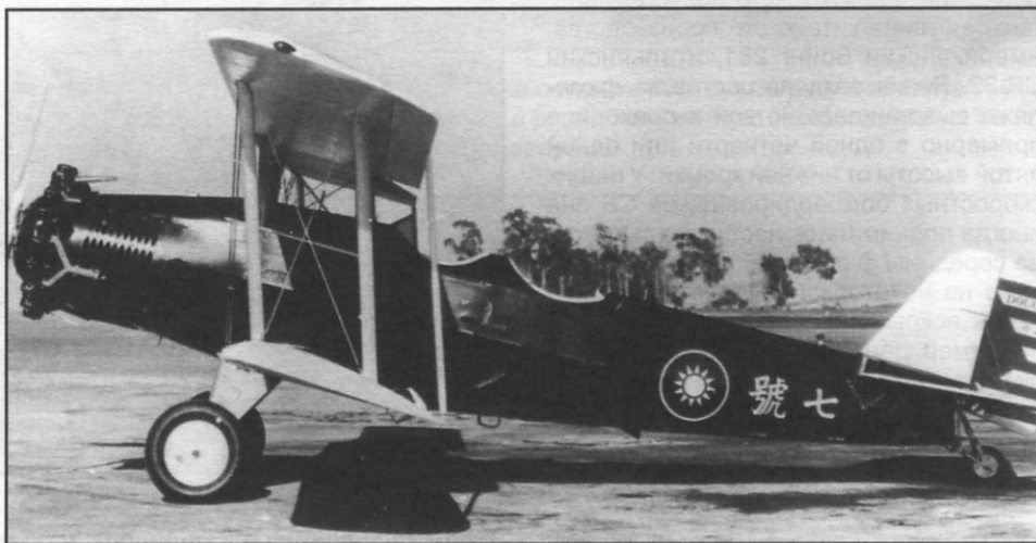
Разведчик O2MC в явном «антикамуфляже» по американскому образцу: фюзеляж тёмный, крылья, оперение и шасси, видимо, ярко-жёлтые. На верхних белых полосах «зебры» на руле направления написано обозначение типа машины. Иероглифы на фюзеляже означают «№ 7»
