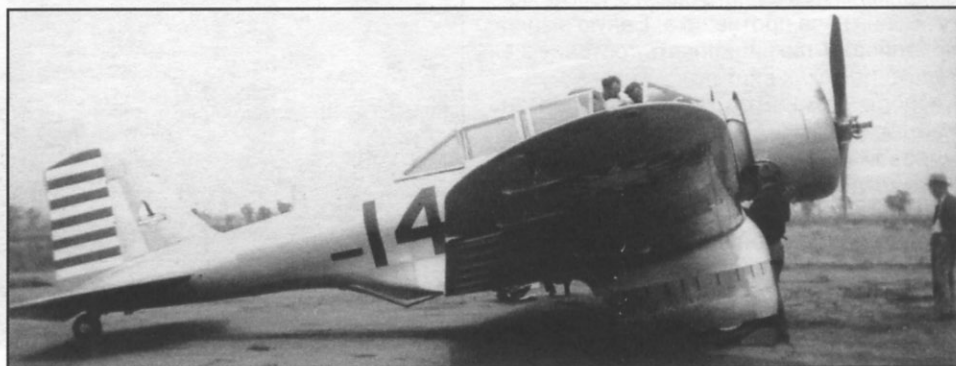
Штурмовик Нортроп 2Е в оригинальной заводской окраске. Собственно, никакой окраски нет — машина покрыта бесцветным лаком поверх алюминиевого листа. На киле — эмблема компании «Нортроп»
