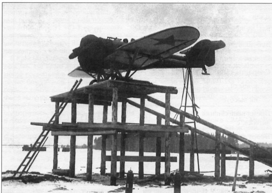
▲ Серийный И-3ЕТ во время наземных стрельб из ДРП. Самолёт окрашен по тогдашним нормам ВВС РККА: верх и бока зелёные, низ – светло-серый
