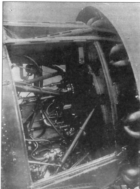
Мотостановка И-ЗЕТ со снятыми боковыми крышками капота
