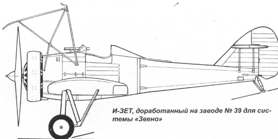
Трапеция для подвески истребителя под ТБ-3, 1935 г.
