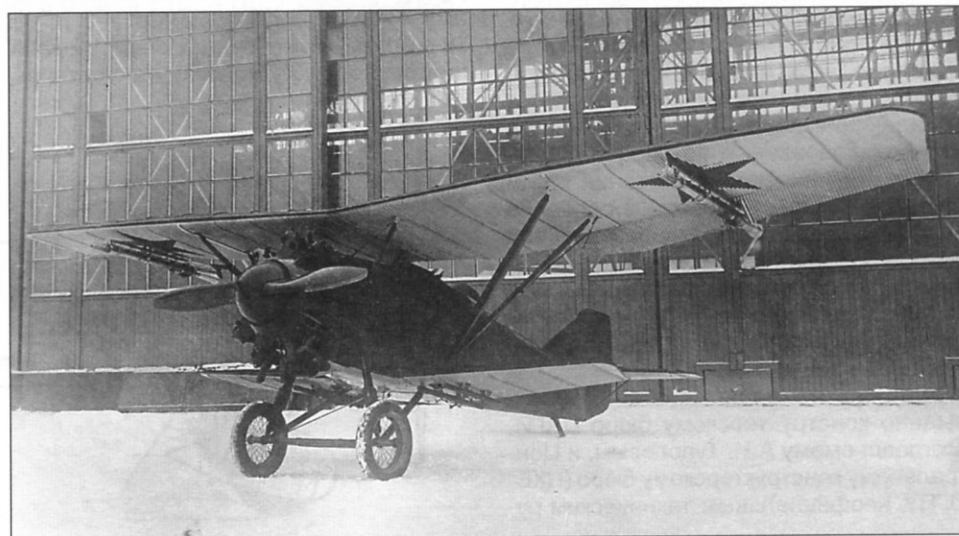
▲ Динамореактивная пушка на разведчике Р-3ЛД
