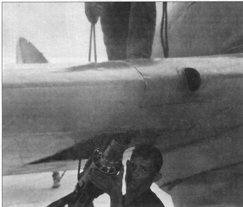
Монтаж пушки ШВАК в крыло ИП-1
