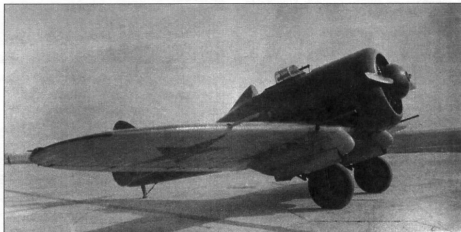
ИП-1 № 135005 с двумя пушками ШВАК, 1936 г.
