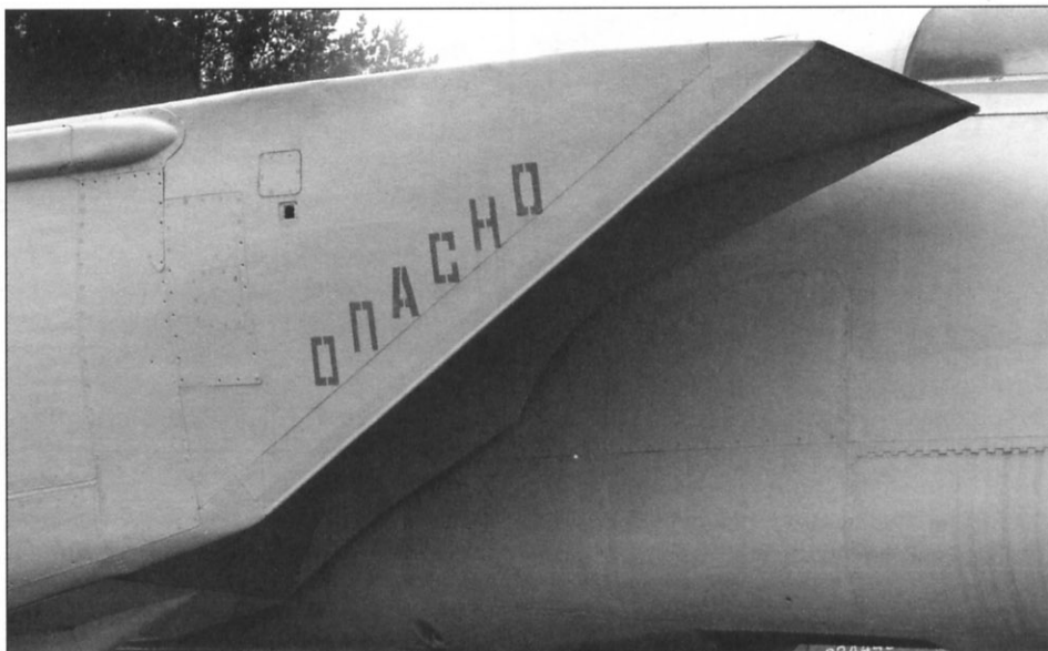
Воздухозаборное устройство самолёта МиГ-25
