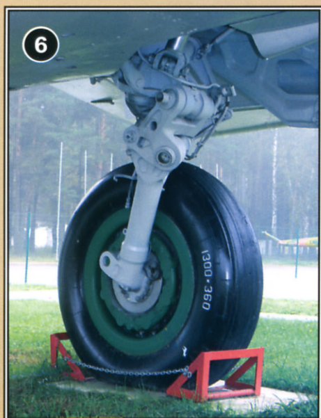
1 — фонарь кабины лётчика-инструктора; 2 — носовая опора шасси; 3 — хвостовое оперение; 4 — пилоны подвески макетов ракет; 5 — подфюзеляжные гребни; 6 — основная опора шасси
