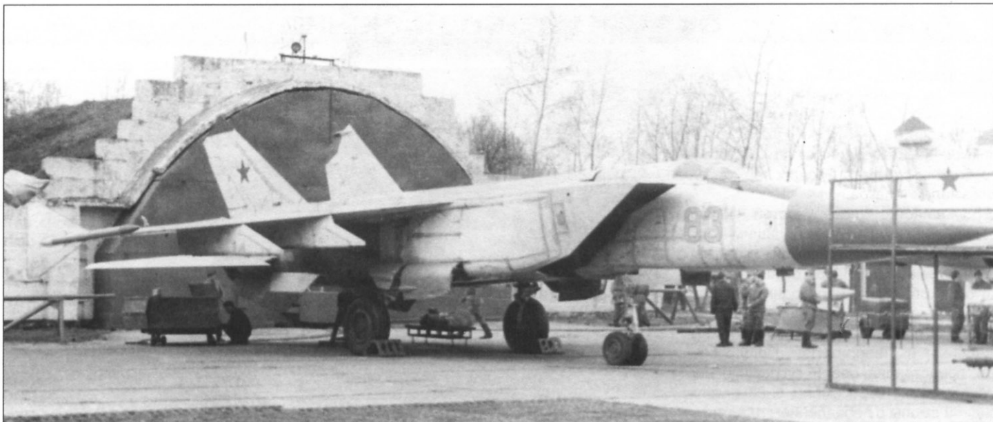
На носовой части этого опытного образца МиГ-25П видны чёрная полоса перед козырьком кабины и зелёный обтекатель РЛС
