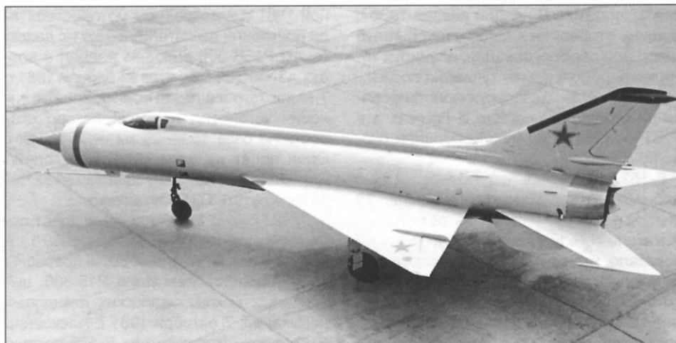
Е-152А с двумя двигателями Р11Ф-300 — летающая лаборатория для отработки самолёта и его систем
