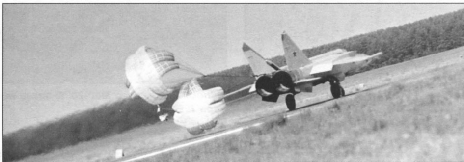
Пробег МиГ-25РБ с использованием тормозных парашютов, выпущенных до касания колёс ВПП
