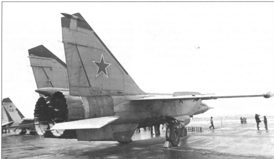
МиГ-25РБ на аэродроме в Липецке. Под крылом видны ухваты для авиабомб. Фото Д. Гринюка
