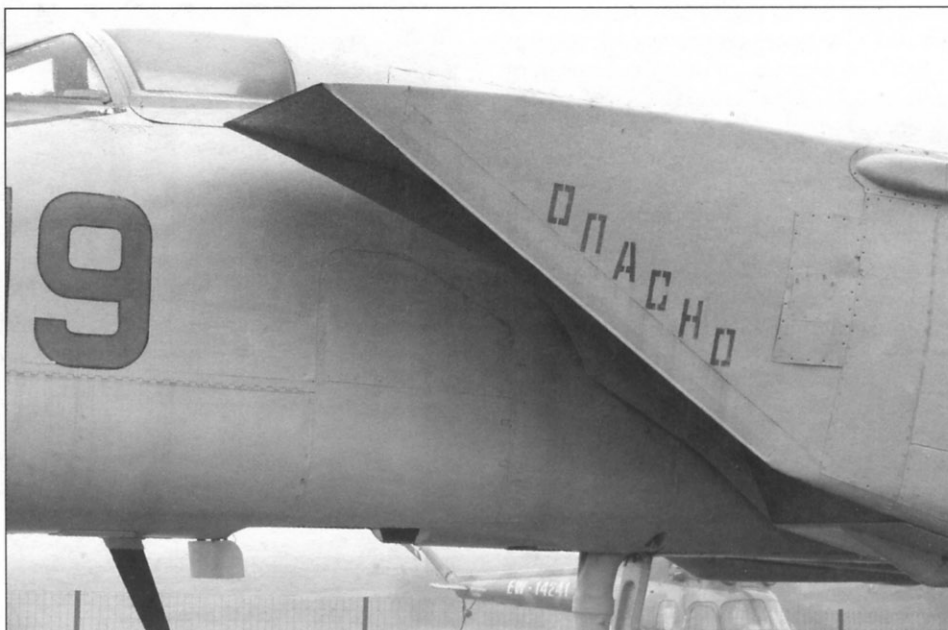
Надпись «Опасно» у передней кромки воздухозаборника двигателя
