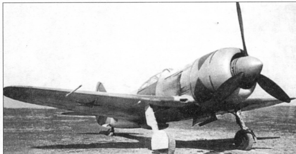
Ла-7 с 18-цилиндровым мотором АШ-71, 1944 г.
