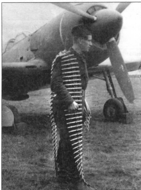
Оружейник с лентой на 100 патронов, укладывавшейся в патронный ящик Ла-7 для каждой пушки ИС-23С за две-три минуты
