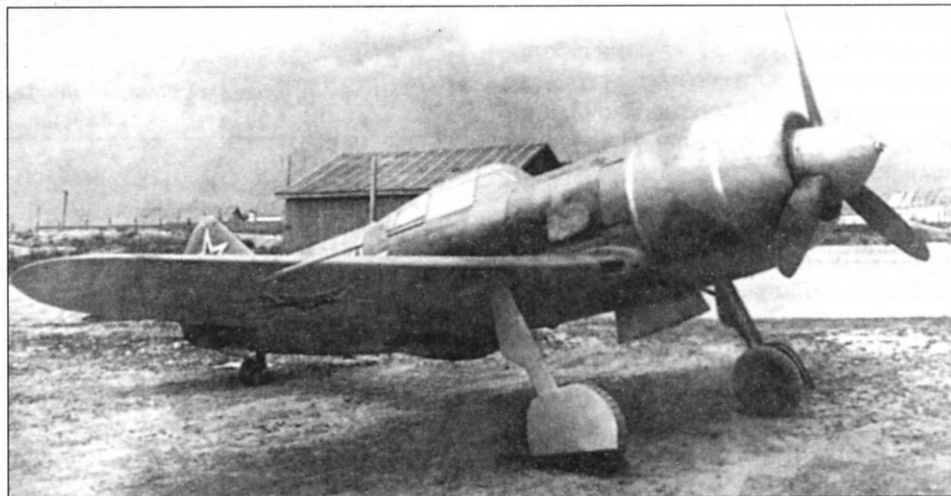
Ла-7 с двумя турбокомпрессорами ТК-3, 1944 г.
