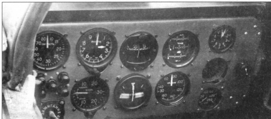
Приборная доска в задней кабине Ла-7УТИ
