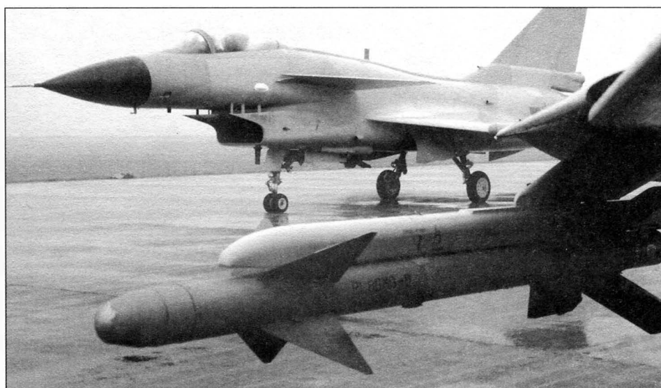
Управляемая ракета PL-8 класса «воздух—воздух» на подкрыльном пилоне
