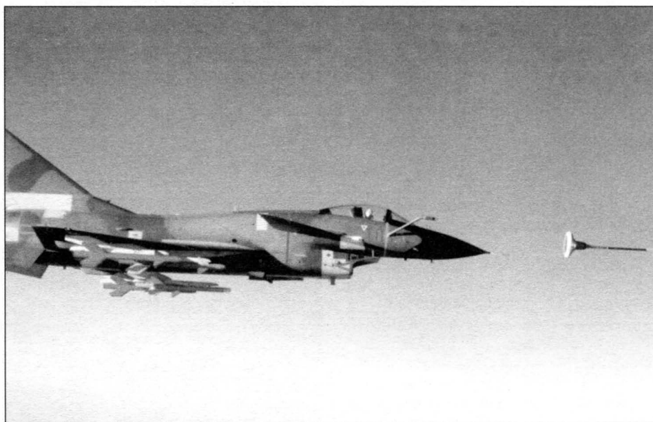
Шестой экземпляр J-10 выполняет стыковку с конусом на шланге заправщика
