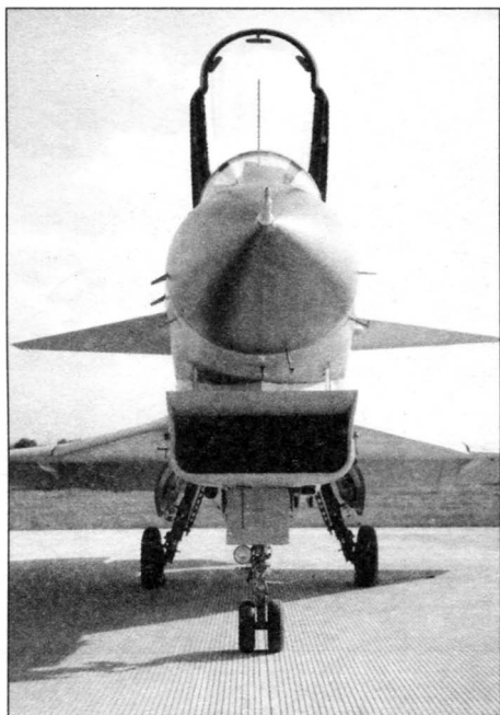
Носовая часть фюзеляжа и воздухозаборник J-10A
