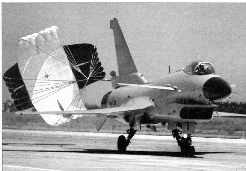
Посадка J-10A с применением тормозного парашюта
