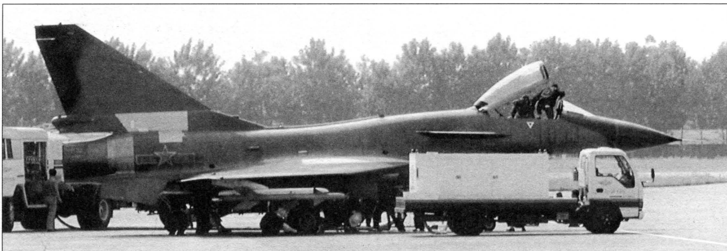
Третий экземпляр J-10 («10-03») с изменённым хвостовым оперением
