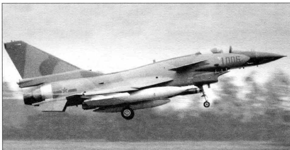
Шестой опытный образец J-10 («10-06») в своём первоначальном виде, без штанги топливозаправки
