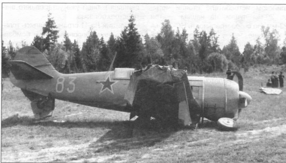
Истребитель, улетевший в Швецию, имеет типичную для Ла-11 окраску: весь светло-серый, тяжёлые ленты капота — не крашенные, на капоте надпись «Ла-11», традиционная для машин выпуска завода №21. Красные звёзды и бортовой номер — на обычных местах
