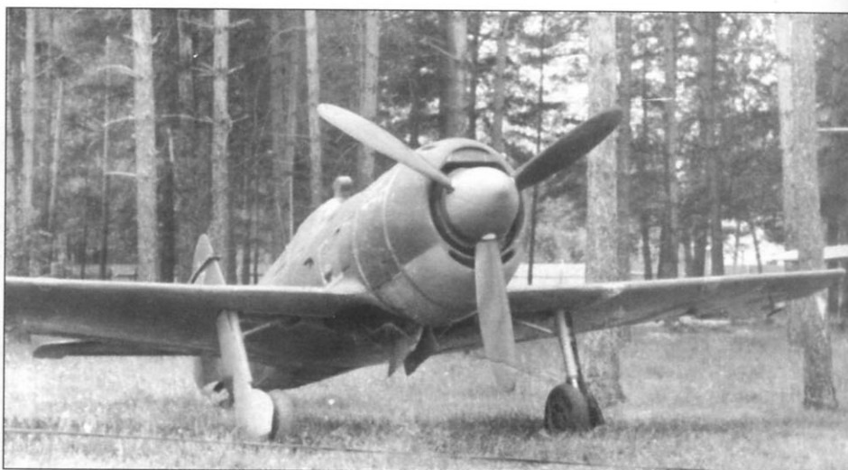
На этом Ла-11 одной из последних серий хорошо видны фотокинопулемёт С-13 на козырьке кабины и одна из двух антенн радиовысотомера РВ-2 под левым крылом
