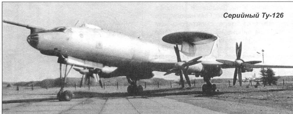
Носовая часть серийного Ту-126 со штангой топливоприёмника
