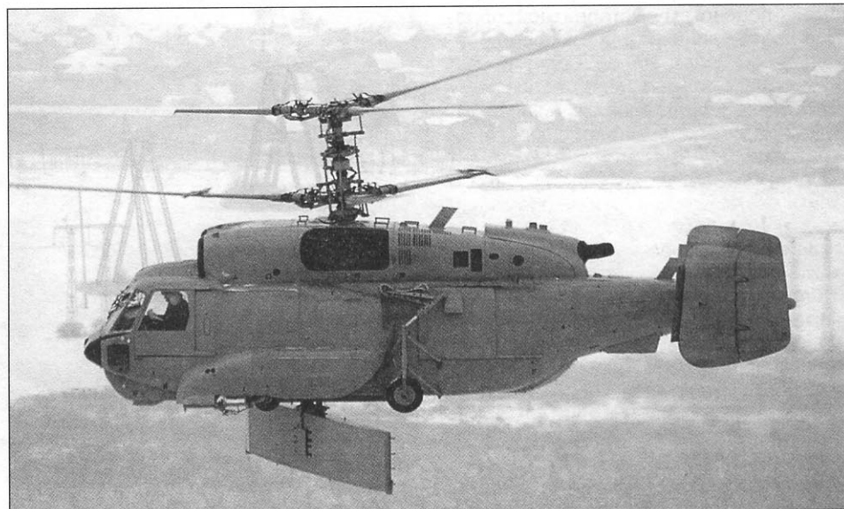
Опытный образец вертолёта Ка-31 в полёте с антенной РЛС в рабочем положении
