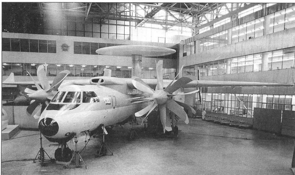
Полноразмерный макет Як-44Э с ТВВД Д-27
