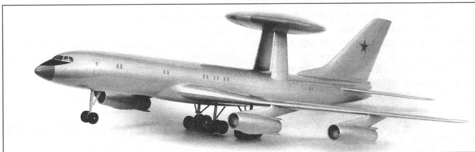
Макет самолёта ДРЛО Ту-156. Хорошо видна третья основная опора шасси под фюзеляжем
