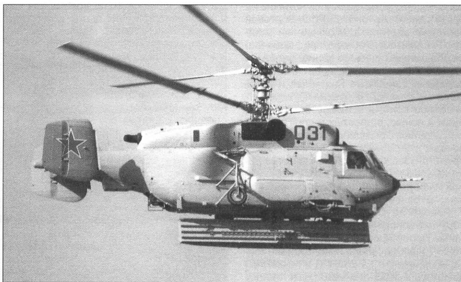
Первый опытный образец Ka-31 в процессе перевода антенны РЛС из походного в рабочее положение
