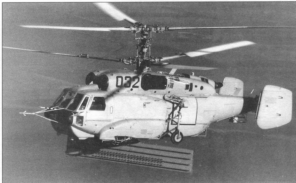
Второй экземпляр Ка-31 с выпущенной антенной РЛС
