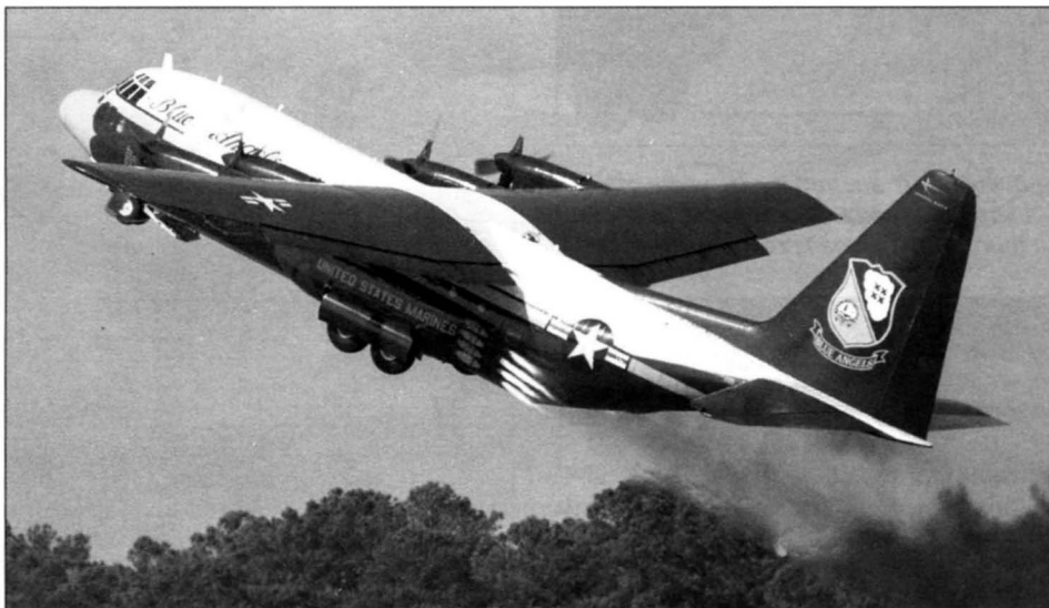
LC-130F пилотажной группы «Блю энджелс» демонстрирует взлёт со стартовыми ускорителями
