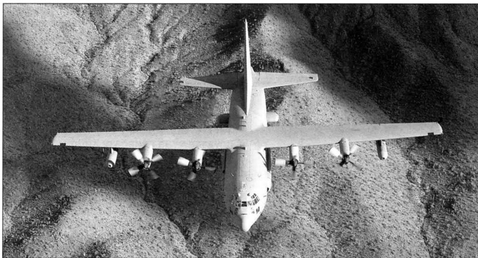
EC-130H «Компас Кол». Хорошо видны дополнительные антенны на фюзеляже
