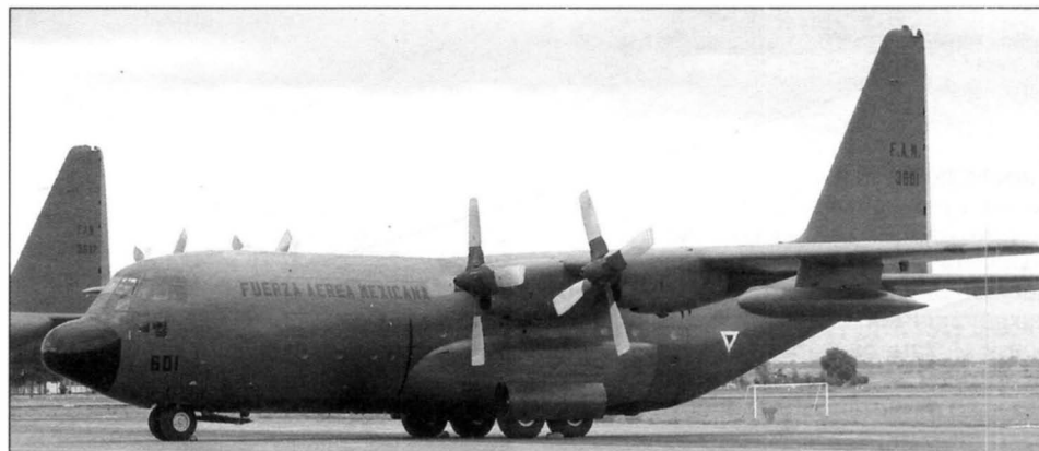
С-130А мексиканских ВВС, укомплектованный двигателями с четырехлопастными винтами
