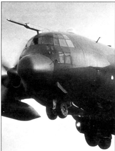
Над кабиной английского «Геркулеса» С.1 хорошо видна штанга для дозаправки топливом в воздухе
