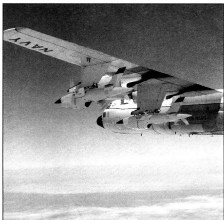
БПЛА «Файербри» под крылом DC-130E
