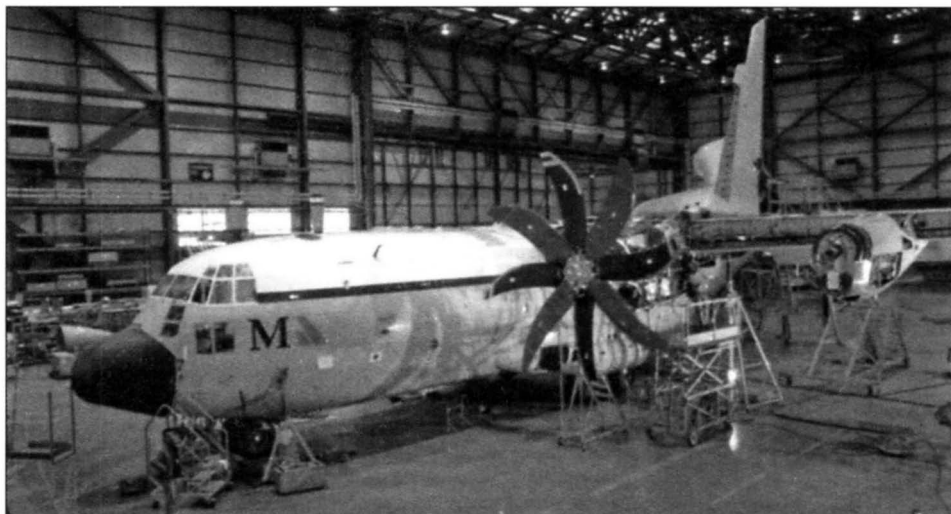
«Геркулес» W.2 в процессе переделки в летающий стенд для испытания ТВД TP400-D6
