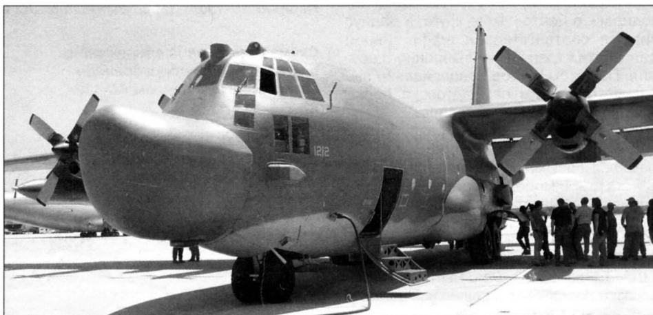
MC-130H с демонтированной «вилкой Фултона»
