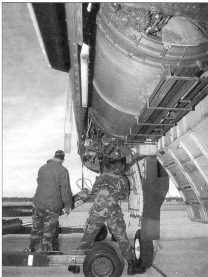
Наземный состав подсоединяет к самолету устройство для заполнения контейнера патронами
