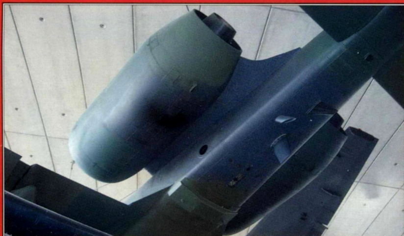
Вид на мотогондолы, выходное устройство ВСУ и подфюзеляжные антенны
