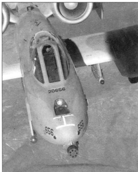
Носовая часть фюзеляжа А-10А. Под крышкой перед козырьком фонаря — штанга для дозаправки в воздухе
