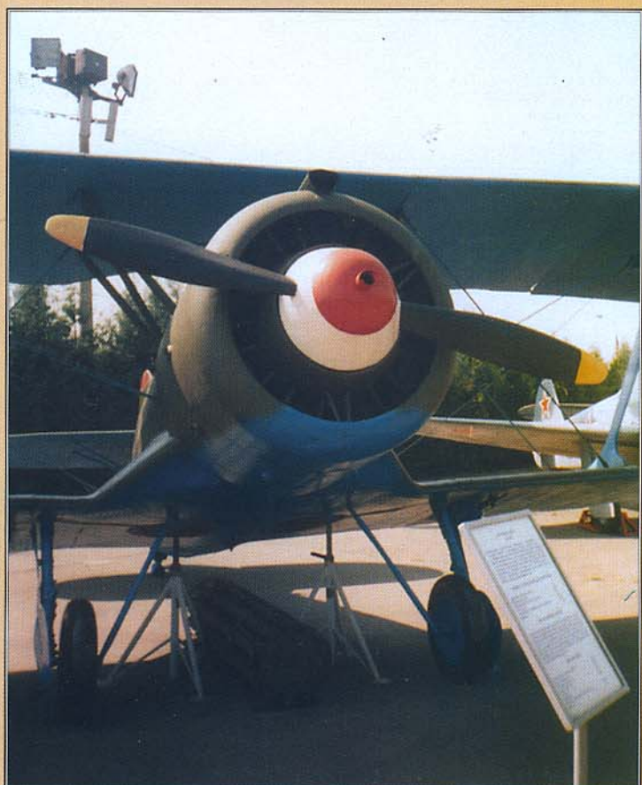
Капот мотора и винт; на коке последнего виден храповик для запуска двигателя автостартером
