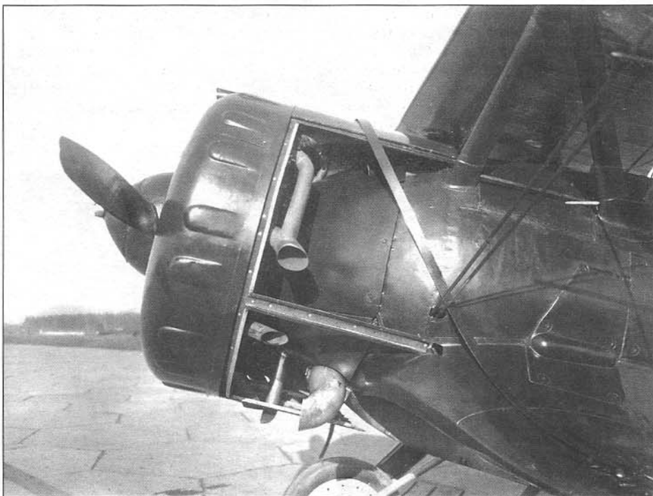
Мотоустановка серийного истребителя в частично раскапотированном виде; обратите внимание на выштаповки под качалки клапанов двигателя
