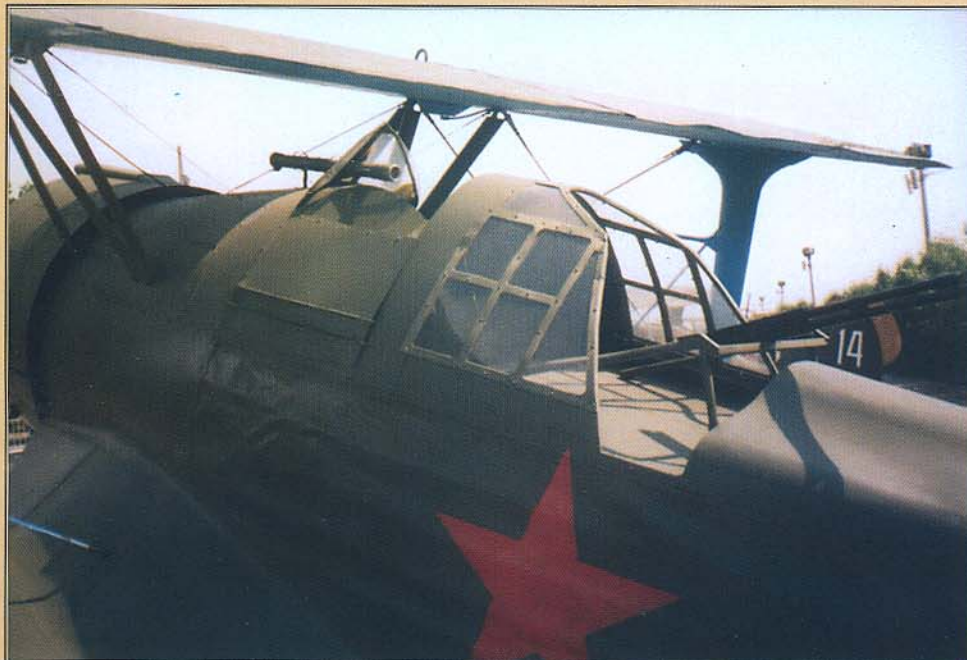
Кабины пилота и стрелка; приборные доски отсутствуют, кабина стрелка зашита фанерой, у пулемета ШКАС смонтирован только ствол
