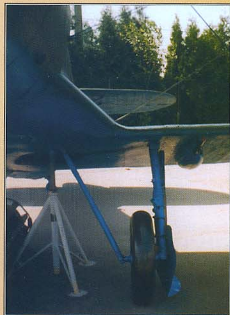
Левая стойка шасси; ниши под колеса просто нарисованы черной краской на нижней поверхности центроплана
