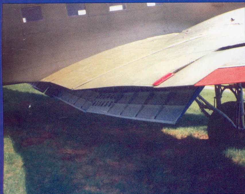
Посадочные щитки в выпущенном положении
