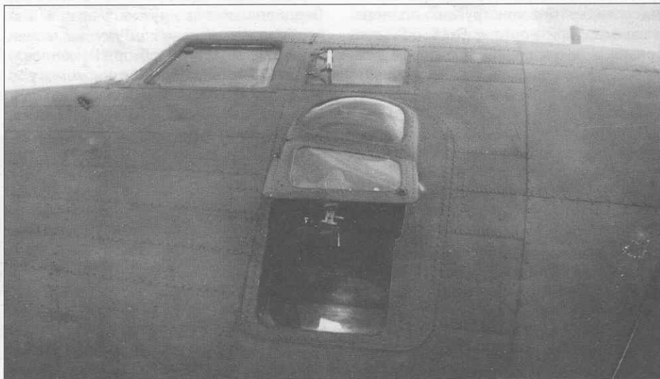
Открывающаяся створка в остекленной запасной двери
