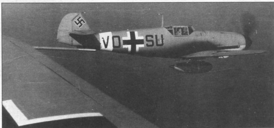
Bf 109F-4/Trop в характерной для Северной Африки окраске. Верх самолета покрыт эмалью цвета RLM 79 (песчаный)
