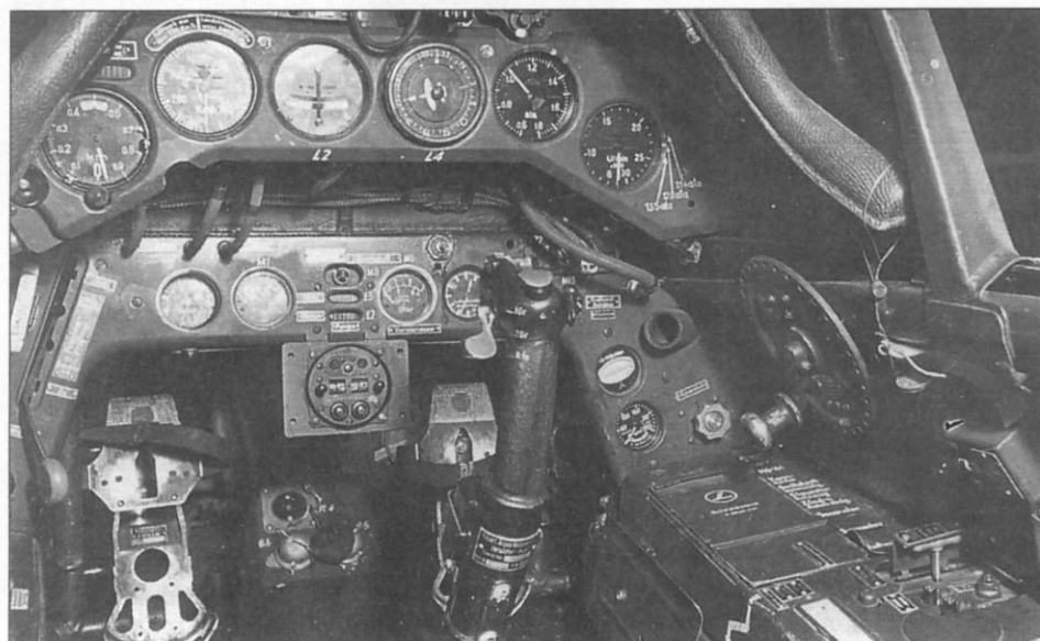
Кабина летающей подки Do 24. Все, кроме приборной доски, окрашено в светло-серый цвет (RLM 66). Приборная доска более темная (RLM 02). Подушки сидений — светло-терракотовые или серые
