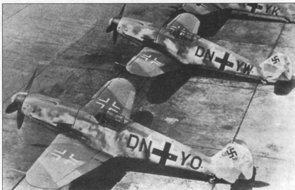
Новенькие истребители Bf 109G-1 на заводском аэродроме. На самолеты нанесены знаки четырехбуквенного кода, которые будут закрашены после прибытия в часть. Окраска машин — комбинацией цветов RLM 74/75/76 с пятнами RLM 02 на бортах фюзеляжа
