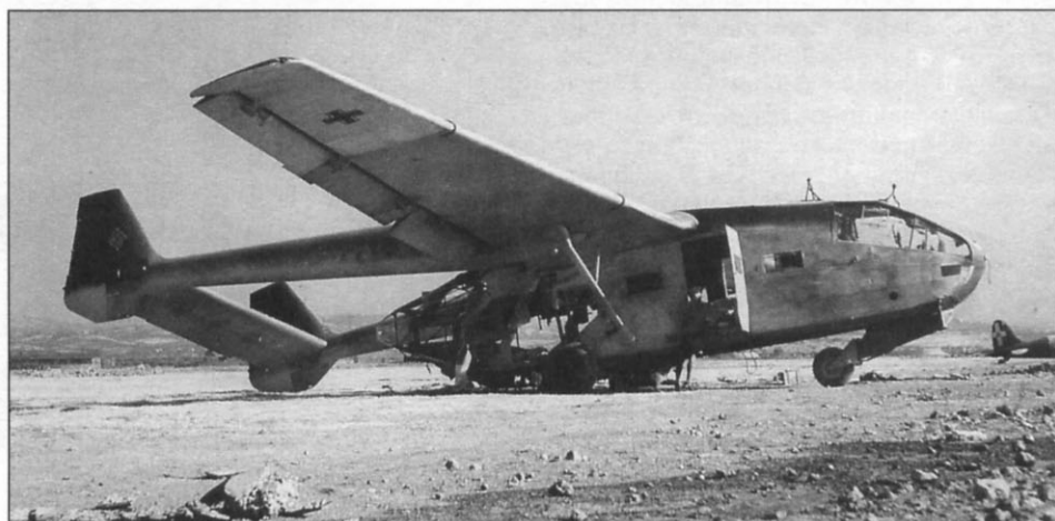
Разбитый планер Go 242 на аэродроме Катания (о. Сицилия). Машина несет камуфляж с сочетанием цветов RLM 70/71/65. Законцовки крыла — желтые; планер до этого побывал на советско-германском фронте
