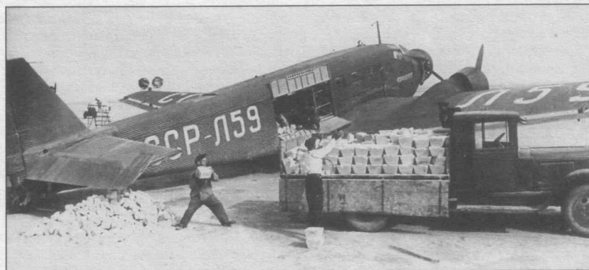
Погрузка Ju 52/3m ГВФ в Уфе, 1945 г. Проем верхней стрелковой точки зашит металлом, на самолете стоит советский радиополукомпас РПК-10
