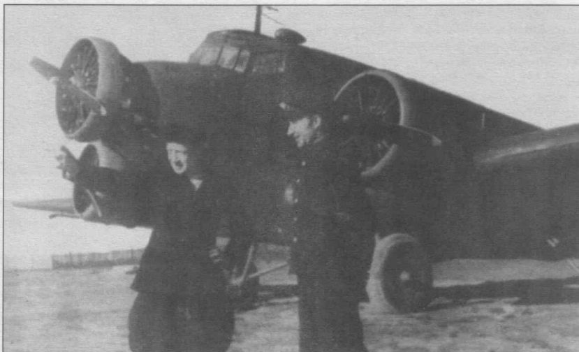
Самолет авиации МВД, приданный Ухтаккомбинату. Обратите внимание на защитный проем, оставшийся от «гнезда кондора» над кабиной, и советский радиополукомпас РПК-2 в каплевидном обтекателе
