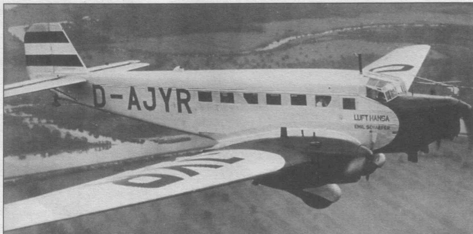
Один из двух построенных Ju 52/3mho с тремя дизелями Jumo 205, 1934 г.
