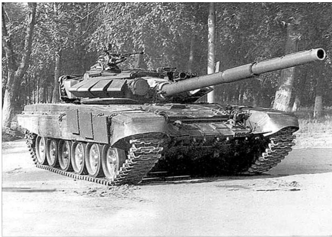
Танк Т-72Б образца 1989 года со встроенной динамической защитой.
