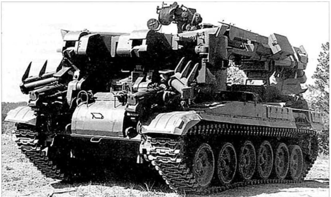
ИМР-3М. Управляемое рабочее оборудование в походном положении.
