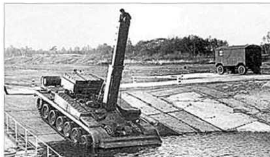
БРЭМ "объект 608" с установленной трубой-лазом преодолевают водную преграду.
