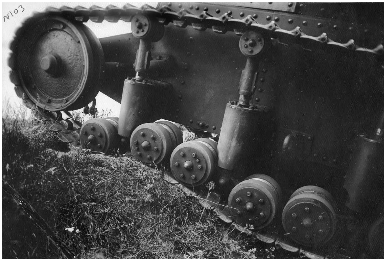
Фото ходовой части танка Т-12. Июль 1930 года. Хорошо видна конструкция тележек подвески, опорных катков и ленивца (АСКМ).
