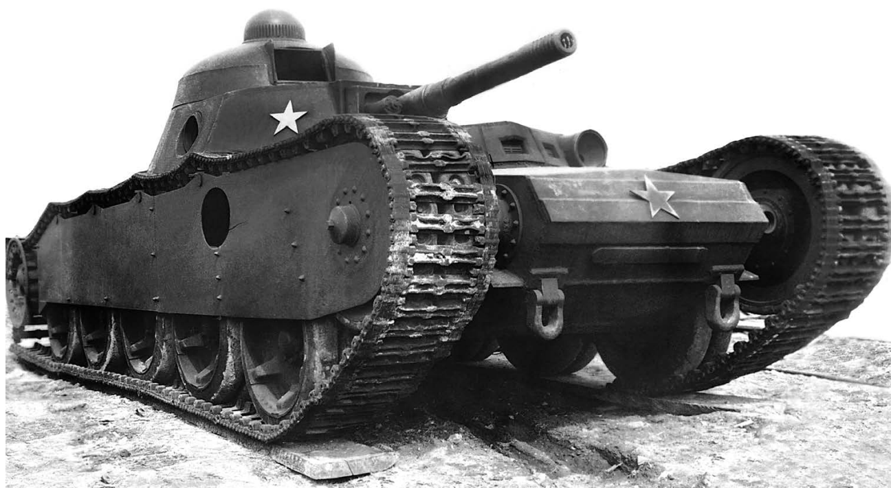
Общий вид танка ТГ в учебном парке Военной академии механизации и моторизации, предположительно 1939–40 год. Все вооружение, за исключением 76-мм орудия, демонтировано (АСКМ).
