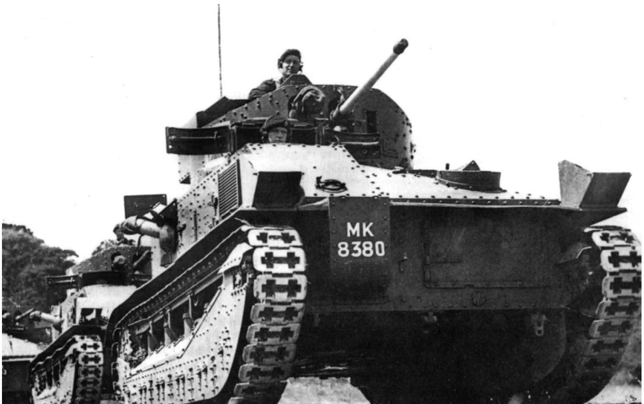
Танки МК-I (верху) и МК-II** (внизу) на учениях английской армии. Хорошо видна разница в форме бортовых экранов защиты ходовой части и бронировке передней части корпуса.
