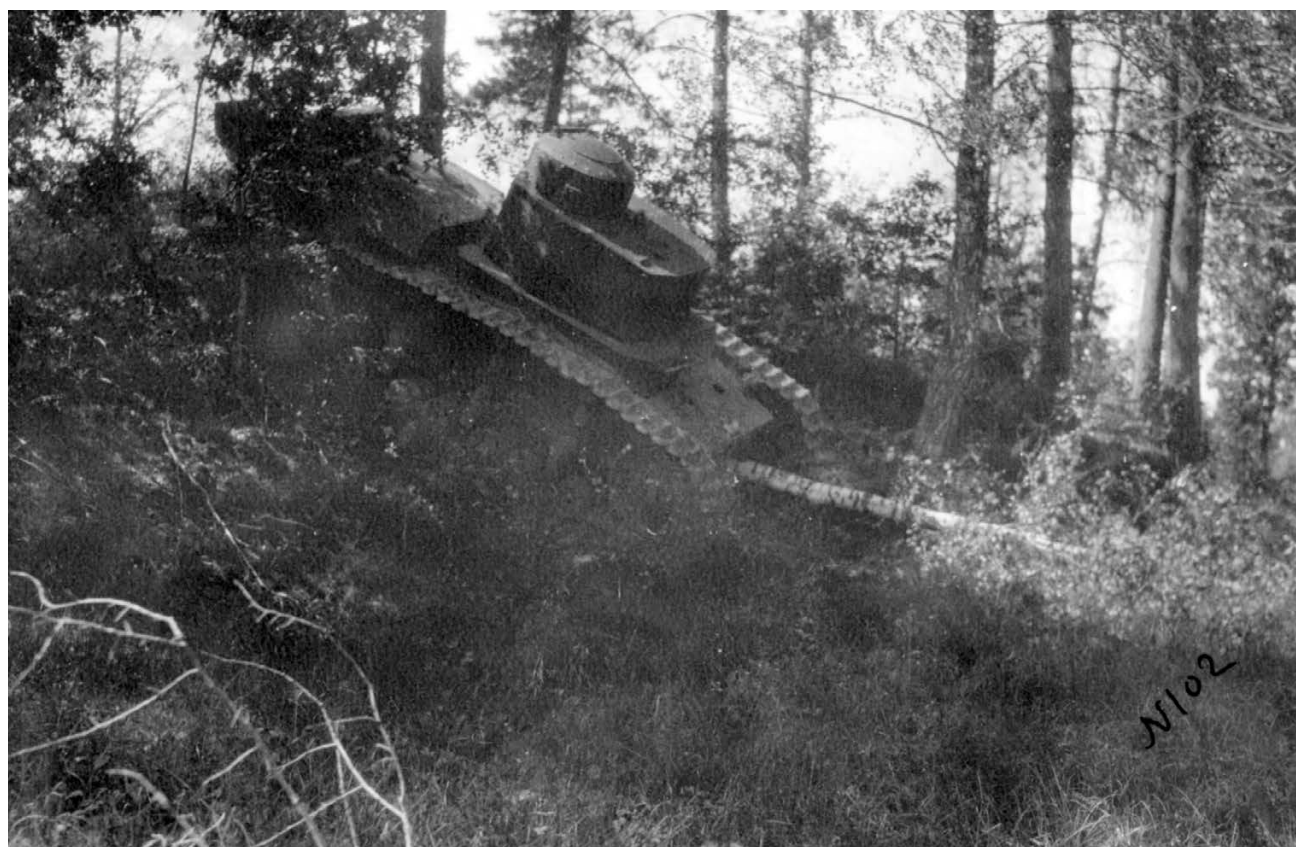
Танк Т-12 на испытаниях – машина валит дерево. Июль 1930 года. Как и предыдущий снимок, фото сделано в окрестностях Москвы (АСКМ).
