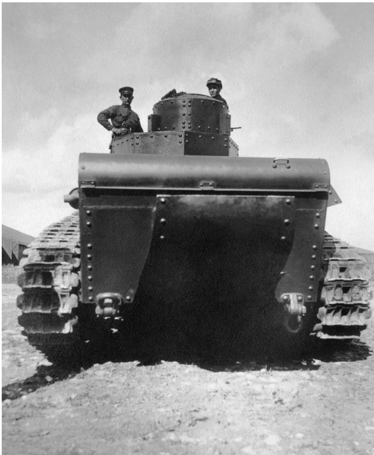
Танк Т-12 во время испытаний, вид сзади. Москва, военсклад № 37, июль 1930 года. Хорошо видна конструкция «хвоста».
