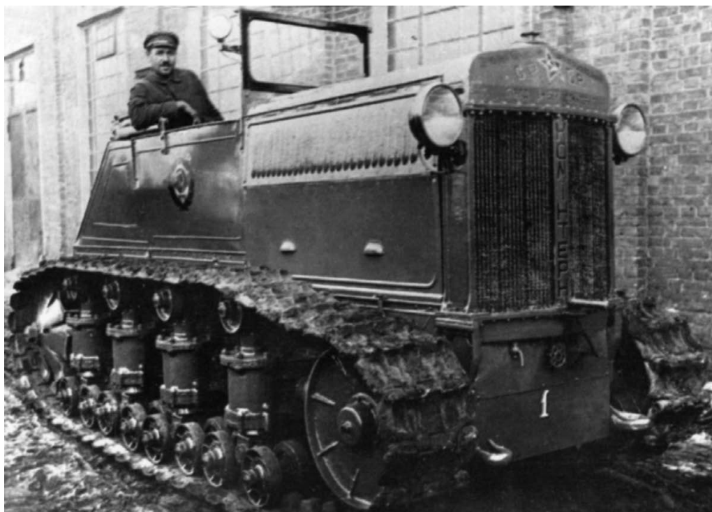
Один из первых опытных образцов трактора «Коминтерн». 1931 год. Машина еще не имеет грузовой платформы (РГАЭ).
