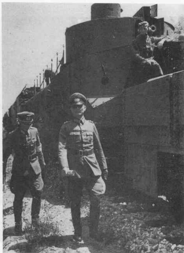
Бронепоезд номер 22. Другой артиллерийский вагон этого поезда вооружен только одним 7.5-см орудием. Обратите внимание на пулеметную бойницу на передней стенке вагона. Антенна позади башни с артиллерийским орудием свидетельствует о наличии командного вагона.
