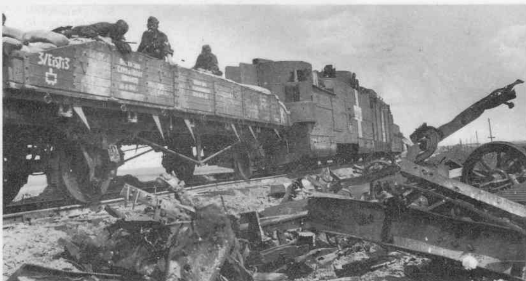
"Защищенный поезд" 3-ей роты третьего железнодорожного полка из состава Танковой Группы Клейста из Группы Армий "Юг" состоял из бронированного советского паровоза серии "О", двухбашенного советского артиллерийского вагона (одно орудие при этом отсутствовало) и трех платформ, борта которых были защищены мешками с песком, а в последней из них располагалось 3.7-см противотанковое орудие.
