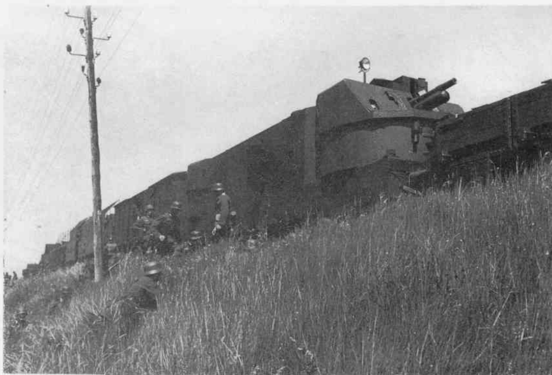
Бронепоезд номер 22, имеющий в своем составе польские вагоны, во Франции в 1942 году. Артиллерийский вагон этого бронепоезда, в котором размещались два 7.5-см орудия, имел помещение для пехоты.
