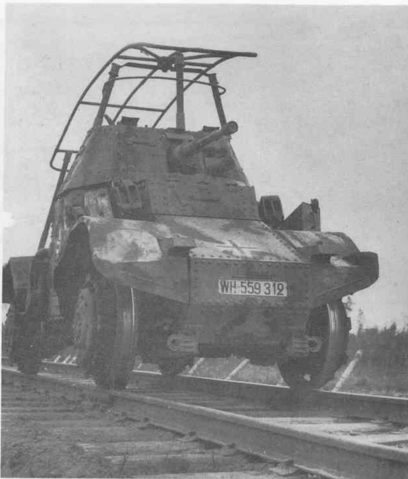
Бронеавтомобиль "Panhard", способный передвигаться по железной дороге являлся надежным средством разведки.
