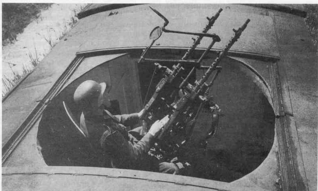
Наряду с 2-см зенитными орудиями личный состав 22-ого бронепоезда для отражения воздушных целей использовал сдвоенные пулеметы МГ-34.
