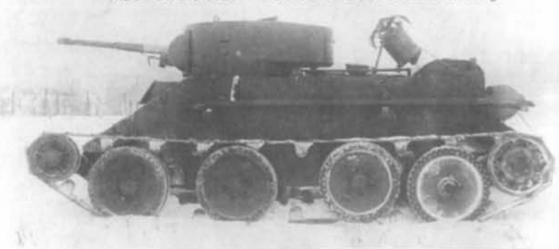
84,85. Танк БТ-5 со съемным РПП и ранний вариант приспособления РПП. The BT-5 with the RPP — the device for the barbed wire removing.
