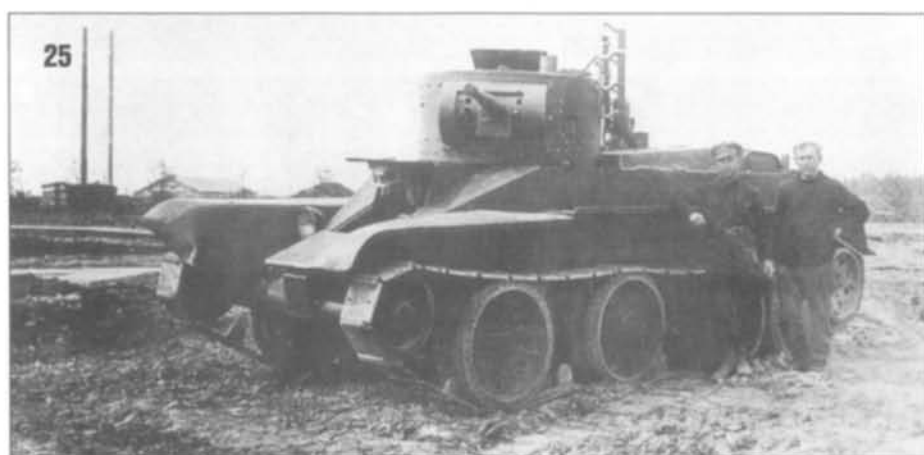
25, 26. Опытная установка 132-мм РС на танке БТ-5. На фото 25 стоят: В.И.Александров (слева) и Петров. В отделении управления — Горьнов. The experimental mounting of the 132-mm rockets on the BT-5 tank.
