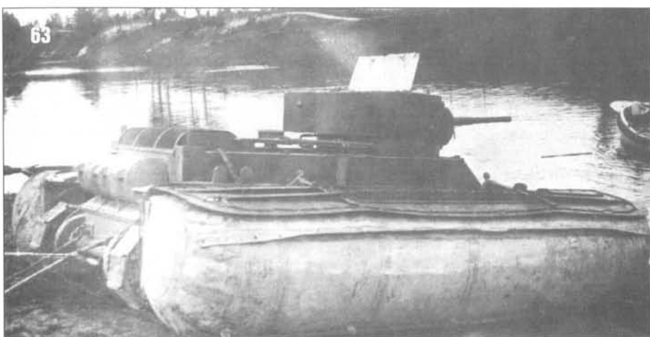
63-66. Испытания приспособления для переправы танков БТ-5 на плаву конструкции Алексеева. Весна 1936 г. Alexeev's river crossing devise. 1935. Spring 1936.
