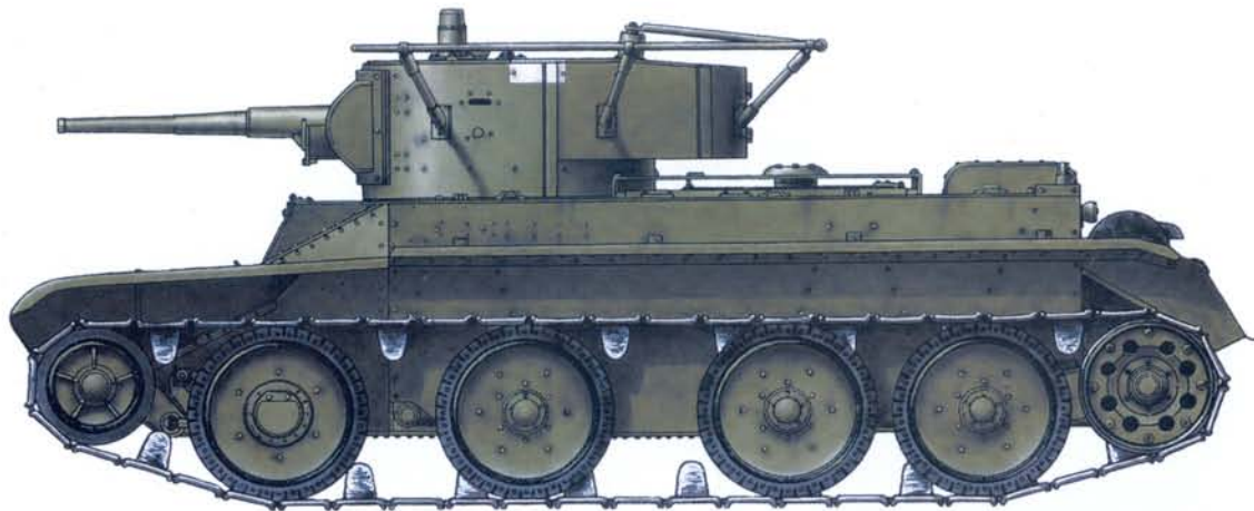
Танк БТ-5 из состава 45-го механизированного корпуса с установленной поручневой радиоантенной. Киевский особый военный округ. Маневры, 1936 г.
