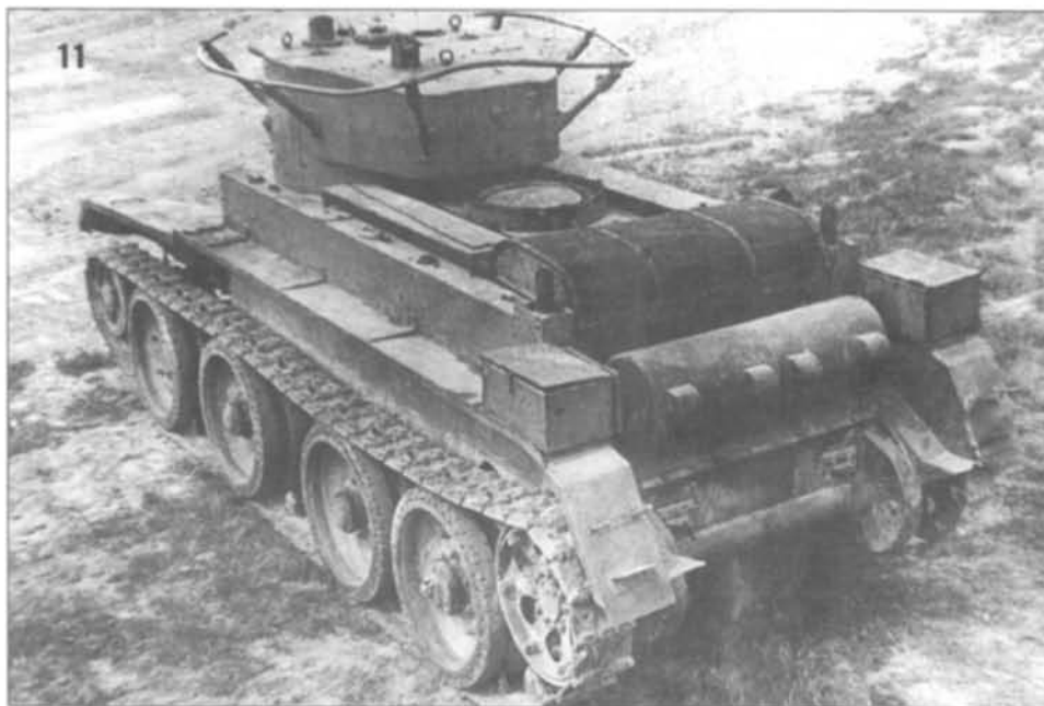
9-11. Танк БТ-5 с установленной радиостанцией 71 ТК-1 на испытаниях. Весна 1934 г. The BT-5 tank equipped with the 71 TK-1 radio under evaluations. Spring 1934.
