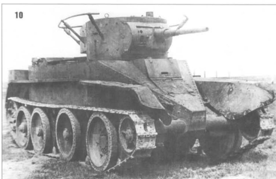
9-11. Танк БТ-5 с установленной радиостанцией 71 ТК-1 на испытаниях. Весна 1934 г. The BT-5 tank equipped with the 71 TK-1 radio under evaluations. Spring 1934.
