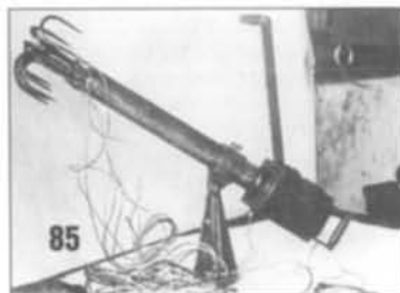
84,85. Танк БТ-5 со съемным РПП и ранний вариант приспособления РПП. The BT-5 with the RPP — the device for the barbed wire removing.
