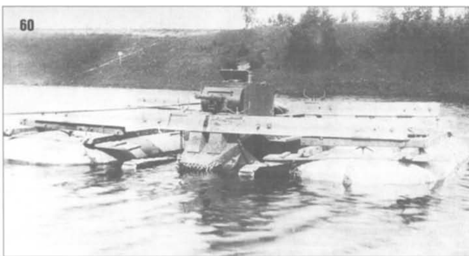
59,60. Полигонные испытания приспособления А.Ф.Кравцова. Оз. Ново-Никольское. Июль 1936 г. Kravtsov's pontoon device under evaluation. July 1936.
