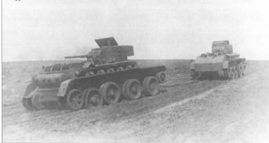
47. Танк БТ-5-ИС на испытаниях буксирует "поврежденный" БТ-5. Май 1937 г. The BT-5-IS tugs the «damaged» BT-5. May 1937.
