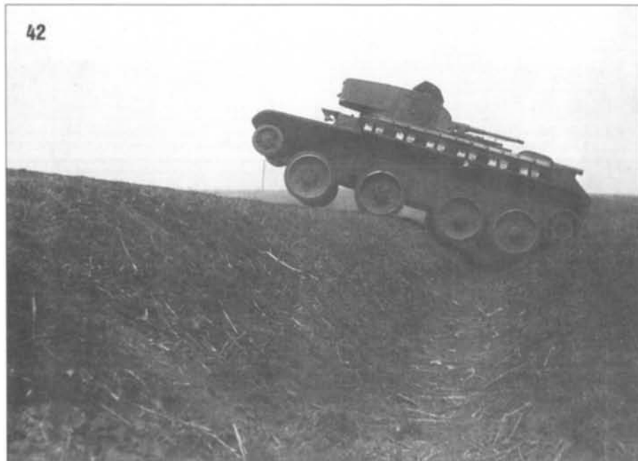
42. Танк БТ-5-ИС на испытаниях. Преодоление 2-метровой канавы. Май 1937 г. The BT-5-IS under evaluations crosses the obstacle. May 1937.
