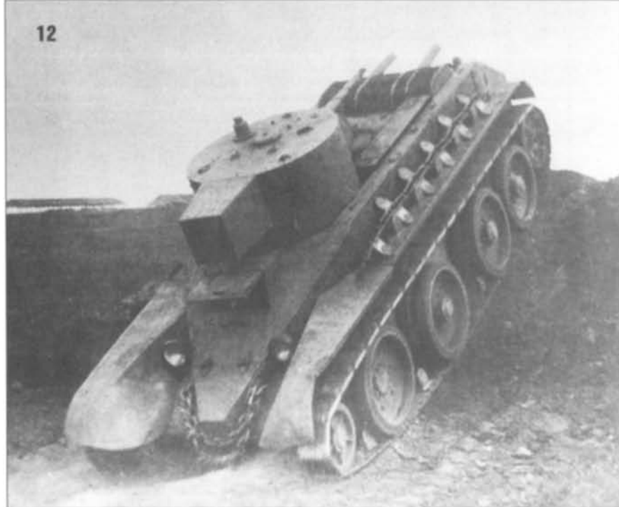
12, 13. БТ-5-ИС с цилиндрической башней. Обратите внимание на наличие только одного люка в крыше башни.
