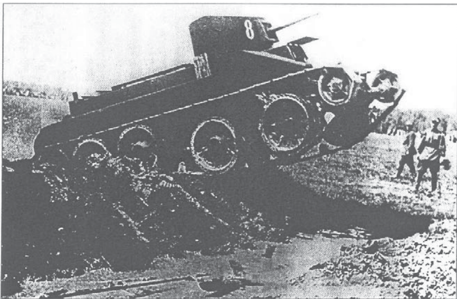
28. Серийный БТ-2 первого выпуска с пушкой Б-3 на испытаниях по преодолению препятствий. The serial BT-2 with the B-3 gun under evaluations.
