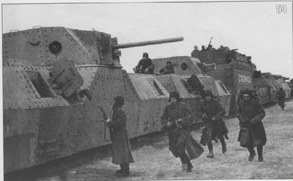
54. Команда бронепоезда № 642 «Сталинец» 32-го ОДБП по тревоге занимает места в бронеплощадках. Действующая Армия, осень 1944 года. Площадка на переднем плане перевооружена 76-мм танковой пушкой Ф-34 (РГАКФД).
