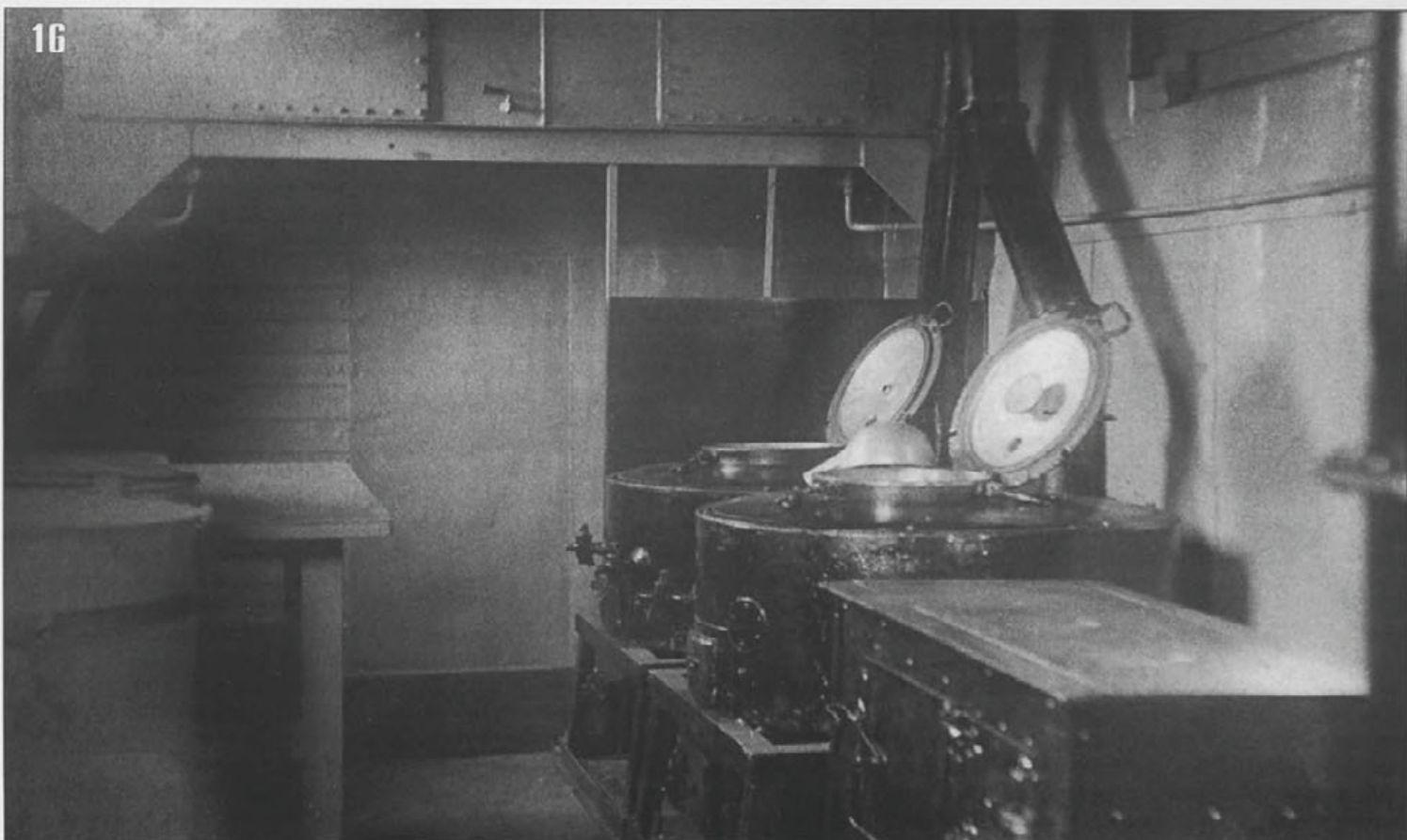
16. Внутренний вид вагона-кухни из состава базы отдельного дивизиона бронепоездов: видна плита и два котла для варки пищи (АСКМ).
