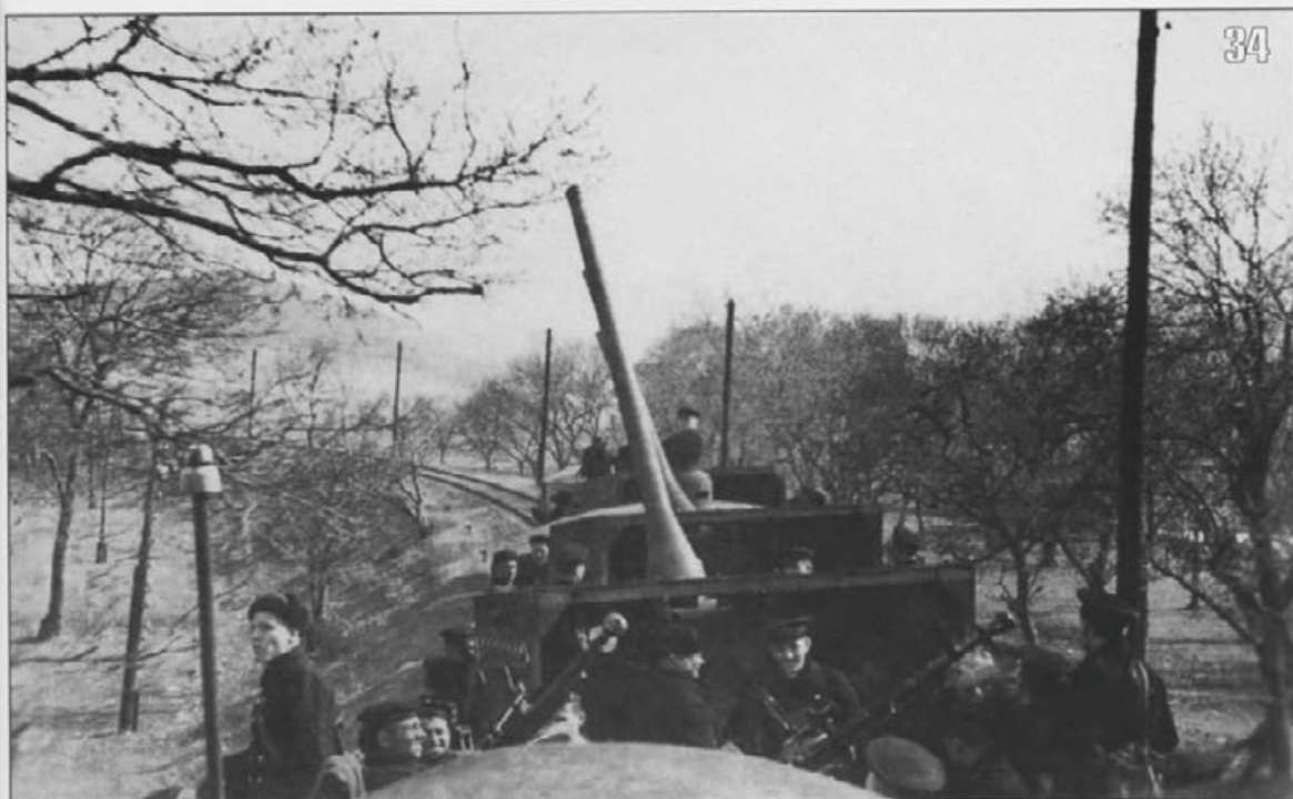
34. Бронепоезд «Железняков» готов вести огонь по немецким самолетам. Севастополь, май 1942 года. 76-мм пушки на максимальном угле возвышения, слева видна штанга для телеграфного провода. Снимок сделан с дальномерного поста (АСКМ).
