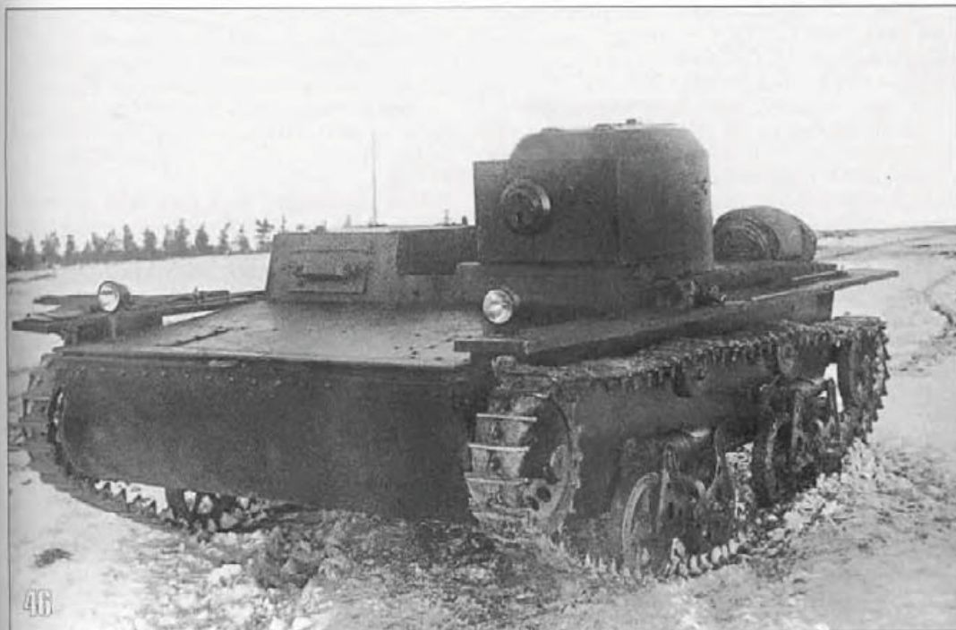
46. Танк Т-38 выпуска 1937 года на полигоне. Смотровая щель механика-водителя уже имеет дополнительную защитную планку. Хорошо видна укладка ЗИП — лопаты, лома, домкрата, брезента (АСКМ).
