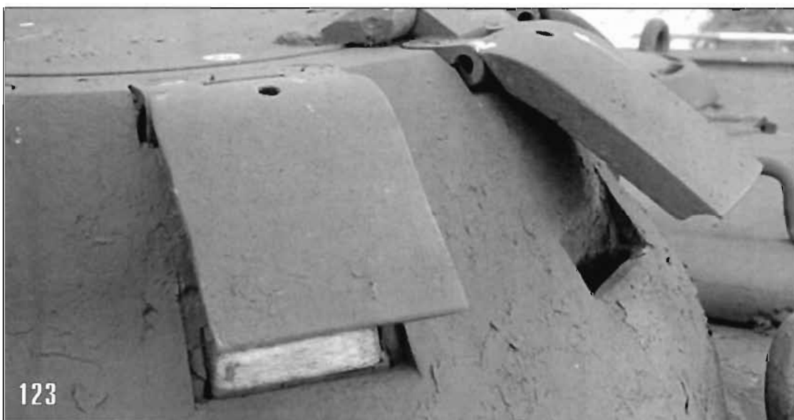
123. Смотровой прибор с защитной броневой крышкой командирской башенки (АА).
