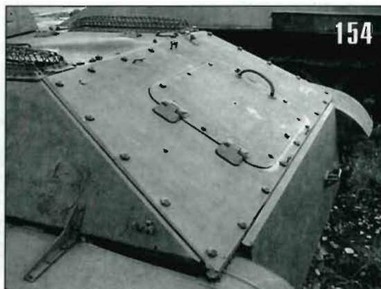
153, 154. Вид задней части крыши корпуса – крыши трансмиссионного отделения. Хорошо виден люк для доступа к агрегатам трансмиссии танка, закрытый откидной броневой крышкой, закрепленной болтами (АА).
