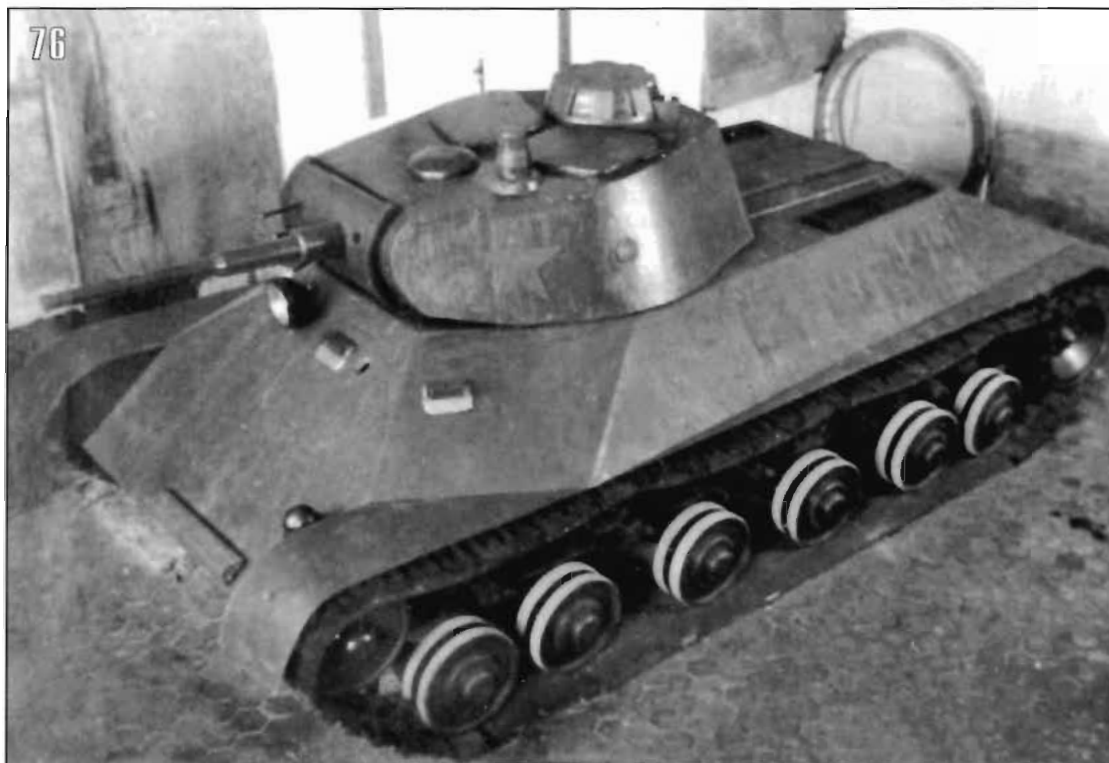
76. Деревянный макет танка Т-50 завода № 174. Фото из архива автора.
