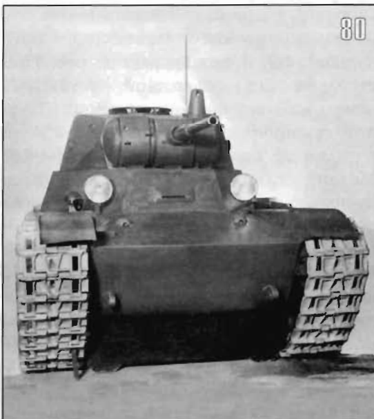
80-82. Деревянный макет танка Т-50 ЛКЗ (АА).
