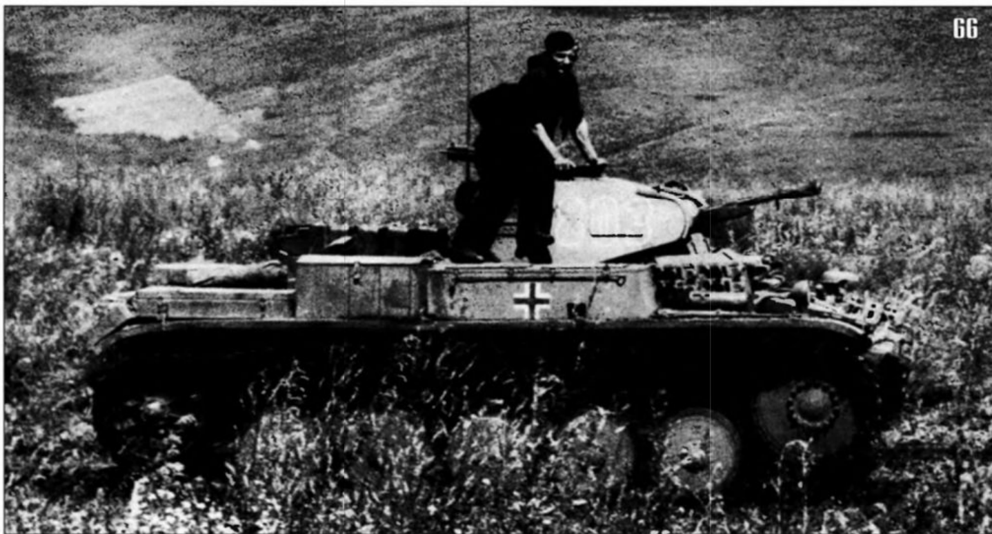
66. Танк Pz.II Ausf.A-C, прошедший модернизацию — с дополнительным бронированием передней части корпуса, командирской башенкой и большим ящиком на правом борту от Pz.II Ausf.F.
