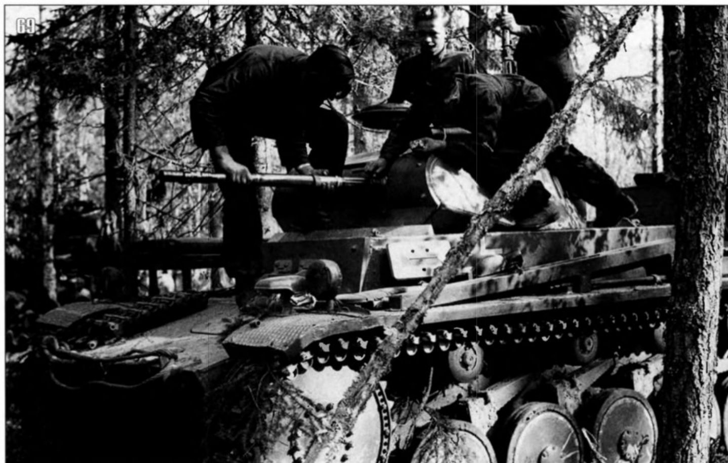
69. Смена ствола 20-мм пушки KwK 30 танка Pz.II Ausf.C. Карелия, июль 1941 года.
