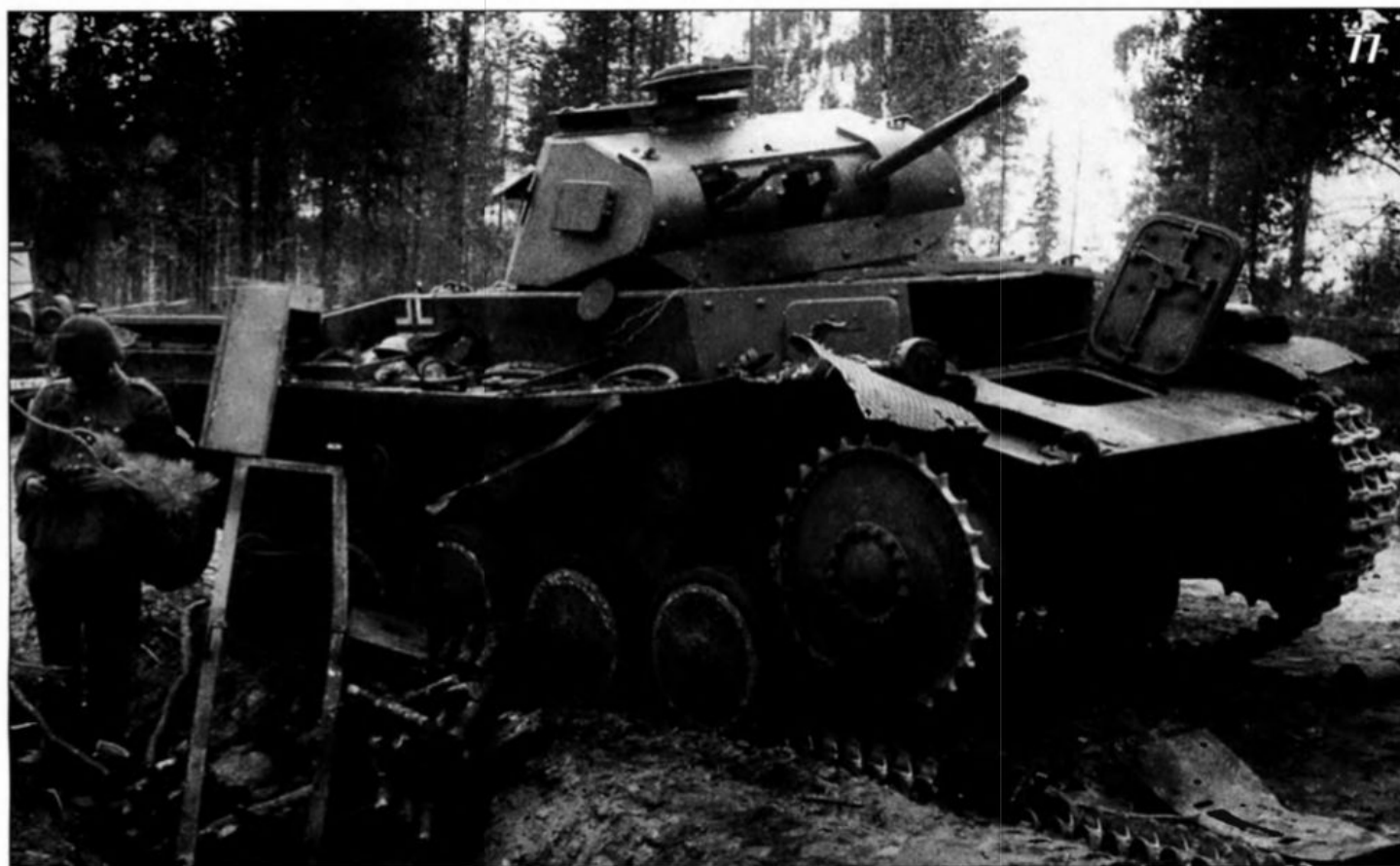
77. Танк Pz.II Ausf.C, подбитый огнем 76-мм орудия. Карелия, июль 1941 года. Хорошо видна снарядная пробоина в лобовом листе башни между пушкой и пулеметом. Видимо, от этого снаряда сдетонировал боекомплект.
