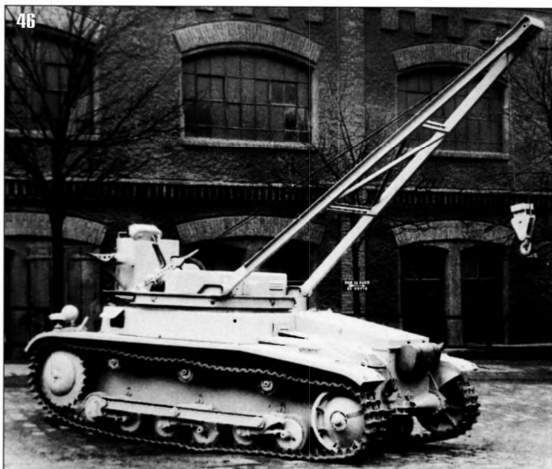
46, 47. Ремонтная машина на шасси танка Pz.II Ausf.b, вид слева и со стрелой, развернутой назад.
