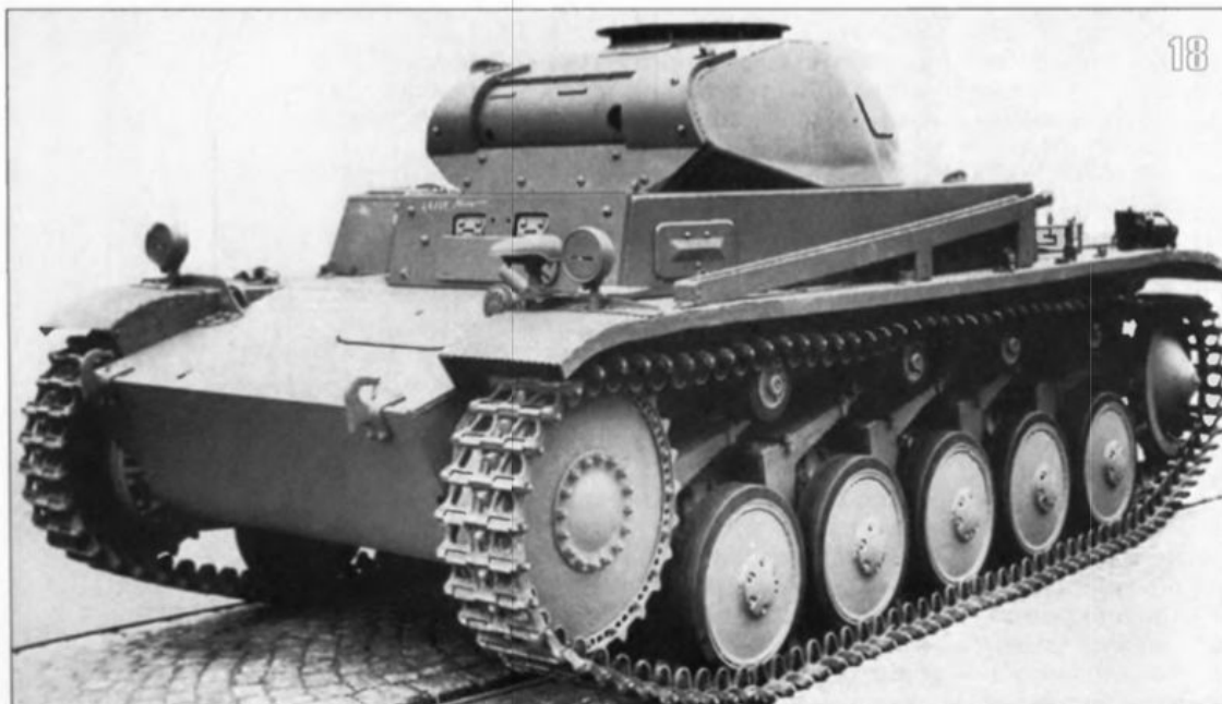
18. Легкий танк Pz.II Ausf.C, прошедший модернизацию – машина имеет дополнительное бронирование передней части корпуса и командирскую башенку на башне. Вооружение не установлено.
