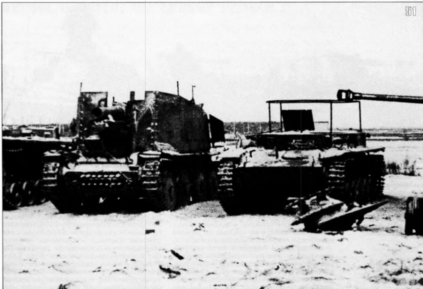
51, 52. Инженерный танк на шасси Pz.II Ausf.A-C, захваченный частями Белорусского фронта в декабре 1943 года. Хорошо видны металлические дуги для установки брезентовой «кабины».
