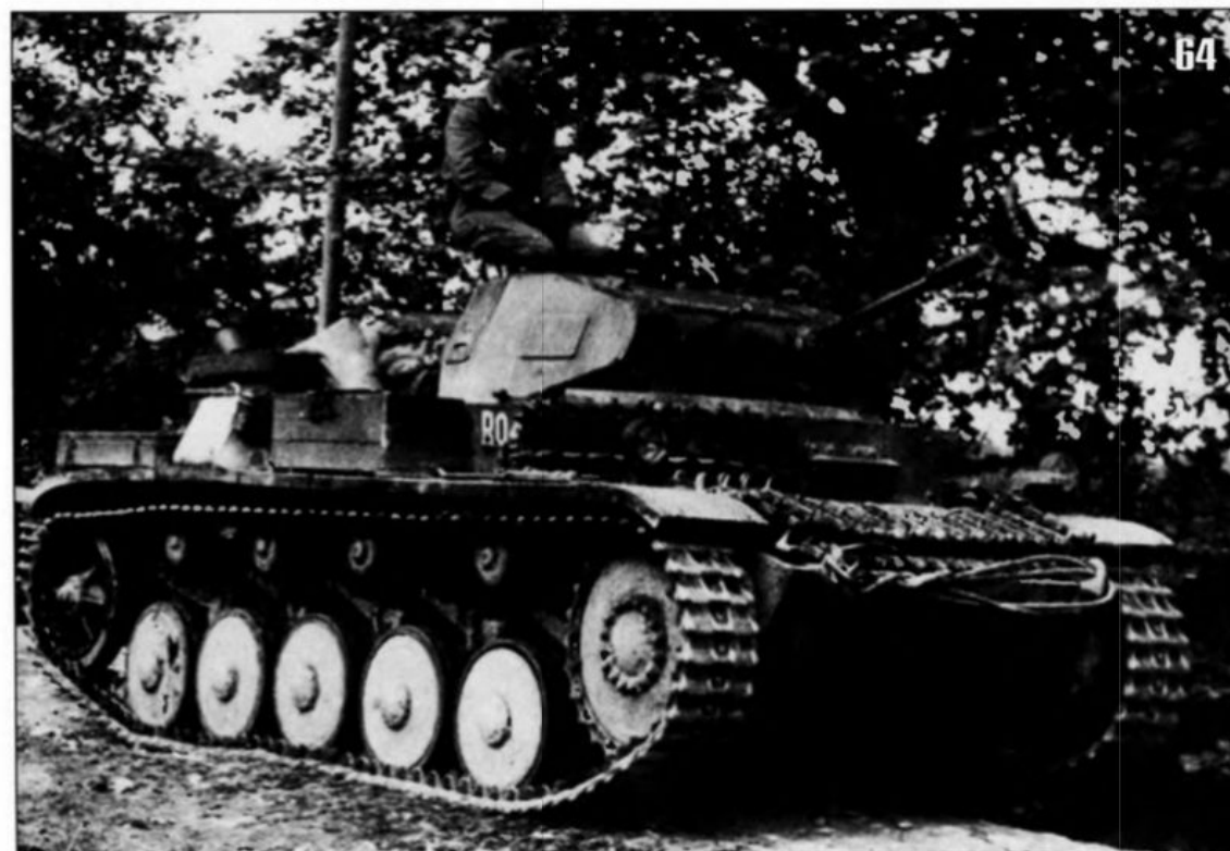
64. Танк Pz.II Ausf.C в начале операции «Барбаросса». На верхнем переднем и лобовом листах корпуса уложены запасные траки, на правой надгусеничной полке — большой нештатный ящик для инструмента и ЗИП.
