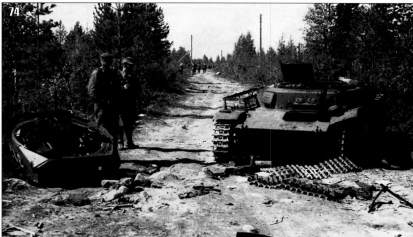
74. Результат подрыва танка Pz.II Ausf.C на советской противотанковой мине — скорее всего, у машины сдетонировал боекомплект. Карелия, июль 1941 года.
