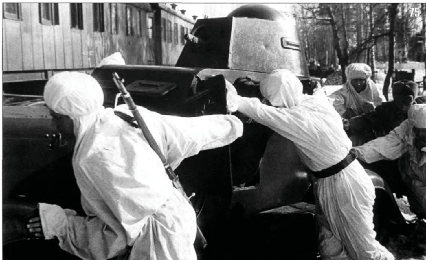
75, 76. Бронеавтомобиль БА-20-жд (на базе БА-20М) — на фото 75 установка броневика на рельсы для замены колес, на фото 76 разведчики отправляются на рекогносцировку пути. Железнодорожные бандажи закреплены на корме и бортах корпуса (АСКМ).
