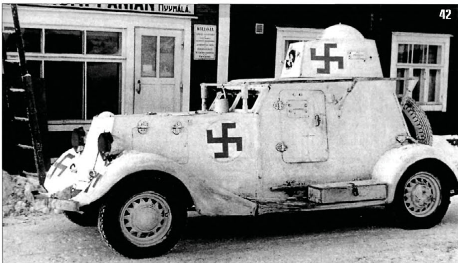
42. Бронеавтомобиль БА-20 (с конической башней) на службе в финской армии. Машина была захвачена в ходе советско-финляндской войны. На фото хорошо видно крепление поручневой антенны на корпусе машины (фото из коллекции Е. Муикку).
