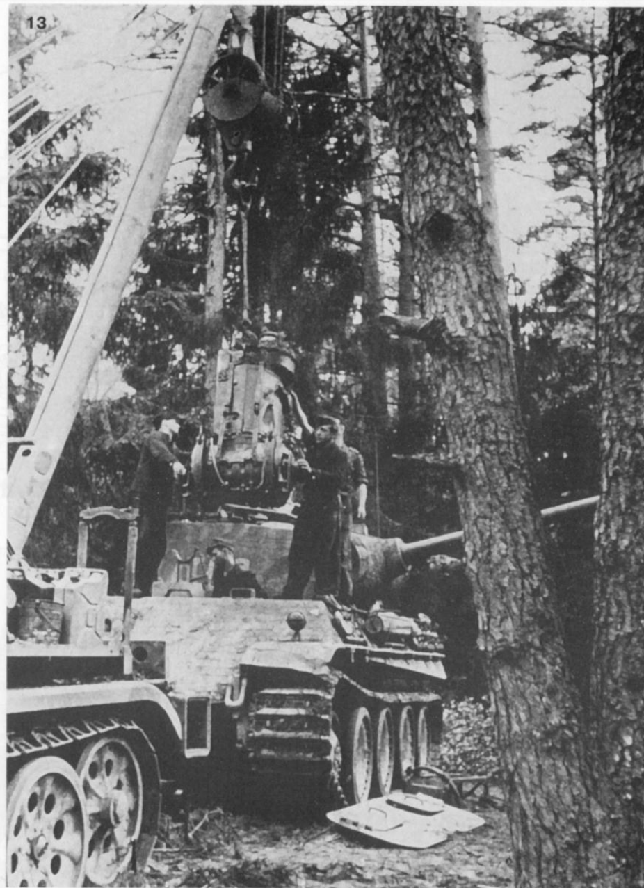
13 Ремонтники снимают коробку передач с танка «Пантера» Ausf G. 1944 г. Technicians take off the drive box from the PzKpfw V Ausf G. 1944.
