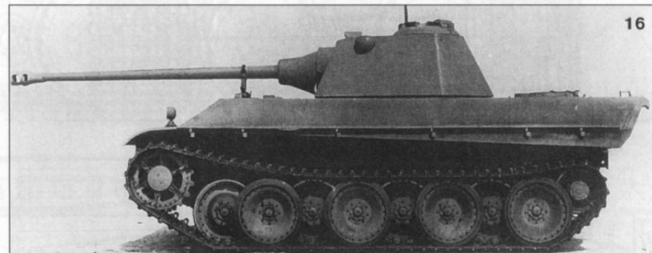
16 «Пантера» Ausf G с первым экземпляром башни «Шмальтурм». 1944 г. The PzKpfw V Ausf G with first example of Smallturm turret. 1944.
