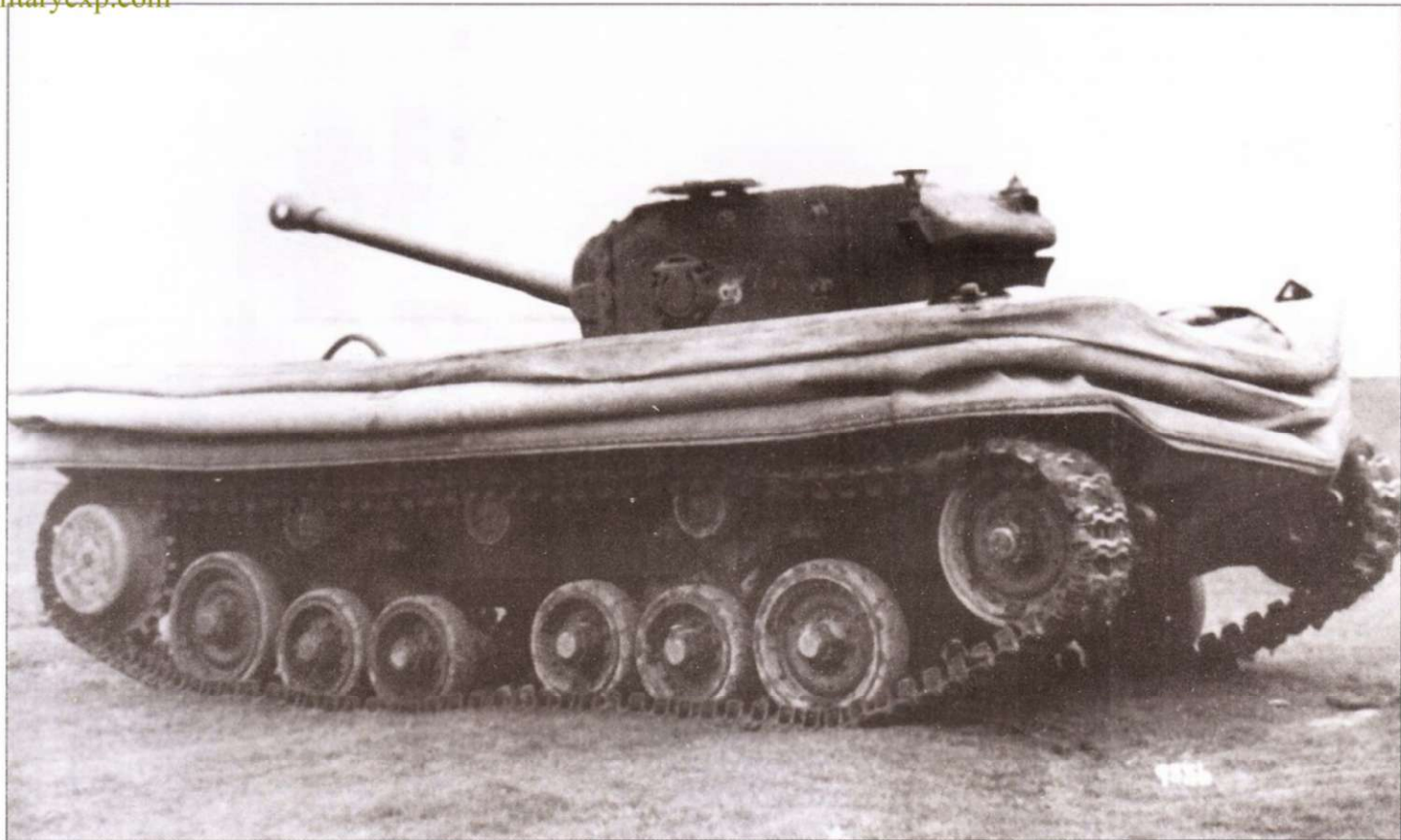
Пехотный танк Mk III Valentine Mk XI с десантным понтоном DD.
