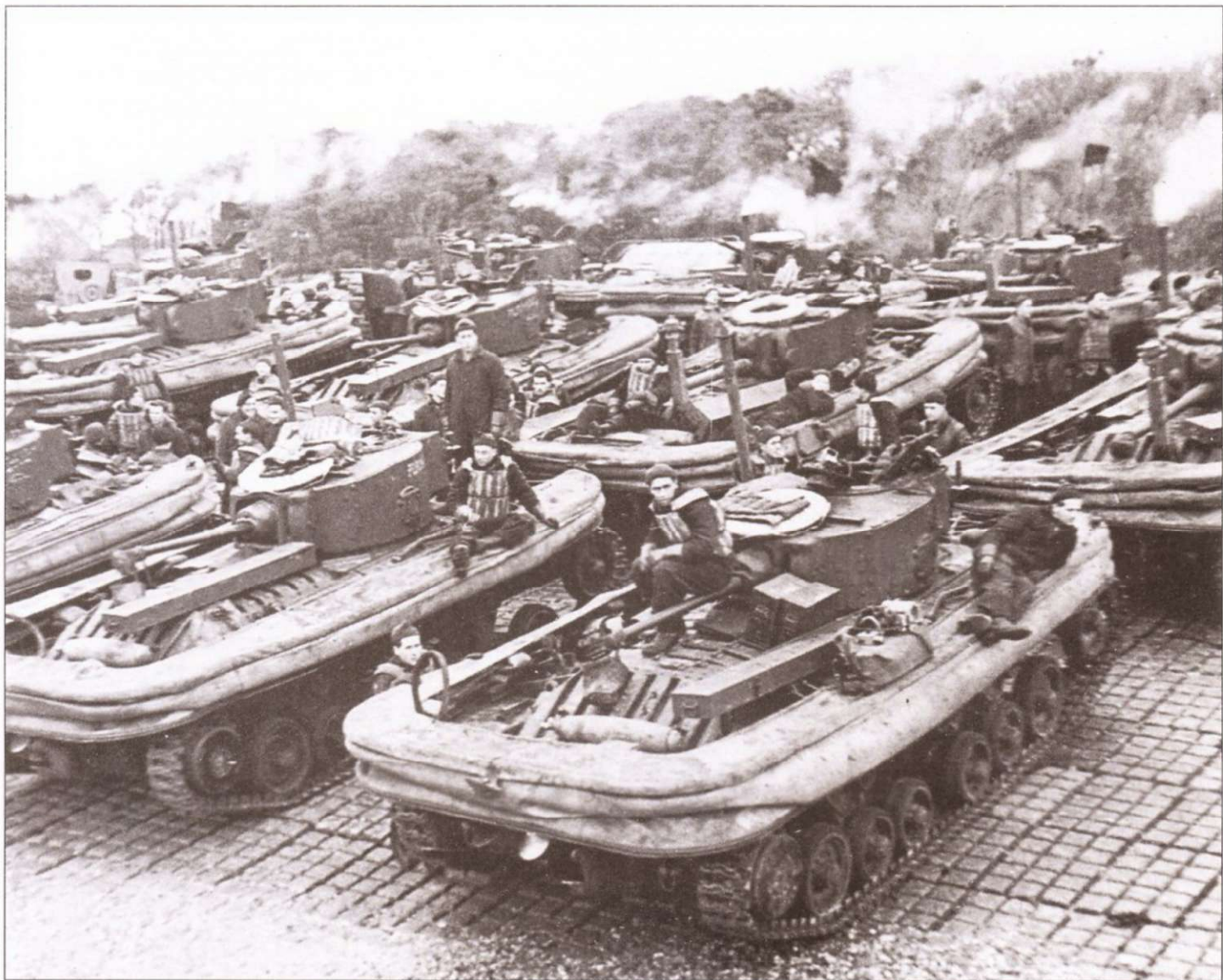
Понтоновые танки Valentine модификаций Mk III и Mk VIII подготовлены к десантной операции.
