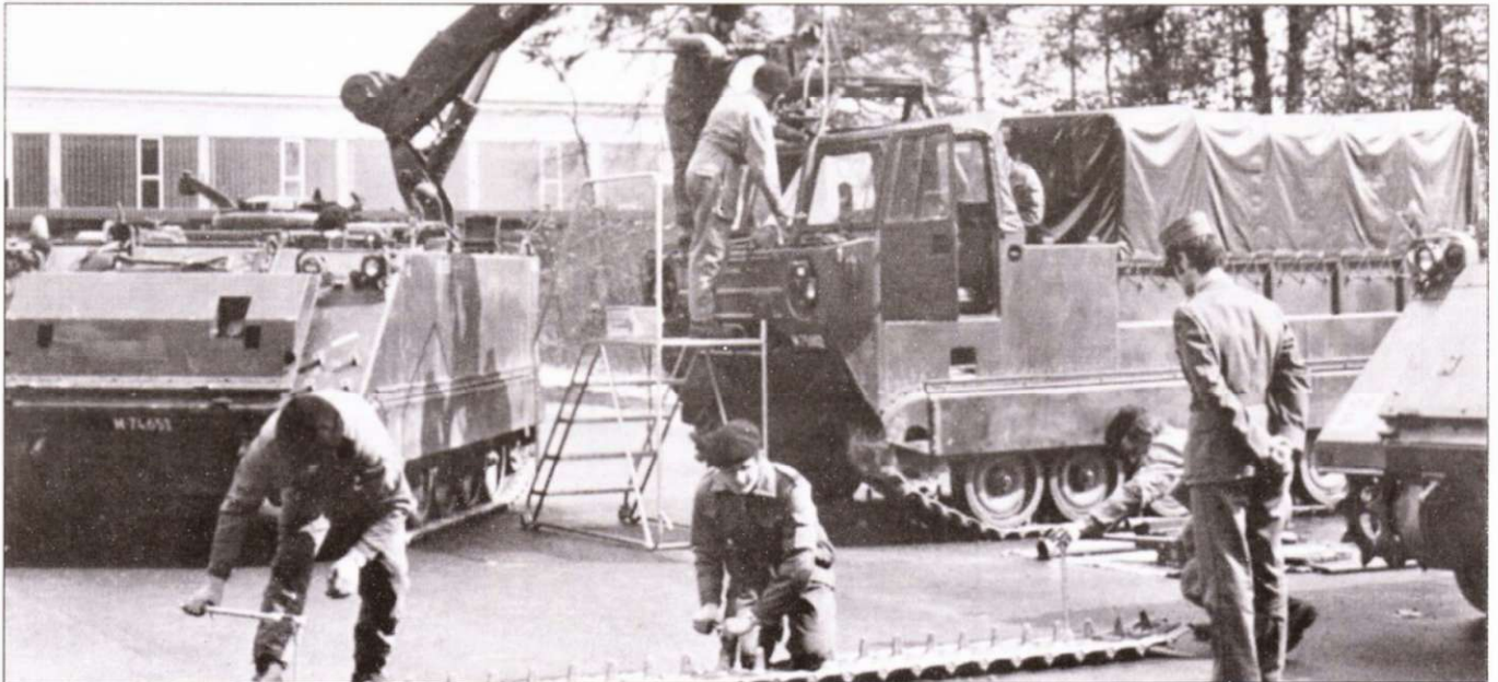
БРЭМ М579 армии Швейцарии, кран в работе. С помощью крана демонтируется двигатель бронетранспортера М113.
