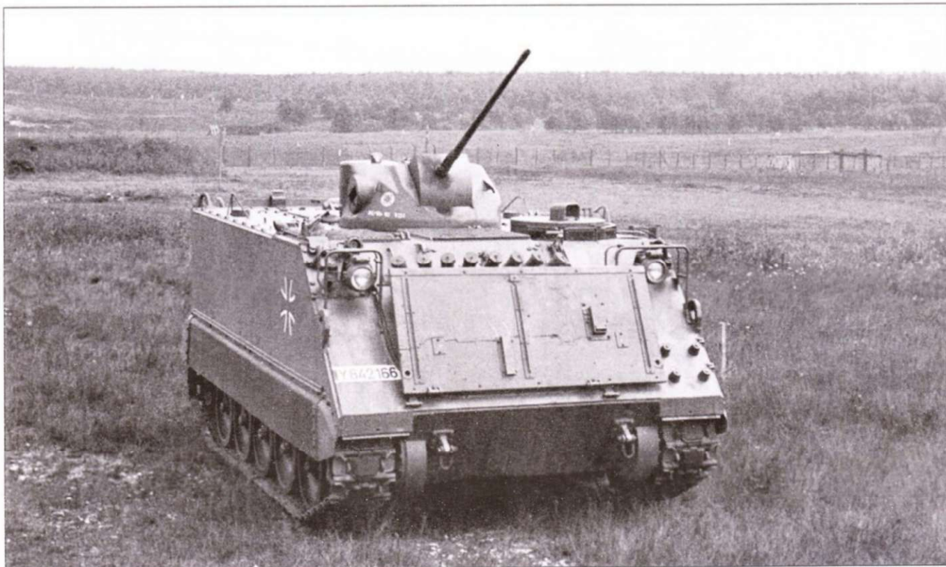
Западногерманская машина M113G, вооруженная башней Рейнметалл TS Rh-10 с 20-мм автоматической пушкой Рейнметалл МК 20 Rh-202. Снимок сделан на испытательном полигоне.
