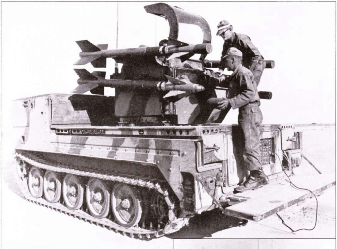
ЗРК XM730 «Чапарель» - попытка приспособить к армейским нуждам авиационные ракеты воздух-воздух «Сайдуиндер». Носитель камуфлирован темными полосами поверх базовой окраски песочного цвета. Обратите внимание - корпус машины существенно отличается от стандартного корпуса грузовика M548.
