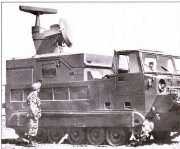
Швейцарская машина М548 с радиолокационной системой «Скайгارد», предназначенной для обнаружения и сопровождения маловысотных воздушных целей, а также для наведения на них зенитной артиллерии и ЗРК. Справа: итальянская машина М548 с установленным на ней радиолокатором обзора воздушного пространства Индиго MEI.
