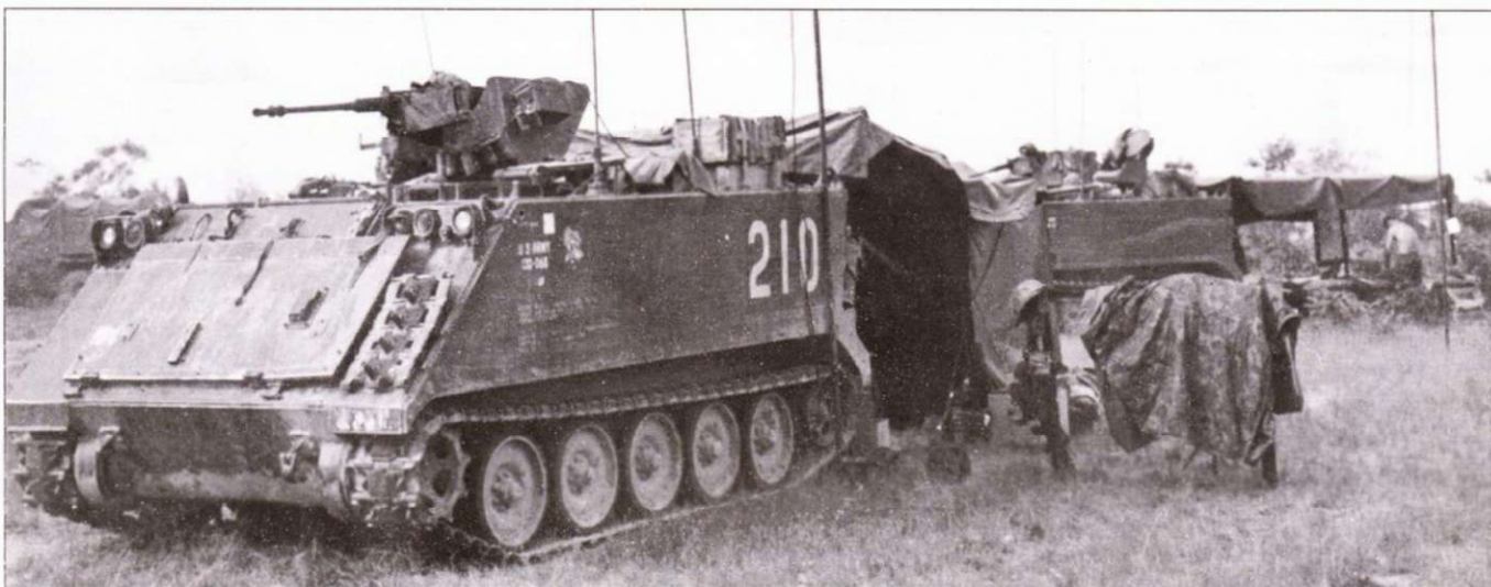
Две командно-штабных машины М113МСР, район Лай Кхе, январь 1968 г. Машины принадлежат роте «В» 2-го пехотного полка 1-й пехотной дивизии. Данный вариант являлся промежуточным - пока не начался массовый выпуск специализированных командно-штабных машин М577. Фактически - обычный бронетранспортер М113, оснащенный дополнительным радиооборудованием и складным тентом. На заднем плане - машина, на крыше которой установлено прикрытое броней сиденье, предназначенное для передового авиационного наводчика.
