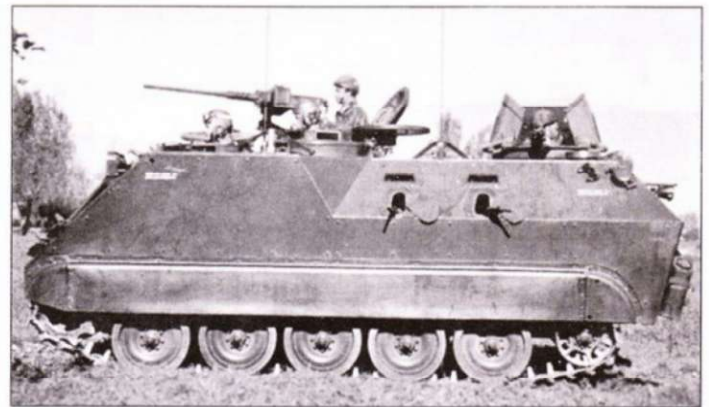
В Италии бронетранспортеры М113 строились по лицензии. Итальянцы самостоятельно разработали БМП на основе бронетранспортера М113, хотя полноценной БМП не получилось. Итальянский вариант получил название «Камиллино». Машина вооружена 12,7-мм пулеметом и пулеметом калибра 7,62 мм. В наклонных бортах боевого отделения сделаны амбразуры и установлены смотровые приборы. На левом снимке - «Камиллино», вооруженная автоматической пушкой.
