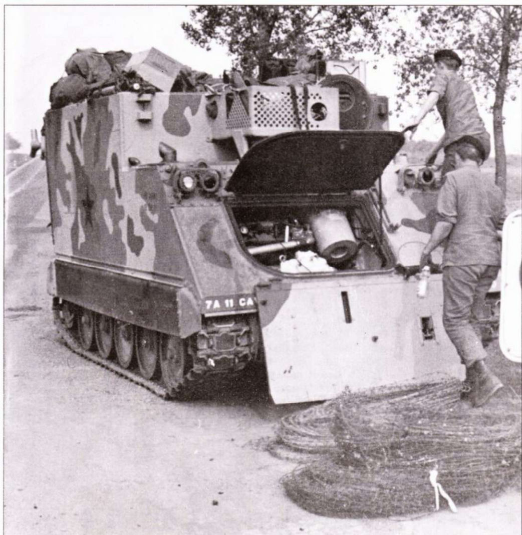
М113МСР с бронекреслом для передового авиационного наводчика. Крупнокалиберный пулемет прикрыт бронещитком. Подобные машины широко использовались во Вьетнаме.
