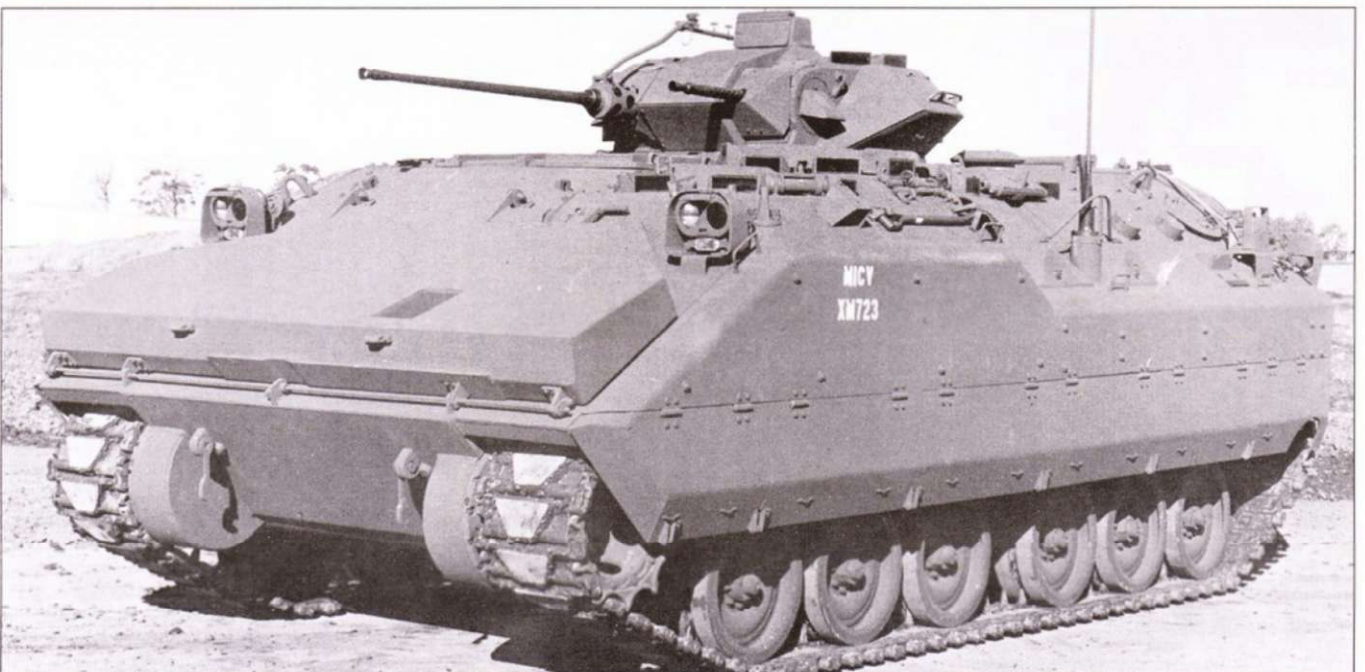
Предсерийный образец боевой машины пехоты ХМ723, разработанный по требованиям к перспективной БМП МПСV-70. Машина вооружена 20-мм автоматической пушкой М139 и спаренным с ней 7,62-мм пулеметом М219. Вооружение установлено в башне кругового вращения. На серийных образцах предусматривалась установка 25-мм автоматической пушки «Бушмастер». Количество амбразур и смотровых приборов по сравнению с опытной БМП ХМ765 уменьшено. Добавлено по одному опорному катку с каждого борта, на бортах и в лобовой части корпуса сделаны надельки для повышения запаса плавучести.
