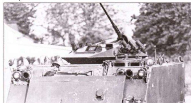
Швейцарский Schützenpanzer-63 с башней Моваг VO-42, вооруженной 12,7-мм пулеметом, на башне смонтированы дымовые гранатометы.
