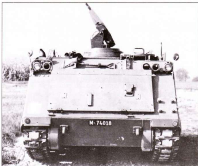
Швейцарский Schützenpanzer-63 с пулеметной установкой фирмы Моваг, пулемет - Маузер MG3 калибра 7,62 мм.
