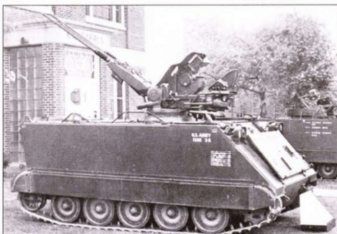
Швейцарский Schützenpanzer-63 с пулеметной установкой фирмы Моваг, пулемет - Маузер MG3 калибра 7,62 мм.
