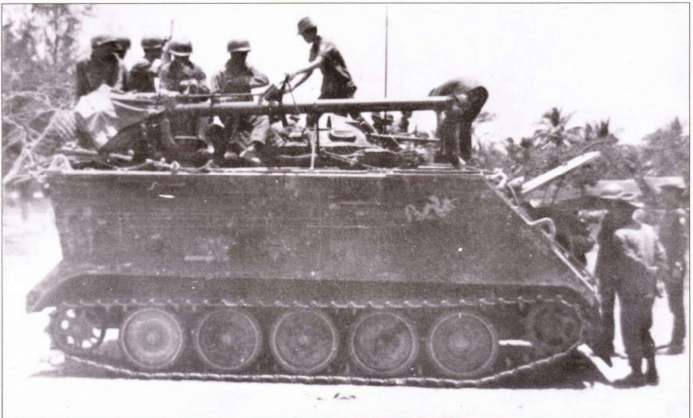
Южновьетнамский бронетранспортер М113 с башенкой М24А2 и 106-мм противотанковым безоткатным орудием.
