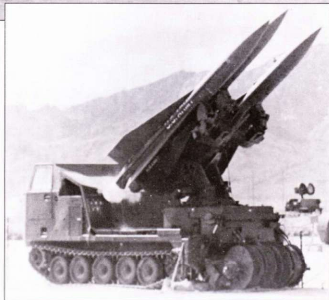
Вариант шасси грузовика М548 с ЗРК «Хок», над кабиной установлен гидравлически поднимаемый и опускаемый дефлектор для отвода газов ракетных двигателей.
