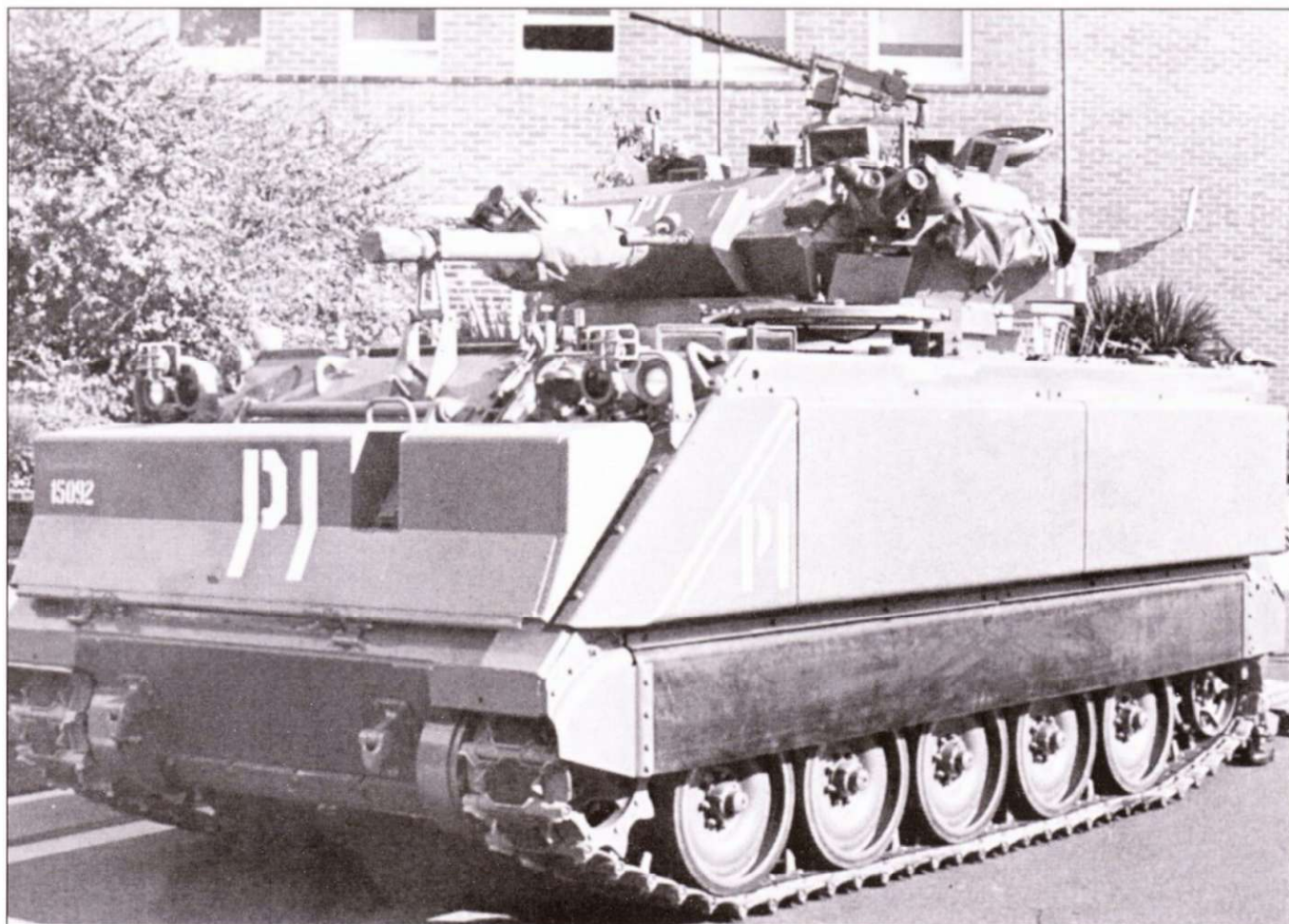
Прототип машины огневой поддержки, разработанный по заказу армии Австралии, представляет собой комбинацию бронетранспортера M113 с башней британского легкого танка «Скорпион», вооруженной 76-мм пушкой. На корпусе установлены специальные отсеки, улучшающие плавучесть машины. «Скорпион» был вооружен той же пушкой, что и «Саладин», однако с точки зрения баллистической стойкости башня танка была много лучше башни броневедомобиля.
