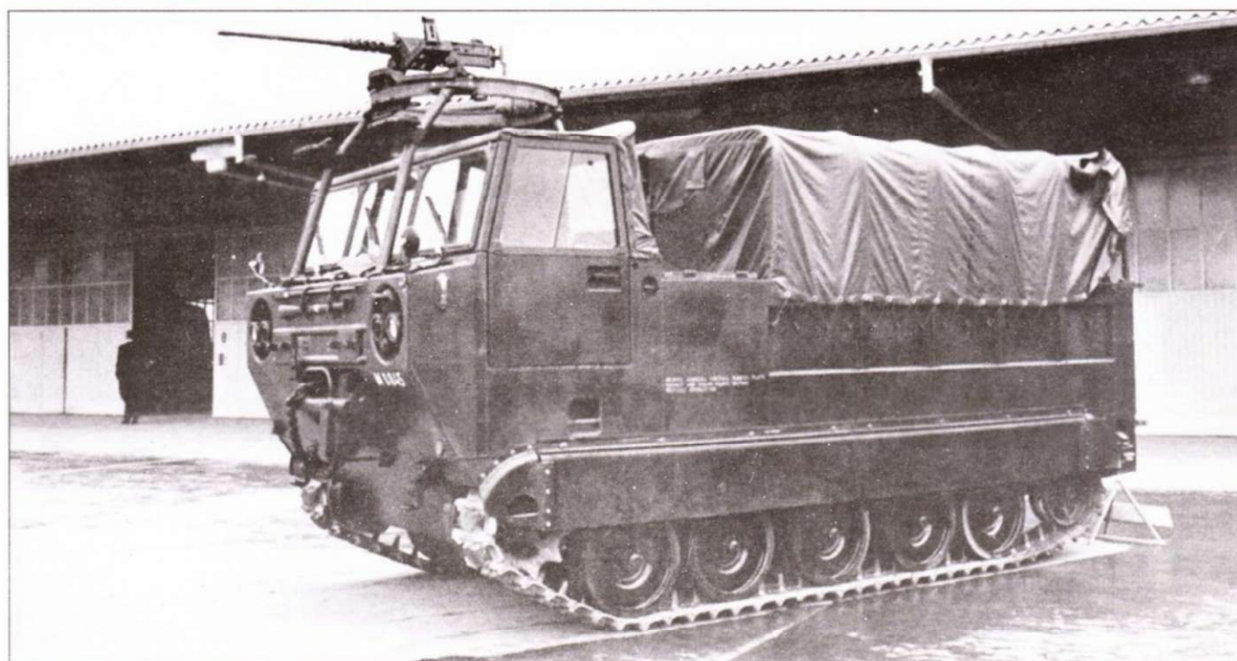
Машина снабжения M548 из артиллерийского подразделения армии США, видна лебедка, предназначенная для погрузки/разгрузки снарядов.
