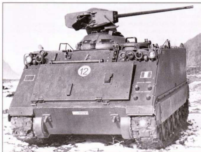
Итальянский вариант - башня Эрликон с 25-мм автоматической пушкой GBD-B20.
