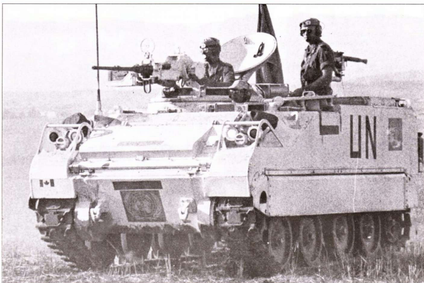
«Линкс» канадской армии из миротворческого подразделения сил ООН на Кипре, 1974 г. Броневик полностью окрашен в белый цвет, на него нанесена символика ООН. Рядом с люком радиста установлен дополнительный пулемет калибра 7,62 мм.
