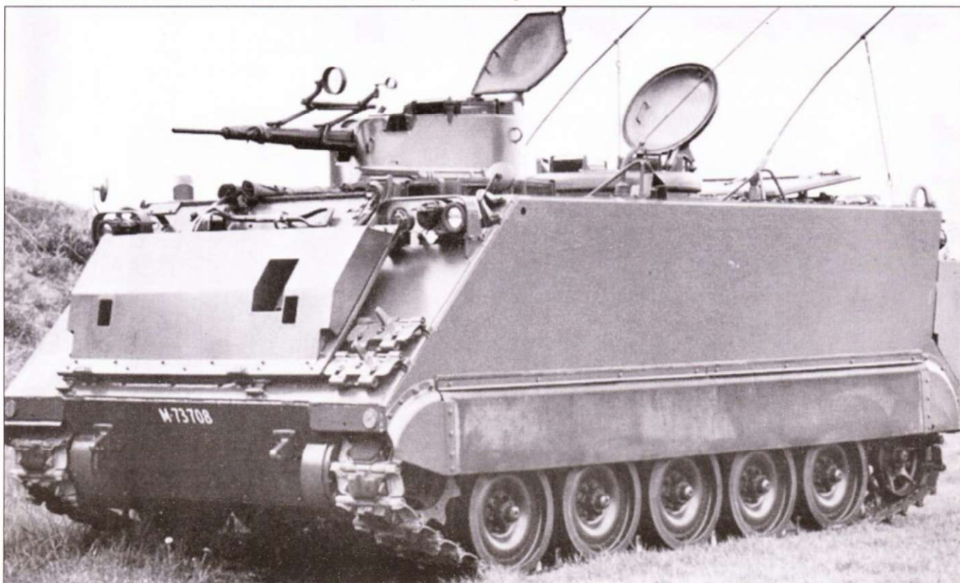
Schützenpanzer-63/73 армии Швейцарии с дополнительным понтоном на корпусе, предназначенным для улучшения плавучести с целью компенсации массы установленной на бронетранспортере шведской башни Хаггдунде с 20-мм автоматической пушкой. Командирская башенка перенесена к правому борту.
