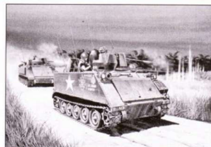
Два бронетранспортера М113 АСАВ подразделения армии США в поисках вьетконговцев, дельта Меконга, Южный Вьетнам. Головная машина названа экипажем «Trailblazer» - стандартный АСАВ, на другом АСАВ'е вместо 12,7-мм пулемета поставлен шестиствольный пулемет калибра 7,62 мм.
