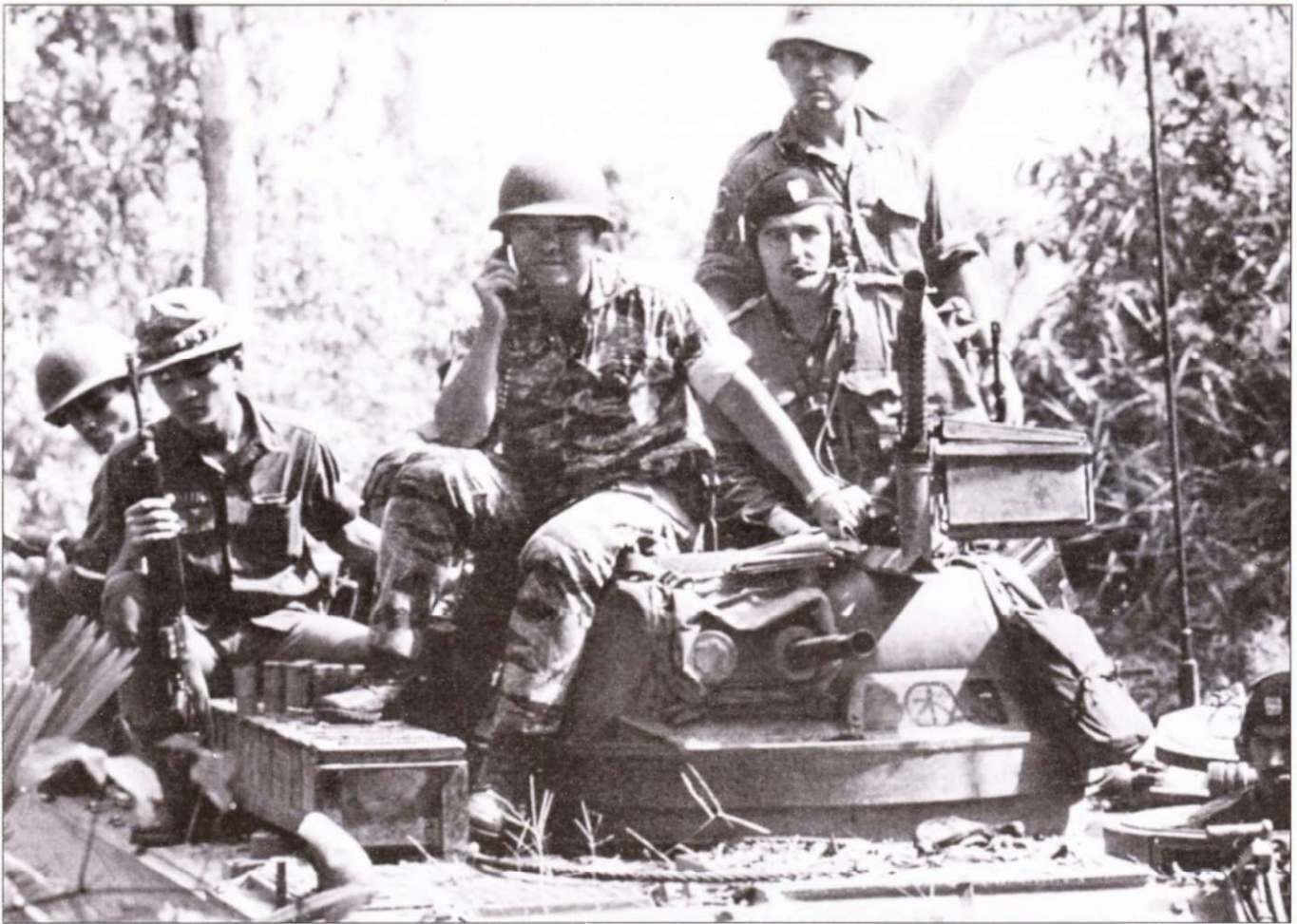
Австралийский бронетранспортер М113 с башенкой Т50, таким образом вооруженные машины пользовались большой популярностью в среде австралийцев, сдерживавших вьетнамский коммунизм. Интересно, что из этой башни один пулемет демонтирован, отверстие под пулемет заглушено. Зато дополнительный пулемет установлен на шкворне. Рисунок на бронезаслонке смотрового устройства отдает духом хиппи. ...во Вьетнаме растет много травы.
