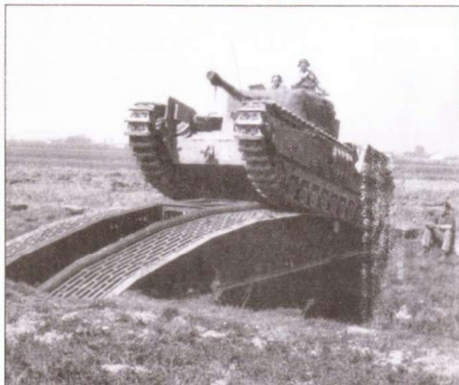
Танк «Черчилль» эскадрона С Северо-ирландского конного полка на мосту, уложенном мостовкладчиком на базе «Черчилля» из 51-го танкового полка, район Меццано, 30 марта 1945 г.
