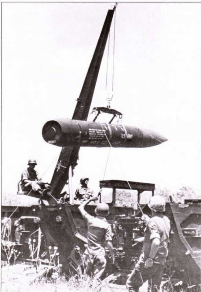
Вариант шасси грузовика М548 с ЗРК «Хок», над кабиной установлен гидравлически поднимаемый и опускаемый дефлектор для отвода газов ракетных двигателей.
