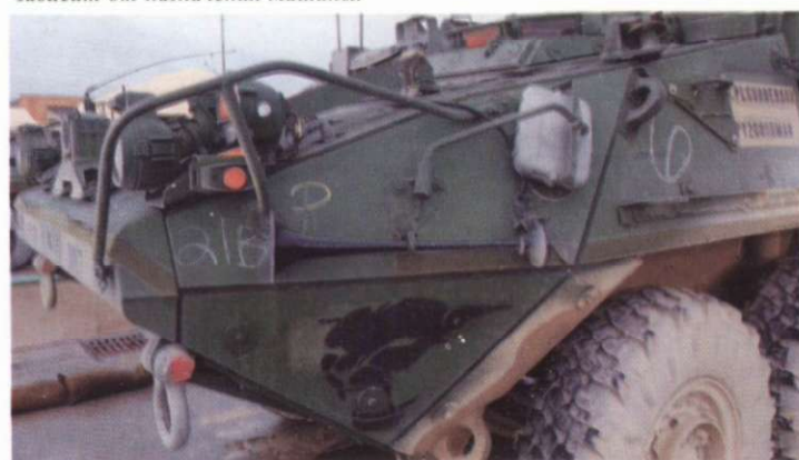
Фары прикрыты мощным ограждением из стальных труб, зеркала заднего вида завалены. На бортах корпуса нарисована эмблема в виде головы коугара черного цвета. Машины «Страйкер» оснащены вспомогательными силовыми установками - небольшим дизелем жидкостного охлаждения установлен в моторном отделении рядом с основным дизелем. От ВСУ приводится электрогенератор.
