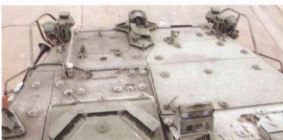
На оптические блоки наблюдательных приборов водителя нанесено антибликовое покрытие.
