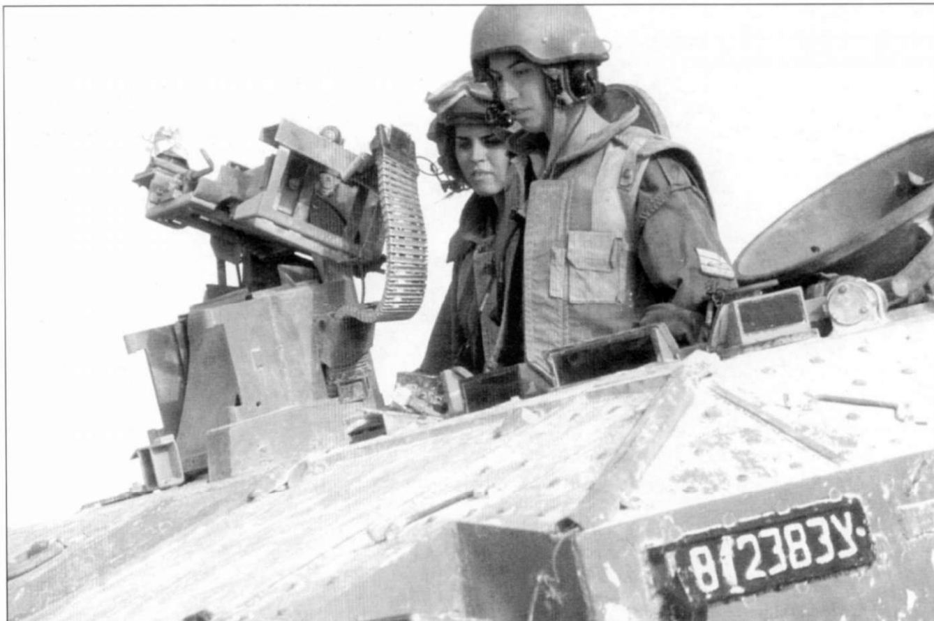
Командир и стрелок бронетранспортера «Ахзарит» - простые еврейские женщины. На модуле OWS пулемета нет. На снимке хорошо видны ... женщины? Хорошо видны смотровые блоки по периметру люка механицы-водительницы! Не менее замечателен номерной знак, закрепленный на броне боевой машины.
