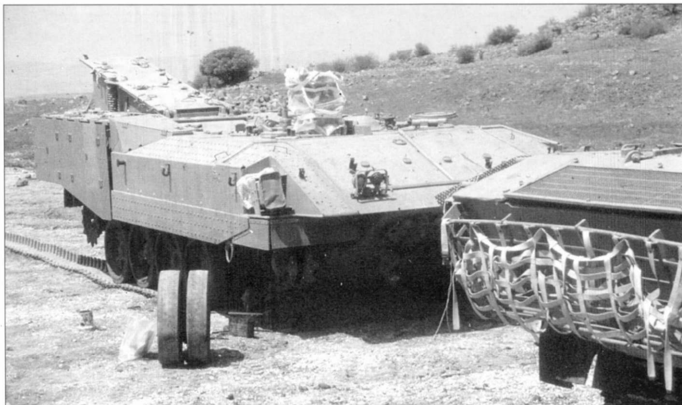
Серийный бронетранспортер «Ахзарит», вид спереди справа. Задний люк-лаз открыт. Ведутся работы по замене гусеницы. Снимок сделан на Голанских высотах.
