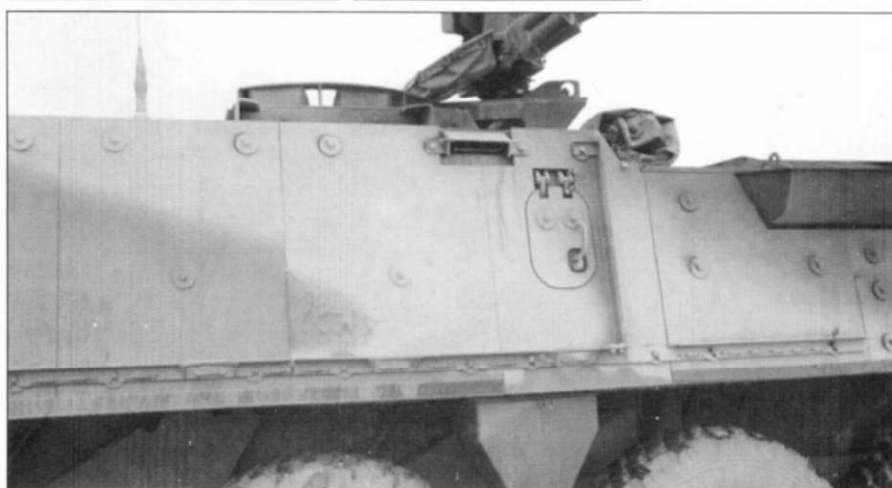
Корпус сварен из стальных бронелистов, поверх которых закреплена керамическая броня и кевлар. Бронезащита устойчива к попаданию пуль калибра до 14,5 мм.
