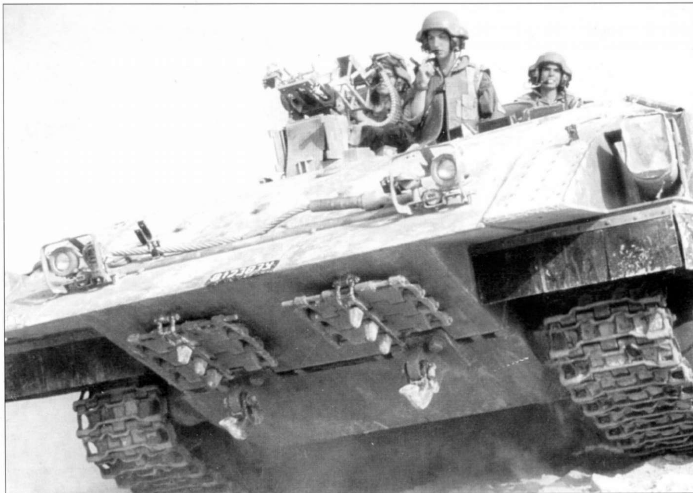
«Ахзарит» перед фотокамерой. Пулемет на модуле OWS не установлен. На нижней поверхности в лобовой части корпуса закреплены секции запасных гусеничных траков. Сбоку смонтирован блок дымовых гранатометов TAAS CL-3030. Командир машины - девушка, за ней из люка выглядывает командир пехотного десанта. Бронетранспортер покрашен в цвет «Синайский серый». На броне осела пыль. По центру лобового бронелиста уложен бронекожух электропроводки фар.
