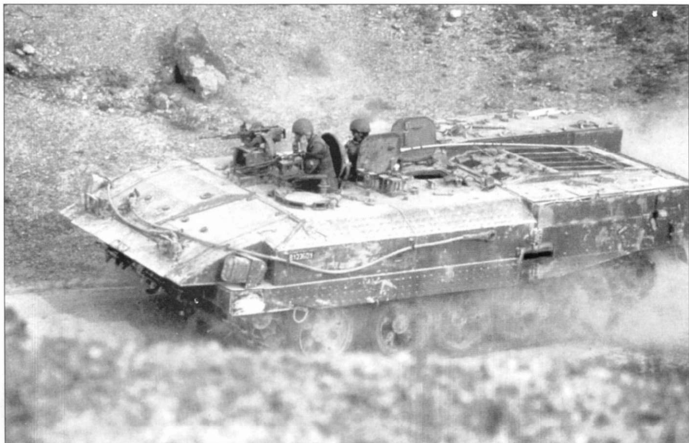
Высокий уровень защищенности бронетранспортера «Ахзарит» достигнут путем навески дополнительной брони на корпус танка Т-55.
