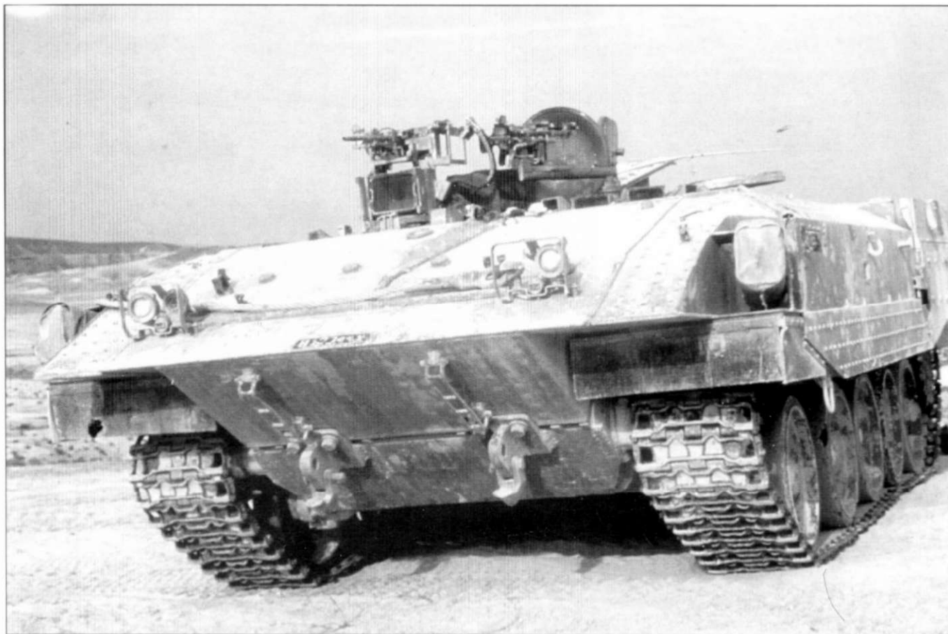
Серийный бронетранспортер «Ахзарит», вид спереди справа. Виден выступ в левой части лобового бронелиста корпуса. Бронетранспортер вооружен двумя пулеметами FN калибра 7,62 мм, один из которых поставлен на модуль Рафаэль OWS. Снимок сделан в пустыне Негев.
