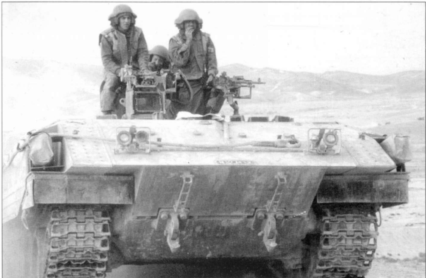
Высокий уровень защищенности бронетранспортера «Ахзарит» достигнут путем навески дополнительной брони на корпус танка Т-55.
