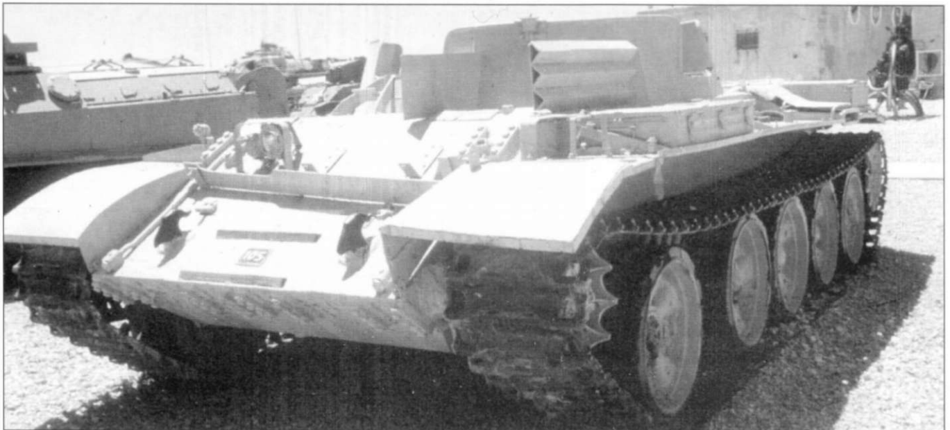
Самая примитивная конверсия поврежденного танка Т-55 в бронетранспортер с открытым верхом. Вероятно - на снимке одна из конверсий Т-55 в бронетранспортер, состоявших на вооружении южноливанской армии.
