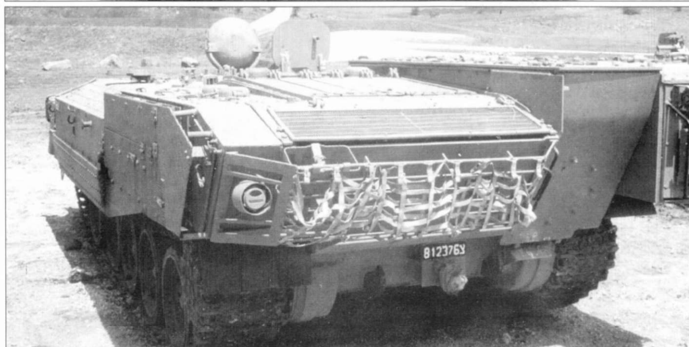
Серийный бронетранспортер «Ахзарит», вид сзади слева. Хорошо видна щель между корпусом и накладной броней комплекта «Тога». Опять - сетка-багажник. Снимок выполнен на Голанских высотах.
