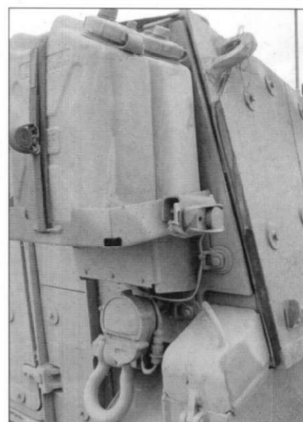
На корме корпуса, справа и слева от опускаемой рамы, закреплены канистры. Дверца в раме снабжена боевым запором. Дверца обеспечивает вход и выход в машину без опускания рамы. При опущенной раме снижается трудоемкость погрузочно-разгрузочных работ, доступ экипажа.
