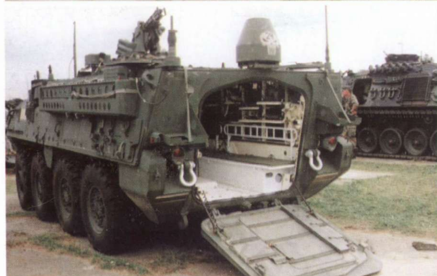
Командно-штабная машина М1130 «Страйкер CV» с открытой задней рампой на учениях в Германии. Машина укомплектована антенной спутниковой связи SATCOM фирмы Талес. Все радиоэлектронное оборудование сосредоточено внутри машины в ее задней части. Состав бортового оборудования зависит от назначения машины.
