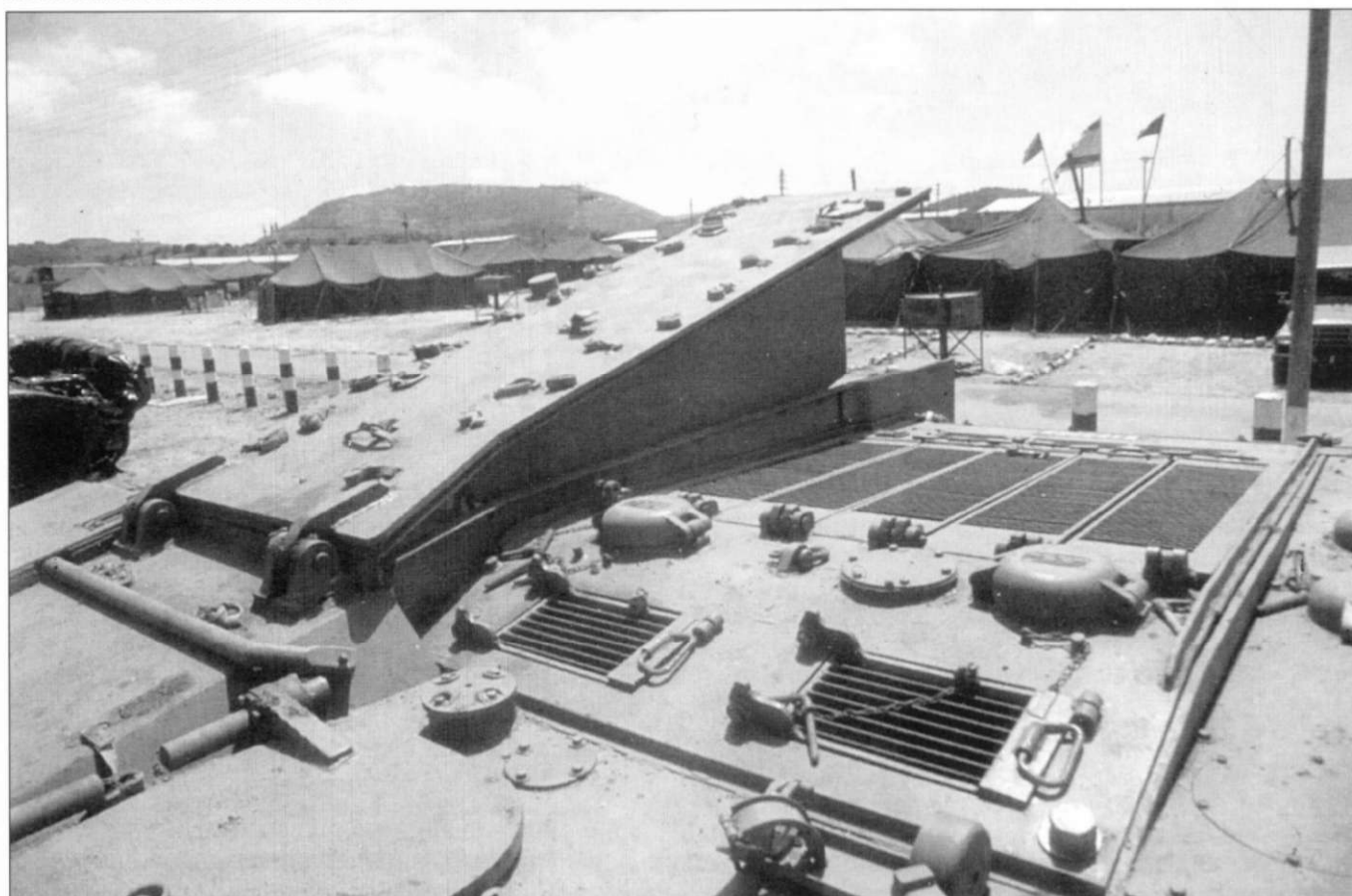
Корма корпуса серийного бронетранспортера «Ахзарит», вид справа сверху спереди. Дверь выполнена в виде рампы, опускаемой и поднимаемой гидравликой. Для увеличения высоты лаза вся его верхняя часть вместе с боковыми стенками может с помощью гидравлики подниматься вверх. Таким образом, конструкторам удалось, несмотря на заднее расположение МТО, реализовать крайне важный для бронетранспортера доступ в боевое отделение машины с кормы. Заднее расположение двигателя также положительно отразилось на балансировке БТР. Основная масса брони машины сосредоточена в передней части, а установленный в корме тяжелый моторный блок удачно компенсирует смещение центра тяжести вперед из-за увеличения толщины лобовой брони, более равномерно распределяя нагрузку на ходовую часть. Снимок сделан на Голанских высотах. По высотам, что на заднем плане проходит линия разграничения между сирийскими и израильскими войсками.
