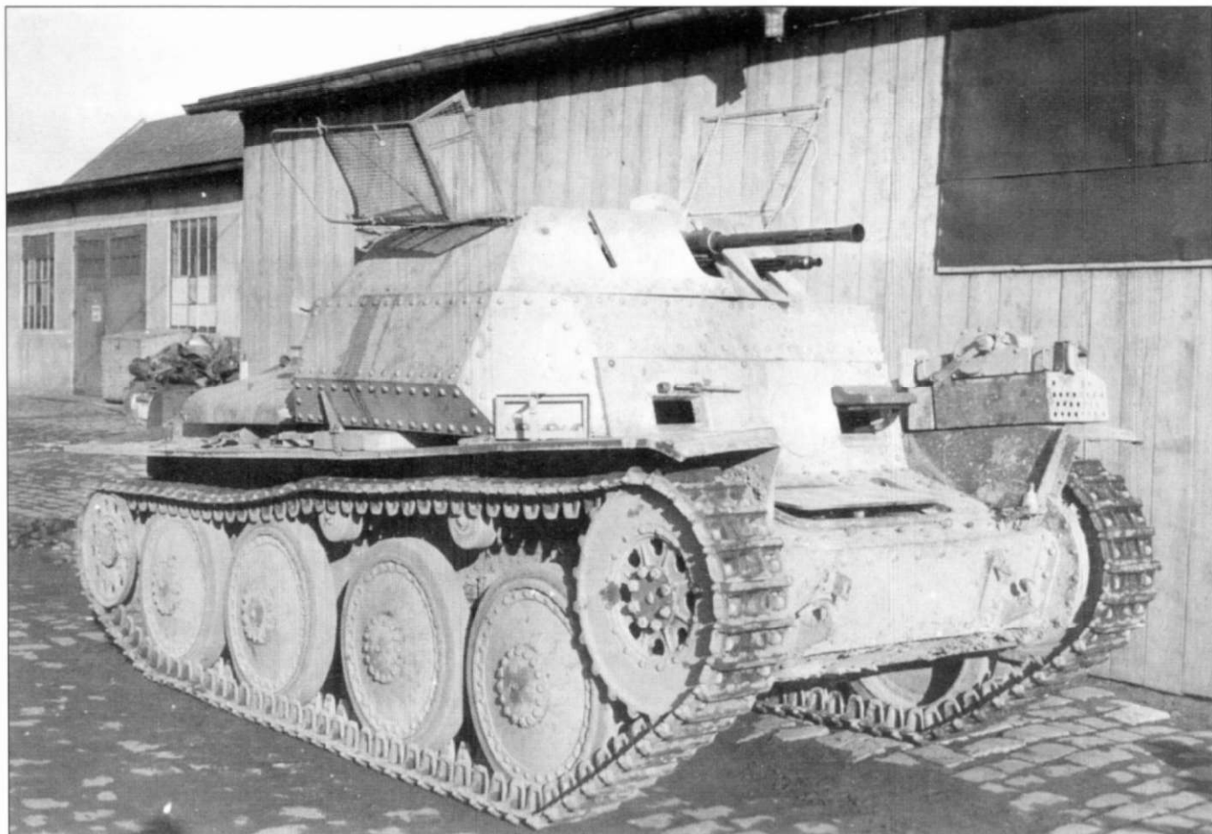
Разведывательный танк Sd.Kfz. 140/1 стал последним представителем семейства боевых машин на базе танка 38(t). Эти танки имели легкое стрелковое автоматическое вооружение, расположенное в башне кругового вращения.
