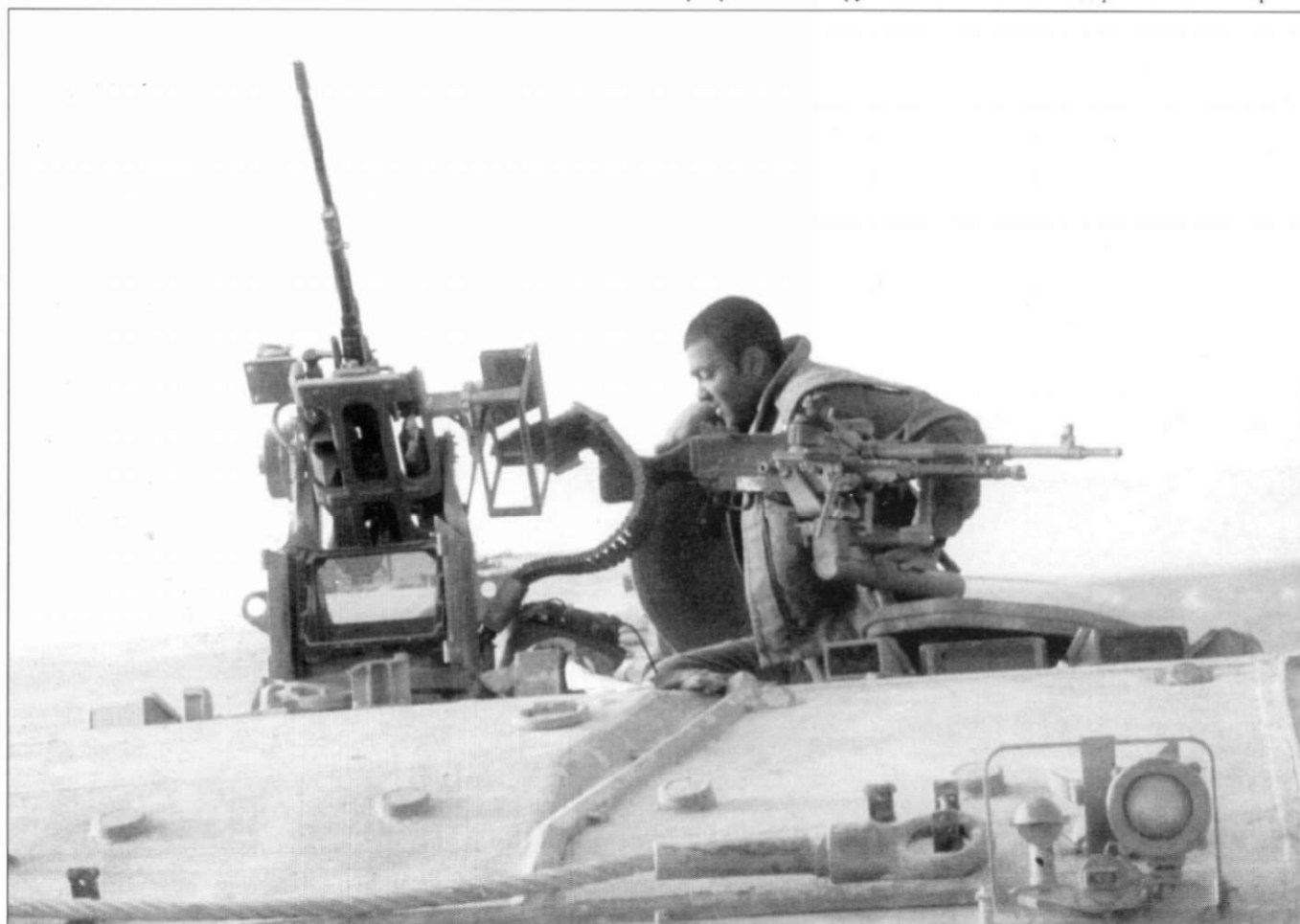
Отличный снимок двух пулеметных установок бронетранспортера «Ахзарит». Один пулемет FN - на модуле OWS, второй - на L-образной турели.
