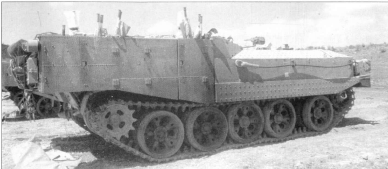
Командирский вариант бронетранспортера «Ахзарит», вид справа. На бортах всех бронетранспортеров «Ахзарит» закреплены мощные буксирные тросы. Петли панелей накладной брони «Тога» окрашены в красный цвет. Фотография выполнена на Голанских высотах.
