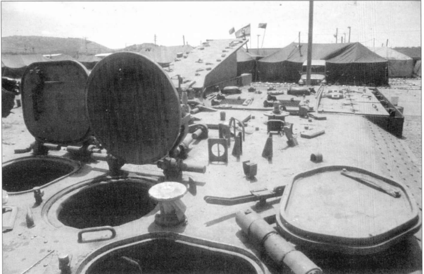
Крыша серийного бронетранспортера «Ахзарит», вид из носа в корму. Слева направо: люки стрелка, командира и механика-водителя. В боевом отделении могут разместиться 10 человек, включая механика-водителя. Шесть десантников могут расположиться на скамейках, установленных вдоль бортов машины; еще одно сиденье для десантника расположено в задней части боевого отделения, по оси машины.
