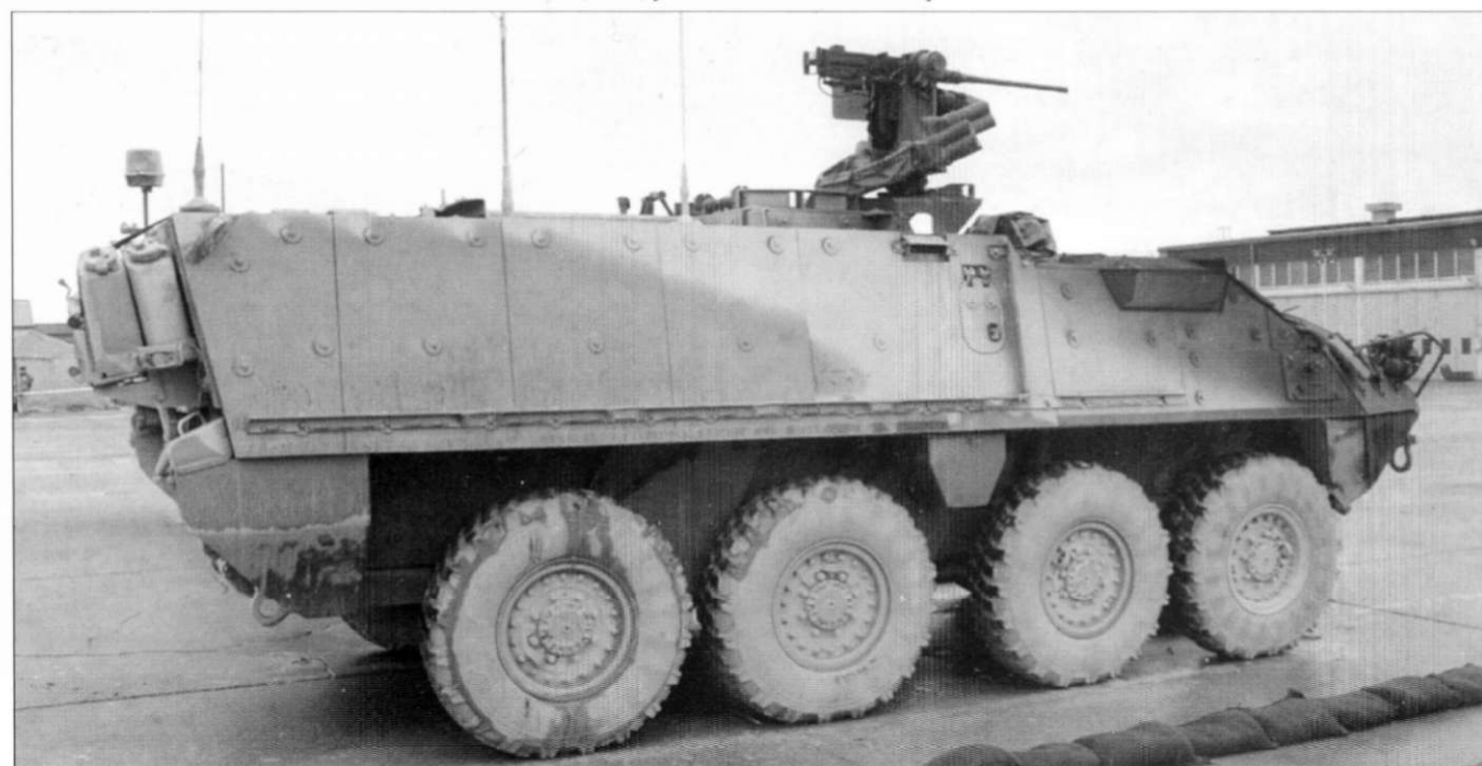
На фото М1130 «Страйкер CV» командира эскадрона 2-2 майора Вуда. На правом борту отсутствует панель с креплениями под инструмент.
