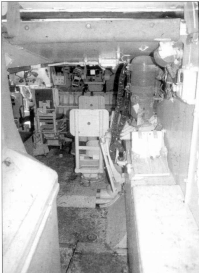
Интерьер боевого отделения серийного бронетранспортера «Ахзарит», снимок сделан через открытый кормовой люк-лаз. Интерьер разрешают фотографировать только после удаления из него боекомплекта и части электронного оборудования.
