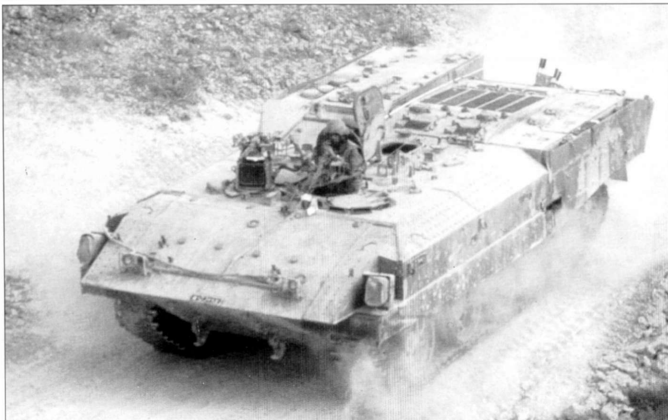
«Ахзарит» в движении, командир привстал в открытом люке. В районе первого опорного катка установлена проволоочная подножка. Больше всего пыли, как ни странно, оседает на горизонтальных, а не на вертикальных поверхностях.
