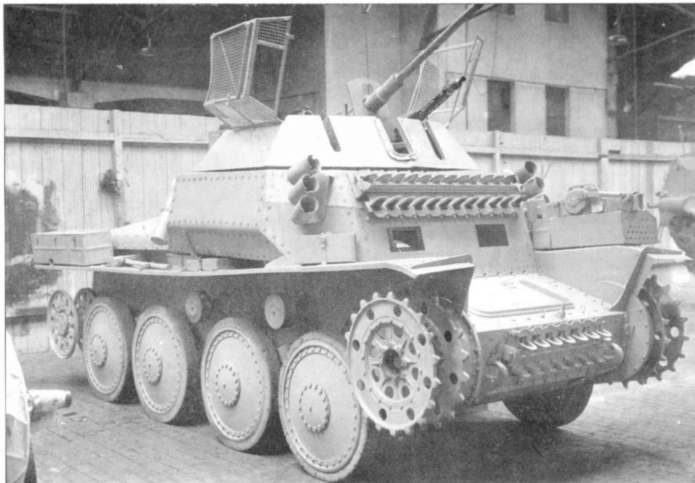
На снимке - прототип разведывательного танка, на стандартном танковом шасси смонтирован деревянный макет башни. На прототипе установлены дымовые гранатометы и запасные гусеничные траки.
