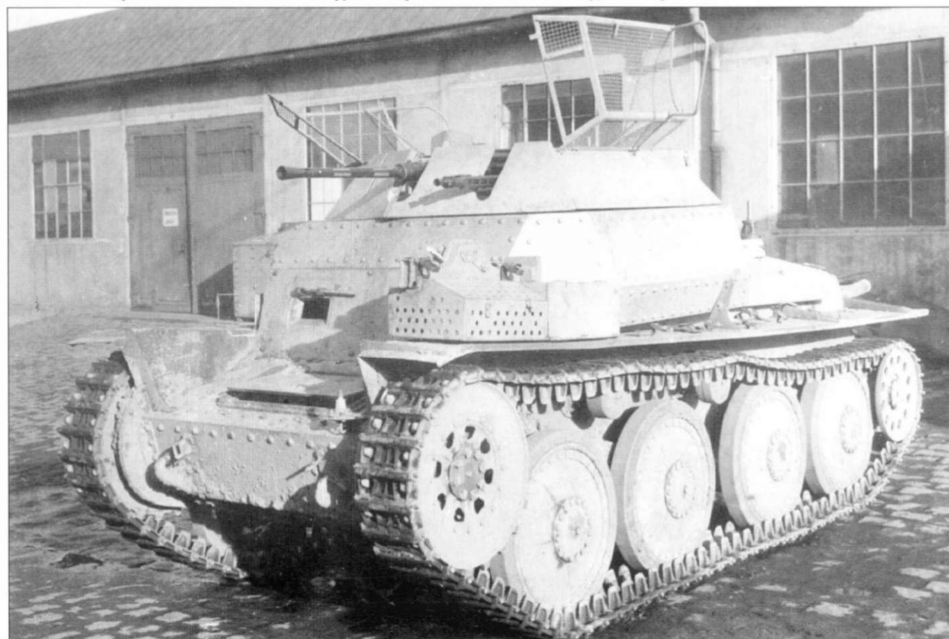
Разведывательный танк Aufklärungspanzerwagen 38 (2 см) обладал высокой максимальной скоростью. Базой для машины послужило проверенное временем и войной шасси чешского танка 38 (t).
