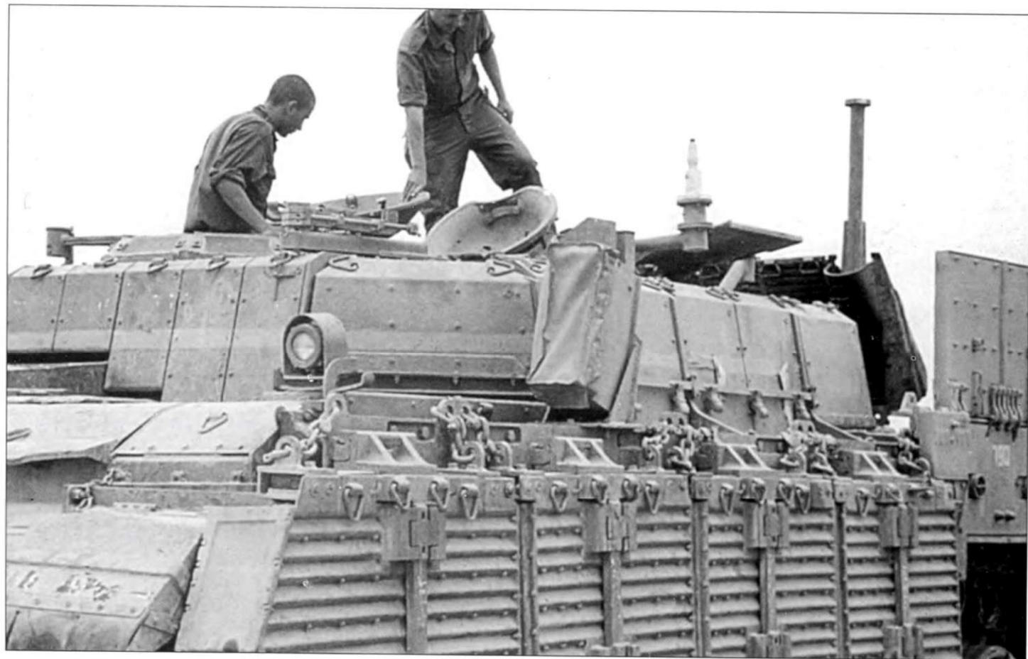
Парашиотисты на броне «Накпадона». На снимке отлично видны секции бортовых экранов. Задняя секция экрана поднята в вертикальное положение.
