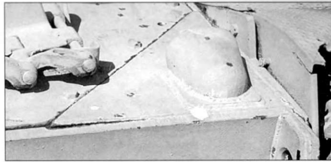
Вентиляционный колпак трансмиссии установлен на отдельном листе в углу передней части корпуса.
