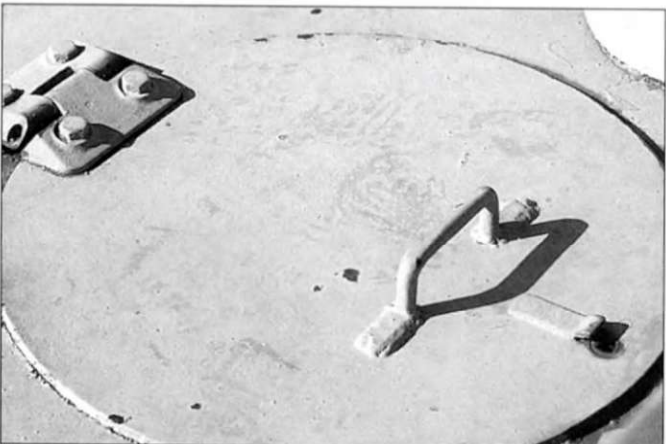
В крыше отделения управления имеется два идентичных круглых люка.
