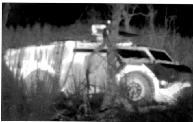
Изображение бронев автомобиля «Феннек» через ИК камеру другой машины данного типа. Форма корпуса и конструктивные особенности машины значительно снижают ее тепловую сигнатуру.
