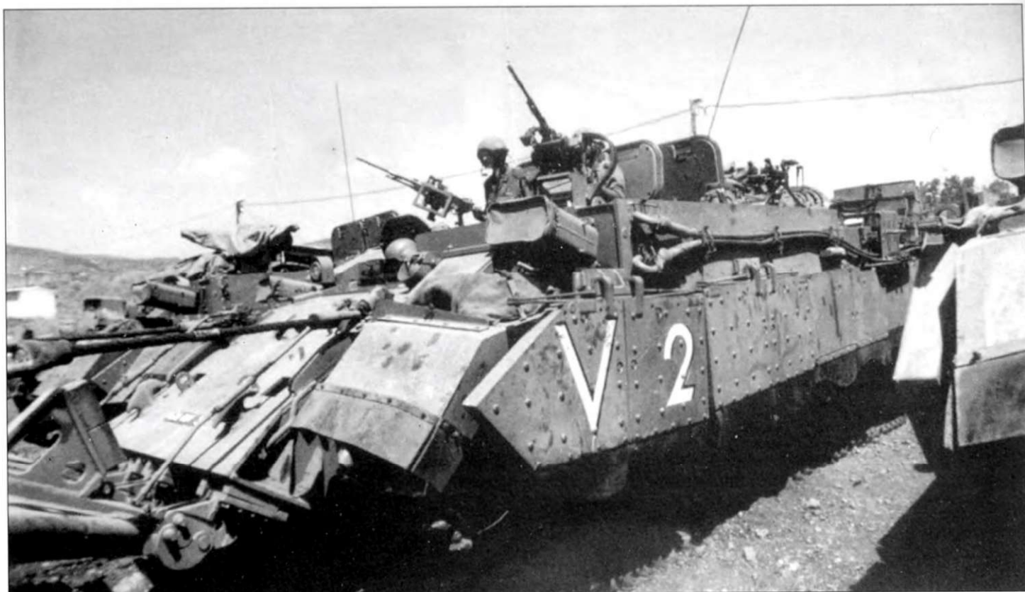
«Пума» - очередная конверсия танка «Центурион», выполненная в Израиле. «Пума» является не бронетранспортером, а боевой машиной саперов и имеет уровень защищенности, близкий уровню защищенности бронетранспортера «Ахзарит». Вооружена боевая машина саперов 7,62-мм пулеметами FN на модуле Рафаэль OWS и простейших турелях. Данная машина оснащена минным тралом РКМ раннего типа. Тактическая маркировка обозначает: машина 2-го взвода 3-й роты (повернутый углом вниз шеврон).
