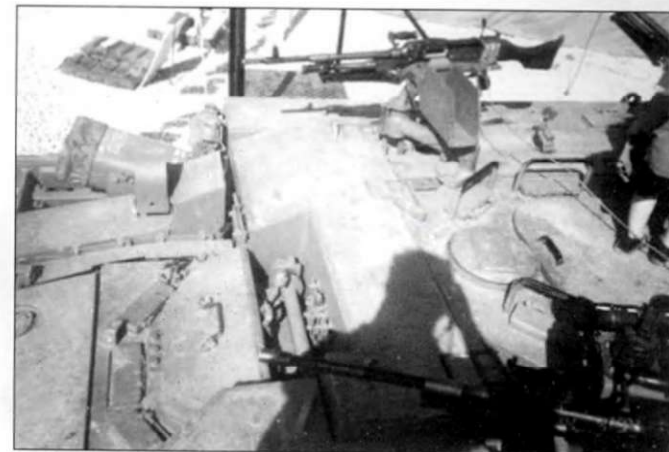
Вид сверху на лобовую часть корпуса боевой машины саперов «Пума», в кадре - люк механика-водителя, блок дымовых гранатометов, пулеметы калибра 7,62 мм.
