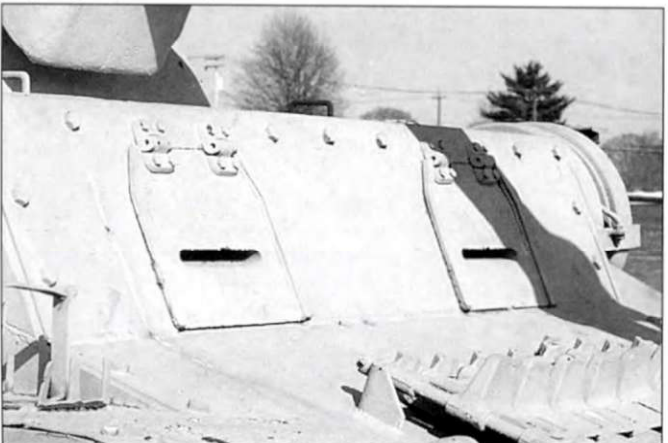
Отделение управление напоминает отделение управления самоходки «Хуммель». На лобовом листе корпуса уложены запасные гусеничные траки.
