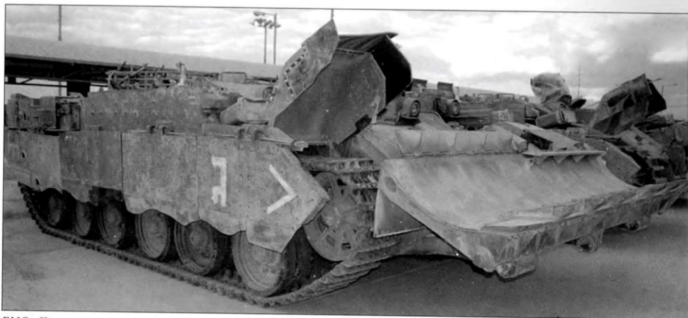
БМС «Пума», оснащенные бульдозерными отвалами. Такие бульдозеры используются для расчистки завалов на дорогах под огнем неприятеля.
