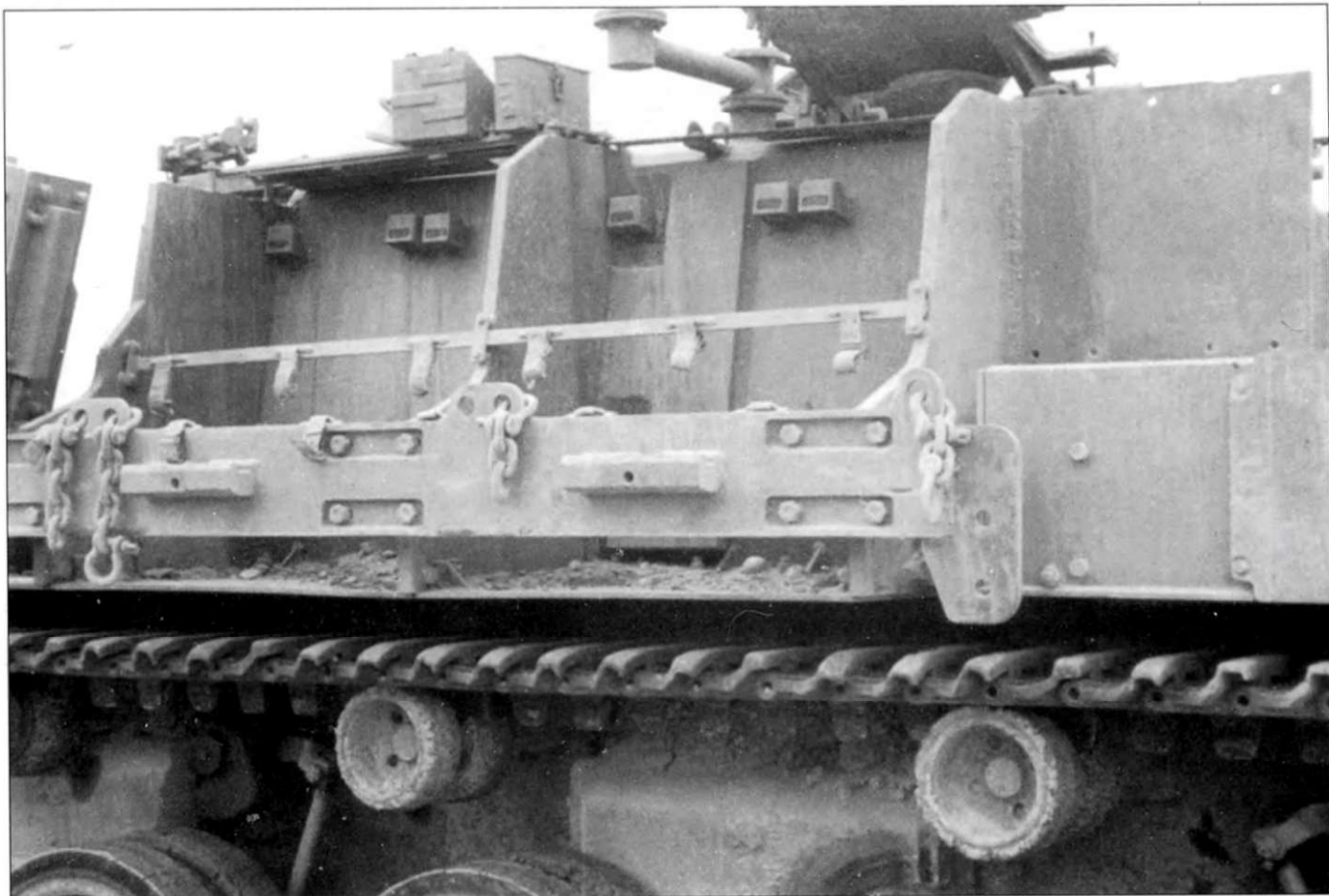
Крупный план обнаженного, без накладной брони, бронетранспортера. Хорошо видны узлы навески модулей накладной брони на стенке рубки.
