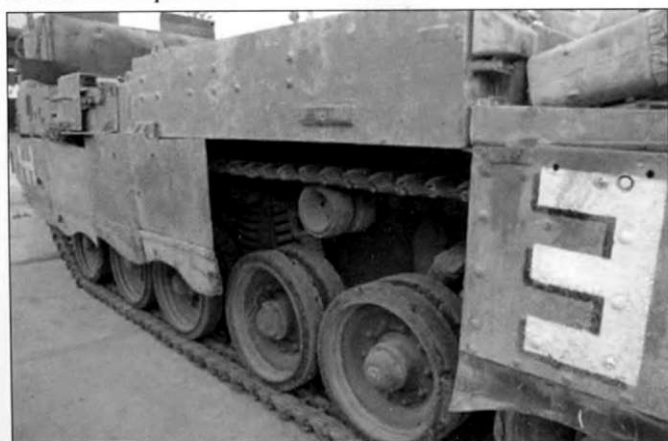
Снятая секция бортового экрана позволяет увидеть элементы ходовой части БМС «Пума». Оригинальная подвеска «Центуриона» заменена подвеской, выполненной по типу подвески танка «Меркава».
