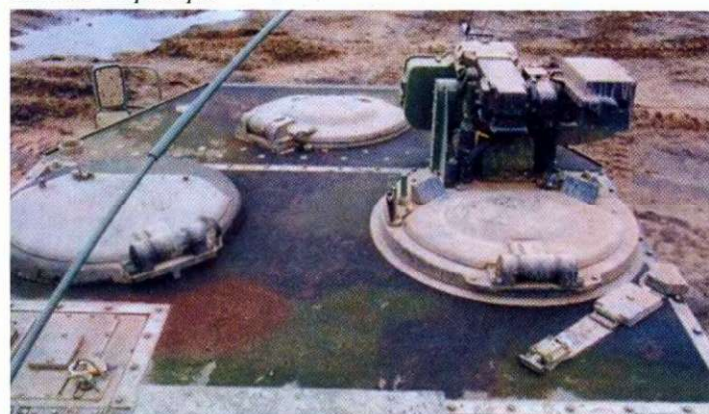
Сиденье водителя расположено по продольной оси машины. Сзади справа-слева от водителя занимают свои места командир и оператор специального оборудования. Верхний люк командира в диаметре на 8 см больше люков водителя и оператора.
