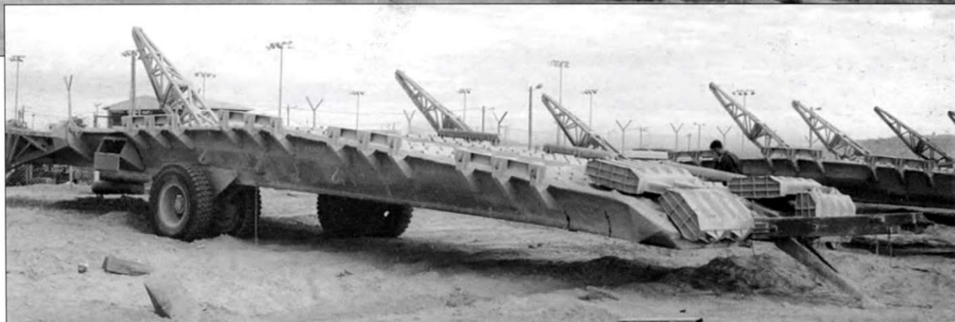
БМС «Пума» буксирует штурмовой мост по морю песка. Информация о боевом применении БМС «Пума» до сих пор не обнародована, но известно, что Армия Оборона применяла «Пумы» для сокрушения опорных пунктов Хезболлы в Южном Ливане.
