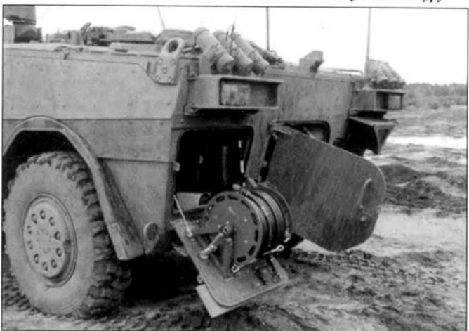
Предусмотрена возможность выноса датчиков на расстояние до 37 м от бронев автомобиля.
