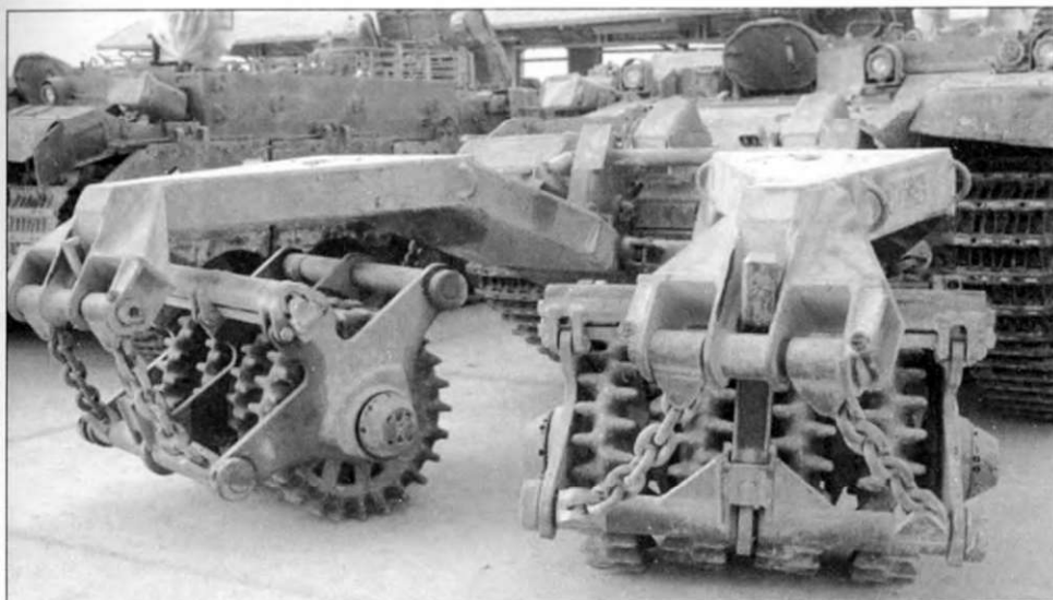
Минный трал «Нохри» представляет собой несколько улучшенный вариант советского минного трала КМТ-5. Массивные крепления катков способны выдержать взрыв противотанковой мины.
