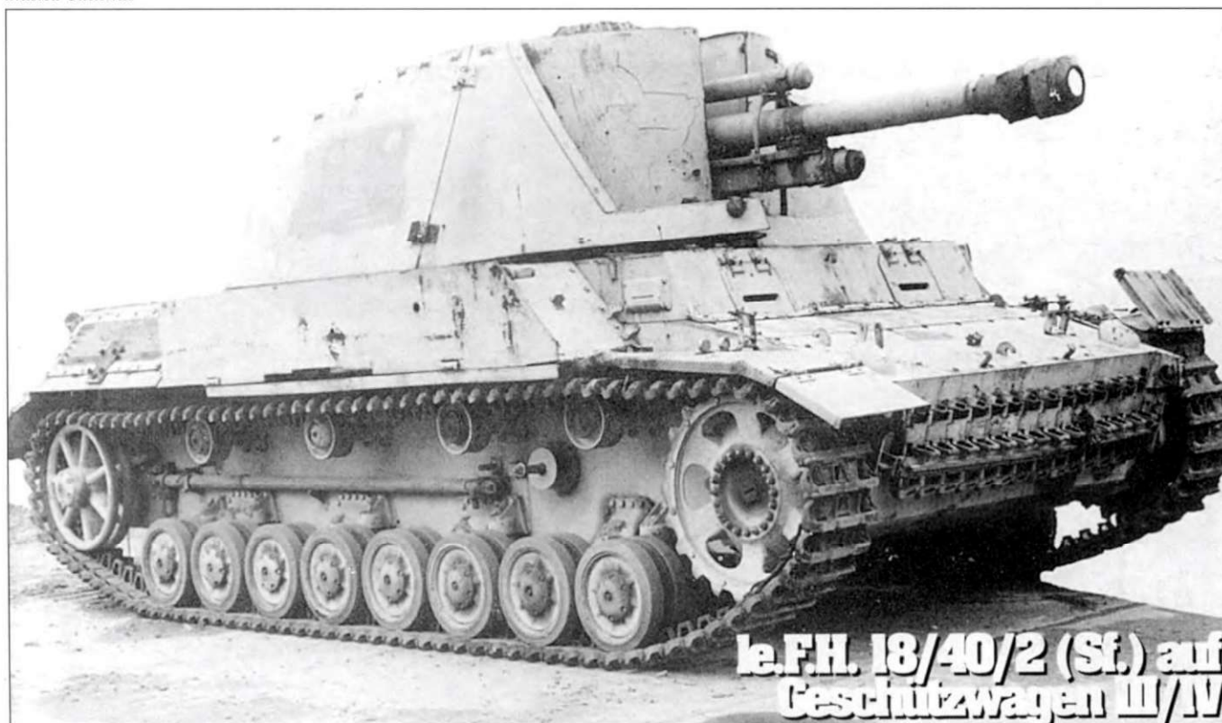
Крюк является частью параллелограммного механизма демонстража башни.
