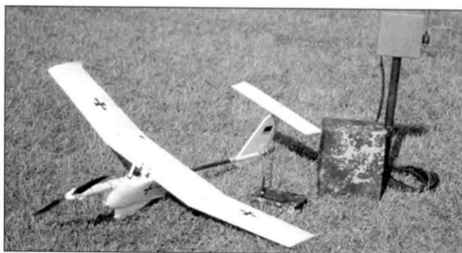
Бронев автомобиль «Феннек» несет миниБПЛА «Аладдин». Система «Аладдин» состоит из пульта управления в рюкзаке и двух БПЛА массой по 3 кг. Размах крыла БПЛА - 146 см. Двум войнам требуется всего пять минут для подготовки БПЛА к запуску.
