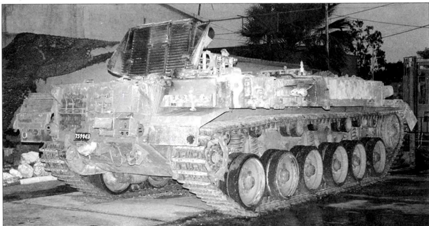
Ночной снимок БМС «Пума» в ремонтной мастерской. Бортовые экраны демонтированы, отчего отлично видна ходовая часть боевой машины саперов, выполненная по аналогии с ходовой частью танка «Меркава».
