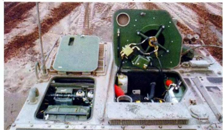
Корма крыши корпуса броневладеца «Феникс». Жалюзи прикрыты металлической сеткой. Справа - платформа с раздвигательным оборудованием. По центру крыши установлен вентилятор с гидравлическим приводом, предназначенный для отсоса газов из моторного отделения.
