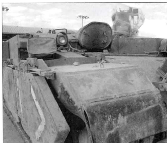
БМС «Пума», детализация передней части машины. Установлены дымовые гранатометы IMI CL-30330 и модуль вооружения «Рафазль» (закрит пластиковым мешком). Люк механика-водителя открыт.
