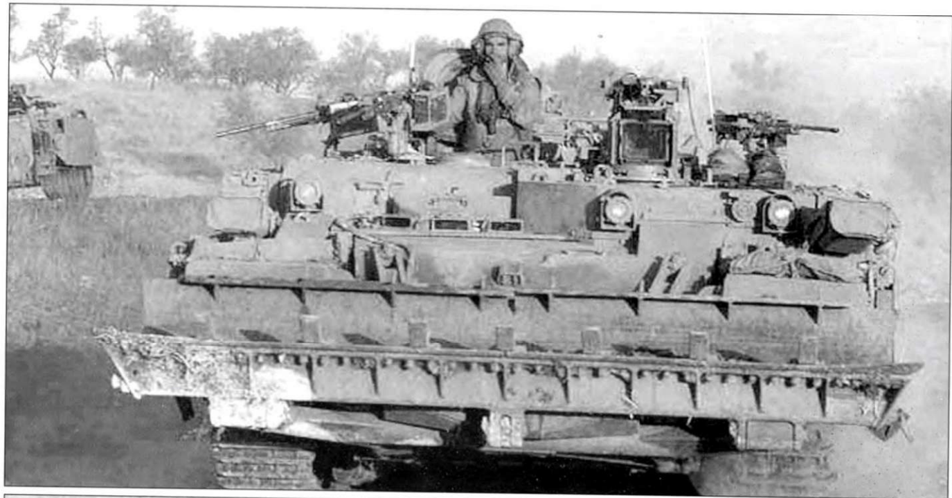
БМС «Пума», оснащенные бульдозерными отвалами. Такие бульдозеры используются для расчистки завалов на дорогах под огнем неприятеля.
