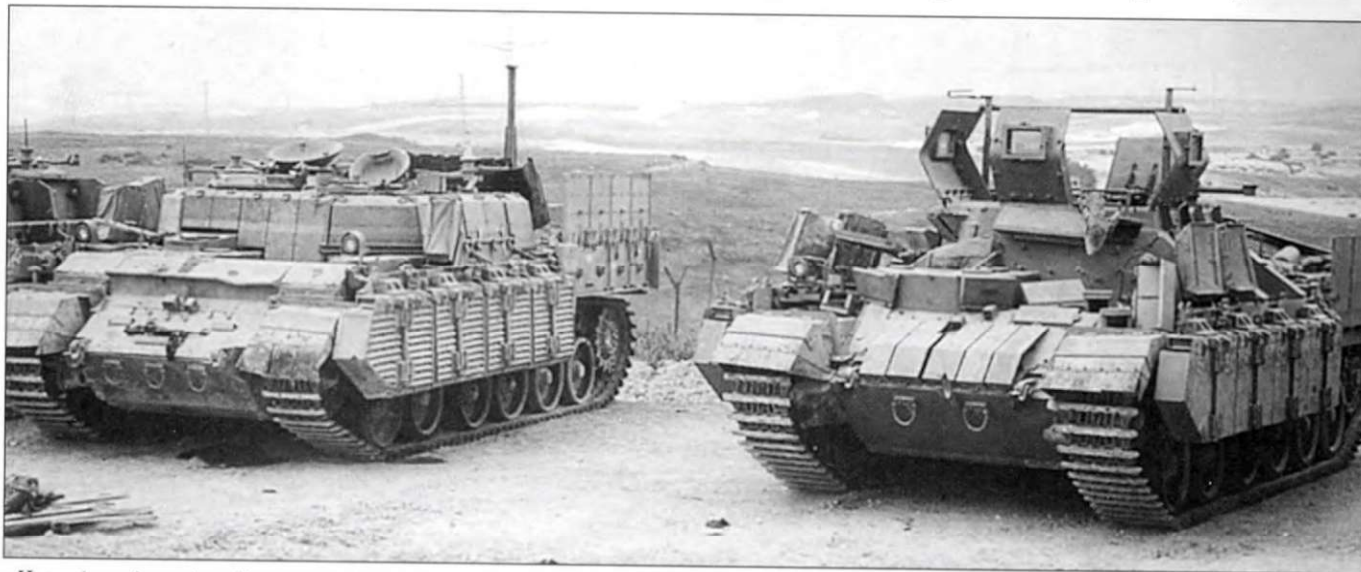
«Накпадон» (слева) и «Нагмачон» (справа) в учебном центре, дислоцированном в пустыне Неgev, 2000 г. Здесь личный состав осваивает тяжелые танковые бронетранспортеры. «Накпадон» отличим по массивной и более низкой надстройке. Задние секции бортовых экранов обеих машины сделаны более легкими по сравнению с передними. Задние секции экранов часто поднимали в вертикальное положение. Так они давали экипажу возможность сравнительно безопасно покинуть в бою машину через люк в задней стенке надстройки.
