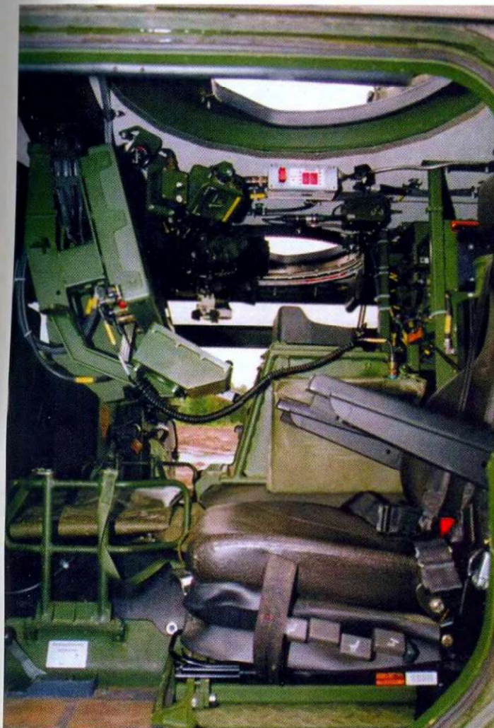
Сиденье командира и сиденье оператора. Над обоими сиденьями в крыше корпуса сделаны круглые люки. Сиденья регулируются по высоте. Спинки сидений складные.
