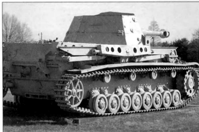
Ныне самоходка выставлена в экспозиции музея Абердинского полигона, шт. Мэриленд. По сравнению с другими образцами техники, выставленными под открытым небом, эта единица музейного хранения выглядит хорошо. На снимке видны откидной кормовой бронелист башни машины и механизм демонтажа башни.
