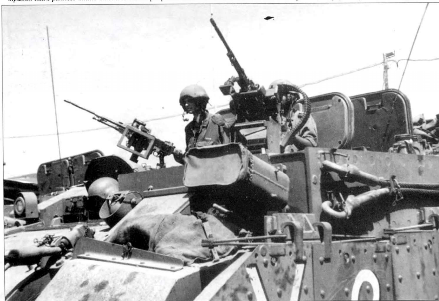
Крупный план той же самой машины. Блоки дымовых гранатометов расположены горизонтально, в то время как на большинстве израильской бронетехники они смонтированы вертикально. Эти блоки по размерам больше стандартных CL-3030.
