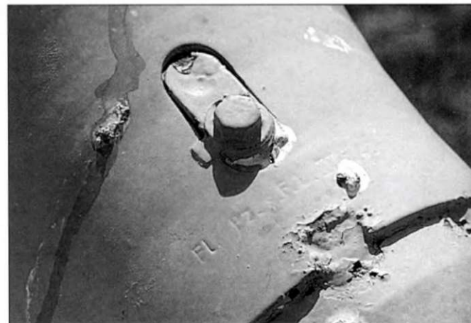
Болт крепления дульного тормоза к стволу 105-мм гаубицы. Американцы банально приварили дульный тормоз к стволу.
