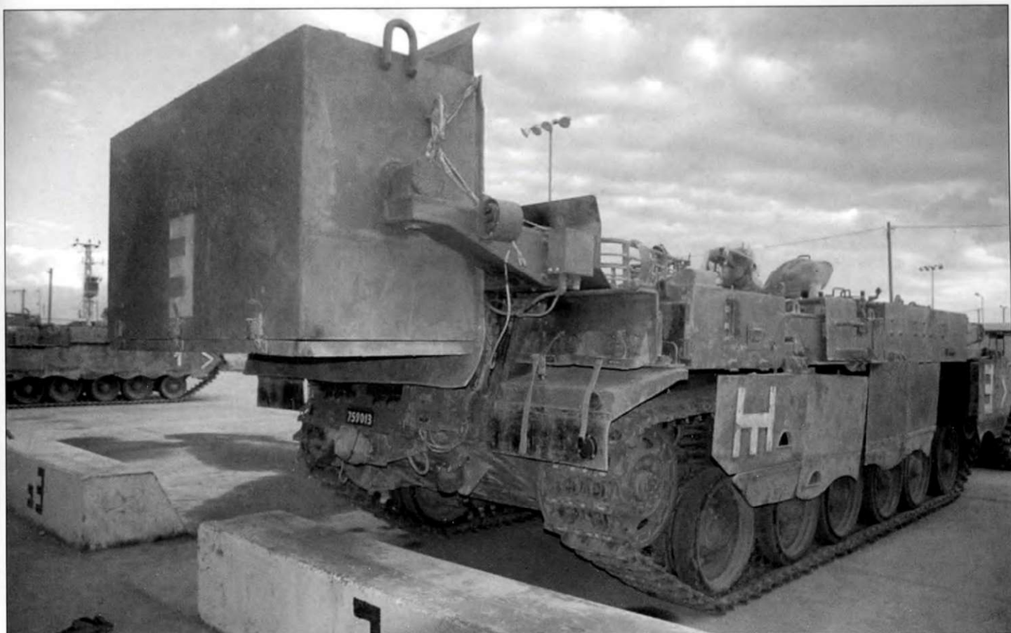
БМС «Пума» с минным тралом РКМ «Ночри» каткового типа и системой активного разминирования «Карпет». Одной из основных задач БМС «Пума» является устройство проходов в минных полях. «Пума» - сокращение от Пороц Мокишм Хандасати - саперная машина разминирования.
