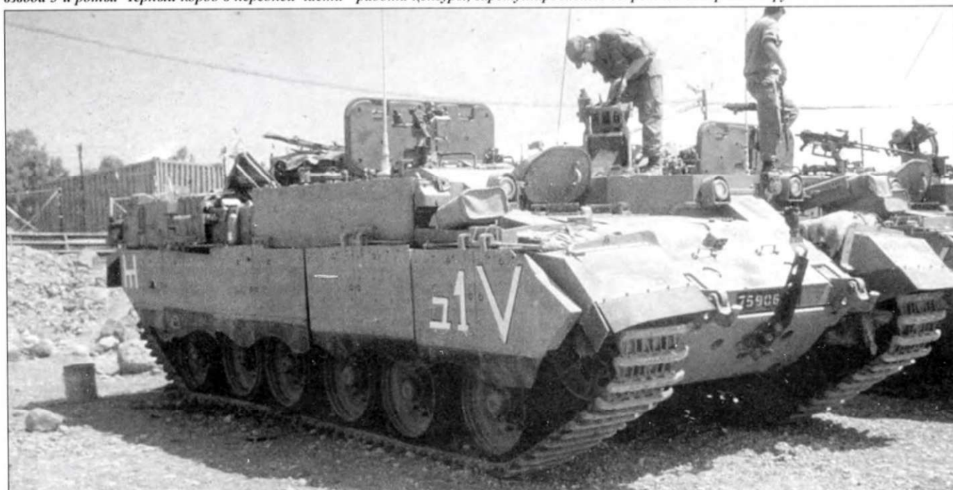
«Пума», вид сбоку, спереди и сзади. Центральные секции бортовых экранов установлены криво. На задней секции бортового экрана изображен тактический символ саперного подразделения. Маркировка на передней секции бортового экрана обозначает 2-ю машину 1-го взвода 3-й роты. Черный короб в передней части - работа цензуры, заретушировавшее секретное саперное оборудование.
