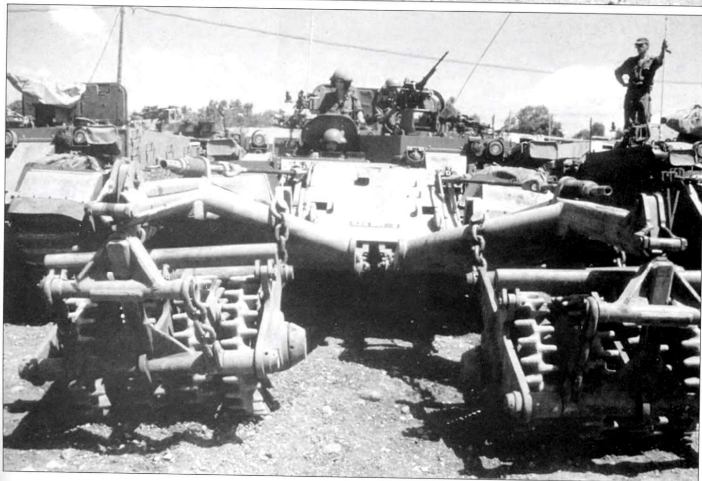
Боевая машина саперов «Пума» с навешенным на нее минным тралом РКМ, вид слева. Трал является копией советского КМТ.
