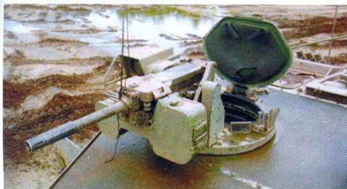
Для самообороны броневладелец «Феникс» вооружен автоматическим гранатометом Хеклер и Кох тип 1530 калибра 40 мм. Дальность стрельбы гранатомета 600 м. Гранатомет установлен на турели кругового вращения, сектор вертикального наведения - от -7 до +40 град. Предусмотрено дистанционное управление стрельбой из гранатомета.
