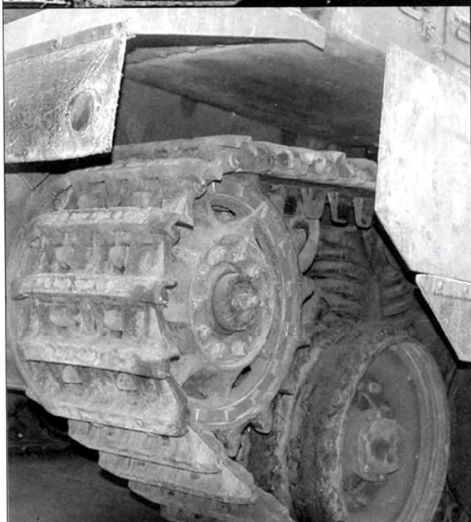
Снятая секция бортового экрана позволяет увидеть элементы ходовой части БМС «Пума». Оригинальная подвеска «Центуриона» заменена подвеской, выполненной по типу подвески танка «Меркава».
