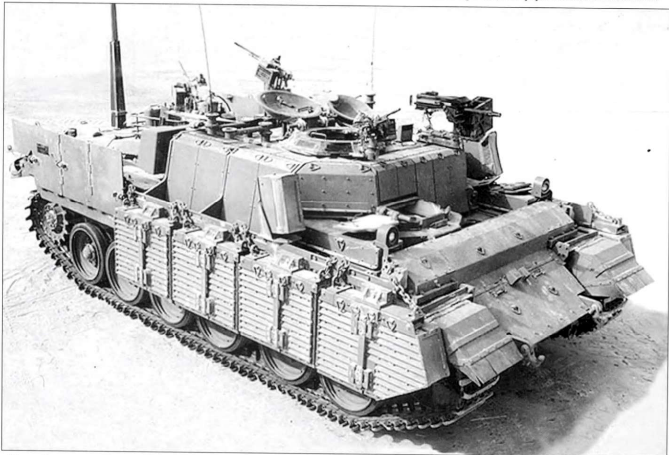
«Накпадон» в стандартной боевой конфигурации. Хорошо виден станковый автоматический гранатомет Mk 19 и три 7,62-мм пулемета.
