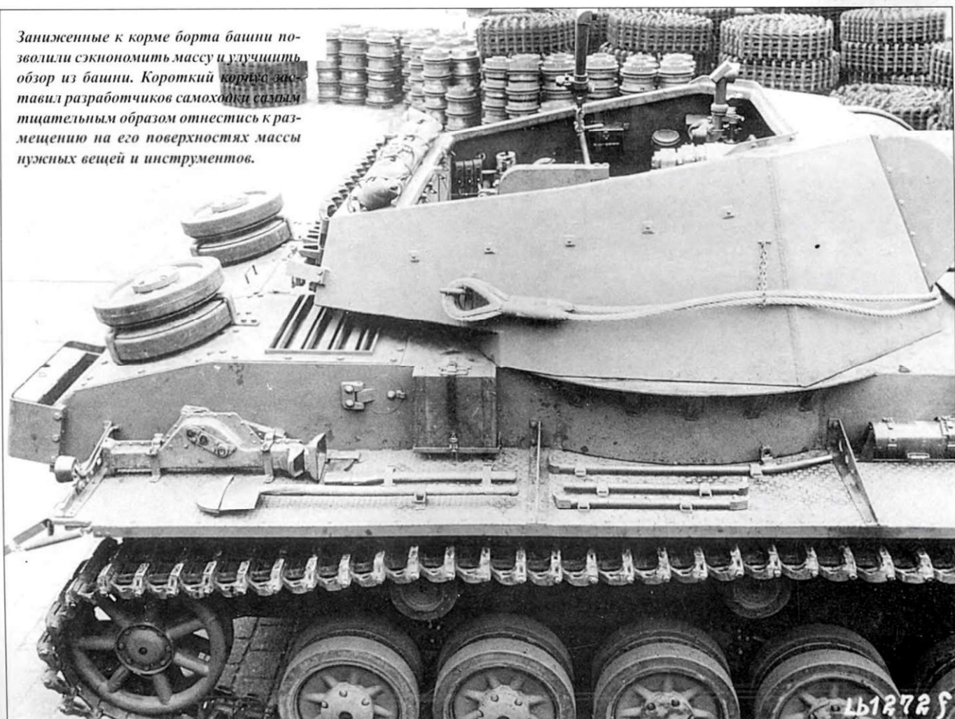
Компактный глушитель 6-цилиндрового двигателя жидкостного охлаждения Майбах HL-66 смонтирован на корме корпуса самоходки. На задней стенке башни закреплены запасные траки.
