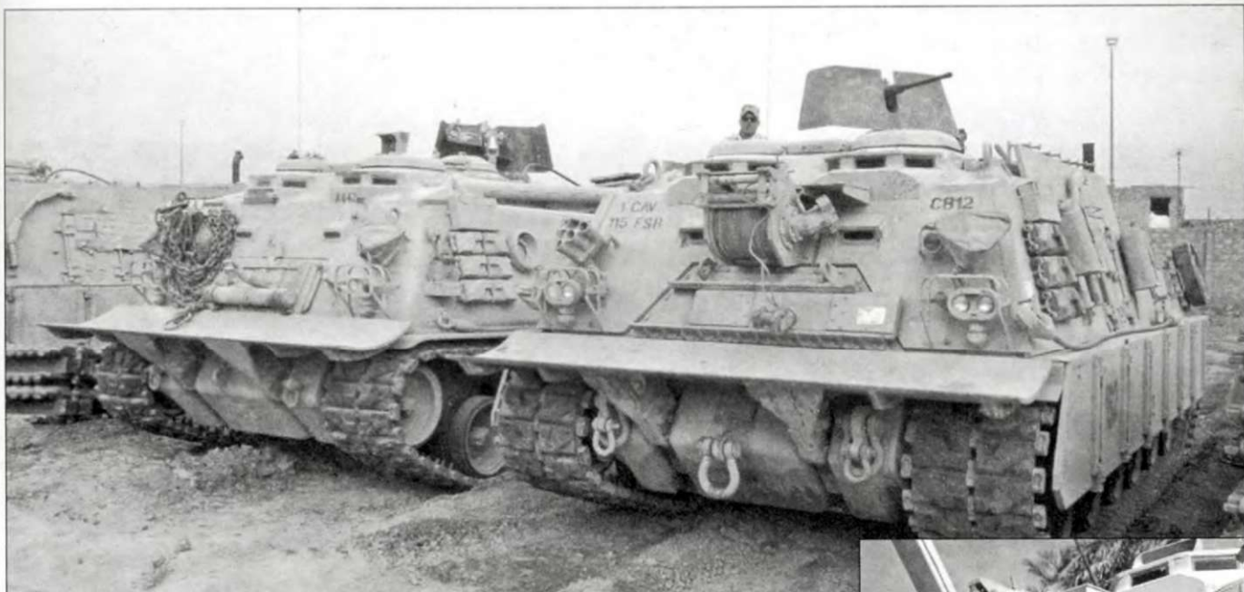
Старое и новое: слева М88А1, справа - М88А2 «Геркулес». Бросается в глаза установленная в лобовой части М88А2 2,7-тонная лебедка и закрывающие ходовую часть краны.
