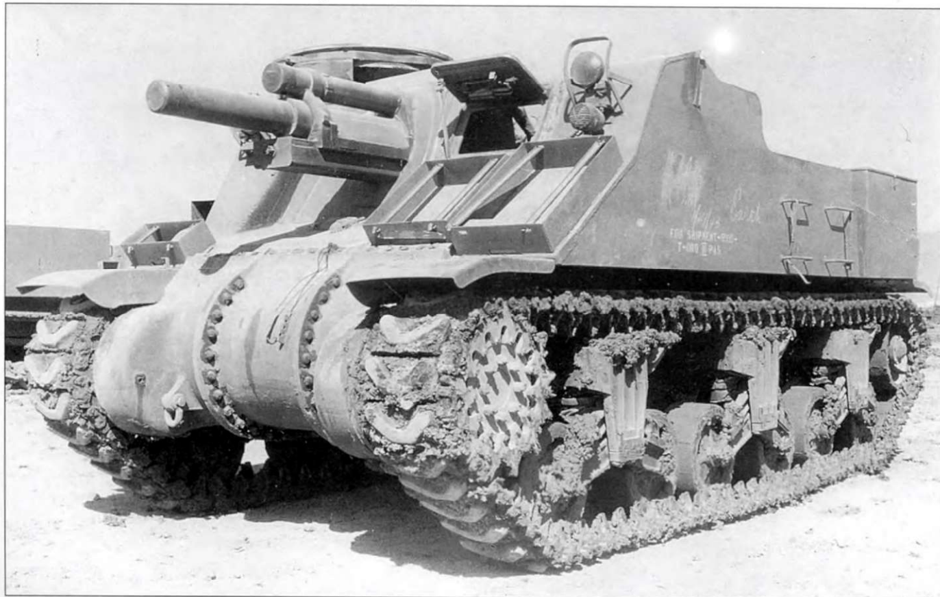
Самоходка М7 среднего выпуска, снимок сделан в Северной Африке. Конструкция бортовых спонсонов изменена, их крышки могут откидываться только вверх. Машины среднего выпуска часто отличались сочетанием бортовых спонсонов от танка М3 «Ли» и колпаками трансмиссий от танка М4 «Шерман».
