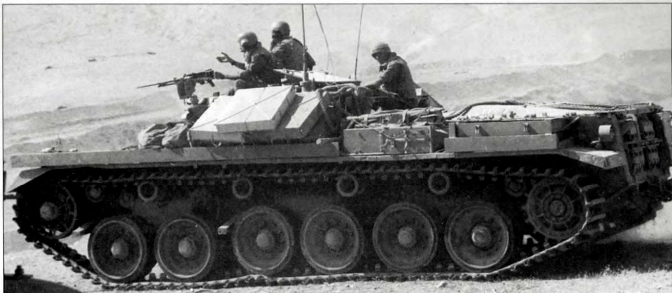
Бронетранспортер «Нагмашот» поздней постройки. Машина вооружена единственным пулеметом FN калибра 7,62 мм. Установлено всего несколько блоков динамической защиты «Блэйзер». На нижнем снимке машина оснащена толстыми бортовыми экранами позднего типа.
