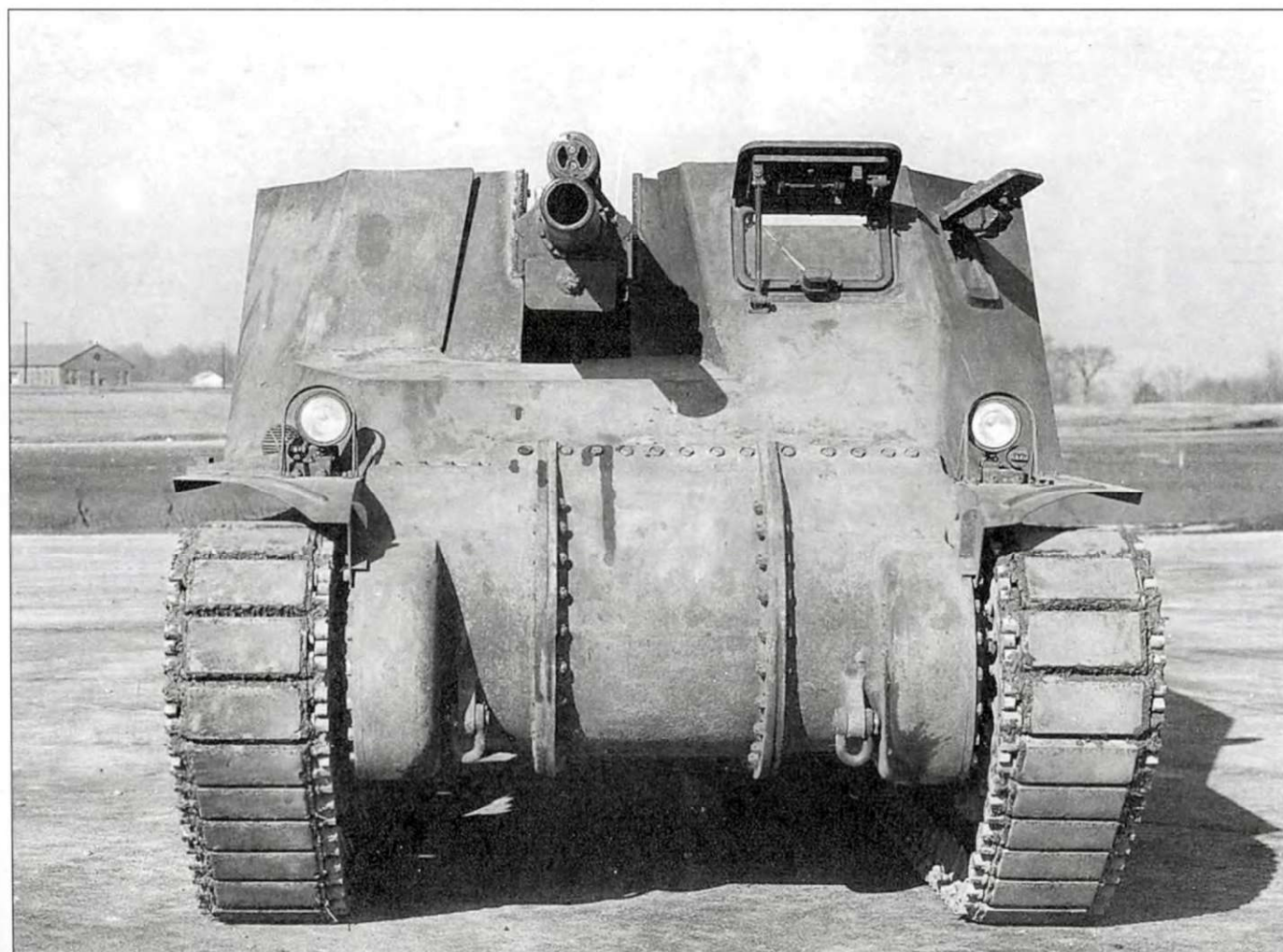
Самоходку T32 вооружили 105-мм гаубицей M2A1, гаубица была смещена несколько вправо относительно продольной оси корпуса. Изначально возимый боекомплект к гаубице состоял из 44 унитарных снарядов. Как на ранних M7, колпак трансмиссии самоходки T32 состоял из трех деталей.
