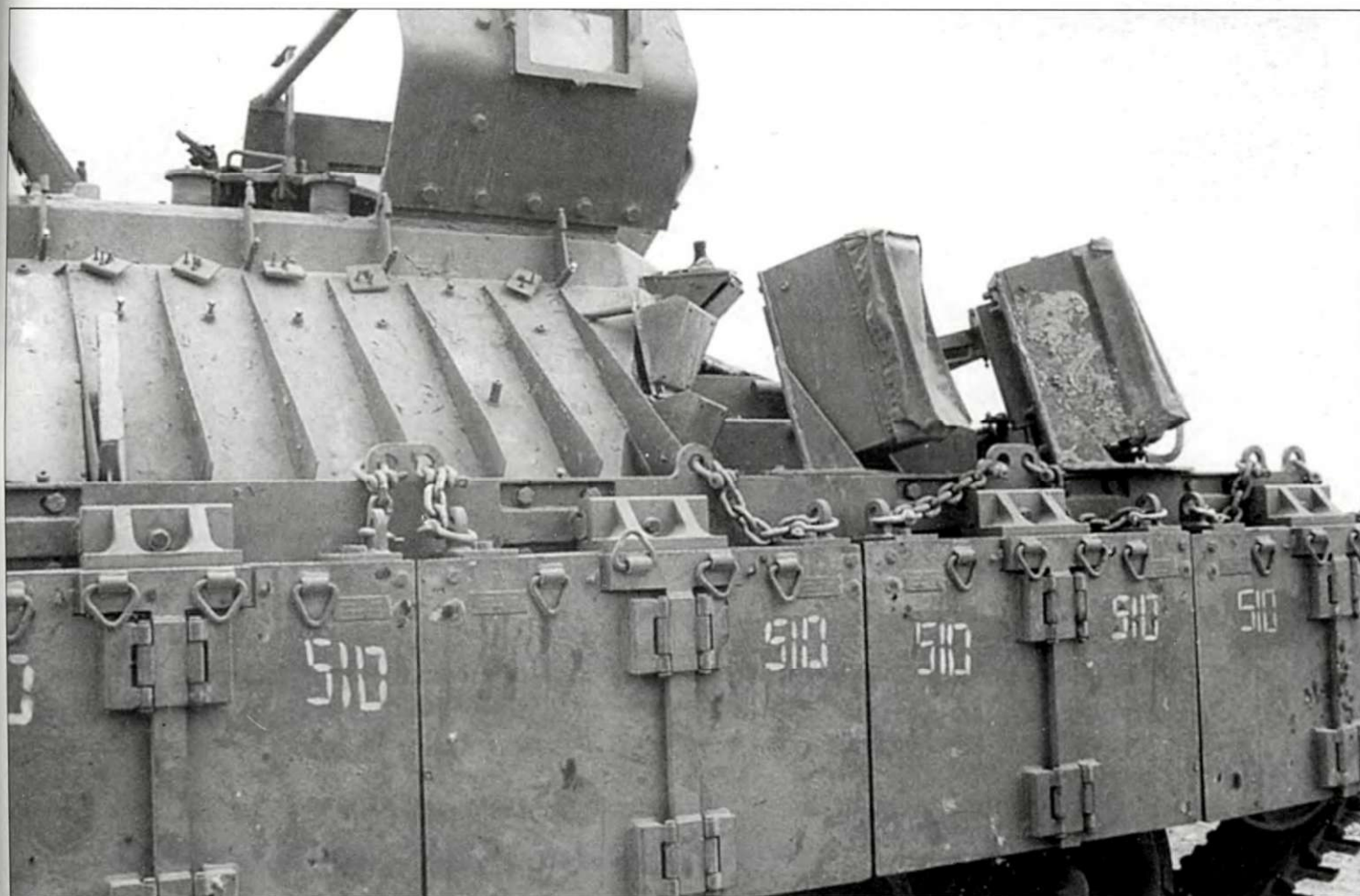
Вид сбоку бронетранспортера «Нагмачон». На стенке рубки есть крепления для блоков динамической защиты. Массивные секции бортовых экранов крепятся к корпусу мощными петлями.
