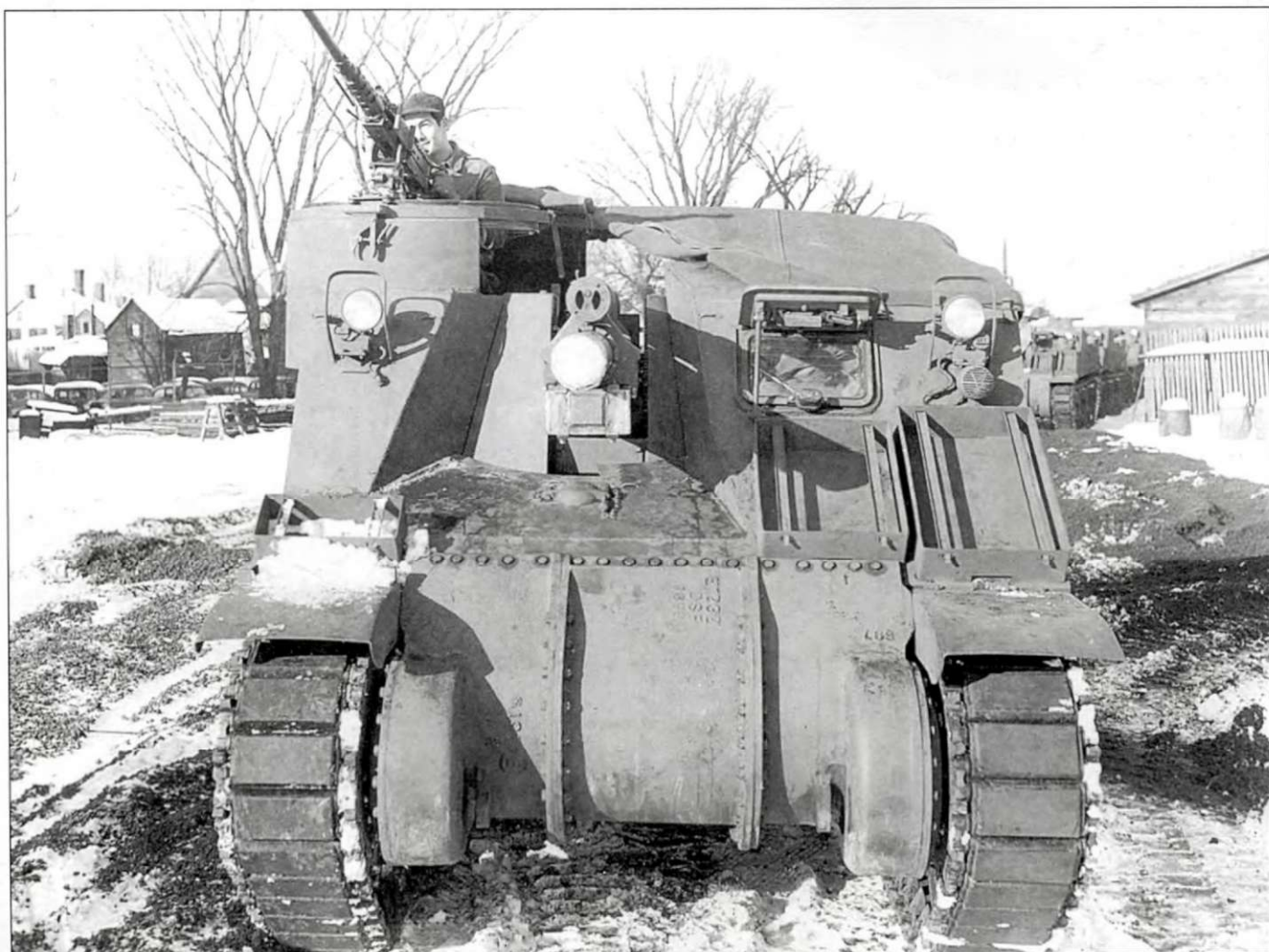
Смотровое окно механика-водителя закрывалось откидной бронекрышкой, в которой была сделана смотровая щель, которая закрывалась бронезаслонкой. Остекление окна снабжено дворником. Фары у ранних «Пристов» прикрывались ограждением, на машинах поздней постройки фары сместили ниже, как на этой машине среднего выпуска.
