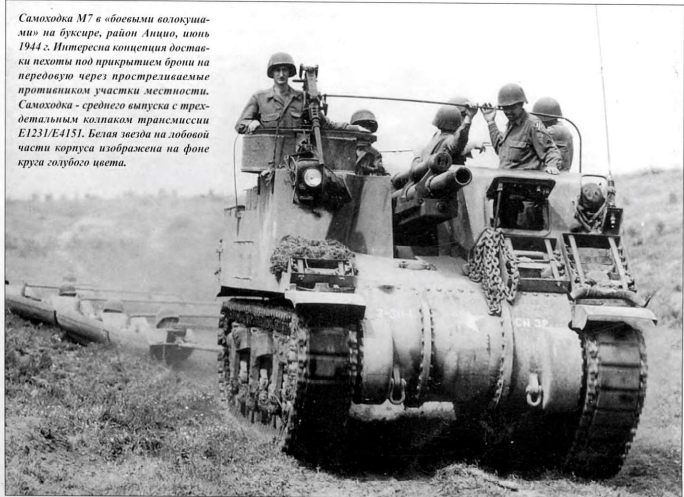
Самоходки М7 «Прист» строились тремя фирмами - Американской локомотивной компанией, Федерал Мэшин энд Велдер, Прессед Стил Кар Компании. Изменения в технологический процесс изготовления самоходок вносились не одновременно, поэтому нередко на «новых» машинах встречались «старые» узлы. На снимке - самоходка с серийным номером «1850» выпуска ALCO декабря 1942 г. со «старым» верхом рубки, но новой ходовой частью D47527.
