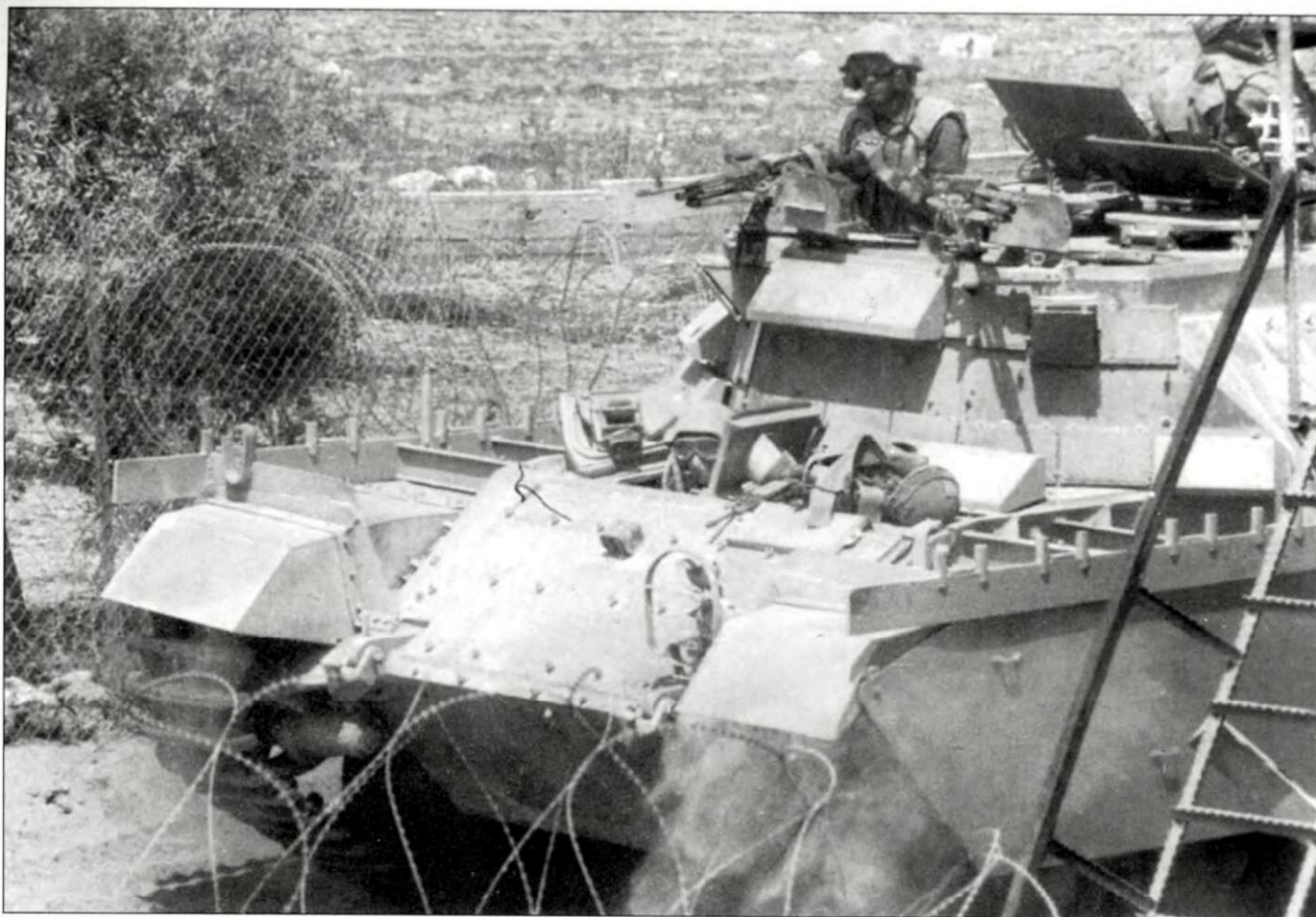
Бронетранспортер «Нагмашон» поздней постройки с несколько увеличенной высотой рубки - обратите внимание на переход от наклонных стенок рубки к вертикальным..
