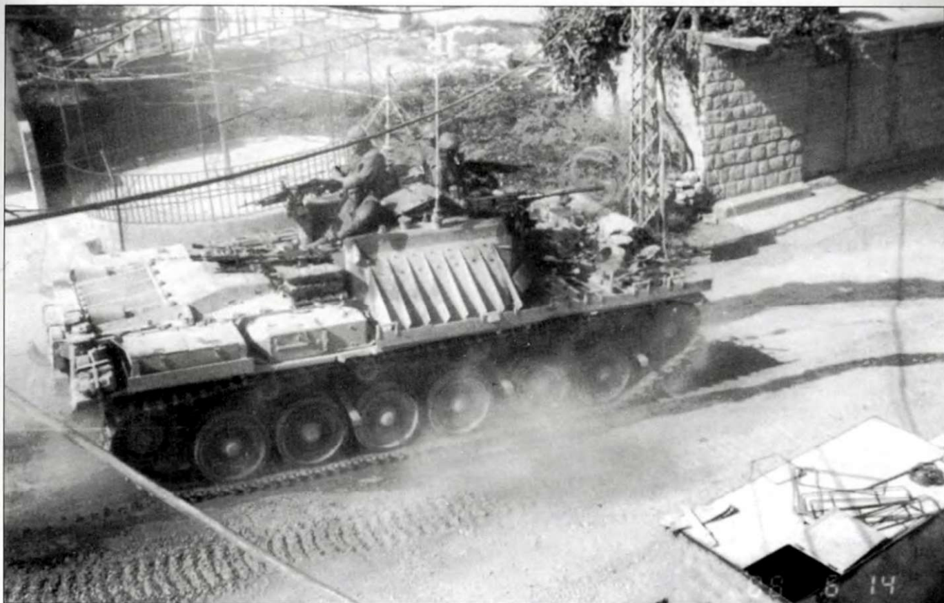
Опять тот самый «Нагмашот». Машина вооружена тремя пулеметами: одним калибра 12,7 мм и двумя калибра 7,62 мм.
