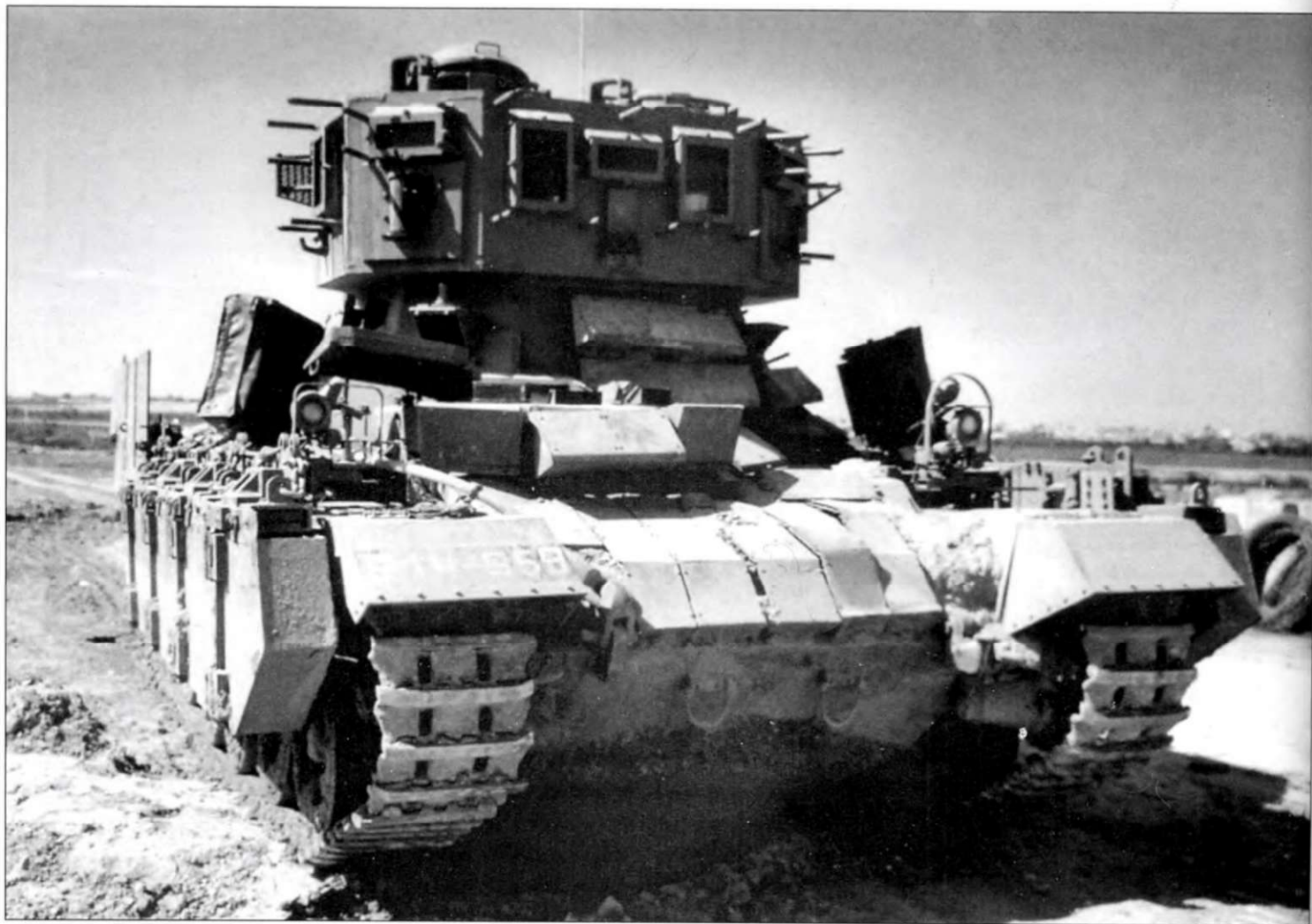
Впечатляющие снимки чудовища - а вот не надо танковым конструкторам смотреть «Звездные войны» и играть в компьютерные игры! На корпусе установлены блоки динамической защиты, на рубке их нет.
