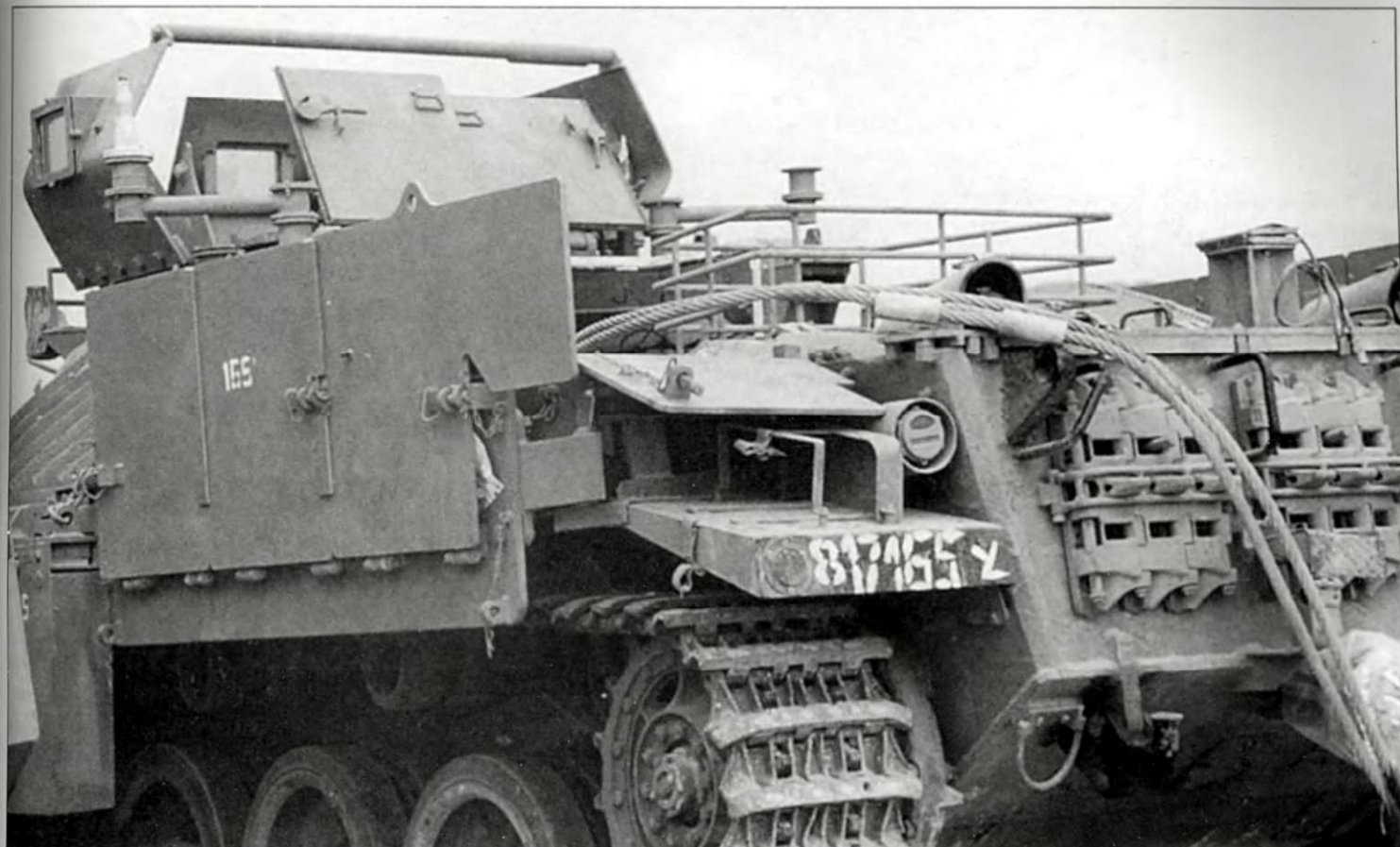
Вид в корму бронетранспортера «Нагмачон». Задняя секция бортового экрана поднята в вертикальное положение. Поднятые с обоих бортов секции экранов дают некоторую защиту от огня стрелкового оружия людям, находящимся на крыше моторно-трансмиссионного отделения.
