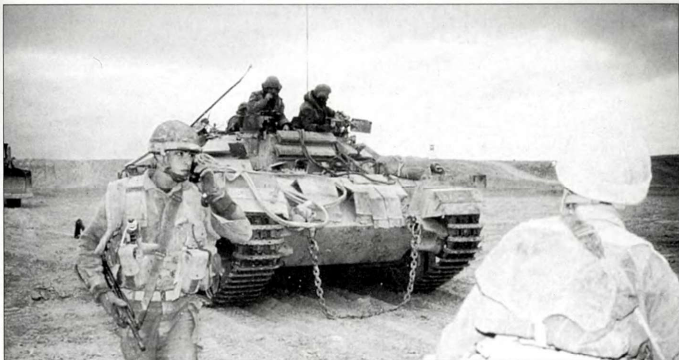
«Нагмашот» доказал свою эффективность во время городских боев в Ливане. На фото сверху показана машина с реактивной броней на рубке и лобовой части корпуса.
