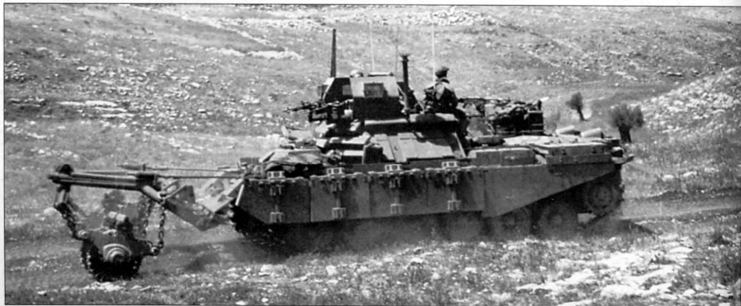
Борт «Нагмачон Мифлесет», на основании рубки установлены блоки динамической защиты. На секции экранов также предусмотрена возможность монтажа блоков динамической защиты. В правой части снимка - прямоугольный блок дымовых гранатометов.
