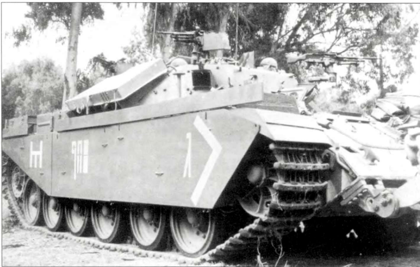
Та же самая машина - ранний «Нагмашот». На стенках рубки установлены адаптеры под крепление блоков динамической защиты, сама реактивная броня отсутствует. Шеврон обозначает 2-ю роту, буква иврита - 3-й взвод, далее следует надпись «чайка» на ивритском языке и тактический символ саперного подразделения.
