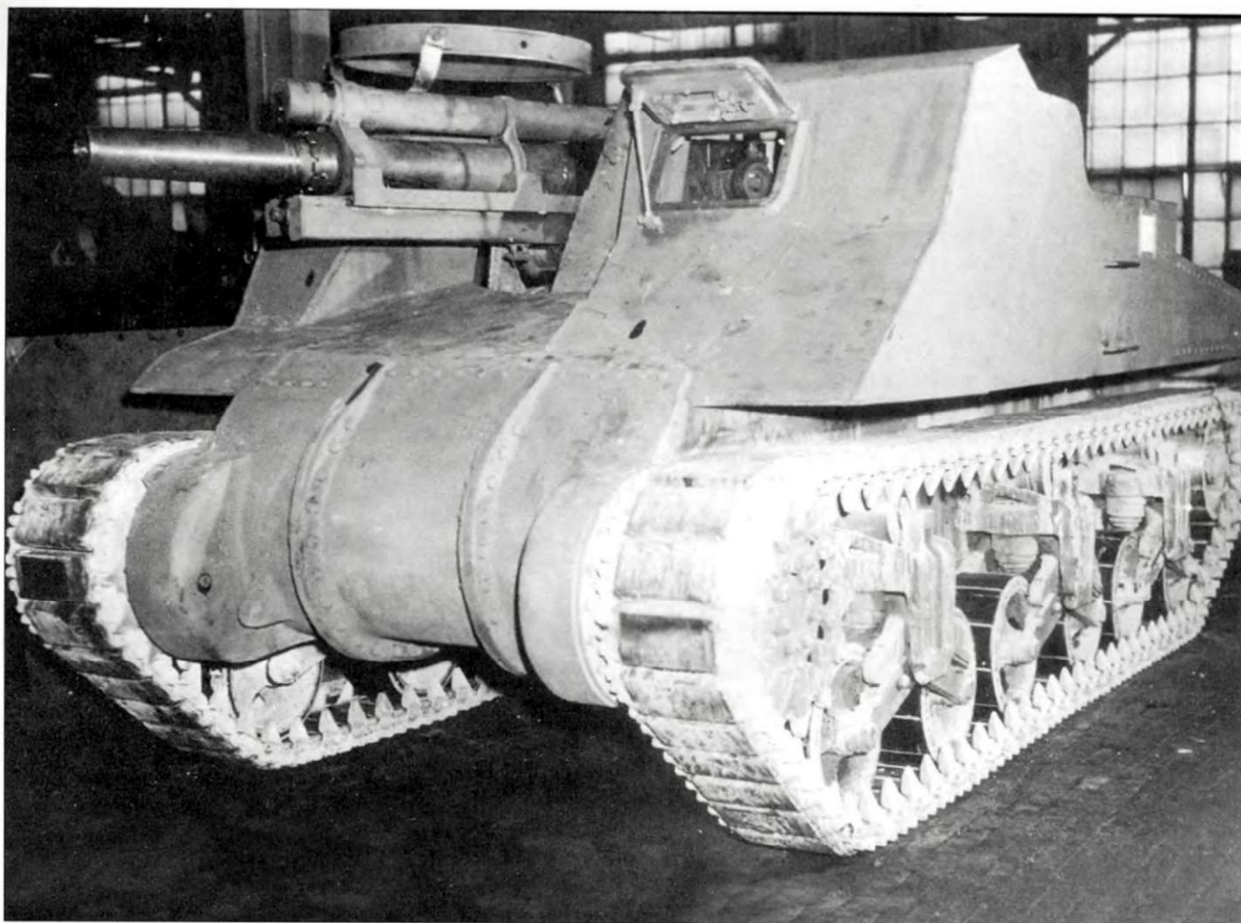
Второй опытный образец самоходной гаубицы Т32 был интенсивно доработан в Форт-Кноксе. Возимый боекомплект увеличили до 57 снарядов, экипаж увеличили до семи человек. Высота бортовой брони была уменьшена на 11 дюймов, в то время как высота лобовой стенки бронерубки увеличена на 3 дюйма. Была смонтирована кольцевая турель для зенитного пулемета.
