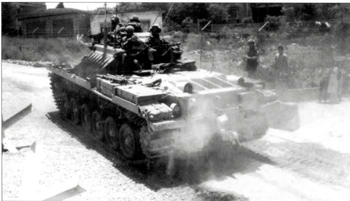
Вид бронетранспортера «Нагмашот» с кормы. Пехотинцы сидят за рубкой лицами в корму.
