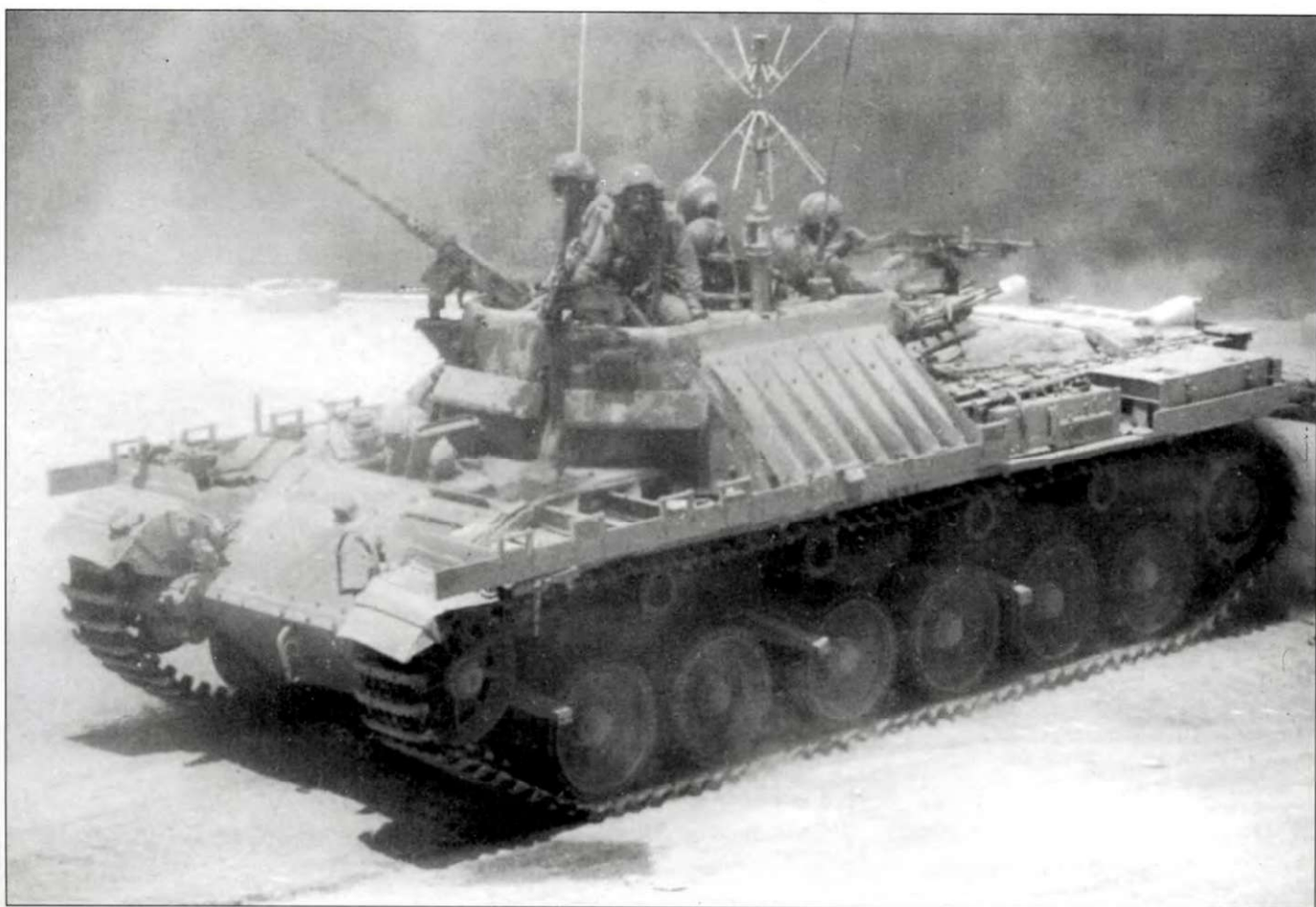
Тот же самый «Нагмашот» в клубах пыли и дыма. Назначение антенны фантастического облика непонятно. Обратите внимание на бронеклапки выхлопных патрубков в корме корпуса.
