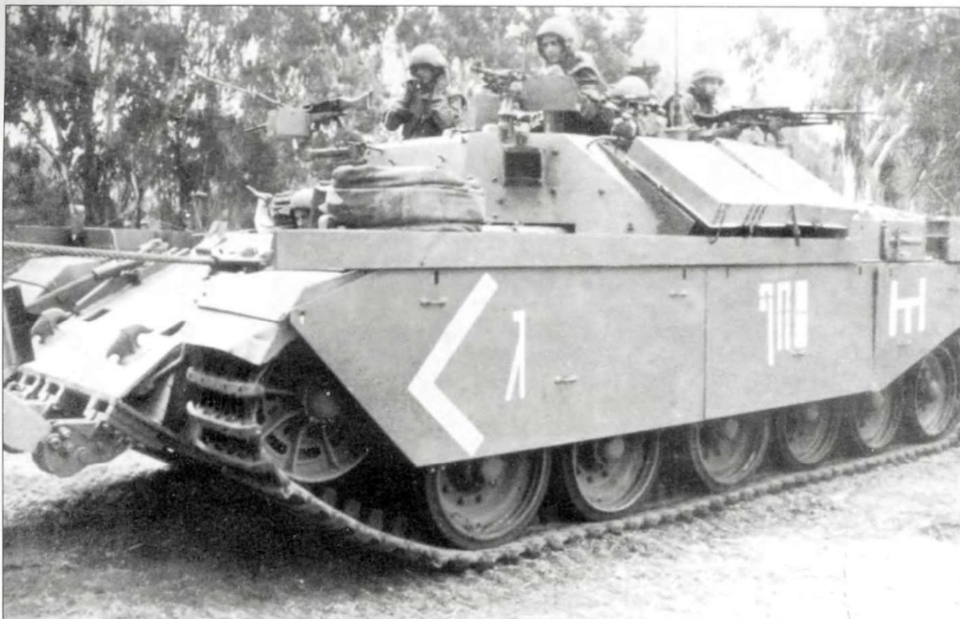
«Нагмашот» ранней постройки, его надстройка ниже, чем рубки более поздних бронетранспортеров на шасси танка «Центурион». Интересный момент: члены экипажа одели шлемы разных типов. В лобовой части корпуса бронетранспортера смонтирован узел навески минного трала. По бортам рубки закреплены маты от мин. Маты используются саперами при подозрении местности на наличие минного поля.
