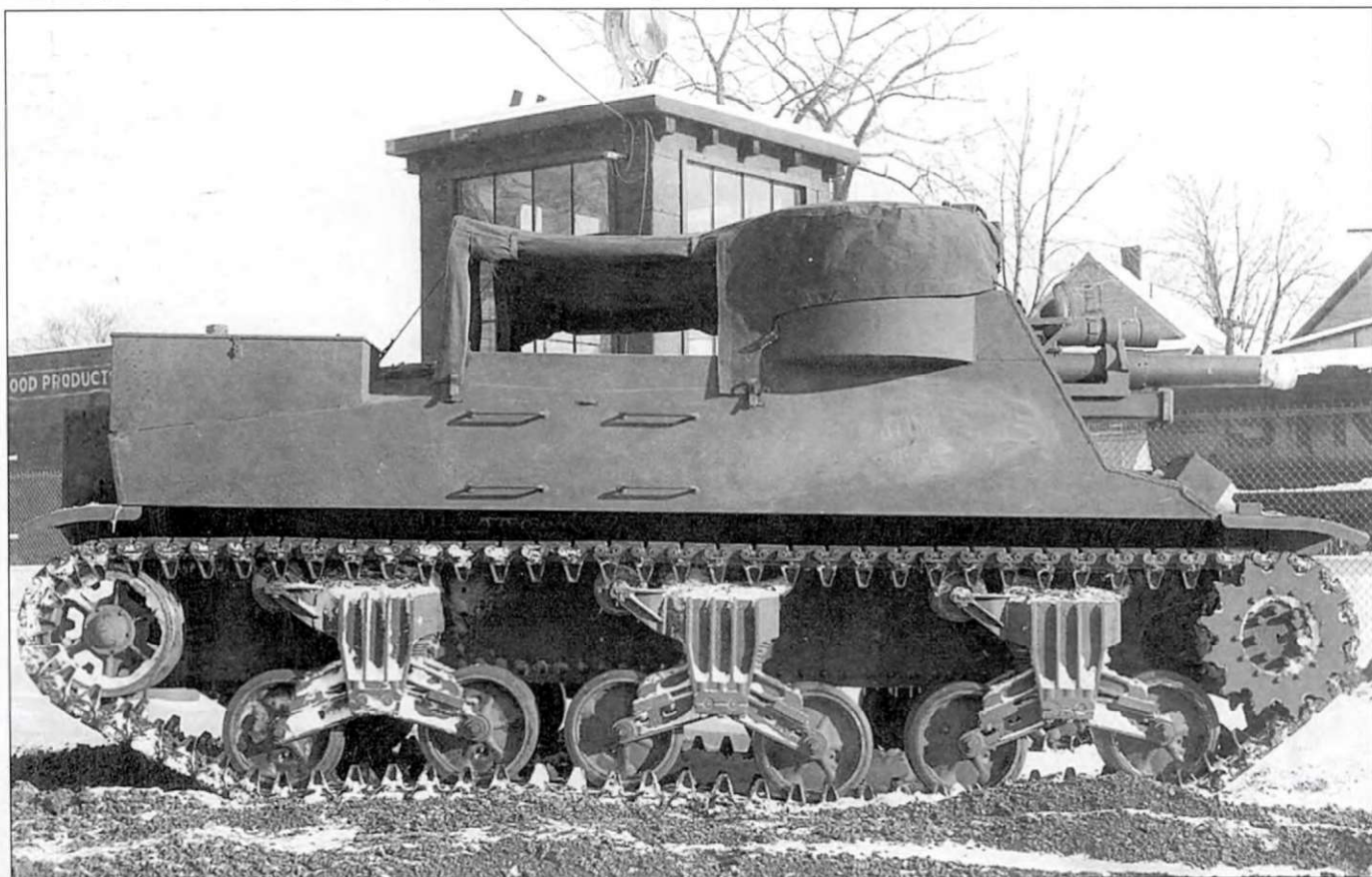
С января 1943 г. борта рубок «Пристов» стали делать еще более низкими - в боевом отделении стало не так тесно. Однако, с такими бортами после января 1943 г. строились далеко не все самоходки.
