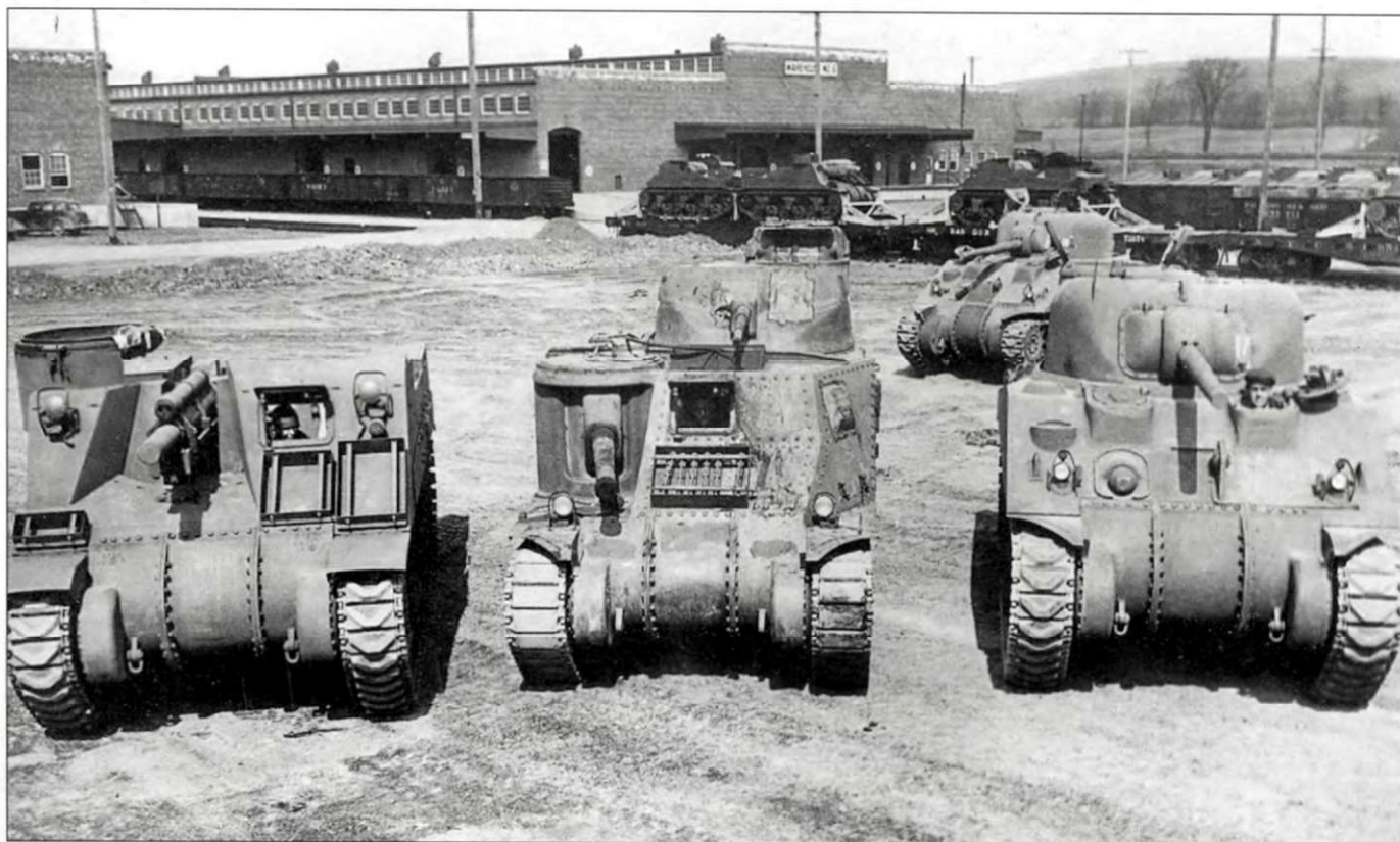
Снимок сделан на заводе ALCO вероятно в начале 1943 г. Трио образцов бронетехники, которые выпускал Американский локомотивный завод: «Прист», «Ли» и «Шерман». Серийное производство танков М3 «Ли» завершилось на ALCO в августе 1942 г. На самоходке М7 стоят тележки с опорными катками от танка М3, что дает возможность примерно датировать снимок.
