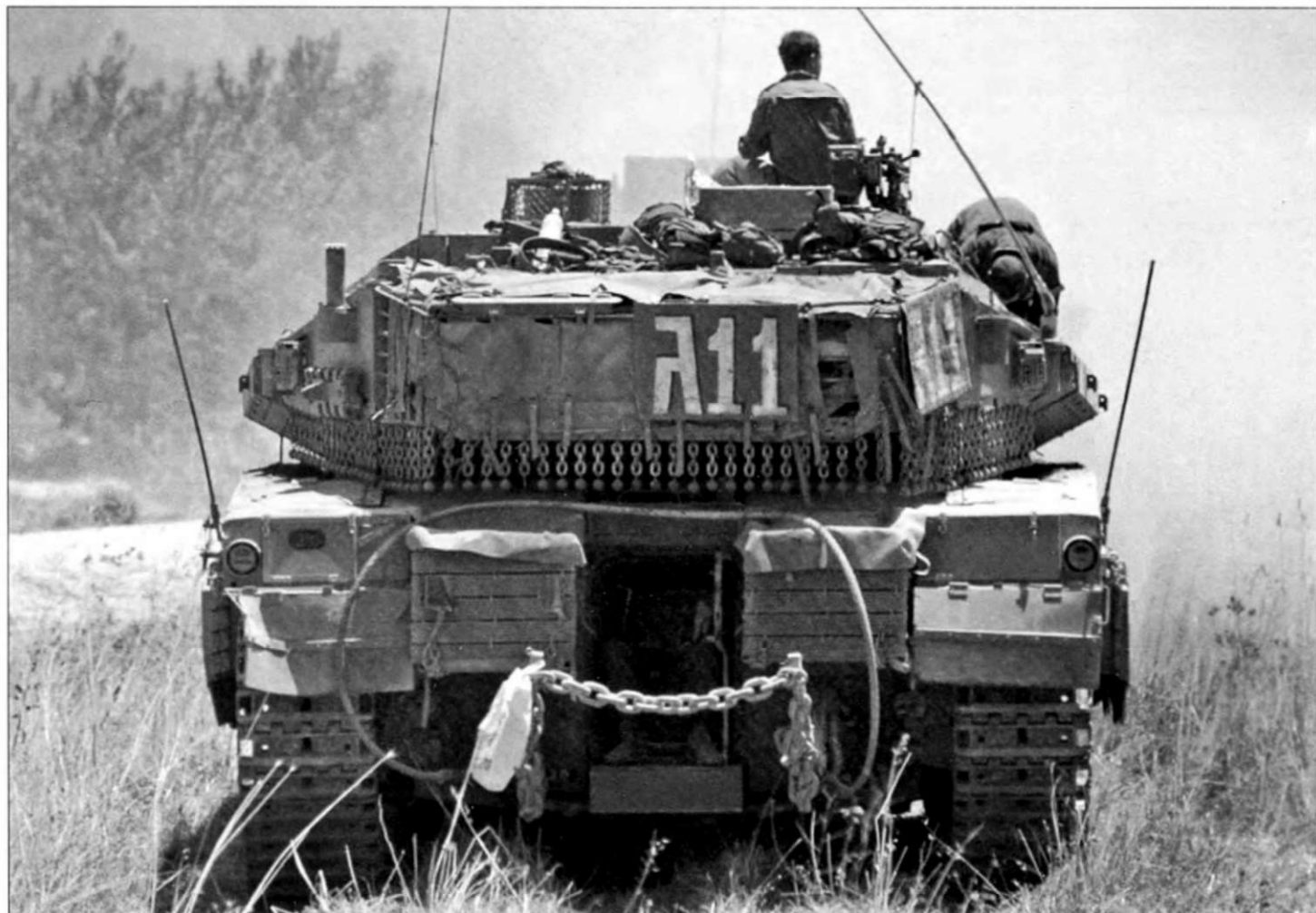
Вид сзади танка «Меркава-4», корма не сильно отличается от кормы танка «Меркава-3» с броней «Дор Далет». Обратите внимание на новые траки гусениц.
