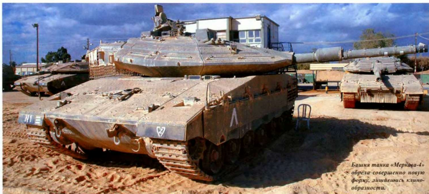
Превосходная фотография танка «Меркава-4», огромная башня повернута на борт. На нижней поверхности скулы башни хорошо видны головки заклепок. Знаменитые цепи с шармами - фамильная черта всех «Меркав». На крыше башни - кресло инструктора. Видна также мачта с датчиками атмосферных параметров.
