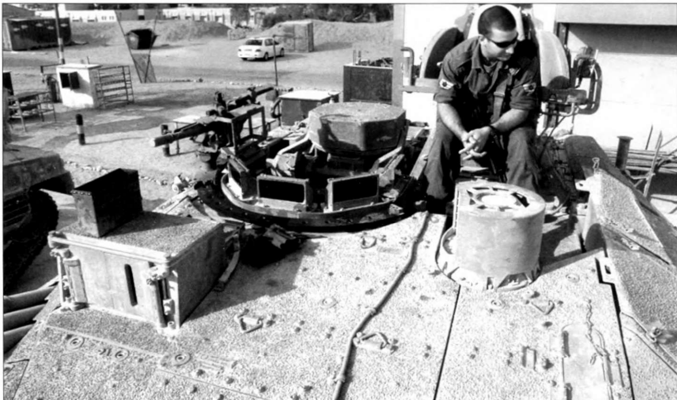
Детализировка крыши башни танка «Меркава-4». Цилиндрический объект перед сидящим в кресле инструктором - основной независимый прицел командира. Правее воина - командирская башенка. Крышка люка откинута. Толщина крышки - без комментариев! В правой части башни (на переднем плане) - бронекоржух основного прицела наводчика.
