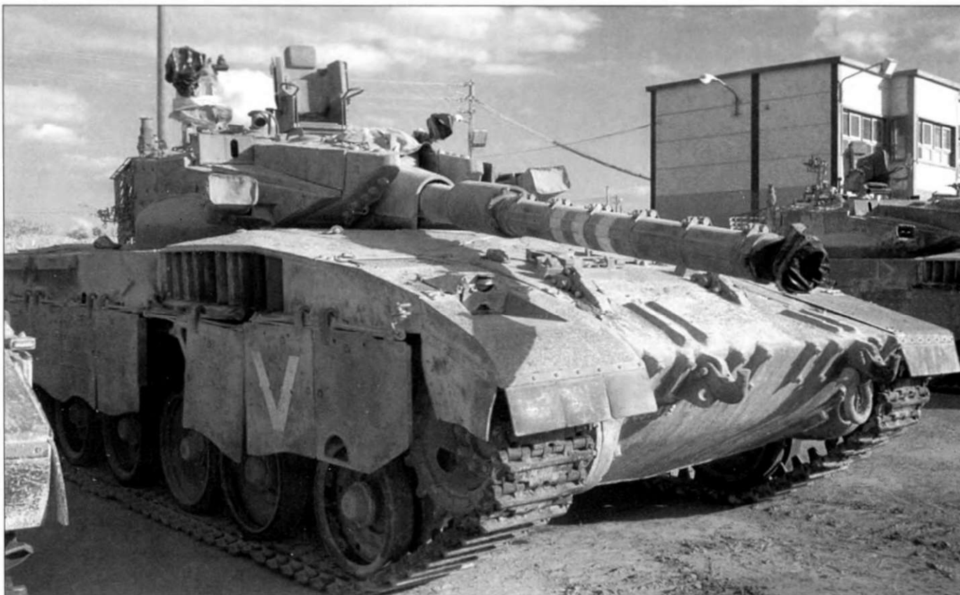
Основной боевой танк «Меркава-2», одна секция бортового экрана снята. Первый опорный каток отличается от остальных. Гусеницы набраны из траков позднего типа.
