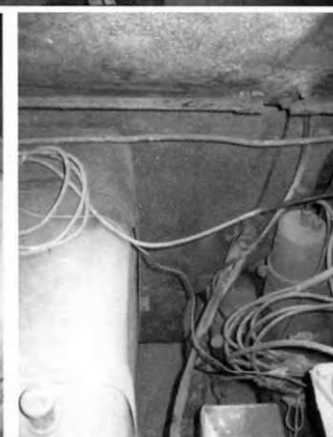
радиатор, часть топливного бака, приводные ремни, нижняя бронеплита моторного отсека.
