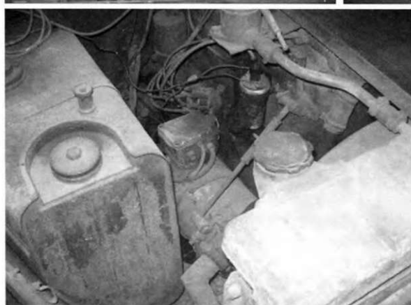
радиатор, часть топливного бака, приводные ремни, нижняя бронеплита моторного отсека.
