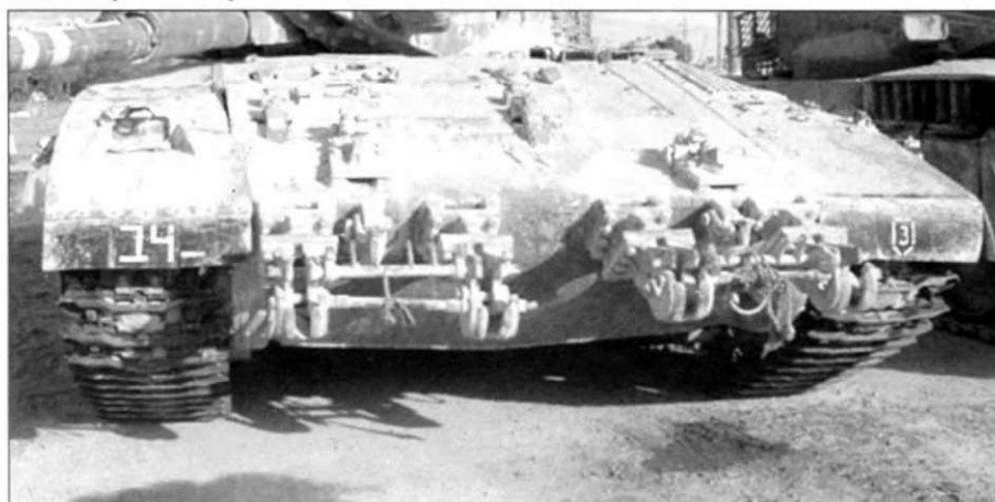
Основной боевой танк «Меркава-2», одна секция бортового экрана снята. Первый опорный каток отличается от остальных. Гусеницы набраны из траков позднего типа.
