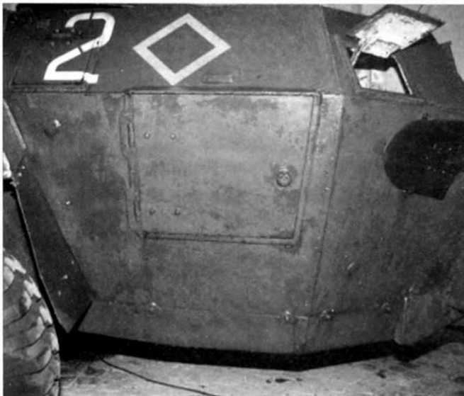
Крупный план открытого смотрового лючка в левом борту бронееавтомобиля, аптечка пер- вой медицинской помощи, радиоантенна и зад- ний смотровой блок.
