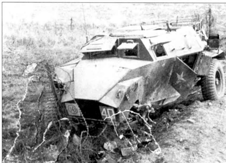
Подорвавшийся на mine «Хамбер» их штаба британской 51-й дивизии. В кормовой части машины над моторным отделением виден импровизированный проволочный багажник.
