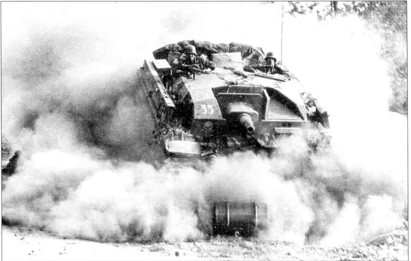
Пропагандистский снимок штурмового орудия StuG III Ausf. B , самоходка в динамике. Машина из 192-го батальона штурмовых орудий, на крыше рубки нанесена свастика для быстрого опознавания с воздуха.
