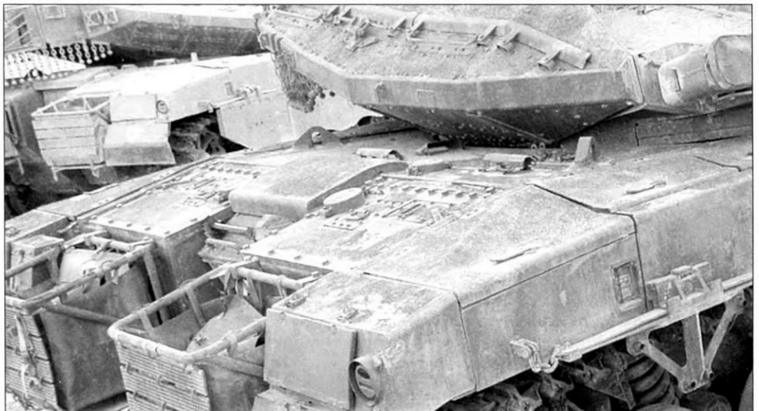
Танки «Меркава-3» с броней «Дор Далет» (справа) и без нее (слева).
