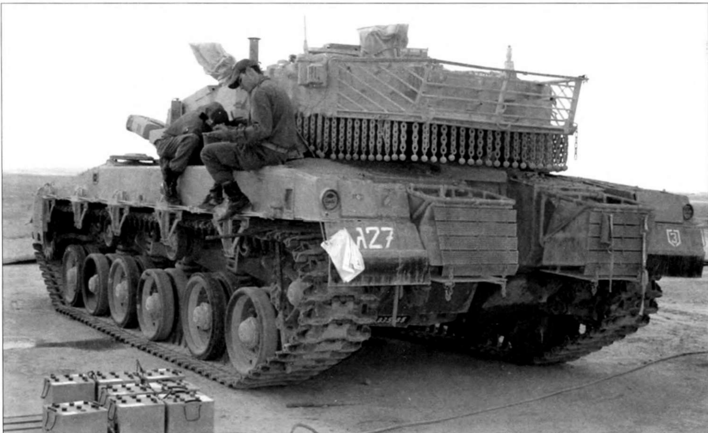
На снимке отлично видны элементы надежной ходовой части танка «Меркав-3». Обратите внимание на узлы навески секций бортовых экранов.
