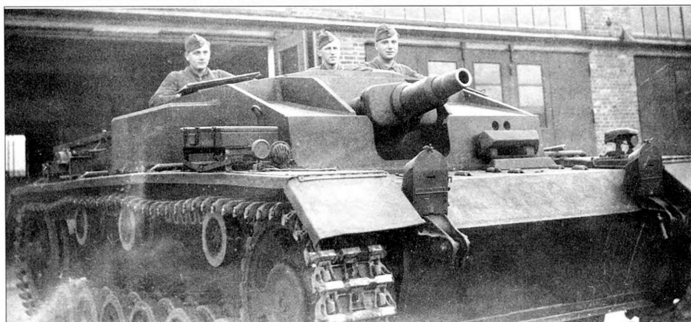
Одно и то же штурмовое орудие, сфотографированное под разными ракурсами, StuG III Ausf. E. Машины модификации У запущены в серийное производство осенью 1941 г., всего изготовлено 284 самоходки. От более ранних моделей StuG III Ausf. E отличали вертикальные боковые стенки рубки.
