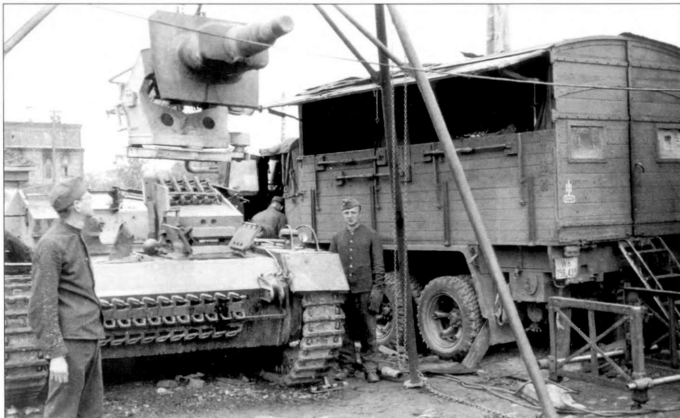
Sturmgeschütz-Abteilung 189: замена орудия на самоходке StuG III Ausf. D с помощью козлового крана. Рядом стоит полевая ремонтная мастерская на базе грузовика Хеншель тип 33, полевая доработка.
