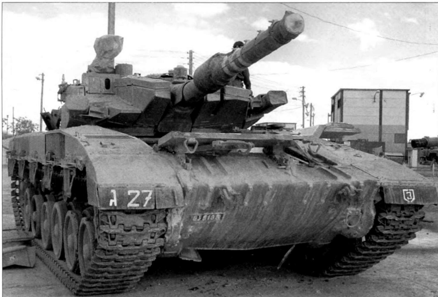
«Меркава-3». Впечатляет толщина броневой крышки люка доступа к двигателю. Над маской пушки установлен датчик системы предупреждения о лазерном облучении «Анкорам».
