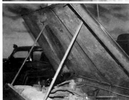
радиатор, часть топливного бака, приводные ремни, нижняя бронеплита моторного отсека.
