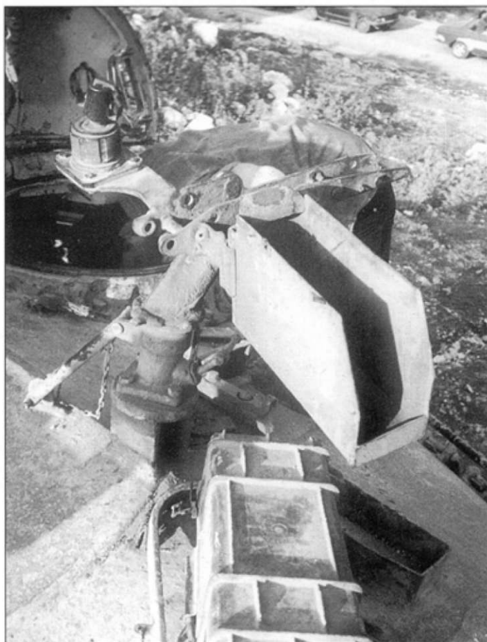
На танке «130312» полностью сохранилась башенная пулеметная турель, стандартная для израильских и южноливанских Т-55.
