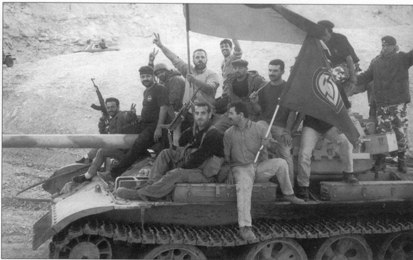
Еще один брошенный в исправном состоянии танк армии Южного Ливана. На танк «130901» забрались представители движения Амаль. Обратите внимание на необычный первый опорный каток, характерный для самых ранних танков Т-54.
