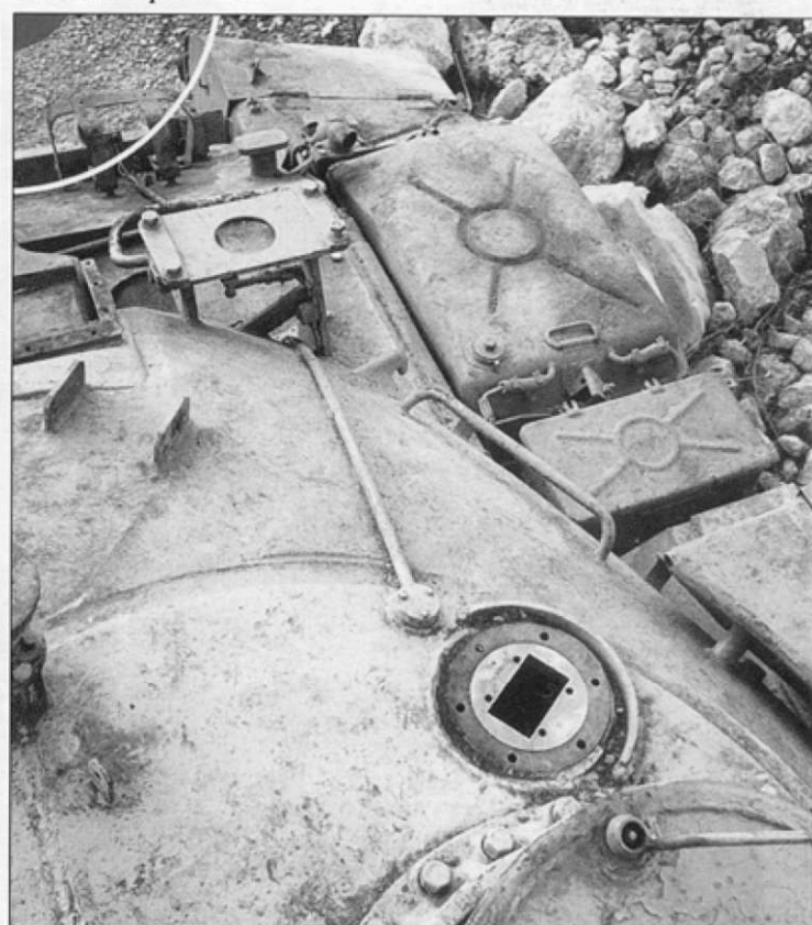
Левая сторона крыши башни с пулеметным шкворнем и прицелом по типу прицела «Шермана». Правая сторона крыши башни. Перископ снят.
