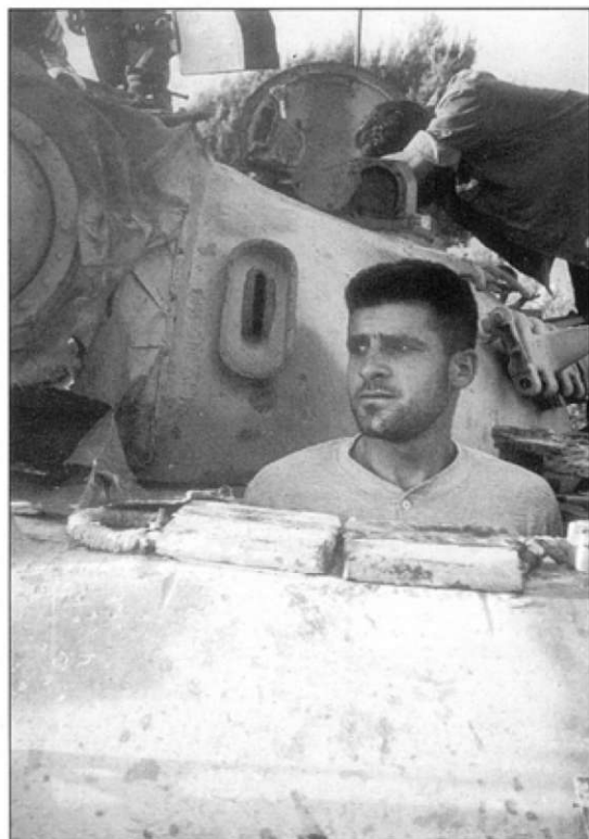
На танке «130312» полностью сохранилась башенная пулеметная турель, стандартная для израильских и южноливанских Т-55.
