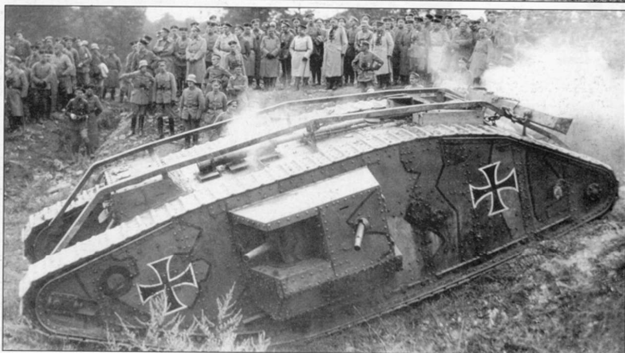
Группа офицеров высшего командования германской армии наблюдают на показательными выступлениями танка Mk IV «самец». Машина вооружена пушками и пулеметами, «самки» имели чисто пулеметное вооружение. Снимок сделан в мае 1918 г. под Шарлеруа. Хорошо виден рисунок камуфляжа.
