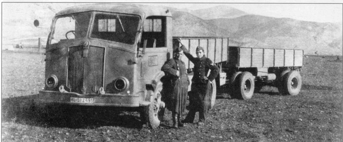
Фиат-666NM (4x2) очень похож на Фиат-626NM, только больше по размерам. Эта машина перевозила груз массой до 6000 кг и буксировала прицеп массой до 12 000 кг. Номерной знак - «WL-582495».
