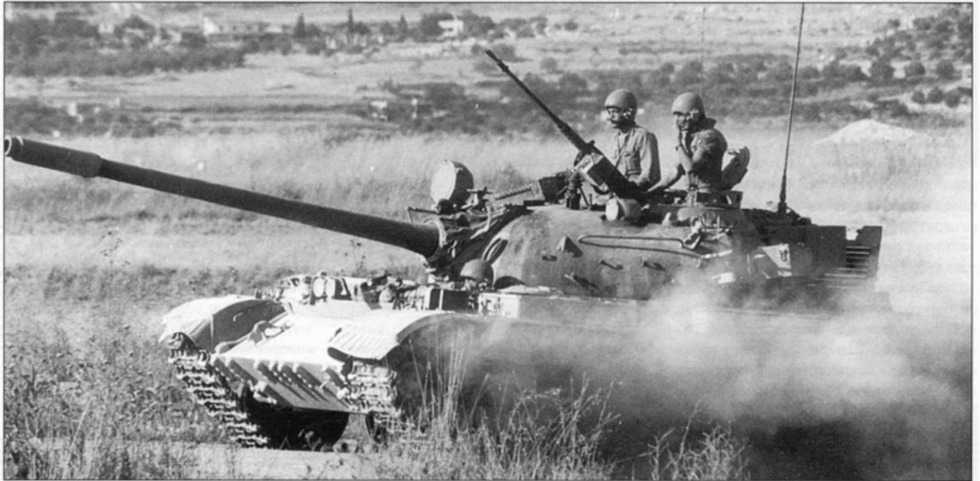
Еще один южноливанский «Тиран» в патруле на опаснейшей дороге Южного Ливана. Танк камуфлирован пятнами коричневого цвета. Это - не краска! Камуфляж нанесен оружейной смазкой, перемешанной с грунтом.
