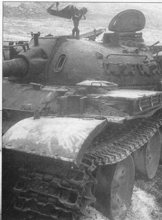
Еще один брошенный в исправном состоянии танк армии Южного Ливана. На танк «130901» забрались представители движения Амаль. Обратите внимание на необычный первый опорный каток, характерный для самых ранних танков Т-54.
