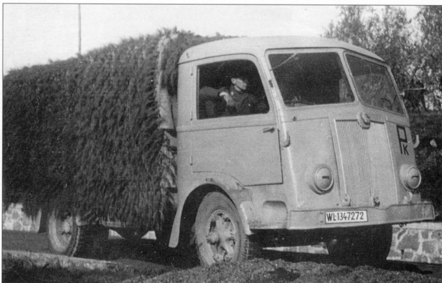
Стандартным итальянским 3-тонным грузовиком являлся Фиат-626NM (4x2). Номерной знак люфтваффе «WL-1347272», численное значение номера необыкновенно высокое для люфтваффе, обычно в номерных знаках машин германских ВВС присутствовало не более шести цифр.
