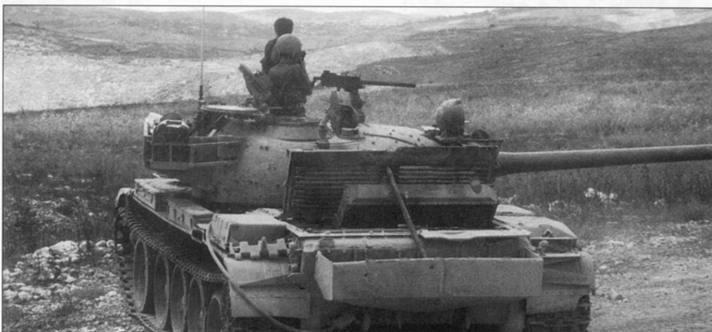
Южноливанский «Тиран» на огневой позиции. Экипаж удовлетворился установкой на башне одного пулемета винтовочного калибра. На наводчике одет шлем израильского образца.
