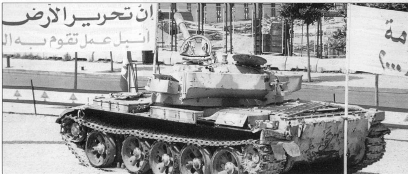
Тот же самый танк, снимок под иным ракурсом. К борту башни также приварен стеллаж для патронных ящиков. На башне наварено не менее пяти узлов крепления пулеметов, три рядом с люком командира, один - над стволом орудия и один - рядом с люком наводчика.
