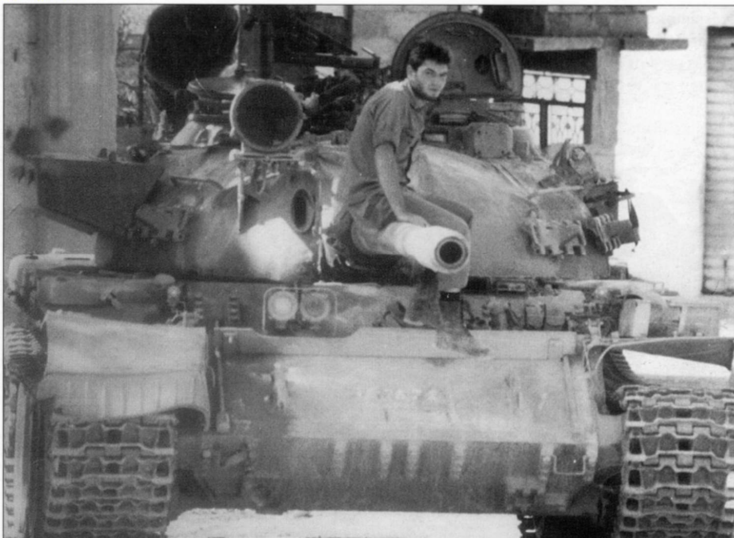
Впечатляющий снимок танка «Тиран» армии Южного Ливана, сделанный с переднего ракурса. Перед люком механика-водителя лежат подсумки от израильской штурмовой винтовки «Галил», хотя обычно танкисты вооружались автоматами АК-47. Магазины к ним укладывались аналогичным образом. На башне танка между люками установлен шкворень под пулемет FN MG.
