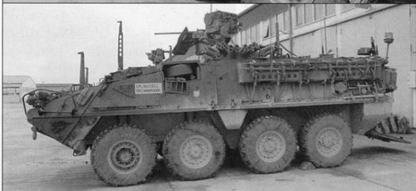
В отличие от бронетранспортера M1126, разведывательная машина M1127 вооружена пулеметом или гранатометом, устанавливаемыми на обычной турели. Система M151 отсутствует. Рядом с турелью на командирской башенки смонтированы датчики системы LRAS3. На снимках представлена разведывательная бронемашина M1127 «Страйкер RV» из 2-го эскадрона 2-го страйкер-кавалерийского полка, учения «Коугар», Графенвохер, Германия.
