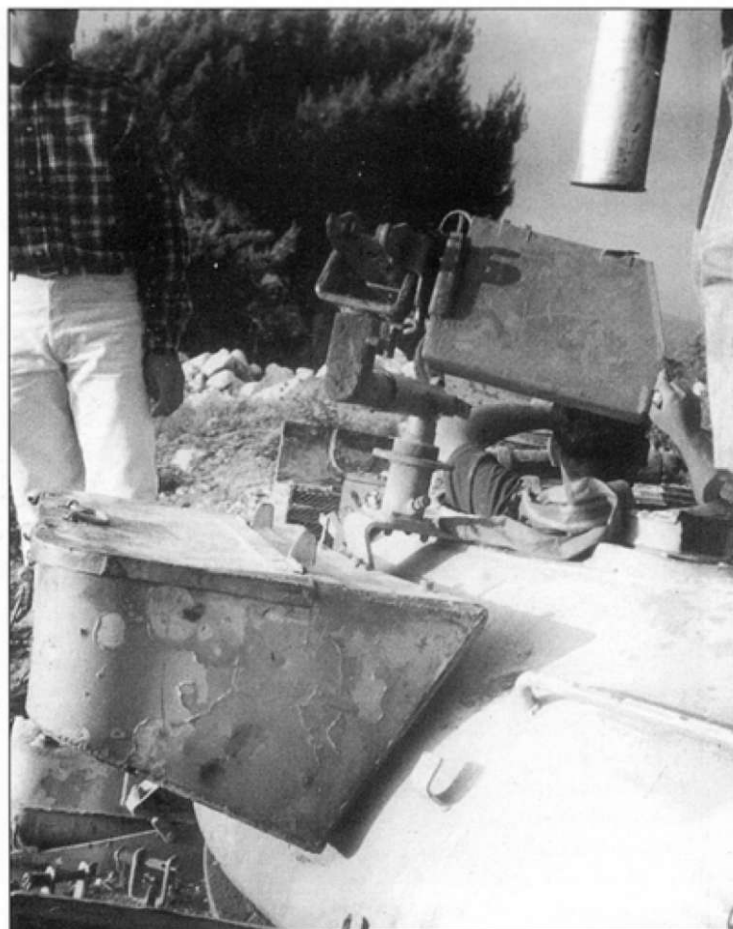
Крупный план шкворня командирского пулемета и платформы под спаренный с пушкой прожектор.
