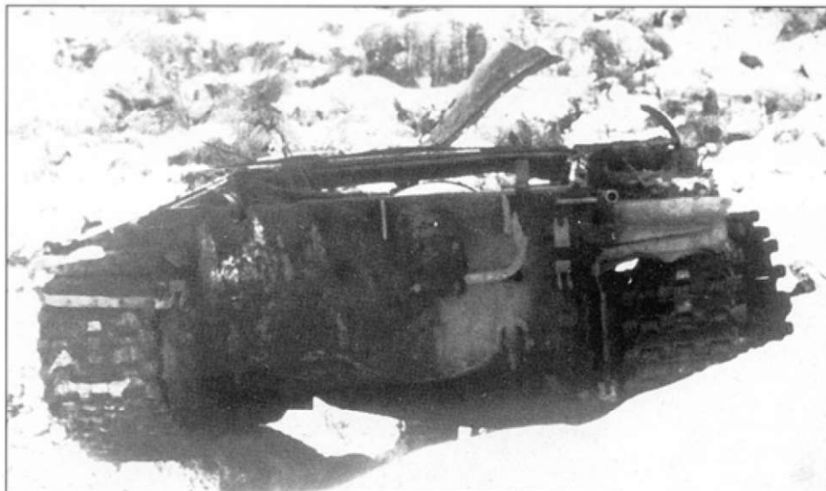
Очередной подбитый арабский танк в ожидании эвакуации израильтянами. Сирийский Т-62 подбит под Джеззиной. Башня танка отлетела при взрыве на 20 м от корпуса танка и перевернулась. Скорее всего, в танке детонировал боекомплект. Краска на башне обгорела полностью.
