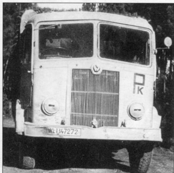
Масса полезного груза автомобиля Фиат-626NM составляла 3 т, масса прицепа - 6,5 т. На кабине напечата символика не установленного подразделения люфтваффе.
