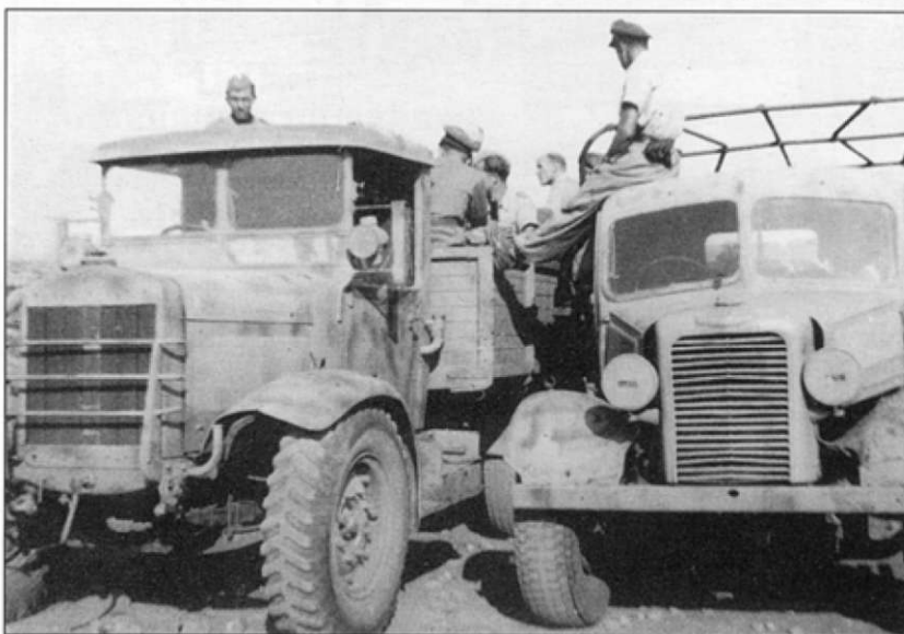
Снимок времен кампании в Северной Африке. Грузовик SPA-38R (4x2) используется немцами, но не имеет символики германской армии. Предположительно, машины немцы отбили у англичан - рисунок протектора на шинах типично британский. Справа - «Beute-LKW», трофейный британский грузовик Commer Q4.
