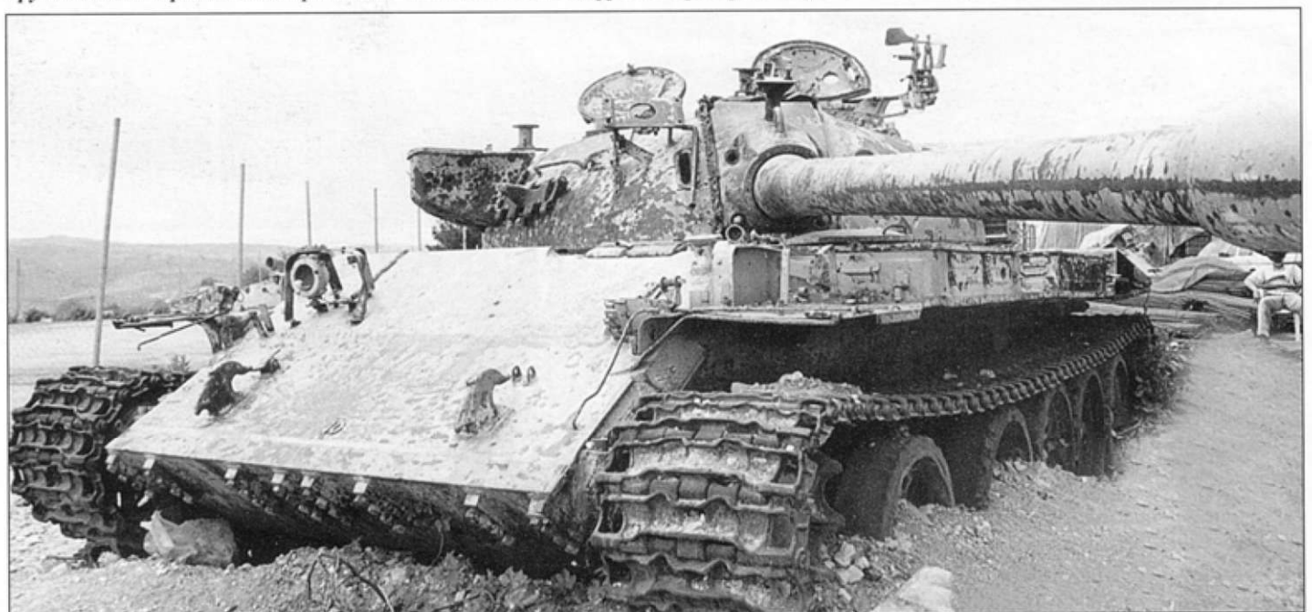
Этот «Тиран» был брошен, будучи в ужасном внешнем состоянии. Скорее всего, машина вышла из строя задолго до развала армии Южного Ливана. Танк получил минимум три прямых попадания минометных мин и ни одна из них не пробила броню, а на лобовой броне корпуса от разрыва мины не осталось даже вмятины!
