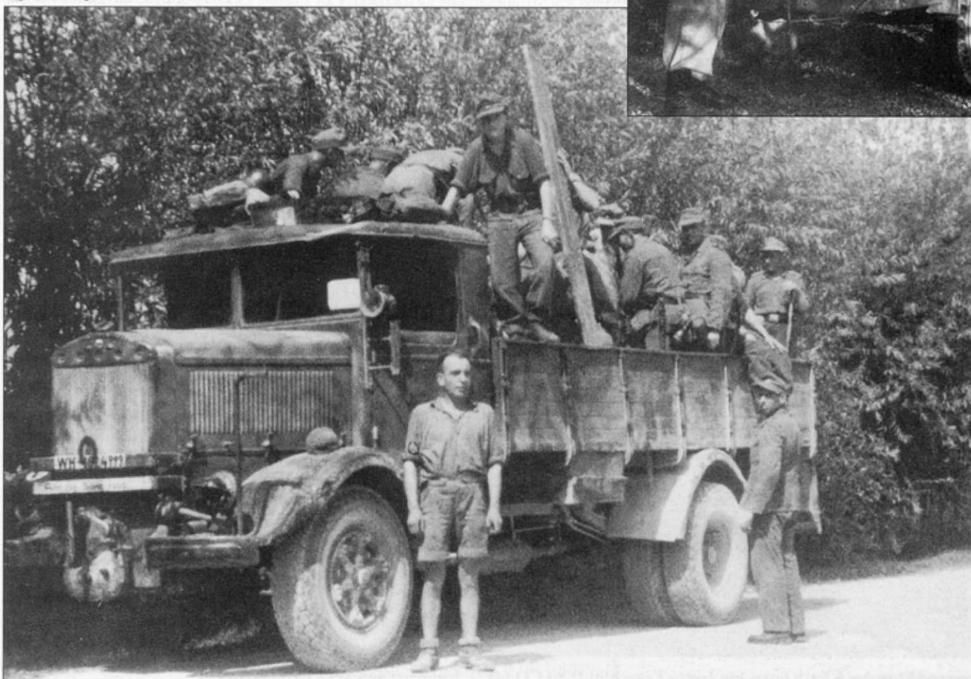
Тяжелый грузовик Лянчия 3RO (4x2), масса полезной нагрузки 6400 кг, масса прицепа - 15 т. Номерной знак - армейский, «WH-1824999». Тяжелые грузовики данного типа были стандартными в итальянской армии. Ниже радиатора выполнена надпись «Acftung gang raus».
