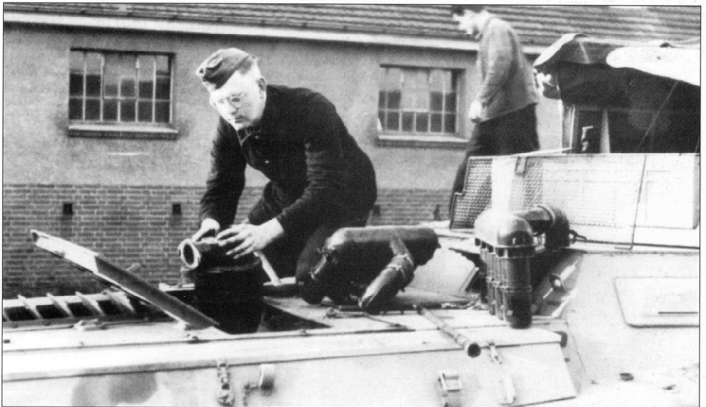
На всех бронев автомобилях Sd.Kfz. 234 стояли дизельные двигатели фирмы Татра. Техник занимается сменой воздушного фильтра.
