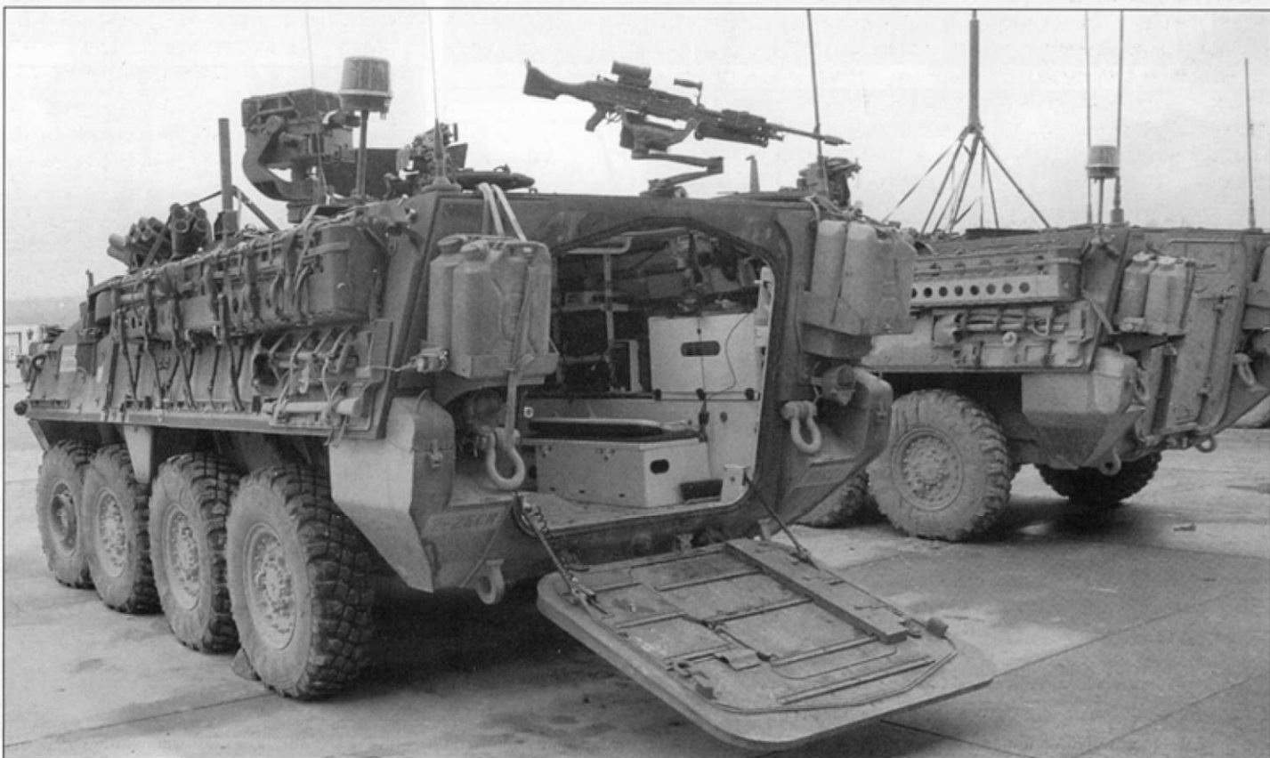
В отличие от бронетранспортера M1126, разведывательная машина M1127 вооружена пулеметом или гранатометом, устанавливаемыми на обычной турели. Система M151 отсутствует. Рядом с турелью на командирской башенки смонтированы датчики системы LRAS3. На снимках представлена разведывательная бронемашина M1127 «Страйкер RV» из 2-го эскадрона 2-го страйкер-кавалерийского полка, учения «Коугар», Графенвохер, Германия.
