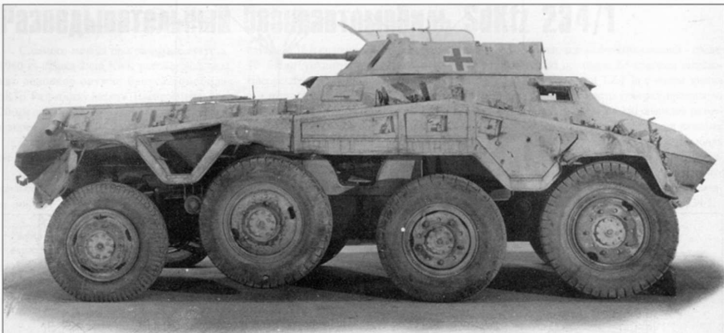
SdKfz 234/1 позднего типа с четырьмя багажниками по бортам корпуса.
