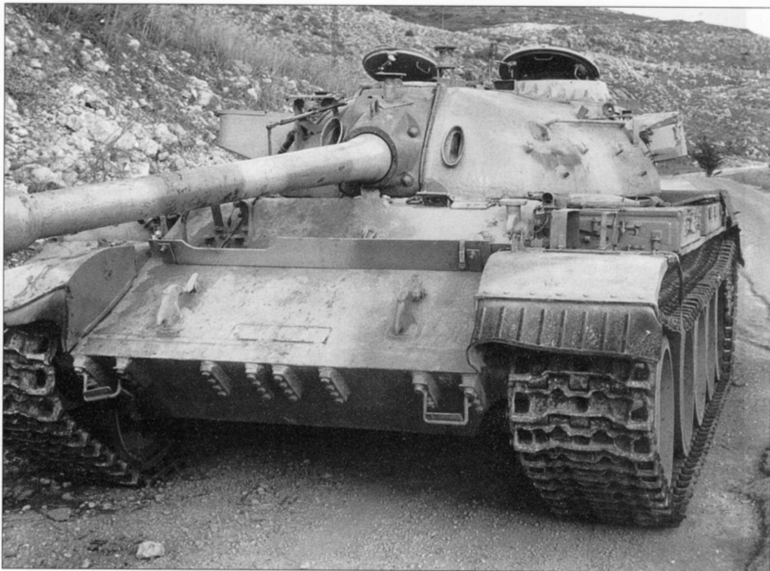
Брошенный южноливанский танк на шоссе Айша - Джермук. На броне болтами закреплена подножка для облегчения доступа в танк механику-водителю. Подножка установлена на узле крепления минного трала КМТ.
