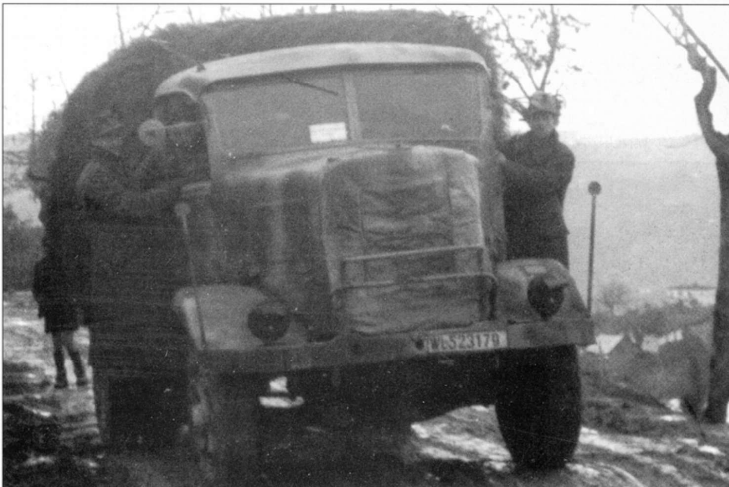
Тяжелый 6,5-тонный грузовик Изотта-Фрасчини D-80CO (4x2) с номерным знаком «WL-523179».
