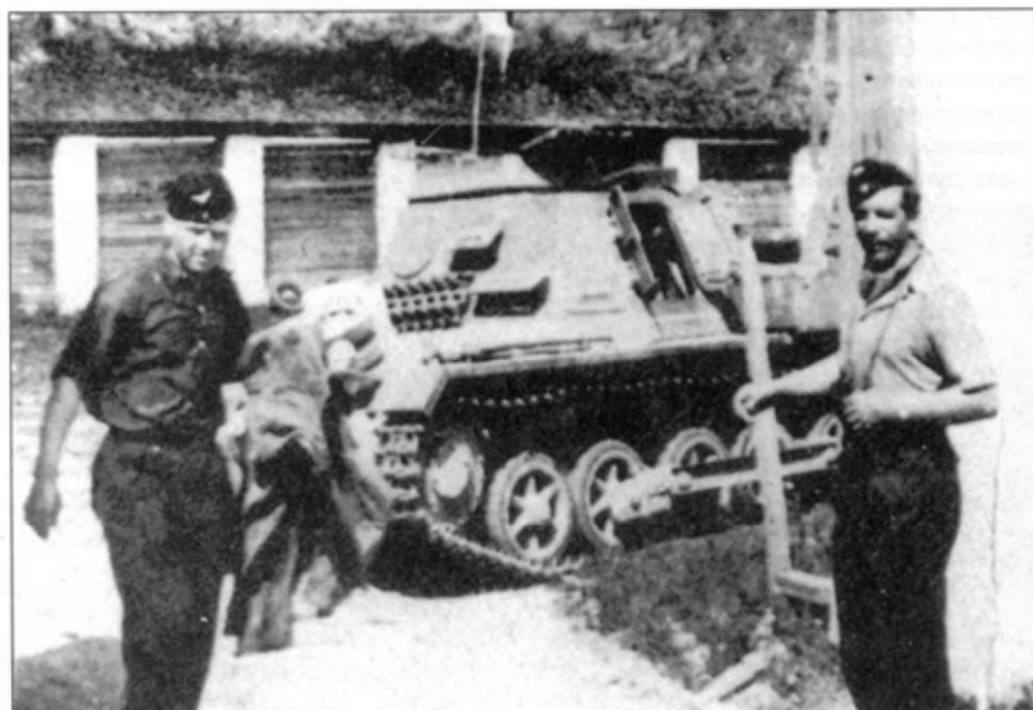
Тот же самый Pz I Bef, что и на фото № 9, но снимок сделан позже. Все обозначения на корпусе закрашены. Только на антенне закреплен белый флаг с красным крестом. Обратите внимание, что передние части крыльев - прямые.
