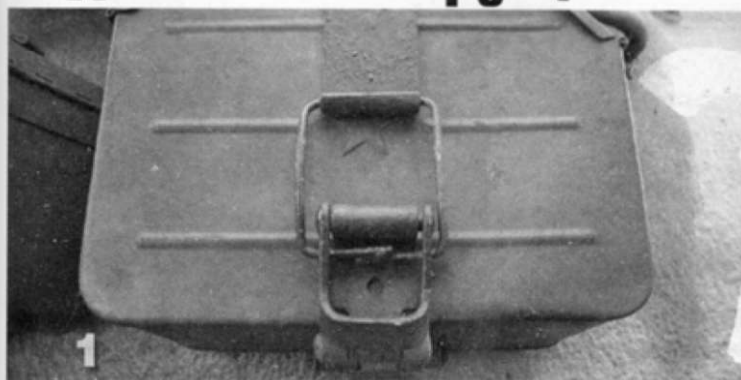
1. Закрепленные на внешней стенке башни патронные ящики для зенитного пулемета - характерное внешнее отличие танки Т-55.
