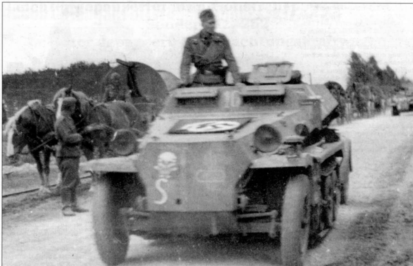
Sd.Kfz. 252 не установленной батареи штурмовой артиллерии. Передние кромки крыльев окрашены в белый цвет для лучшей видимости во время ночных маршей.
