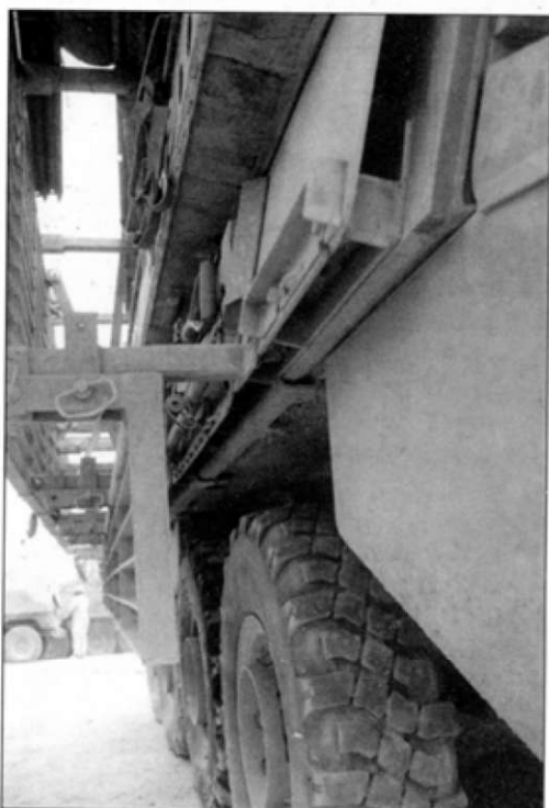
На фотографиях крупно показаны узлы крепления решетчатой брони к корпусу бронетранспортера М1126 «Страйкер». «Бампер-код» указывает на принадлежность машины 5-му батальону 20-го пехотного полка 2-й пехотной дивизии. В лобовой части небольшой участок решетчатой брони выполнен откидным для пропуска троса лебедки.
