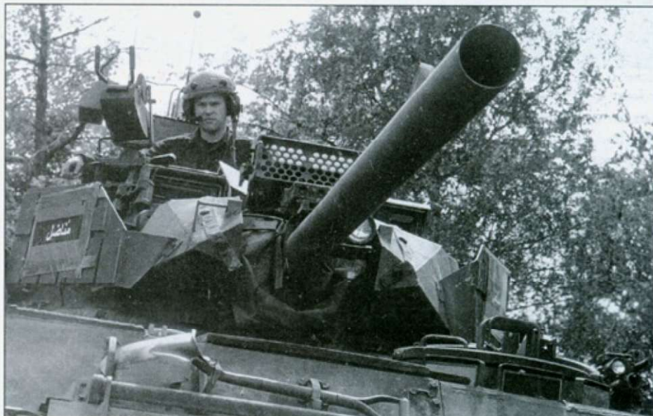
OSTS-MBT из «AltunianArmy» имитатором каткового минного трала КМТ-7. Классный имитатор - старые покрышки!!!
