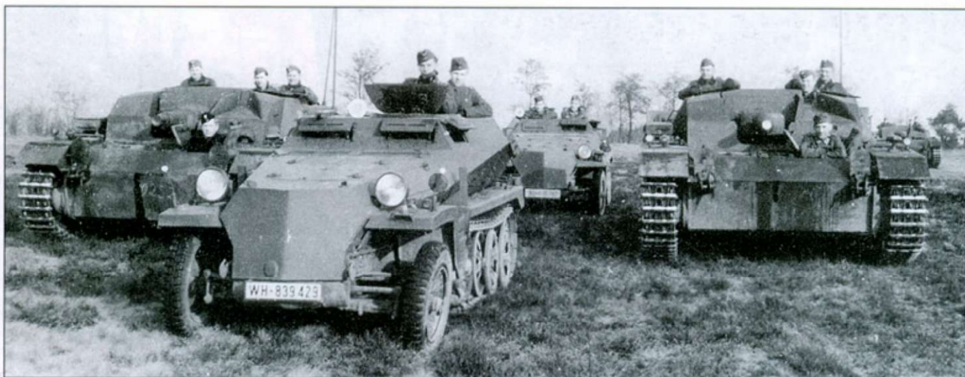
Парад в полевых условиях. На переднем плане - машина артиллерийского наблюдателя Sd.Kfz. 253, на заднем плане - пара истребителей StuG III Ausf. B и транспортер боеприпасов Sd.Kfz. 252.
