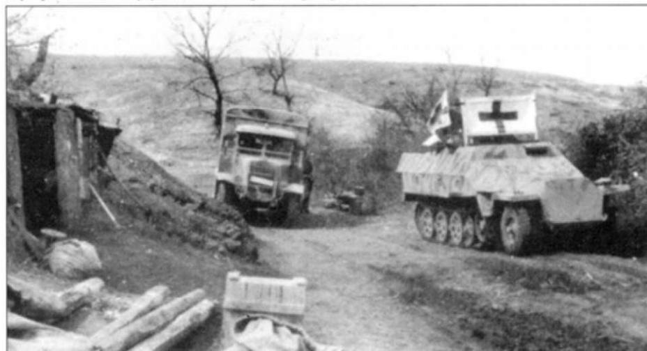
SdKfz 251/8 танковой дивизии «Герман Геринг». Наверху бронекорпуса закреплена легкосъемная растяжка с красным крестом. Однако в условиях плохой видимости красный крест можно было легко спутать с черным. Это было одной из причин исчезновения эмблем красного креста с бортов машин. Преимуществами растяжки было то, что ее можно было легко снять.
