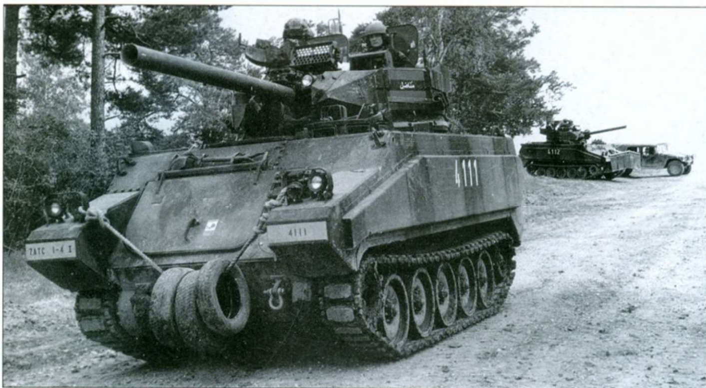
OSTS-MBT из «AltunianArmy» имитатором каткового минного трала КМТ-7. Классный имитатор - старые покрышки!!!
