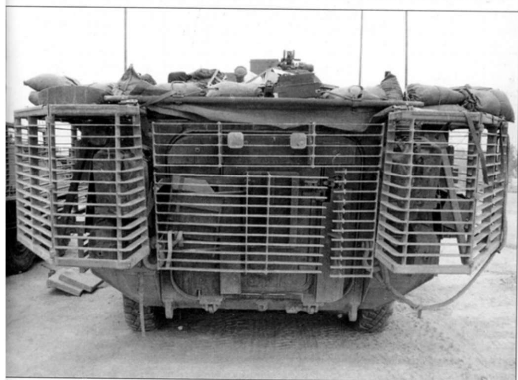
На фотографиях крупно показаны узлы крепления решетчатой брони к корпусу бронетранспортера М1126 «Страйкер». «Бампер-код» указывает на принадлежность машины 5-му батальону 20-го пехотного полка 2-й пехотной дивизии. В лобовой части небольшой участок решетчатой брони выполнен откидным для пропуска троса лебедки.
