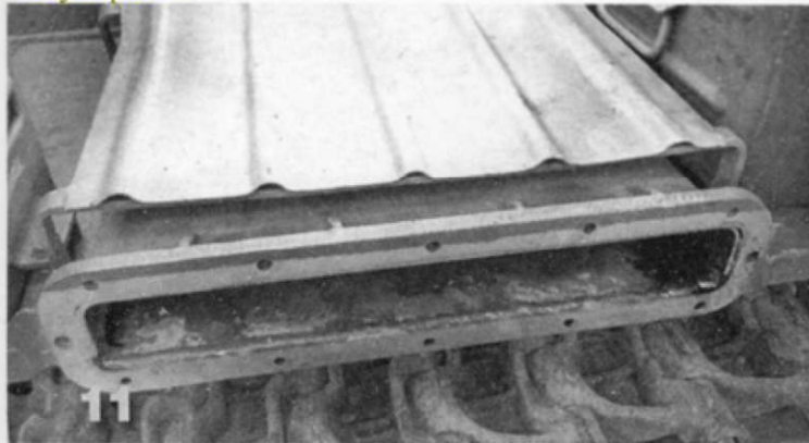
11. Фланец выхлопного патрубка, к которому при необходимости выхлопная труба для подводного вождения. Обратите внимание на четыре ребра жесткости на верхней поверхности выхлопного патрубка. 12. Надгусеничный топливный бак, вид сверху. Угол бака выполнен скошенным из-за расширения корпуса танка в месте установки башни. Все надгусеничные баки имеют одинаковые выштамповки, увеличивающие прочность.
