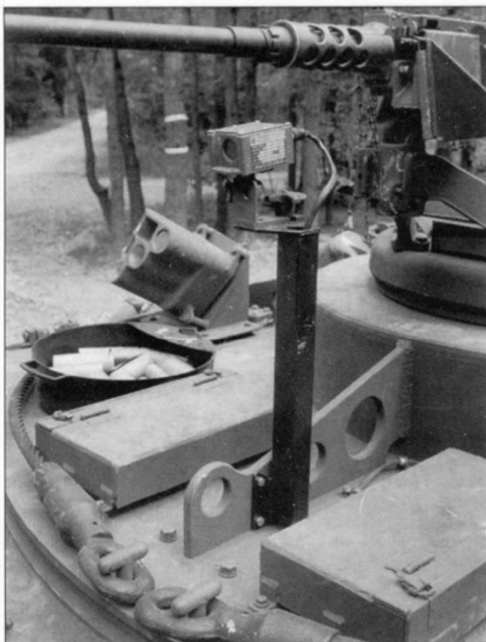
Видеокамера установлена на простейшей мачте, изображение этой видеокамеры передается на монитор, установленный в машине управления. Камера и кабель весьма уязвимы.
