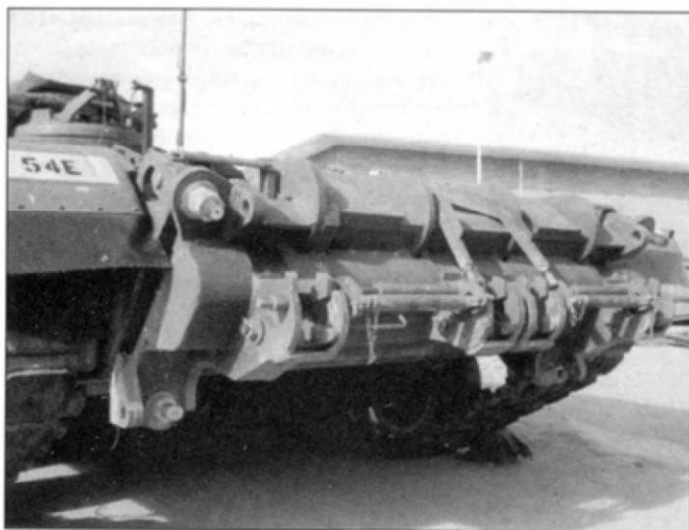
Носовая часть корпуса машины разминирования «Пантера II». Минный трал не установлен. На всех точках контакта трала с корпусом краска содрана и видны следы коррозии.
