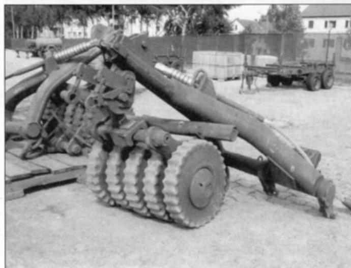
Общий план каткового минного траля. Втулка проржавела.
