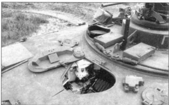
Передняя часть корпуса, люк механика-водителя открыт. Конструктивно люк полностью аналогичен люку танка «Абрамс». И опять - поверхности чистые.
