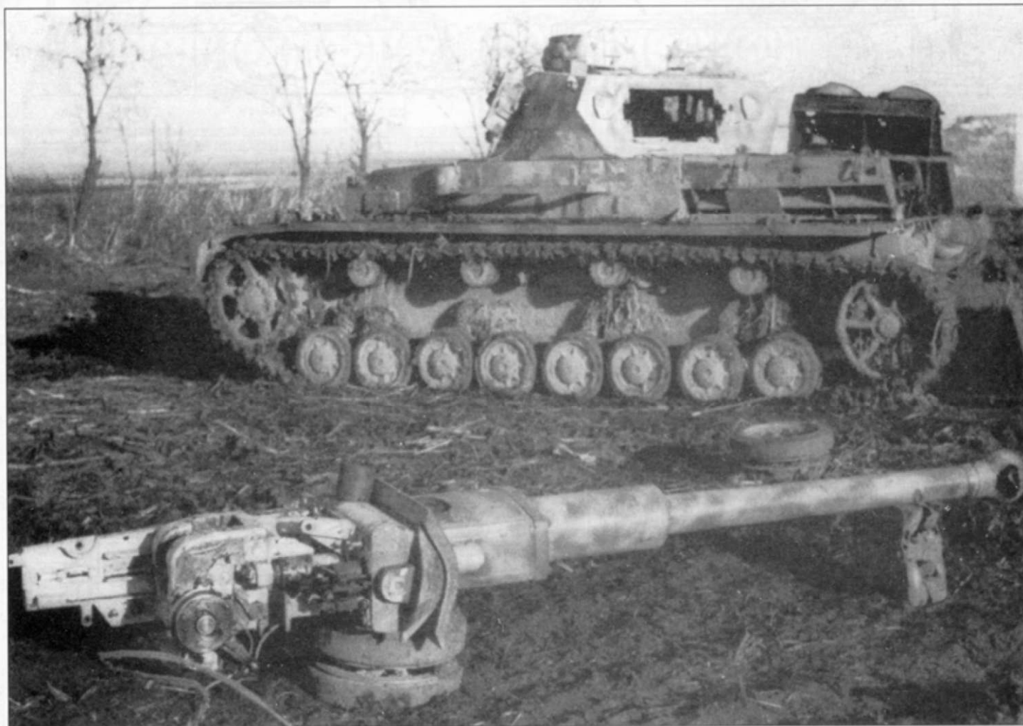
PzKpfw IV Ausf. F2 из 13-й танковой дивизии, Кавказ, лето 1942 г. Победимому танк проходит ремонт - демонтированы орудие и двигатель.
