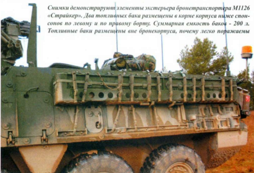
пулями и осколками. Ниже багажника левого борта смонтирована плата с креплениями для инструмента - топор, кувалда, кирка, лопата.
