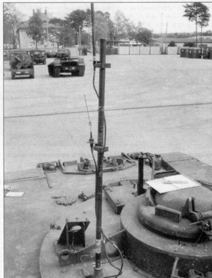
Антенны аппаратуры дистанционного управления, на одной мачте закреплены две антенны, кабели антенн обвиты вокруг мачты. Мачта выполнена складной.
