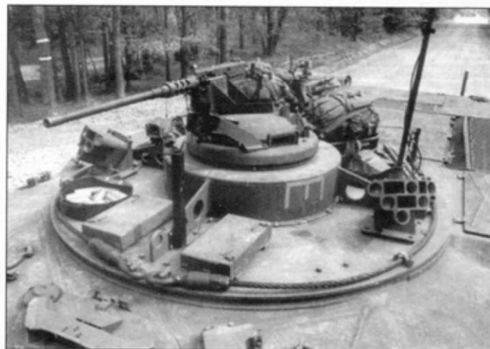
Командирская башенка с двумя блоками дымовых гранатометов и 12,7-мм пулеметом. Здесь установлена мачта с видеокамерой.
