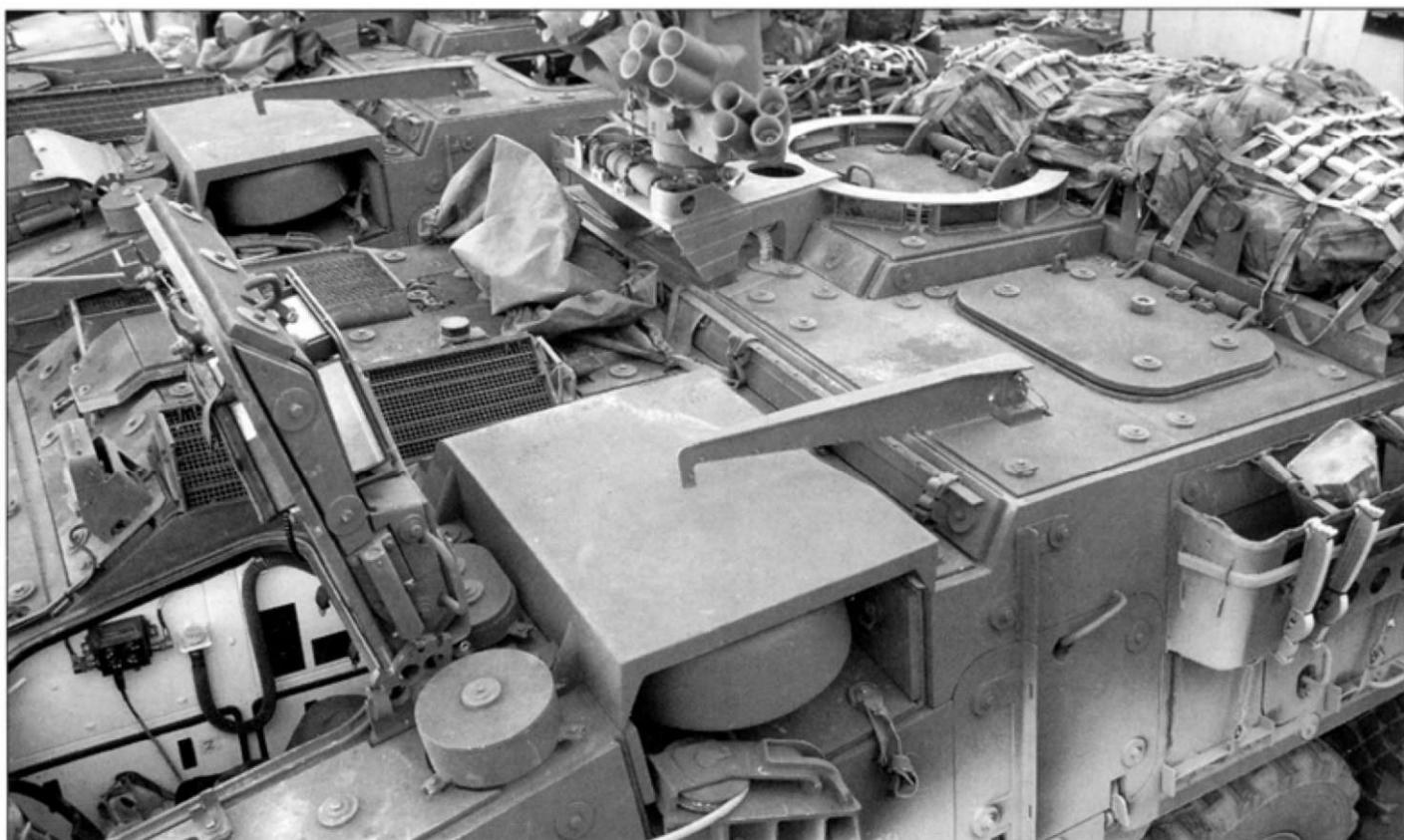
Внешний облик бронетранспортера M1126 «Страйкер» имеет немало характерных отличий, например - гидравлическая лебедка TR-080, установленная за люком водителя. Люк командира десанта пехоты расположен левее люка командира машины. Обратите внимание на ремни, предназначенные для крепления на крыше корпуса разнообразного имущества.
