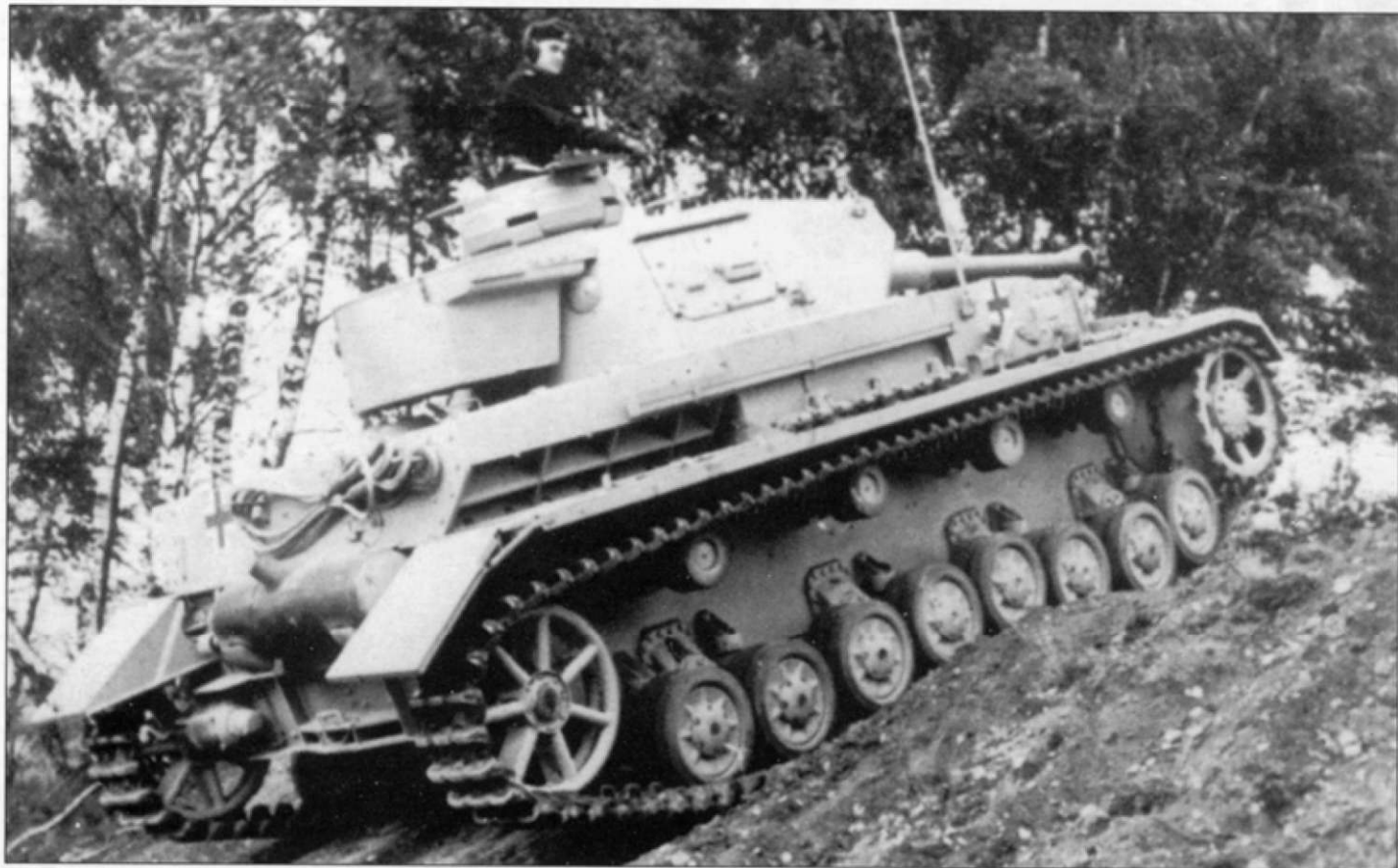
Новые танки прибыли на Восточный Фронт, 1942 г. По-видимому машины покрашены в желтый цвет. Позже экипажи нанесут на него зеленые полосы. Танк на снимке сверху оснащен дополнительным лобовым бронелистом. В середине 1942 года танки PzKpfw IV Ausf. F2 были самыми мощными в Вермахте. Почти через год после начала войны с Советским Союзом немецкие танкисты получили машины, способные бороться с Т-34 и КВ. К концу года появится и знаменитый «Тигр».
