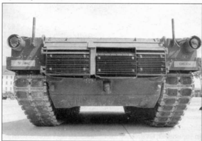
Корма машины разминирования «Пантера II». Центральная секция решетки сильно проржавела, именно через нее выходят наружу выхлопные газы турбины. Корпус сравнительно чистый.
