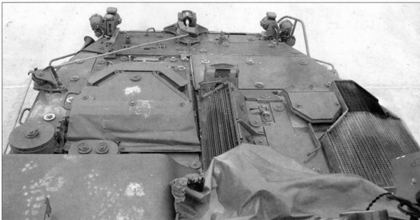
Забранный сеткой воздухозаборник прямоугольной формы расположен правее люка водителя. Обратите внимание на небольшой инспекционный лючок, который находится рядом с большим забранным сеткой отверстием для выхлопных газов двигателя. Выхлопные газы двигателя для снижения ИК сигнатуры машины охлаждаются.
