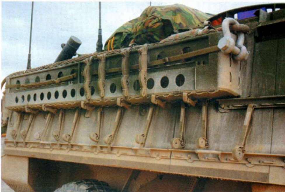
Снимки демонстрируют элементы экстерьера бронетранспортера M1126 «Страйкер». Два топливных бака размещены в корме корпуса ниже спонсонов по левому и по правому борту. Суммарная емкость баков - 200 л. Топливные баки размещены вне бронекорпуса, почему легко поражаемы
