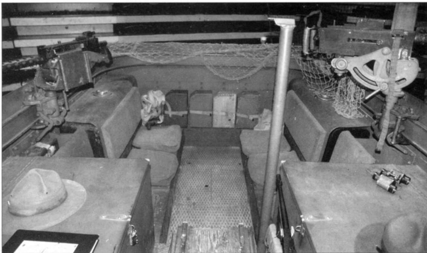
В боевом отделении машины M2/M2A1 размещалось шесть человек. По углам задней части кузова размещены топливные баки, на машинах более поздних модификаций их перенесли ближе к отделению управления.
