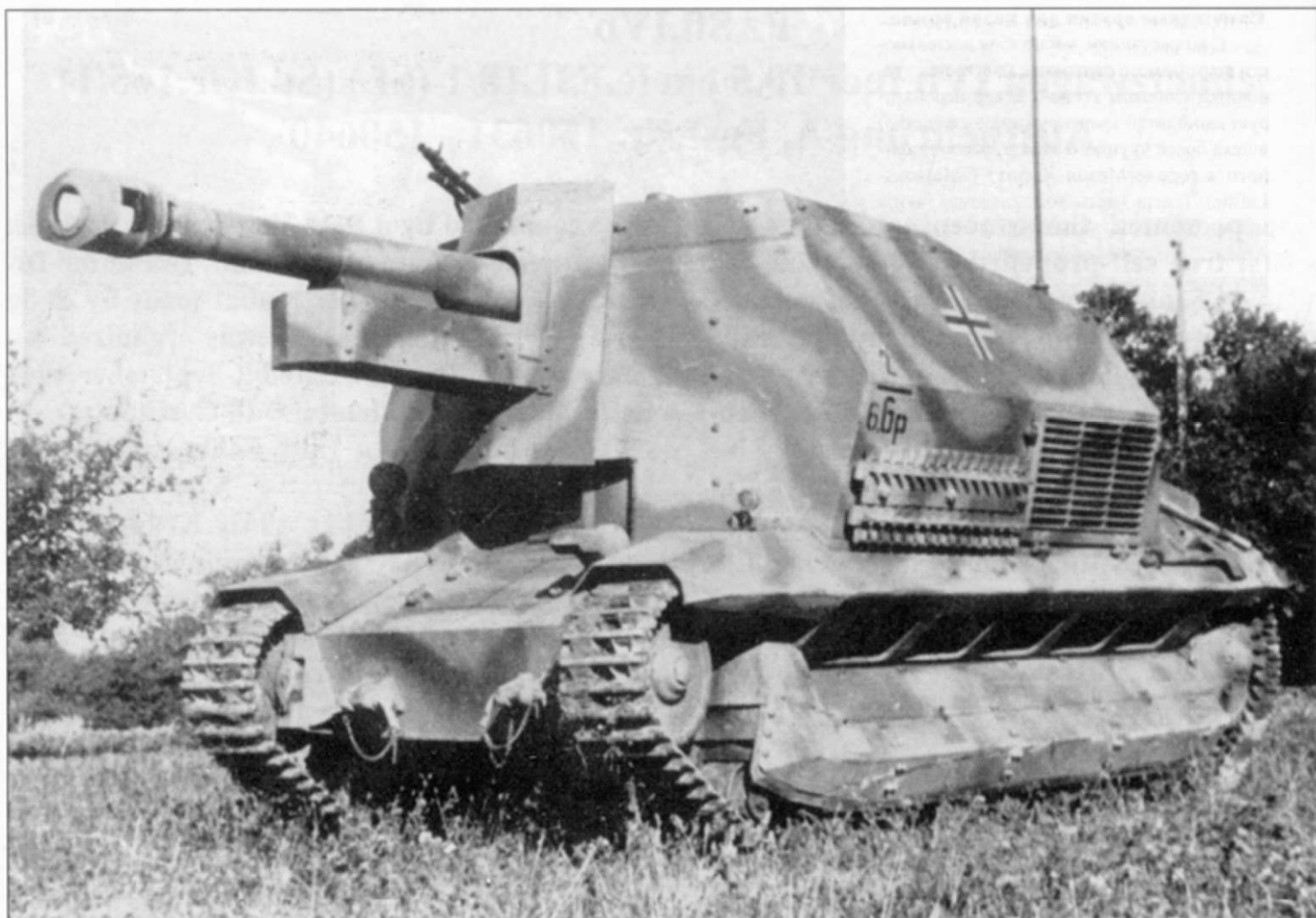
105-мм гаубица на базе танка FCM. Всего было построено 8 таких машин.
