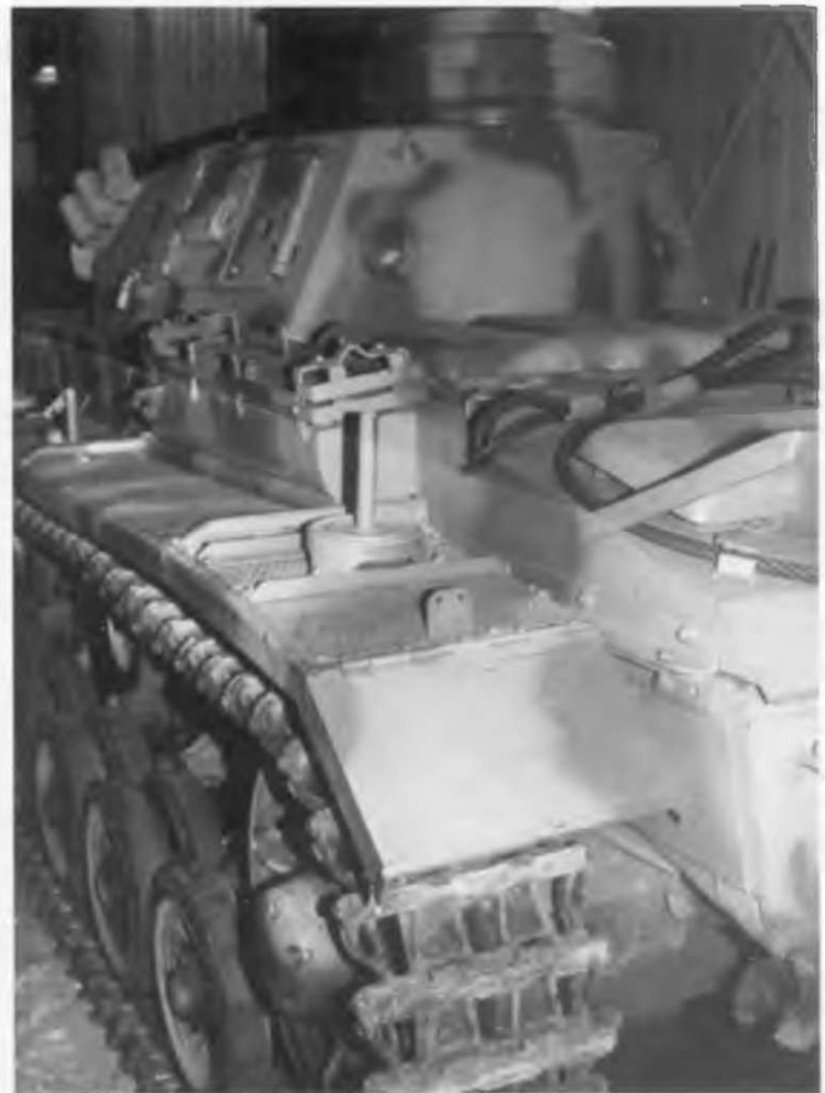
Задняя часть левого крыла в поднятом и опущенном положении. Эта деталь реконструирована.
