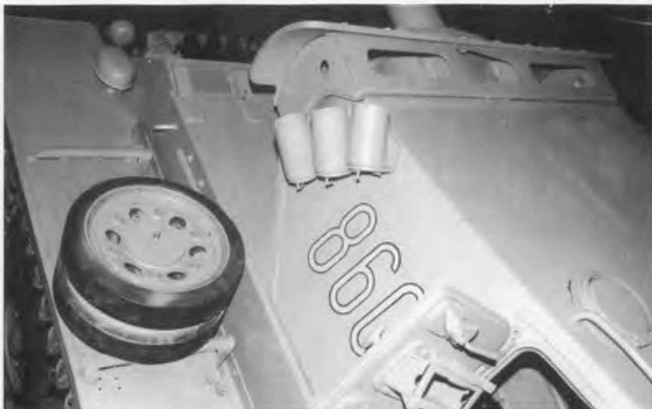
Интересный вид на PzKpfw III Ausf. M. Обратите внимание на крепление дополнительного бронирования на маске пушки.
