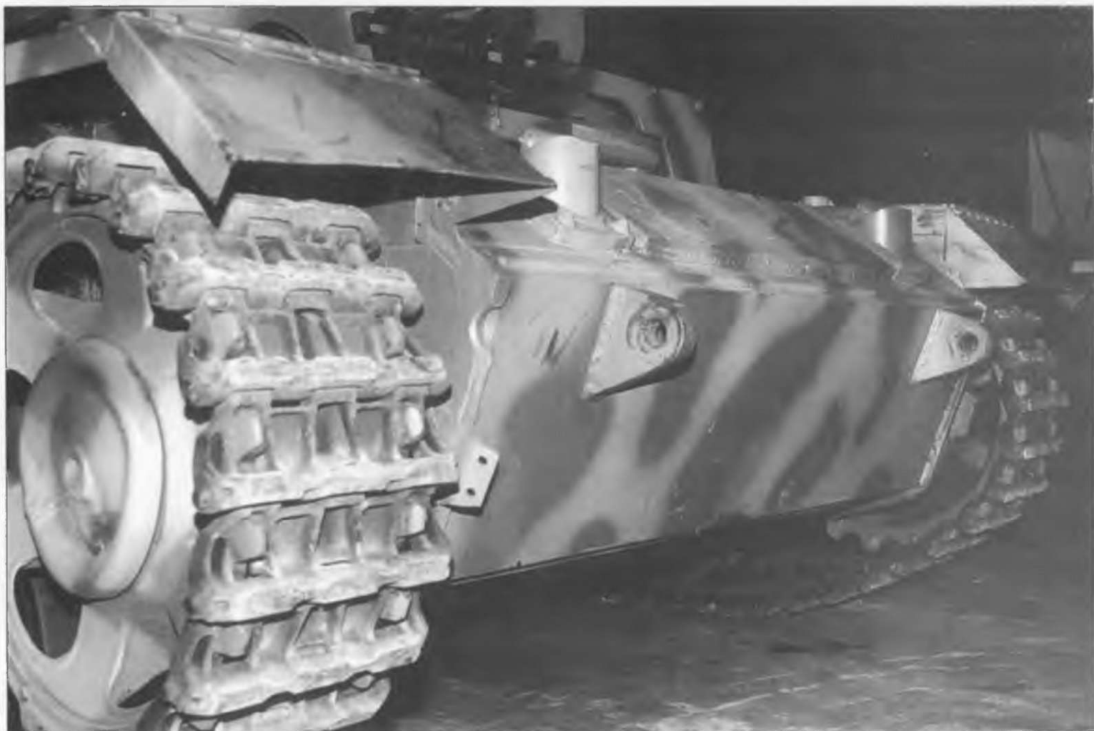
Огнеметный танк Flammpanzer III, вид спереди и справа. Танк имеет нетипичные буксировочные серьги, наваренные на лобовую броню. Оригинальные серьги, составлявшие единое целое с бортовой бронеплитой, срезаны.
