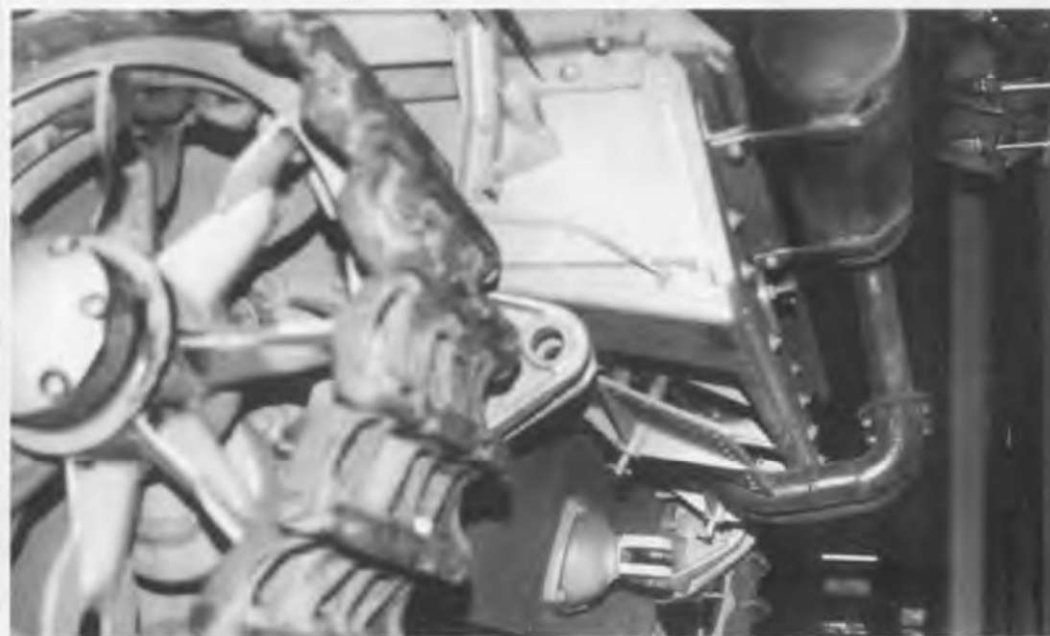
Корма танка PzKpfw III Ausf. M. Виден люк системы охлаждения танка и глушитель.
