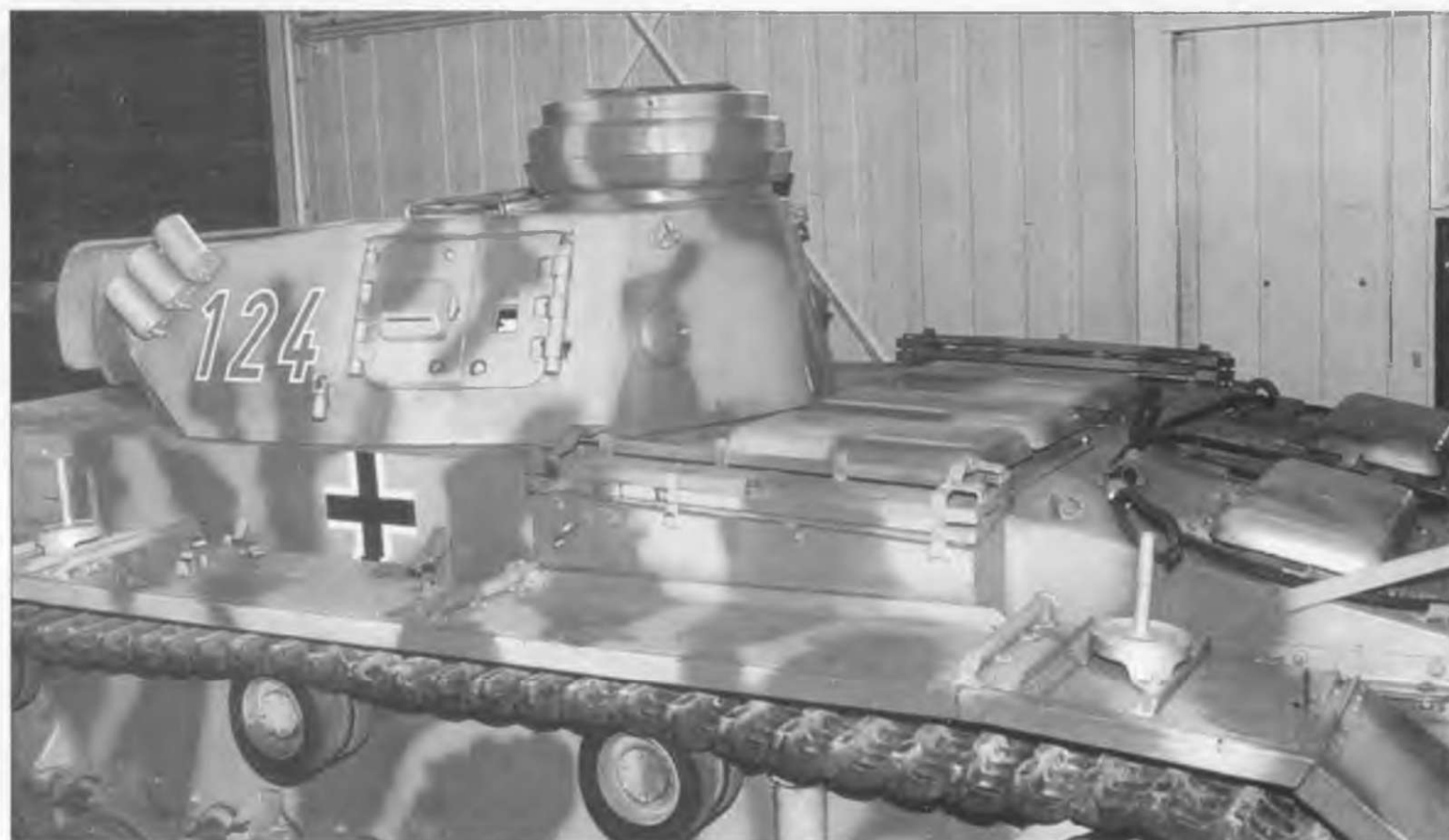
Подвеску для танка PzKpfw III разработал Фердинанд Порше. Позднее торсионная подвеска использовалась на многих танках разных армий мира.
