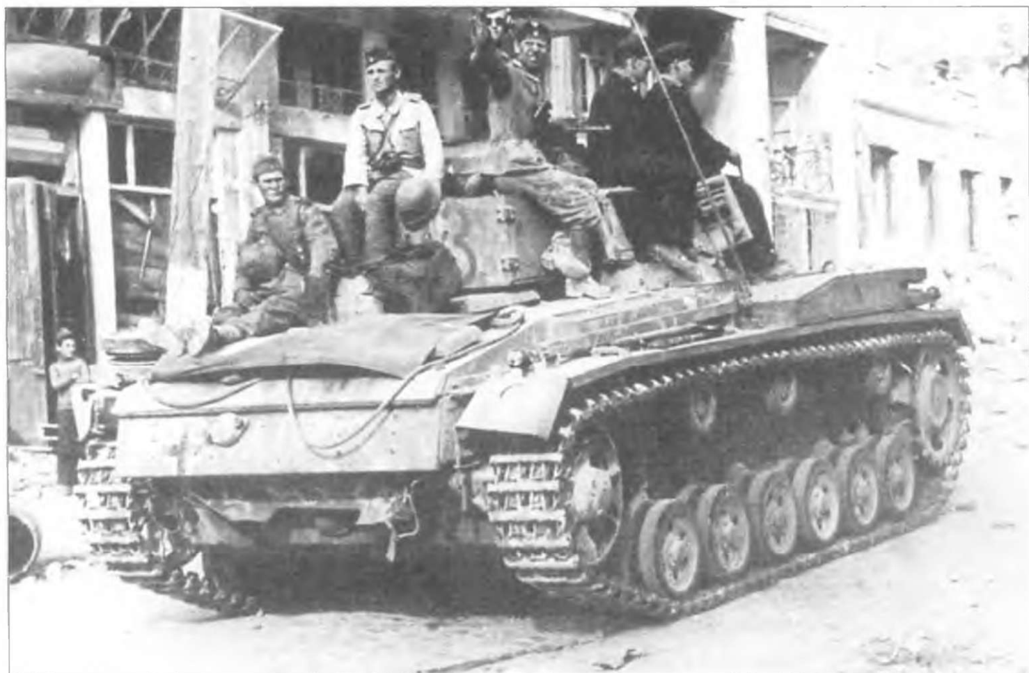
РзКрфв III Ausf. L «123», 300-й танковый батальон, лето 1942 г., бои за Севастополь. На правой надгусеничной полке и в корме башни смонтированы ящики для имущества нестандартного типа.
