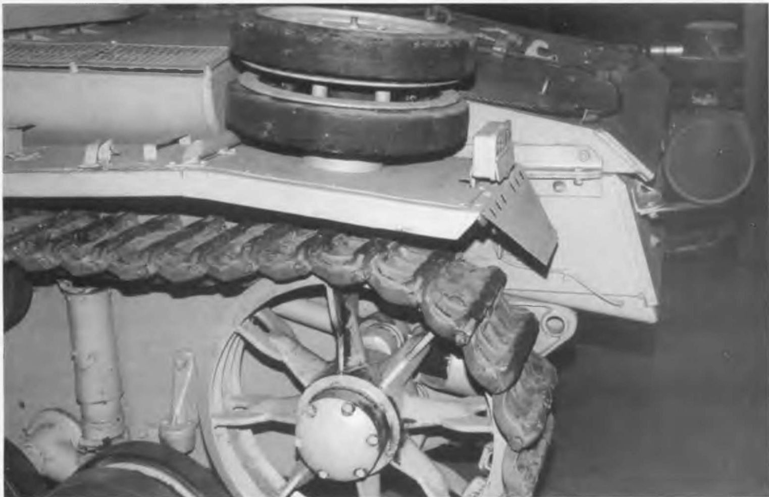
РzKpfw III Ausf. M. Заднее направляющее колесо. Выхлопная система, характерная для танков данной модификации. Крепление для запасного опорного катка реконструировано.
