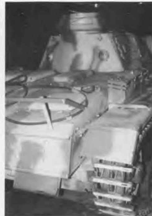
Огнемётный танк Flammpanzer III вид сзади и справа. Обратите внимание на конструкцию воздухозаборников, позволяющих танку без подготовки форсировать броды глубиной до 1,3 м. Башня PzKpfw III Ausf. M, вид слева. Запасной опорный каток установлен на реконструированном креплении.
