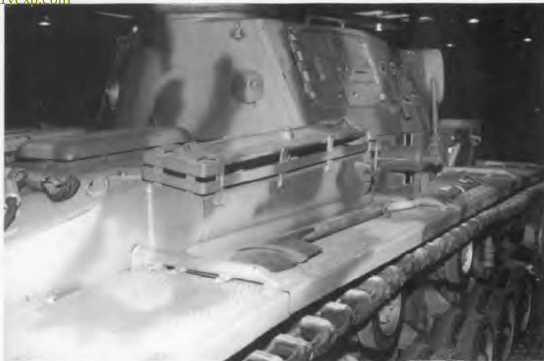
Огнемётный танк Flammpanzer III вид сзади и справа. Обратите внимание на конструкцию воздухозаборников, позволяющих танку без подготовки форсировать броды глубиной до 1,3 м. Башня PzKpfw III Ausf. M, вид слева. Запасной опорный каток установлен на реконструированном креплении.
