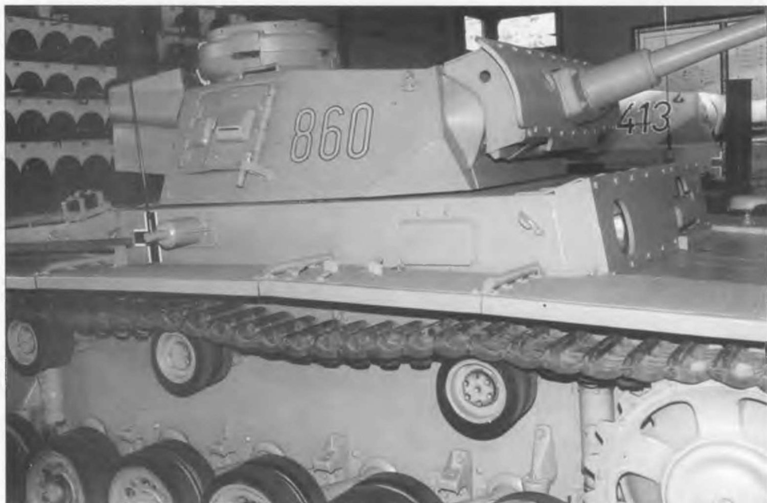
РзКрfw III Ausf. M в музее в Мюнстере. Танк вооружен длинноствольной 50-мм пушкой KwK 39 L/60.
