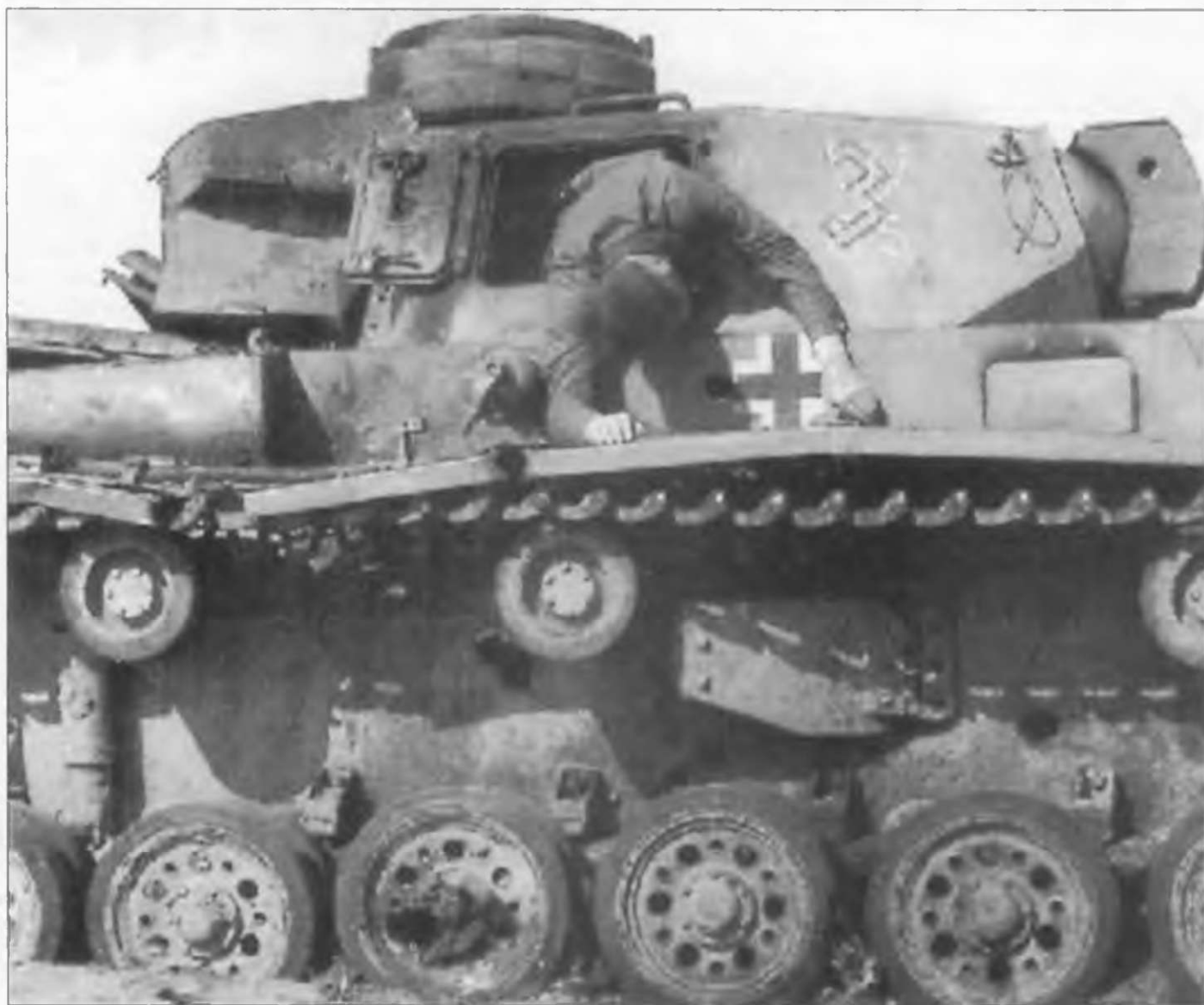
PzKpfw III Ausf. L 7-й танковый полк, 10-й танковой дивизии, подбит в Тунисе, начало 1943 г. Хорошо видны пробоины в борту корпуса.
