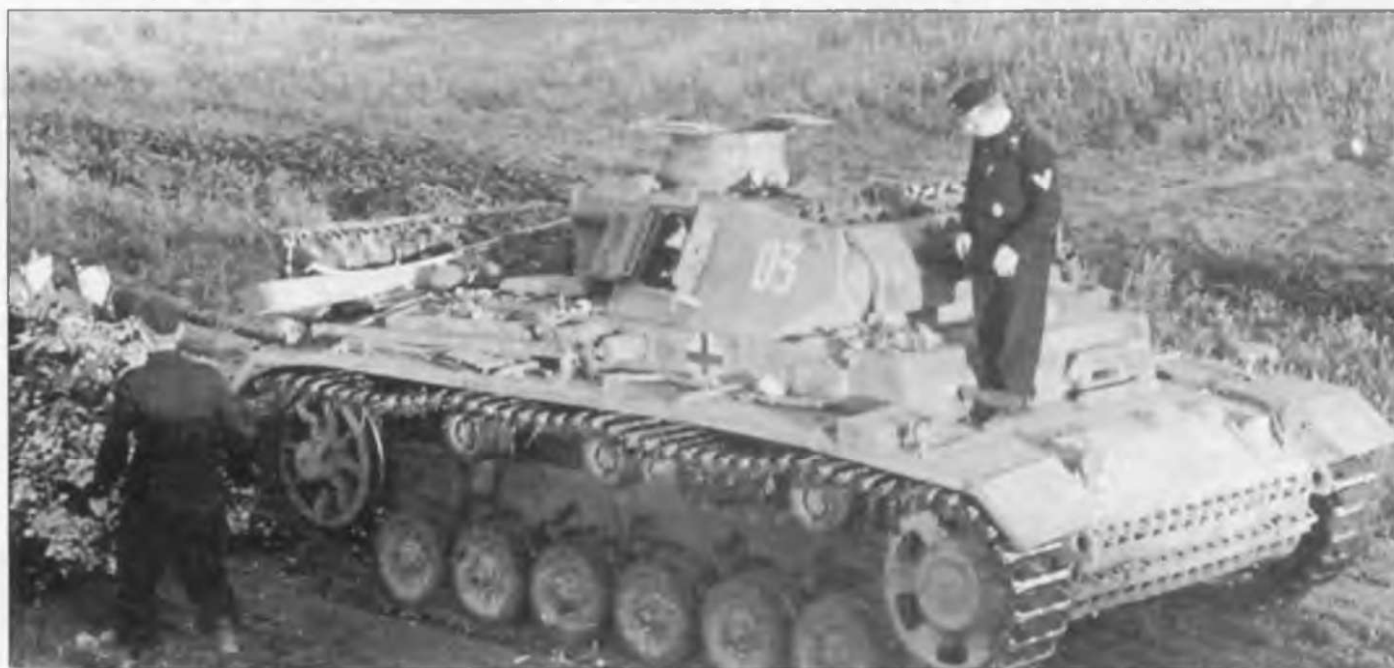
PzKpfw III Ausf. J, вооруженный длинноствольной 50-мм пушкой L/60, 16-я гренадерская дивизия, лето 1942 г.
