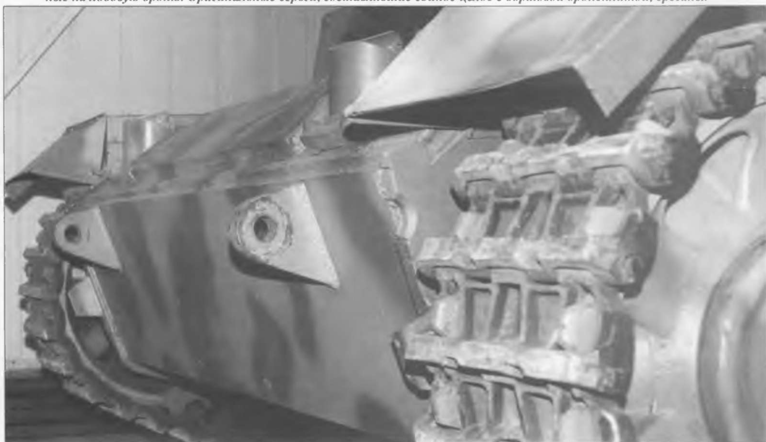
Тот же танк, вид спереди и слева. Видны характерные крепления для поперечной планки, удерживающей на лобовой броне запасные гусеничные траки.
