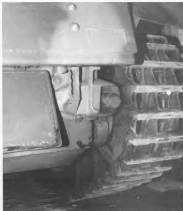
Корма танка. Видна система регулировка правого ленивца, и также открытый люк системы охлаждения двигателя.
