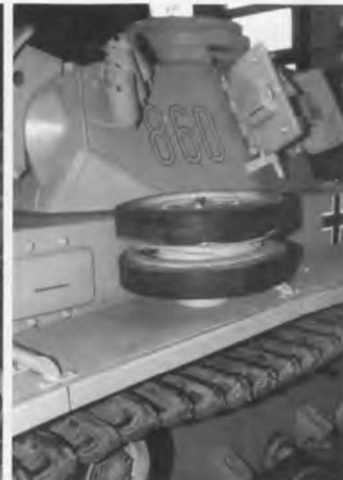
Огнемётный танк Flammpanzer III вид сзади и справа. Обратите внимание на конструкцию воздухозаборников, позволяющих танку без подготовки форсировать броды глубиной до 1,3 м. Башня PzKpfw III Ausf. M, вид слева. Запасной опорный каток установлен на реконструированном креплении.
