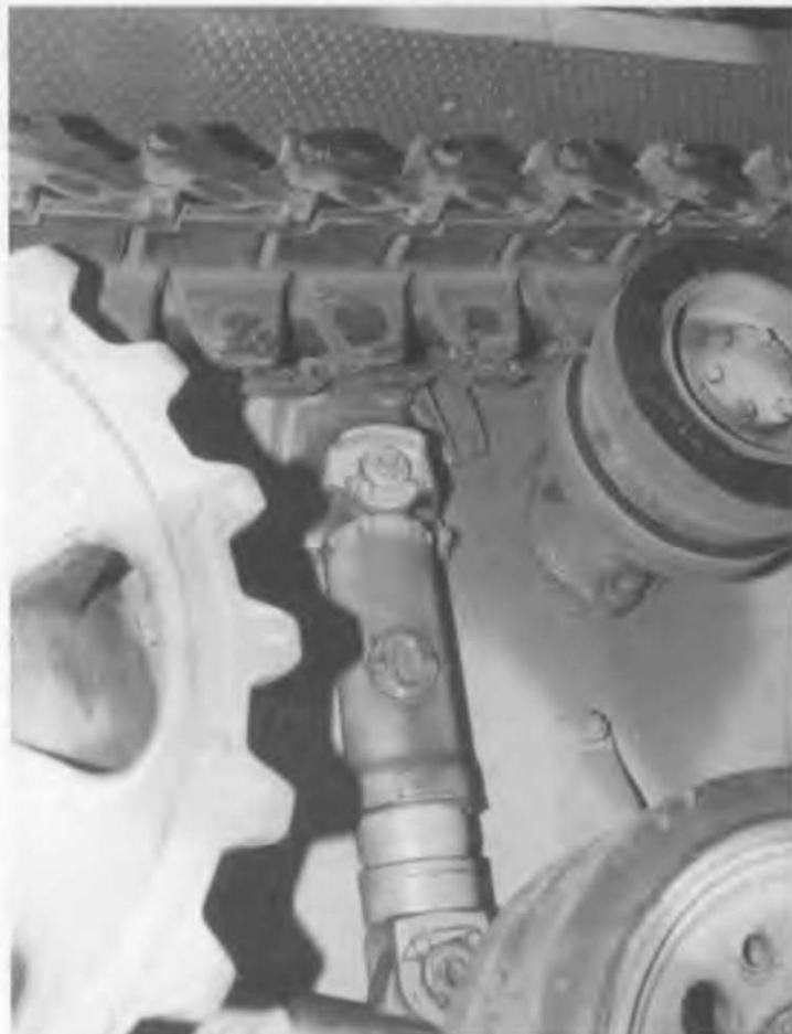
Передний амортизатор, опорный и поддерживающий катки, нижняя поверхность крыла.
