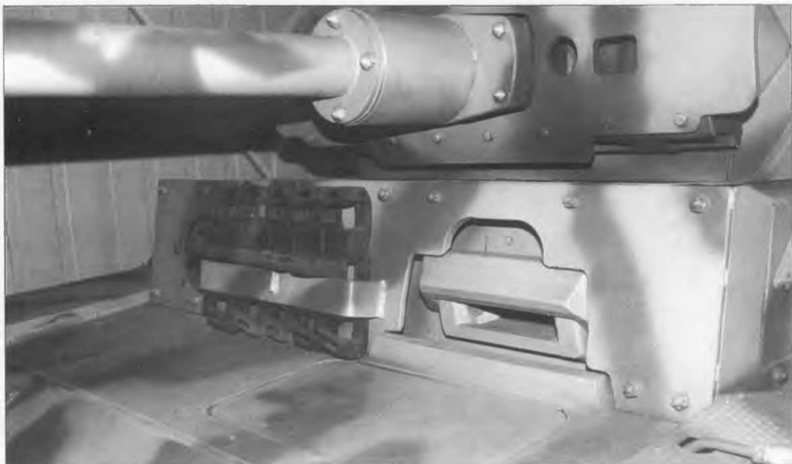
Смотровой прибор механика-водителя. Виден вывод электропровода на левое крыло.
