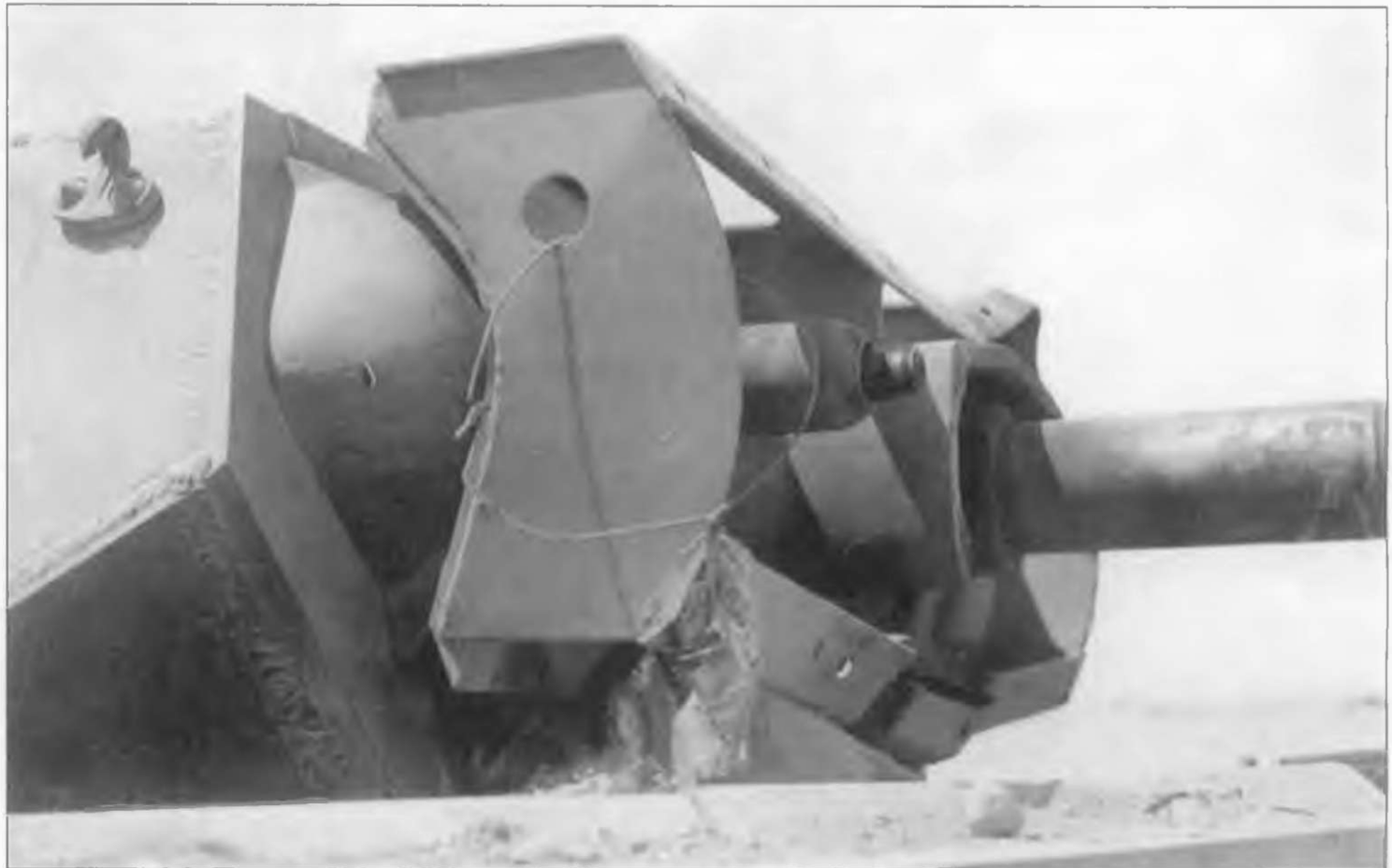
Маска пушки PzKpfw III Ausf. L (бронеплита отсутствует). Танк потерян в Северной Африке.
