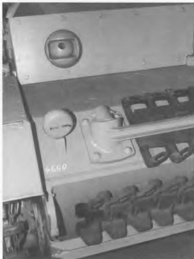
Р-Крфw III Ausf. M. Видна шаровая установка курсового пулемета Kugelblende 50 и накладная броня.
