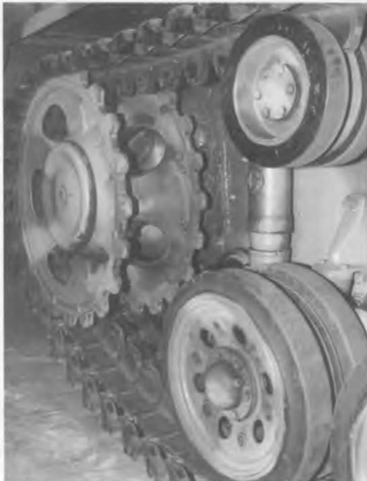
Левое ведущее колесо, передний амортизатор, передний опорный каток и передний поддерживающий каток.
