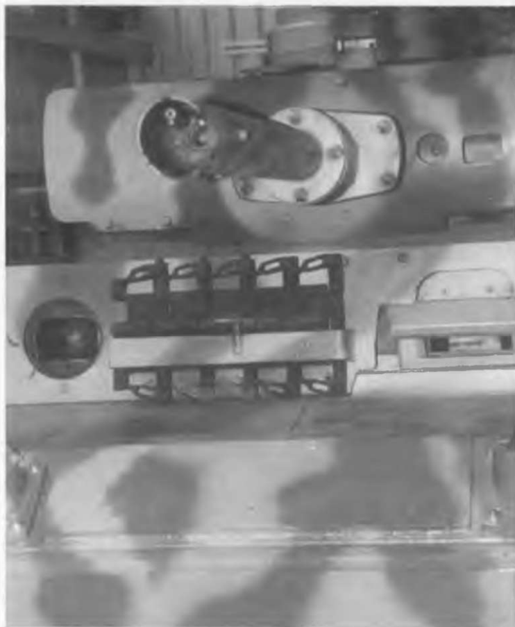
Детали огнемета, вид спереди. Обратите внимание на дополнительную накладную броню, наваренную между воздухозаборниками.
