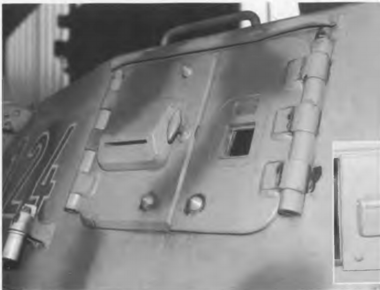
Левый борт башни Flammpanzer III. Видны детали люка.
