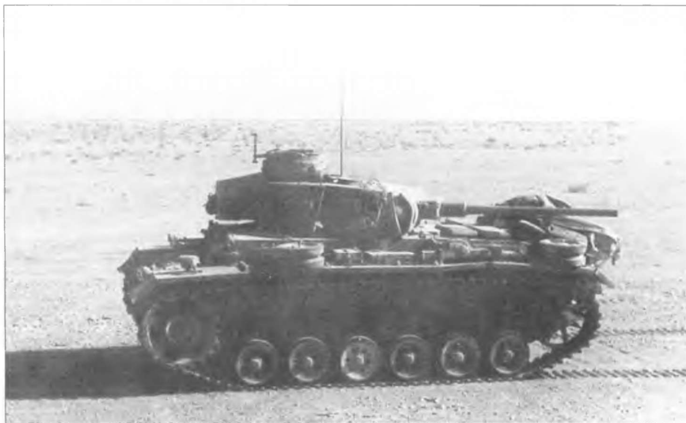
РзКрfw III Ausf. J 5-я рота 8-го танкового полка 15-й танковой дивизии, Северная Африка, лето 1942 г. На башне с трудом виден номер танка - «5». Машина загружена скарбом экипажа. Хорошо видна надмоторная плита с вентиляционными люками.
