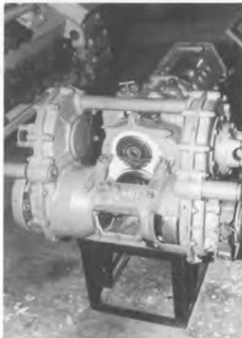
Коробка передач ZF SSG & WrA 705 Amphion. Видна ручка переключения передач, бортовые фрикционы Daimler-Benz-Wilson и барабанные тормоза.
