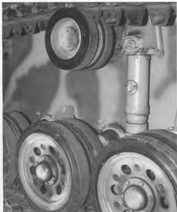
Ходовая часть крупным планом. Виден задний амортизатор.
