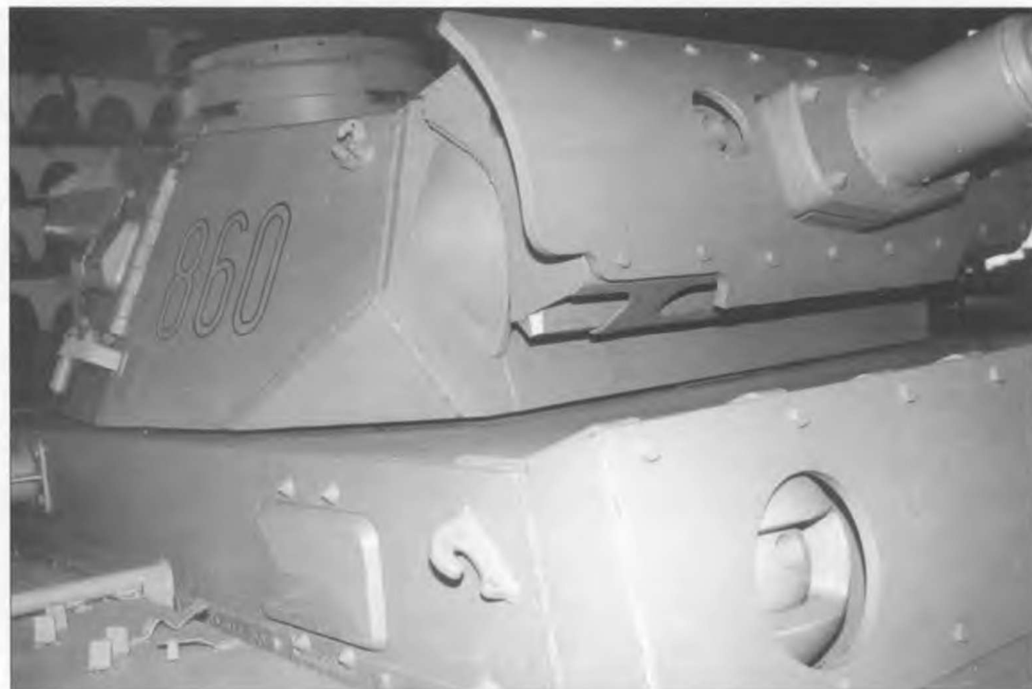
РзКрfw III Ausf. M в музее в Мюнстере. Танк вооружен длинноствольной 50-мм пушкой KwK 39 L/60.
