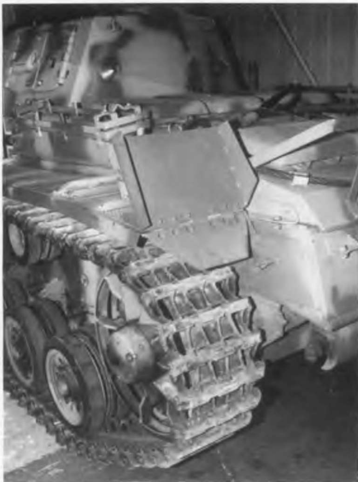
Задняя часть левого крыла в поднятом и опущенном положении. Эта деталь реконструирована.
