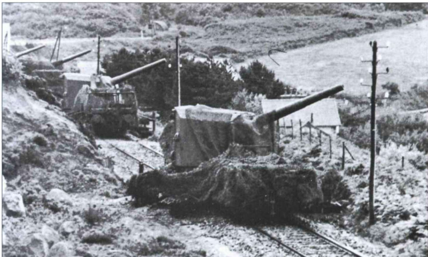
Четыре пушки морской железнодорожной батареи «Гнейзенау». Максимальная дальность стрельбы достигалась при угле возвышения ствола орудия в 45 градусов. На вооружении батареи состояло четыре орудия, которые могли за час выпустить 80 снарядов.
