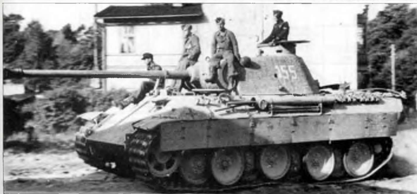
Pz.Bef.Wg Panther в Италии, 1944 г. Машина оборудована тремя штырями (Steckmasten) для увеличения высоты радио-антенны Sternantenne. Видны отличия, характерные для «Пантер» Ausf. D поздней постройки, вроде дождевого щитка над отверстием под оружейный прицел, турель зенитного пулемета на командирской башенке, нанесенное в заводских условиях цинкмеритное покрытие.
