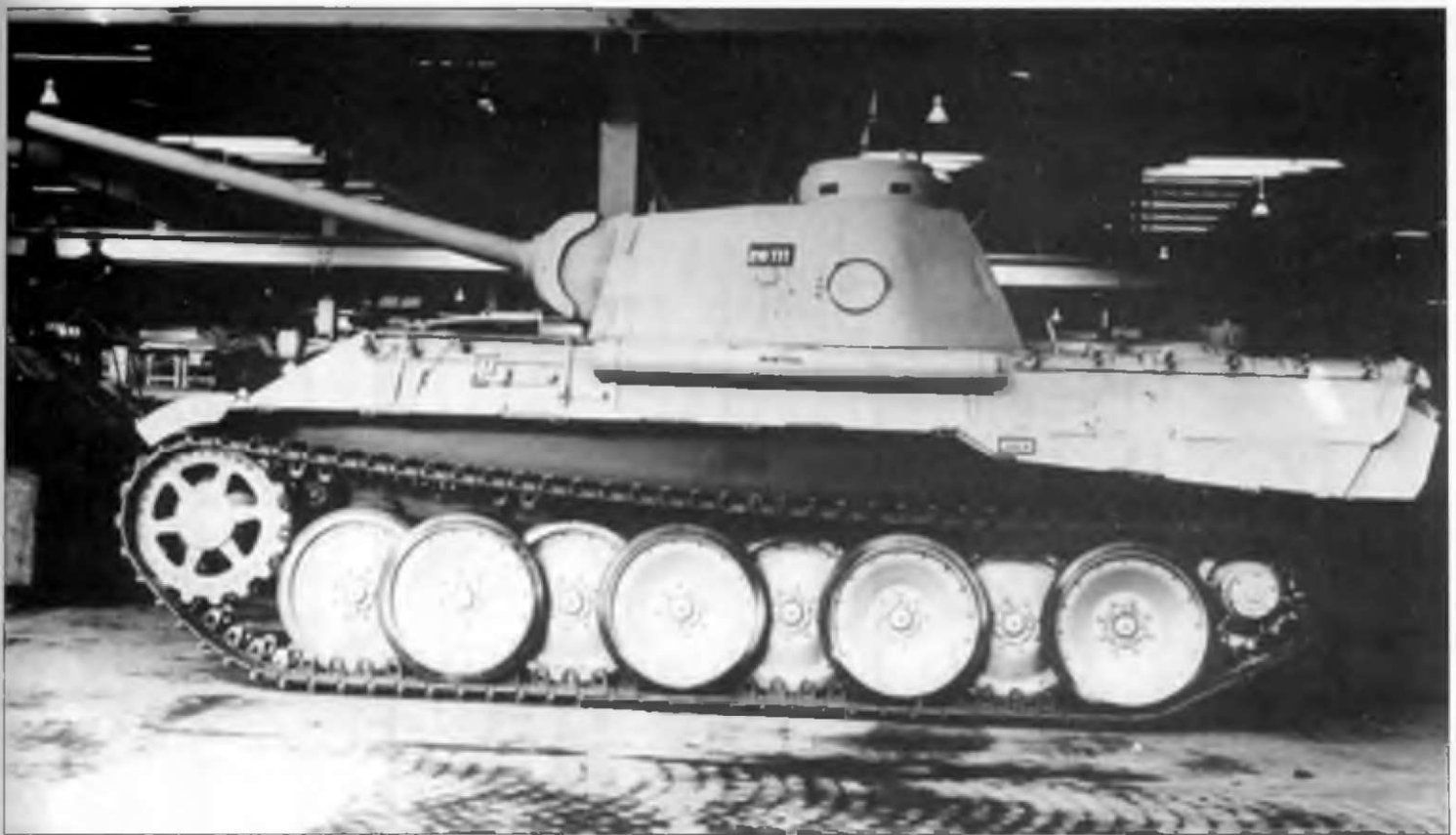
«Пантера» Ausf. D ( Fgst.Nr. 210111) изначально была собрана в конце мая – начале июня 1943 г. – первая машина KV (боеготовая) машина, переделанная по программе перестройки «Пантер». В бортах башни установлены гранатометы Nebelwurfgeraet, бронезаглушкой закрыто отверстие шнорхеля в крыше моторного отделения.
