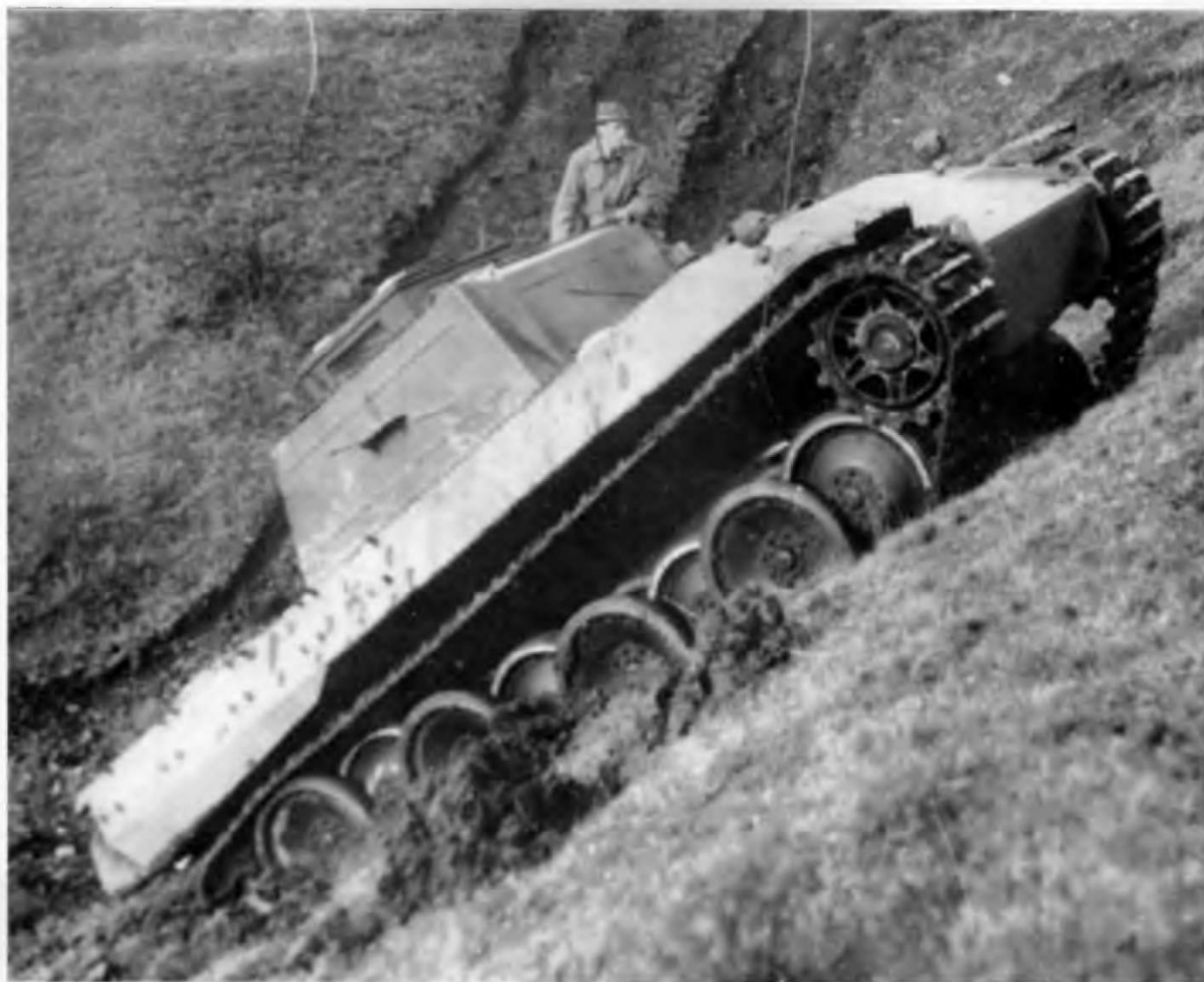
Шасси испытательной серии (Fgst.Nr. V1 было собрано на фирме MAN в сентябре 1942 г.) без башни и с опорными катками, имеющими по 18 крепежных болтов – отличие, уникальное для двух опытных машин Fgst.Nr. V1 и Fgst.Nr. V2.
