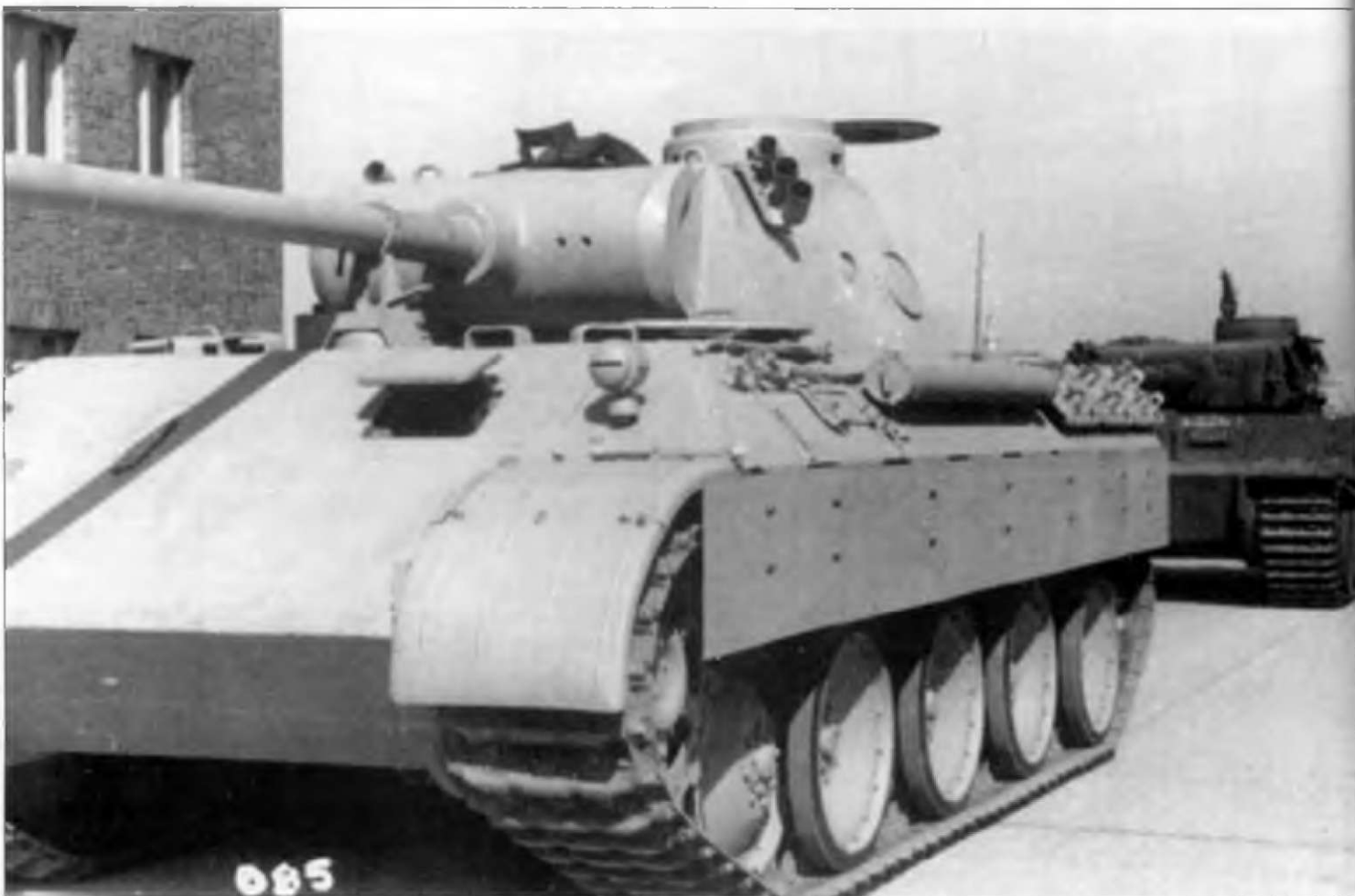
«Пантера» Ausf. D, собранная фирмой Хеншель в начале мая 1943 г. Над пушечной амбразурой установлен дождевой щиток, в наличии коммуникационная амбразура. Рама под инструмент переделана с учетом размещения 450-мм С-образного крюка и буксирного троса большего диаметра. Огнетушитель по правому борту отсутствует. Бронекнопки над воздухозаборником двигателя все еще снабжены ручками.
