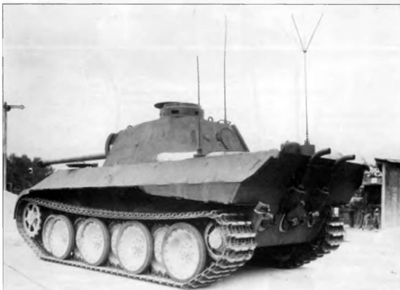
Рз. Bef. Wg Panther (Fgst. Nr. 210137) сборки фирмы MAN июня 1943 г. Машина использовалась для испытаний специалистами Ва Prüf 6. Инструмент и другое полевое оборудование не установлены. Подкрылки выполнены цельными (обычно – составные из двух деталей), отбортовка подкрылков шире, чем обычно.
