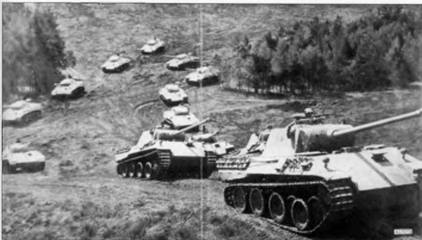
Все 13 построенных танков «Пантера» были показаны министру Шнейеру в Графенвохре 21 февраля 1943 г. Видно, что в противовес злым языкам, ни одна серийная «Пантера» Ausf. D не имела шаровидного дульного тормоза второй опытной машины.
