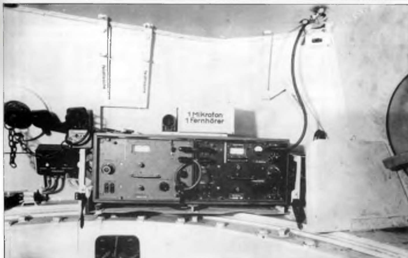
Интерьер башни командирской «Пантеры», Pz.Bef.Wg Panther, собранной фирмой MAN в мае 1943 г. В правом борту башни еще сохранилась коммуникационная амбразура, в правом заднем углу башни поставлена радиостанция Fu-5, соединенная электропроводкой с антенным вводом в крыше башни.
