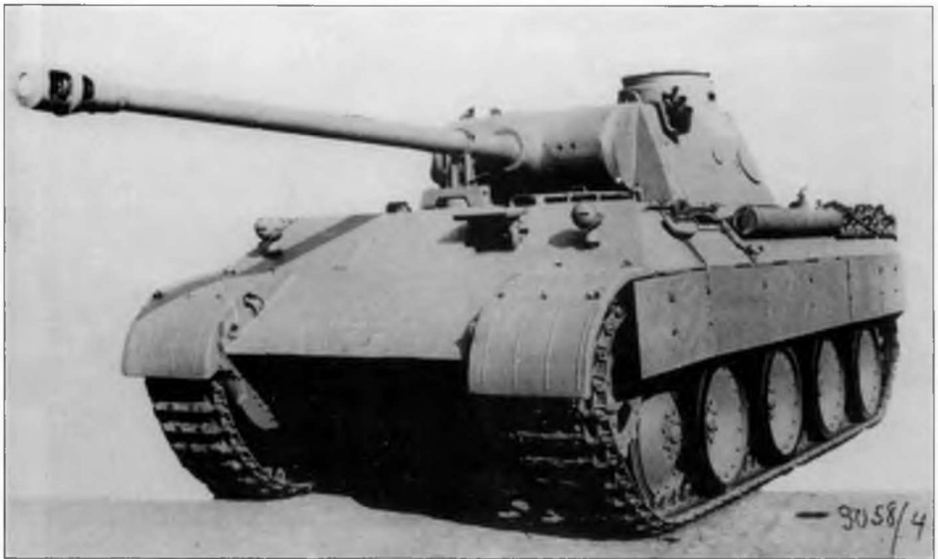
Уникальные предкрылки имелись на «Пантерах» Ausf. D, они крепились к внутренней поверхности корпуса болтами. Бортовые экраны установлены на танк в ходе полевой доработки.
