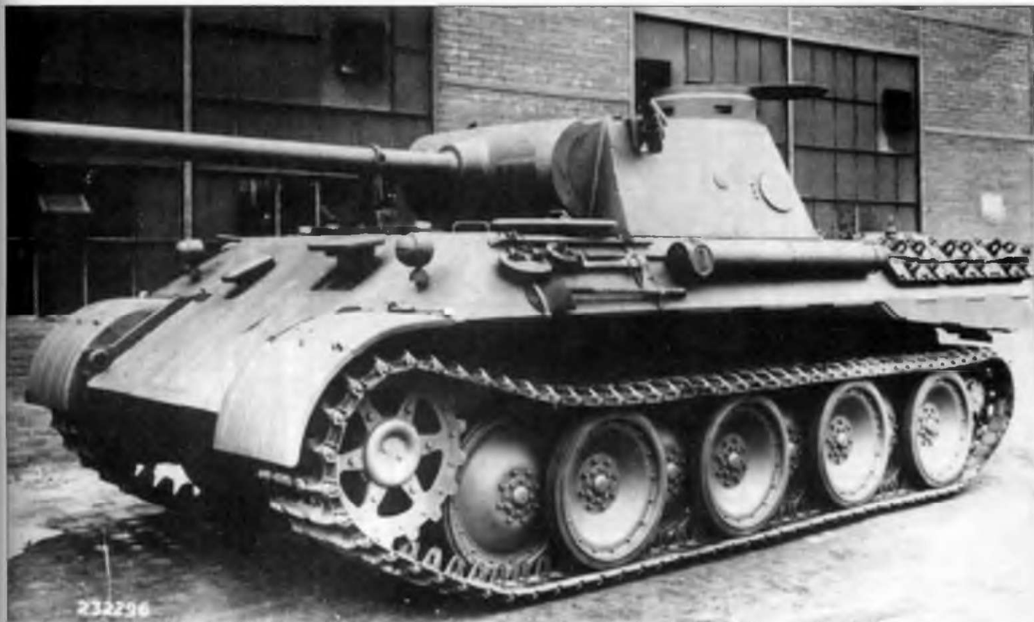
Один из первых танков «Пантера» Ausf. D, собранных фирмой MAN в январе – феврале 1943 г. Машина оснащена оригинальной рамой под инструмент с вертикальными полосками, наваренными на крыше корпуса и ниже надгусеничной полки, крепления бортовых экранов отсутствуют, нет передних монтажных проушин на башне (проушины «конфликтовали» с электропроводкой дымовых гранатометов).
