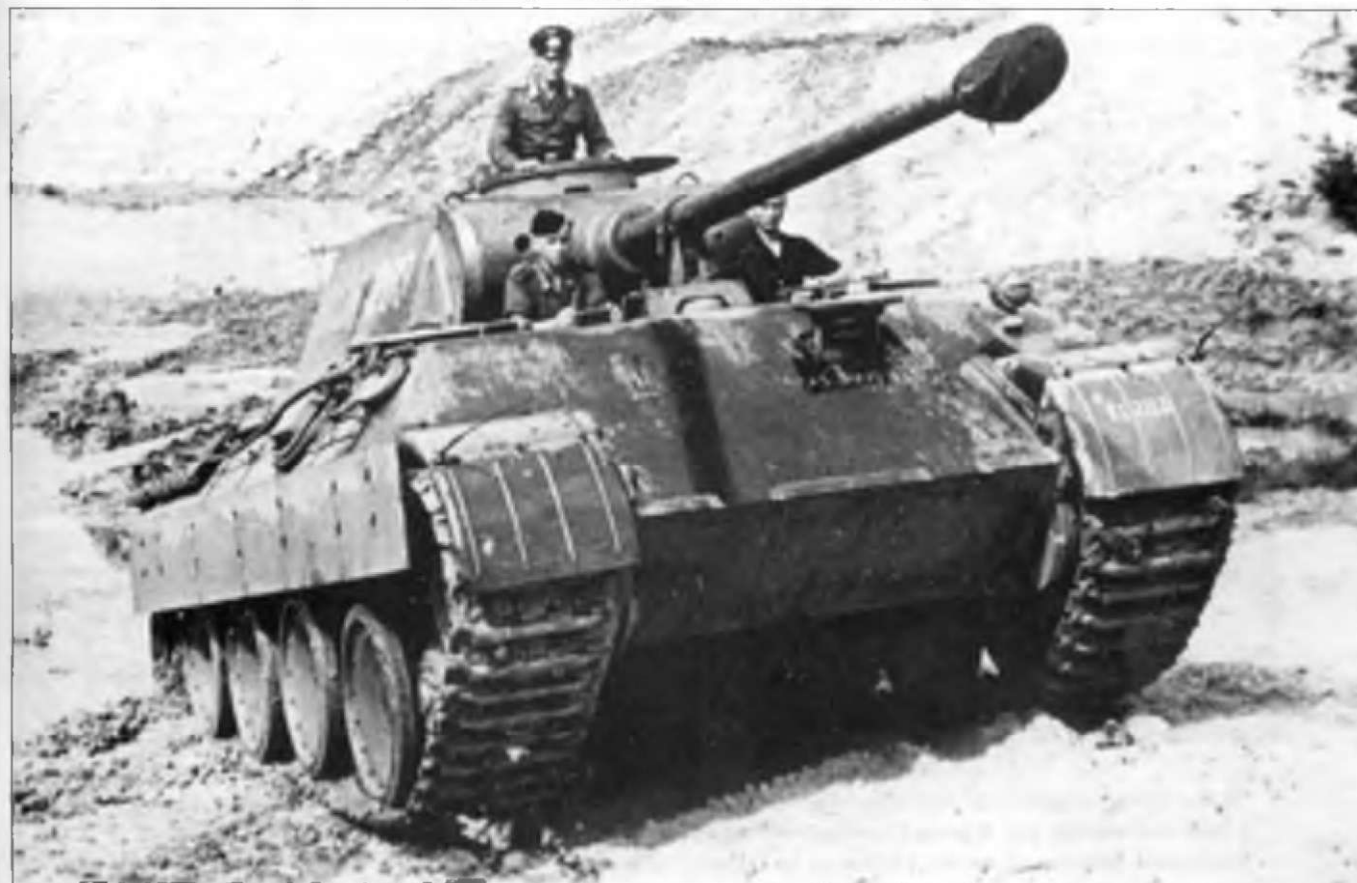
«Пантера» Ausf. D ( Fgst.Nr. 211213) сборки фирмы Даймлер-Бенц августа 1943 г. с кольцом на командирской башенке для монтажа зенитного пулемета, вторая фара Бош в лобовой части корпуса отсутствует.
