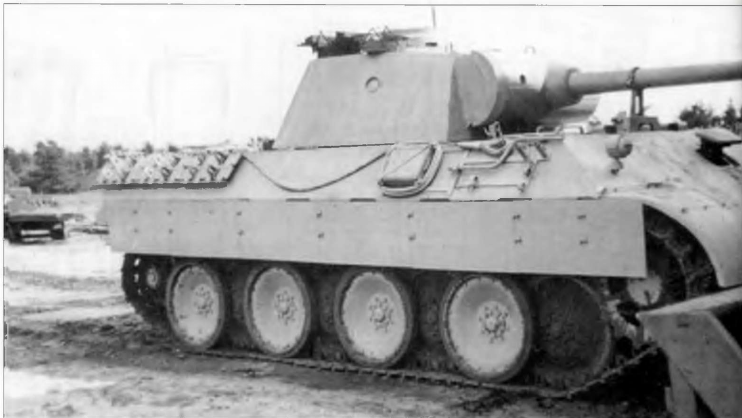
«Пантера» Ausf. D ( Fgst.Nr. 210061, собранная фирмой Хеншель в конце мая – начале июня 1943 г.). Огнетушитель все еще отсутствует, нет и креплений под огнетушитель. Деревянная подложка домкрата зафиксирована стяжками. Прикрепленными болтами к круглому основанию.
