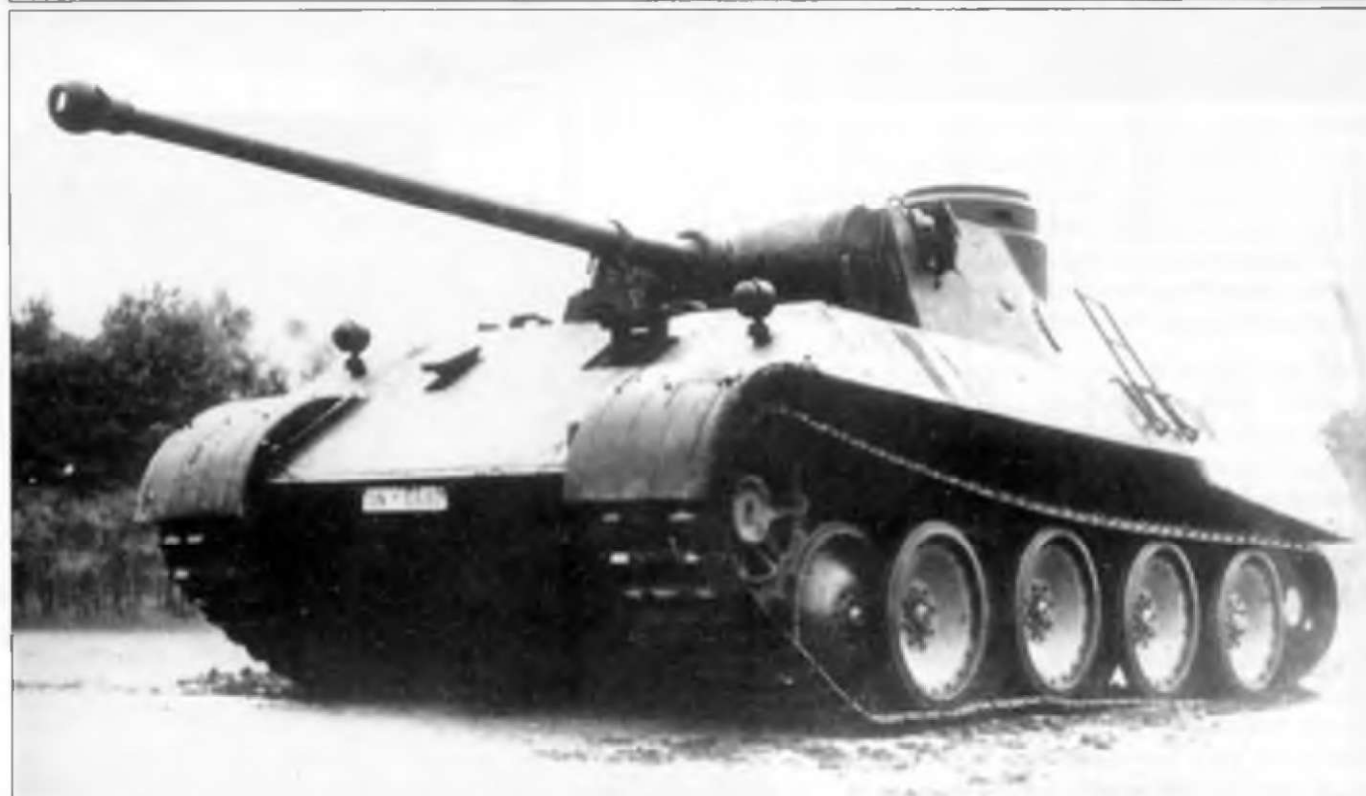
Второе опытное шасси Fgst.Nr. V2 с установленной опытной башней Peilmetall Versuchs-Turm, имевшей скругленные борта и шаровидный дульный тормоз диаметром 220 мм на стволе орудия. Сравните вид сбоку с чертежами фирмы MAN, датированными маем 1942 г.
