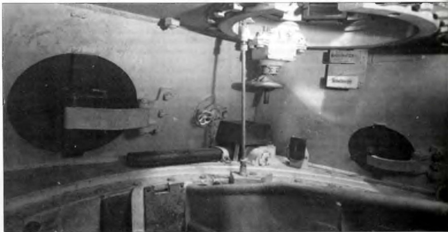
Интерьер задней части опытной башни Versuchs-Turm, в наплыве ниже командирской башенки установлен дымовой гранатомет Neberlkerzen, в опытной башне были много иных уникальных отличий от серийных башен.
