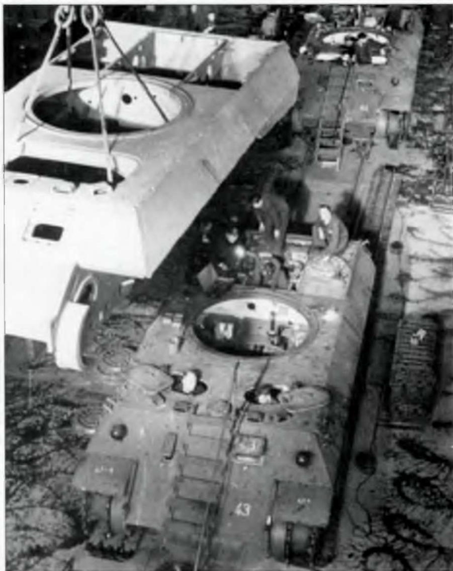
Линия сборки шасси танков «Пантера» на заводе фирмы Хеншель, (Wanne Nr. 211713 сварен фирмой Рурсталь) снабжен перехлестом Wahlweise Ausfuehrung между низом бортов надстройки корпуса и верхом клинообразной ботовой плиты.
