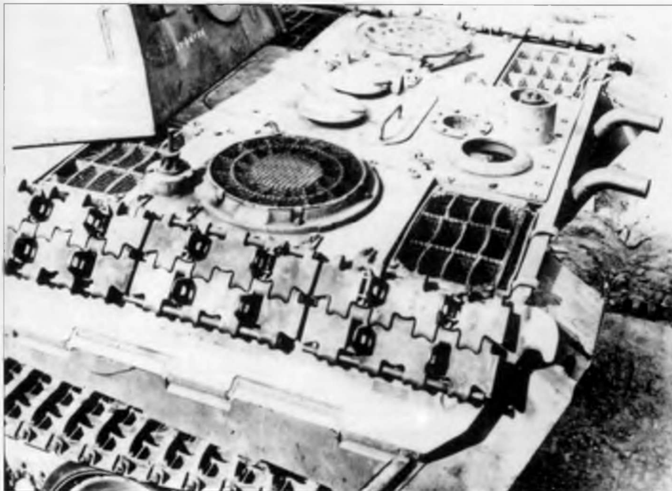
«Пантера» Ausf. D (Fgst.Nr. 213101) сборки фирмы MNH конца мая – начала июня 1943 г. Крыша моторного отделения взята от командирской «Пантеры» выпуска фирмы MAN. Перехлест нижних углов бортов надстройки корпуса и верхних углов клиновидной бортовой плиты выполнен в стиле Wahlweise Ausfuehrung, результатом чего является широкий сварной шов.
