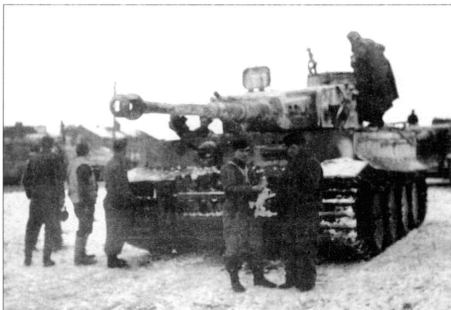
Рз.Крpfw. VI Tiger Ausf. H1 раннего выпуска, зима 1943 г. Подразделение не установлено. Крепление запасных траков на нижнем лобовом бронелисте корпуса с помощью двух полос металла практиковалось в 505-м тяжелом танковом батальоне.
