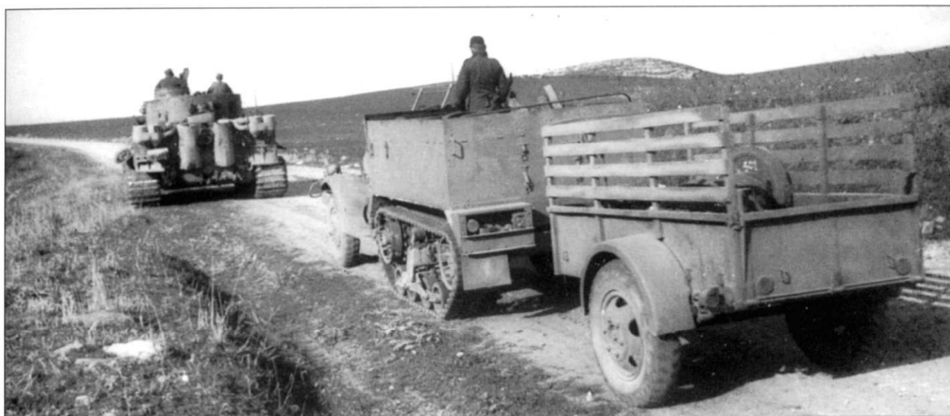
В одной колонне движутся танк «Тигр» и трофейный полугусеничный бронеевтомобиль с прицепом. «Хавтрэк» сохранил свою оригинальную окраску, в прицепе лежат запасные опорные катки к танку «Тигр».
