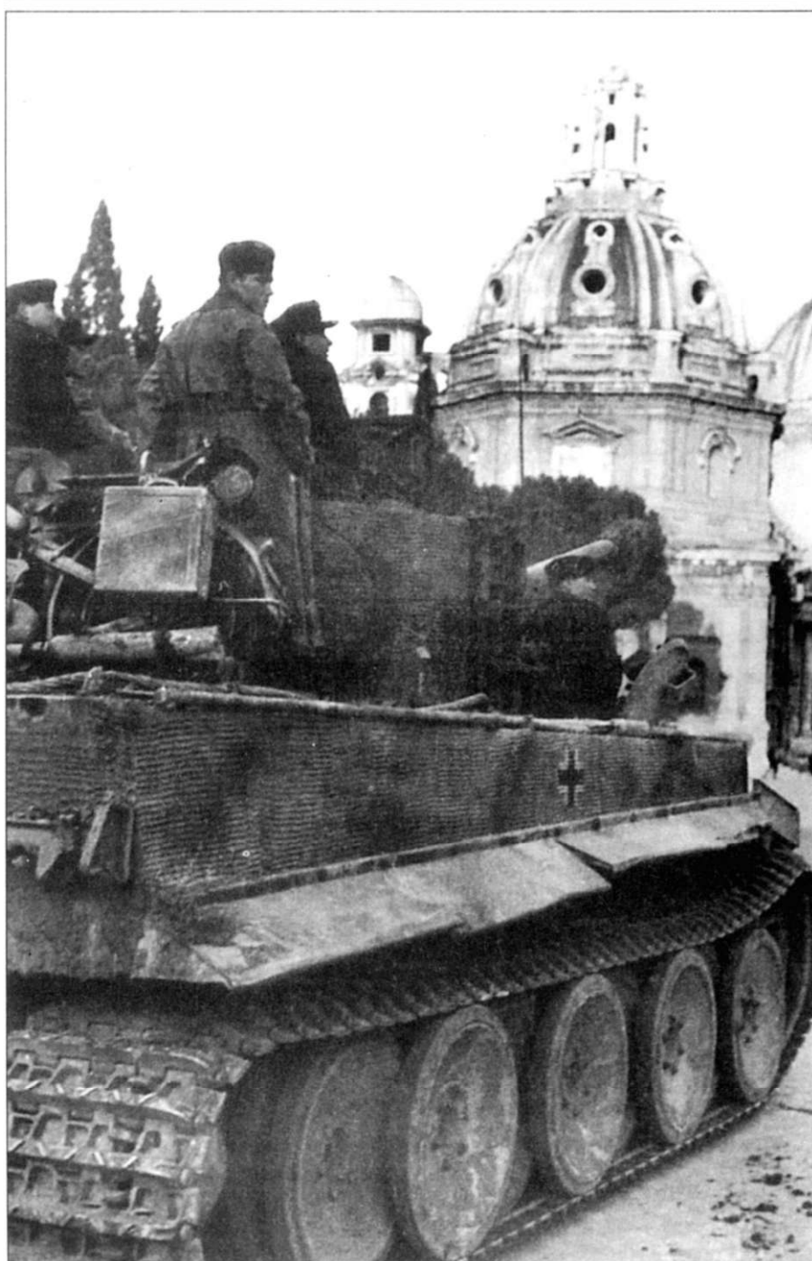
Рз.Крpfw. VI Tiger Ausf. H1 «среднего» выпуска из 508-го тяжелого танкового батальона на улице Рима, март 1944 г. Хорошо видны траки нового типа и циммеритное покрытие на корпусе и башине. На крышу моторного отделения погружен мотоцикл DKW.
