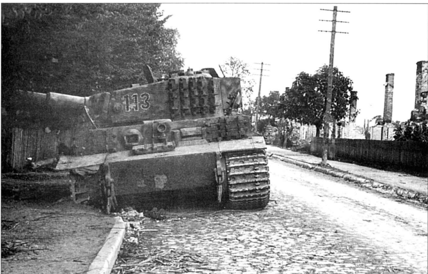
Тот же танк. Хорошо видны гусеничные траки, которые использованы как накладная броня на борту башни и на лобовом бронелисте надстройки корпуса.
