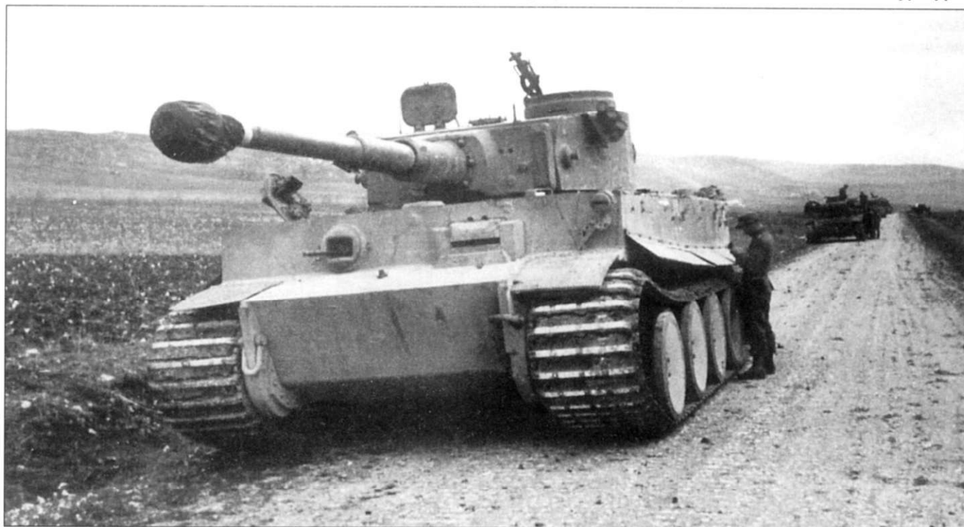
Колонна танков Pz.Kpfw. VI Tiger Ausf. H1 «африканской модели» раннего выпуска. Танки остановились на осмотр, Тунис, весна 1943 г. Обратите внимание на узкие передние подкрылки, перенесенную на лобовой лист надстройки корпуса фару, эпископ KKF-2 механика-водителя. На маске орудия (ниже отверстий под оптический прицел) видны следы от попадания снарядов. На заднем плане стоит танк Pz.Kpfw. III, за ним - снова «Тигры».
