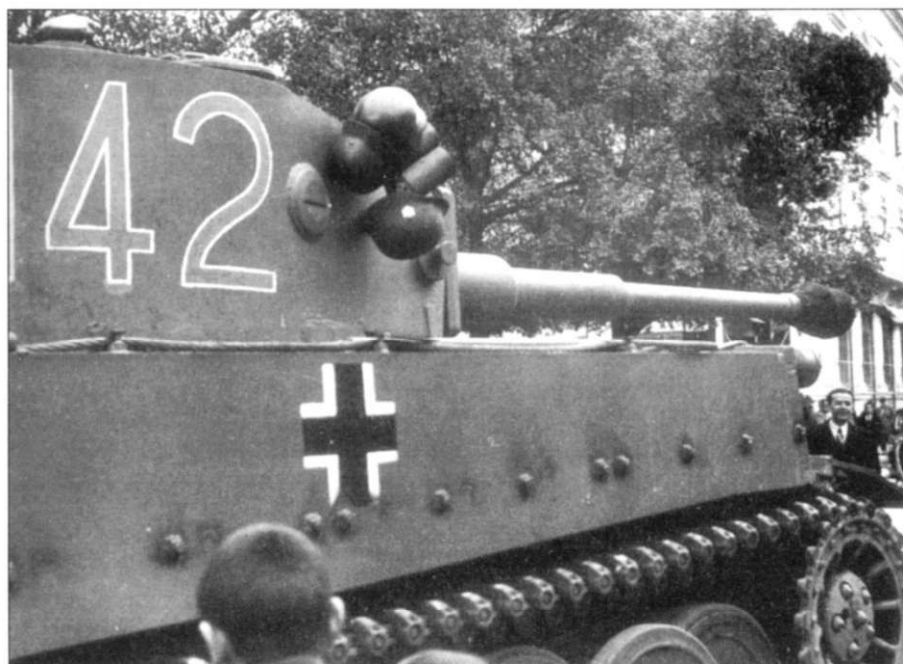
Обратите внимание - краска цифр тактического номера танка из 501 батальона темнее краски, которой окрашен сам танк. Скорее всего - на базовый цвет RAL 70-28 нанесена серо-зеленая краска RAL 7008. Батальон формировался в мае 1942 г. в Эрфурте, в ноябре того же года был отправлен в Тунис. В Северную Африку подразделение прибыло еще не укомплектованным до полного штата, положенные батальону танки «Тигр» и Pz.Kpfw III продолжали поступать мелкими партиями. Танки Pz.Kpfw III состояли только на вооружении 1-й роты. До 17 марта 1943 г. танкисты s.Pz.Abt. 501 уничтожили примерно 150 танков союзников. К этой дате уцелевшие 11 танков «Тигр» из 501-го тяжелого танкового батальона были переданы в s.Pz.Abt. 504. 501-й батальон потерял в боях десять «Тигров», семь из них - под Беджой. Всего батальон использовал в Тунисе 21 танк «Тигр» (по другим данным 23).
