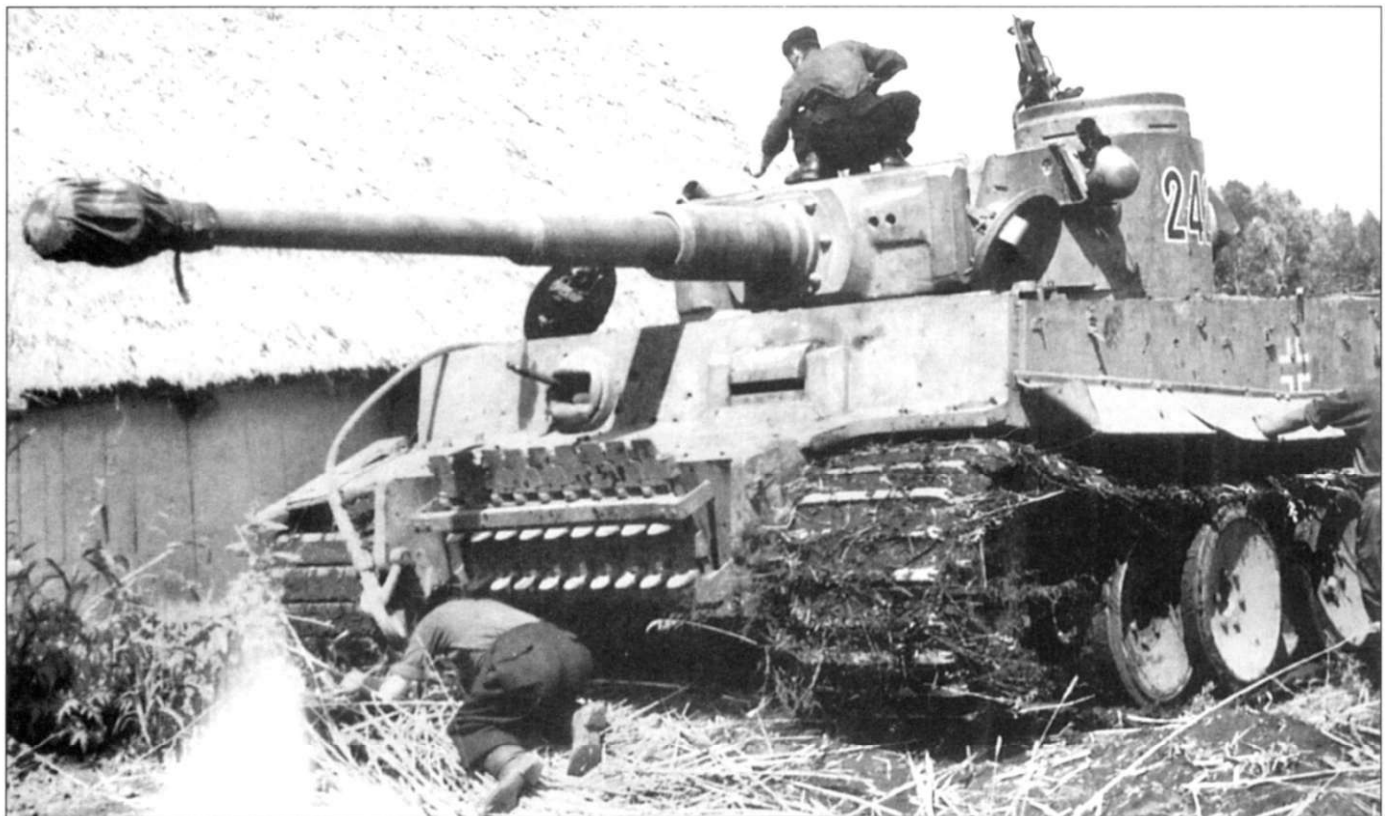
Техническое обслуживание «Тигра» из 4-го взвода 2-й роты 503-го тяжелого танкового батальона на остановке в длительном марше, район Белгорода, август 1943 г. На снимке хорошо виден способ крепления запасных гусеничных траков с помощью двух полос. Левый передний подкрылок оторван совсем, а передняя секция крыла отогнута. На борту башни рядом с дымовыми гранатометами видна отметина от противотанкового снаряда.
