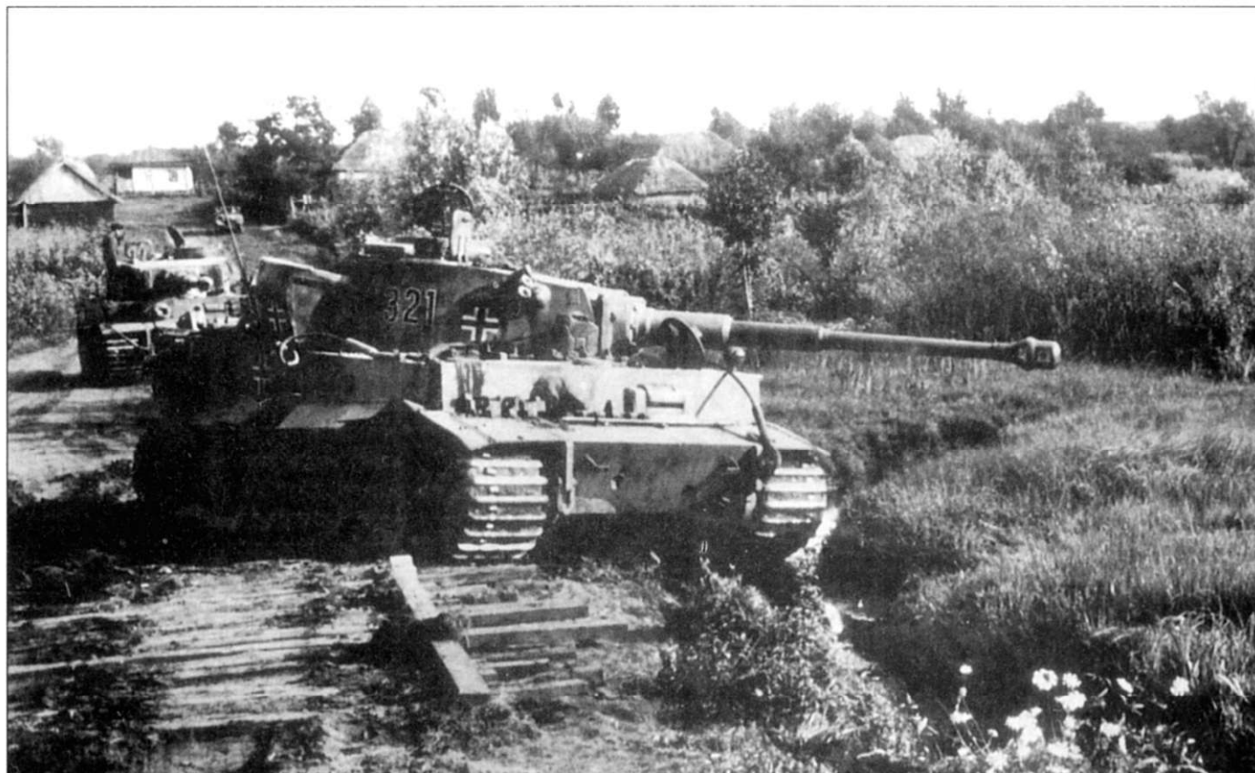
Pz.Kpfw. VI Tiger Ausf. H1 командира 2-го взвода 1-й роты 503-го тяжелого танкового батальона, Россия, лето 1943 г. Кресты с бортов башни исчезли очень быстро - они оказались хорошими прицельными метками для наводчиков противотанковых орудий противника. На этом «Тигре» башенные кресты еще не покрашены.
