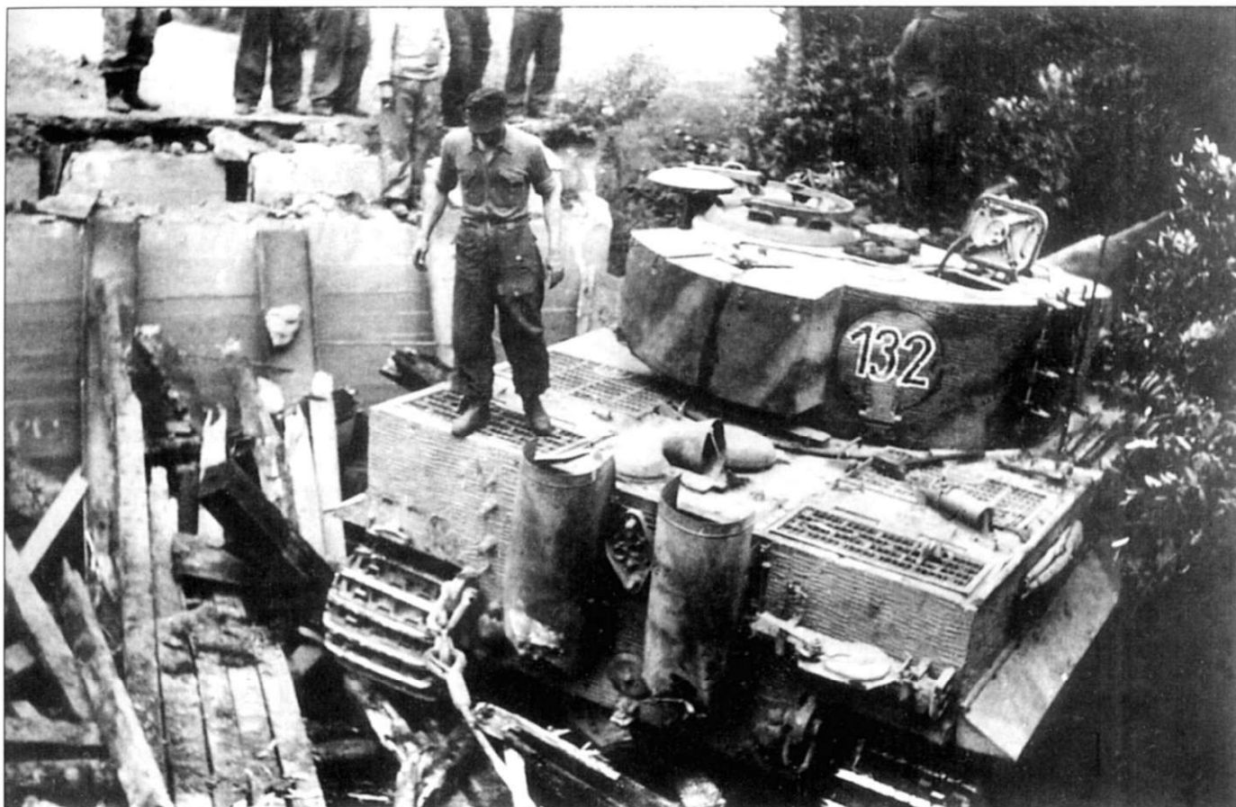
Типичная картина - «Тигр» продавил мост. Танк принадлежит 3-му взводу 1-й роты 503-го тяжелого танкового батальона. Башня - позднего выпуска: литая командирская башенка со сдвижным люком, изменено место установки колпака вентилятора, установлена мортирка для самообороны и епископ заряжающего. Корпус, наоборот, ранней постройки. Танк оснащен двигателем HL-210 P-30 - хорошо виден узел для крепления инерционного стартера между кожухами выхлопных патрубков. Фильтры Feifel сняты. Корпус и башня покрыты циммеритом.
