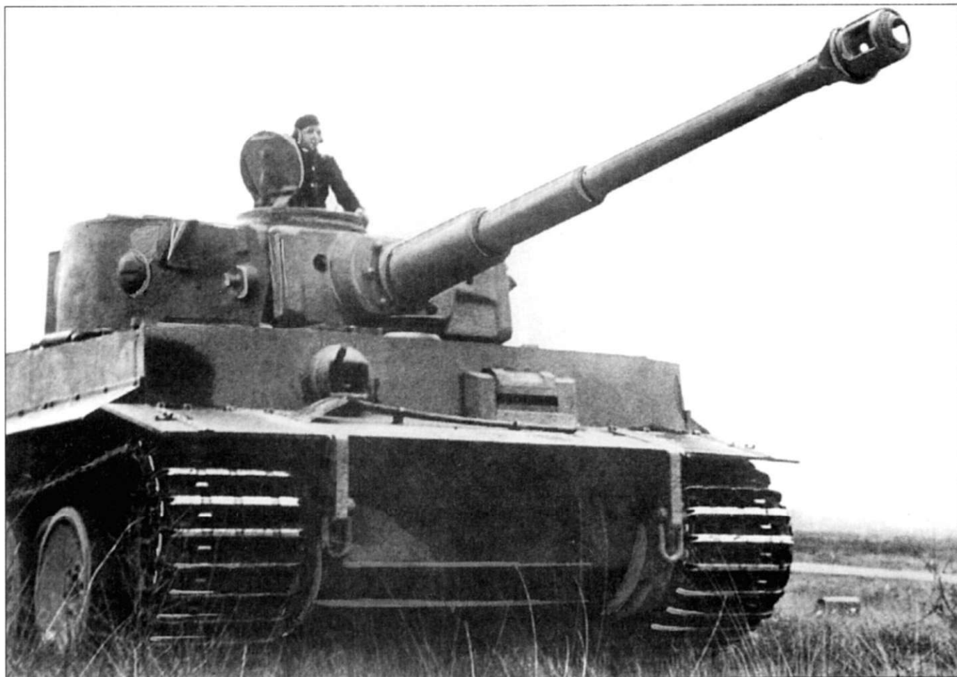
«Тигр» «позднего раннего» выпуска. Дымовые гранатометы с башни сняты, однако кронштейны под них остались.
