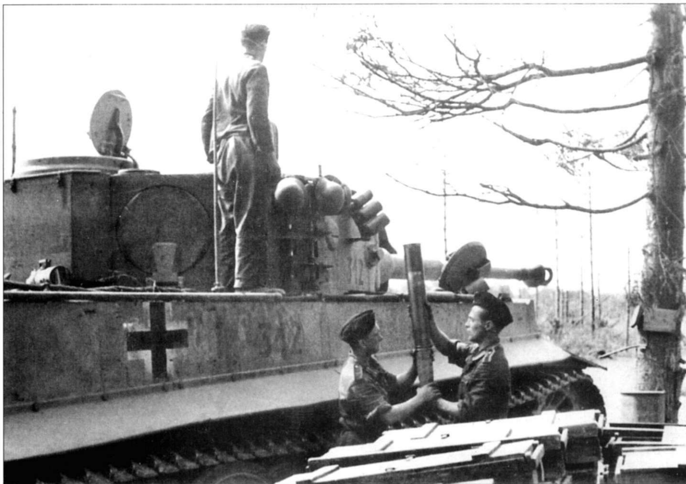
Погрузка боекомплекта на «поздний» «Тигр» раннего выпуска. Танк принадлежит 1-му взводу 3-й роты 503-го тяжёлого танкового батальона. Два танкиста держат в руках снаряд Sprenggranatpatrone L/4,5.
