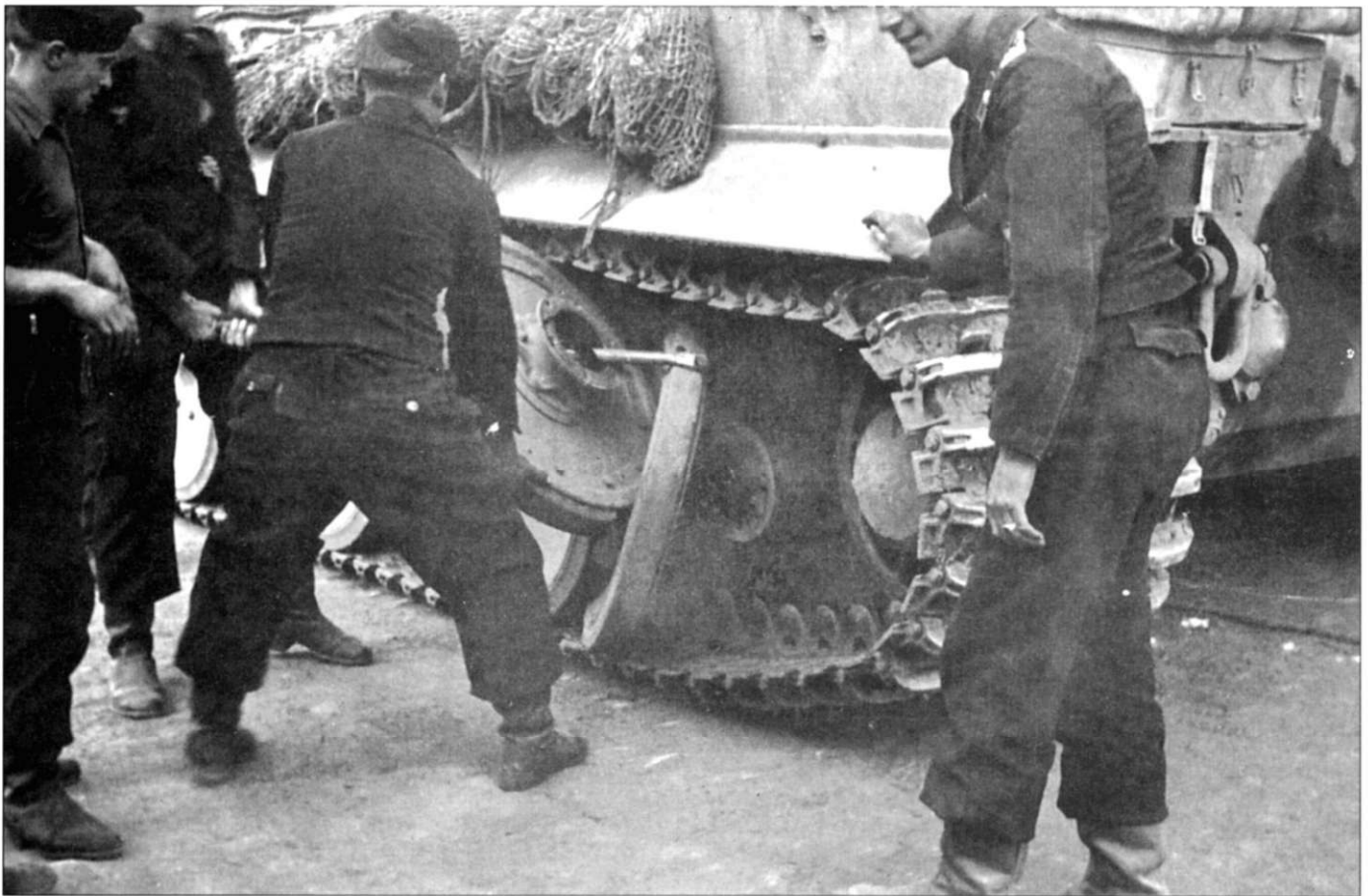
Если замена траков на «Тигре» - тяжелая работа, то снятие опорных катков - каторга.
