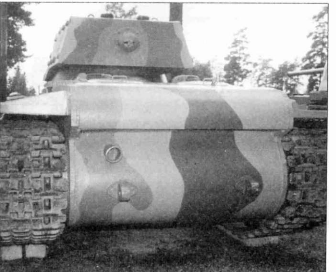
Упор балансиров и механизм натяжения гусеницы за ленивцев.
