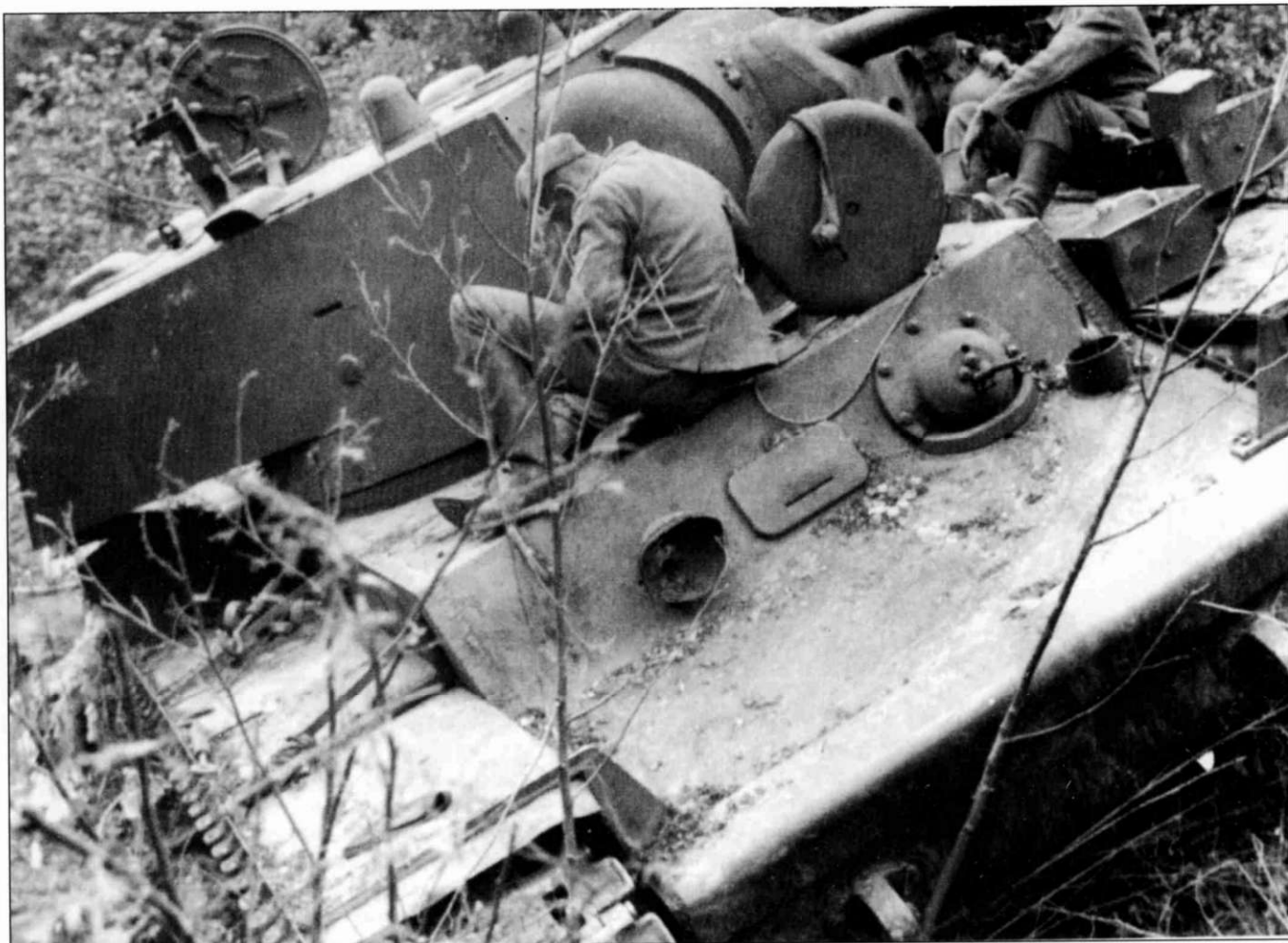
Несколько танков KV-1 проекта 1940 г., с непонятным отверстием в маске пушки (ниже основания ствола). Возможно это отверстие для доступа при установке другого орудия (не Ф-32). Нужно заметить, что монтаж в этом месте пулемета практически невозможен.
