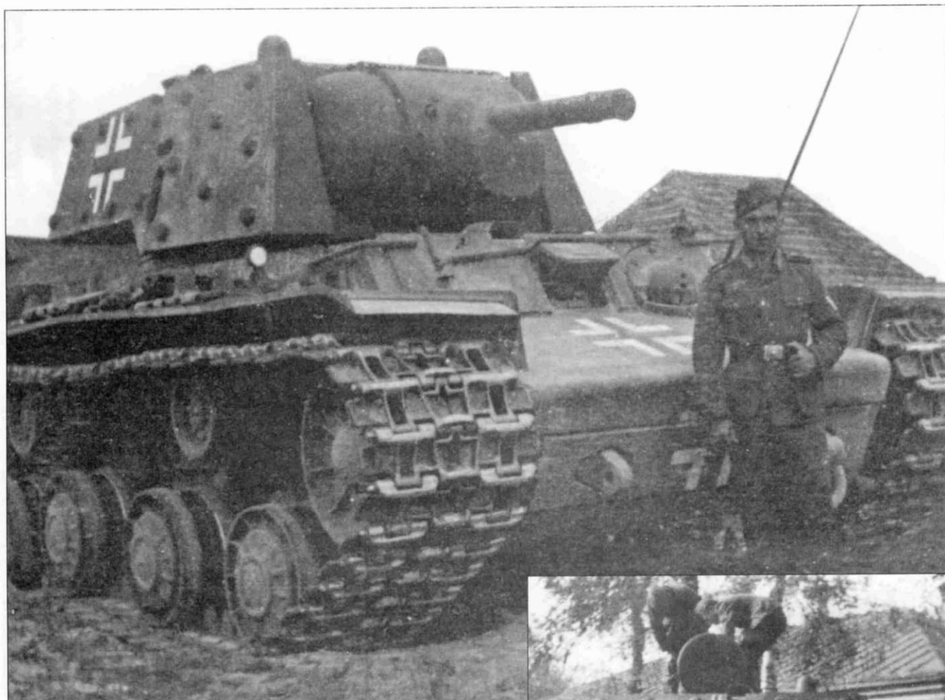
Panzerkampfwagen KV-IB 755 (r) - танк КВ-1 с экранами на базе танка проекта 1940 г. Дополнительные экраны установлены как на башне, так и на корпусе машины. Нанесение изображения Valkenkreuz на наклонных лобовых листах корпуса довольно необычно для захваченных немцами КВ.
