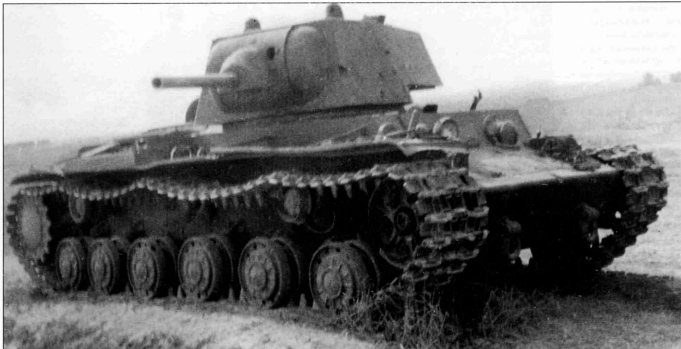
На танках KV-1 проекта 1939 г. ЛКЗ последних производственных серий уже начал монтироваться 7,62 мм курсовой пулемет в шаровой установке. Прямоугольные очертания кормовой части башни хорошо видны при виде сбоку. Машина представленная на этом снимке, была потеряна не в результате отказа материальной части, как это имело место с многими танками типа KV, а из-за боевых повреждений - следы от многочисленных попаданий можно видеть на левом борту башни.
