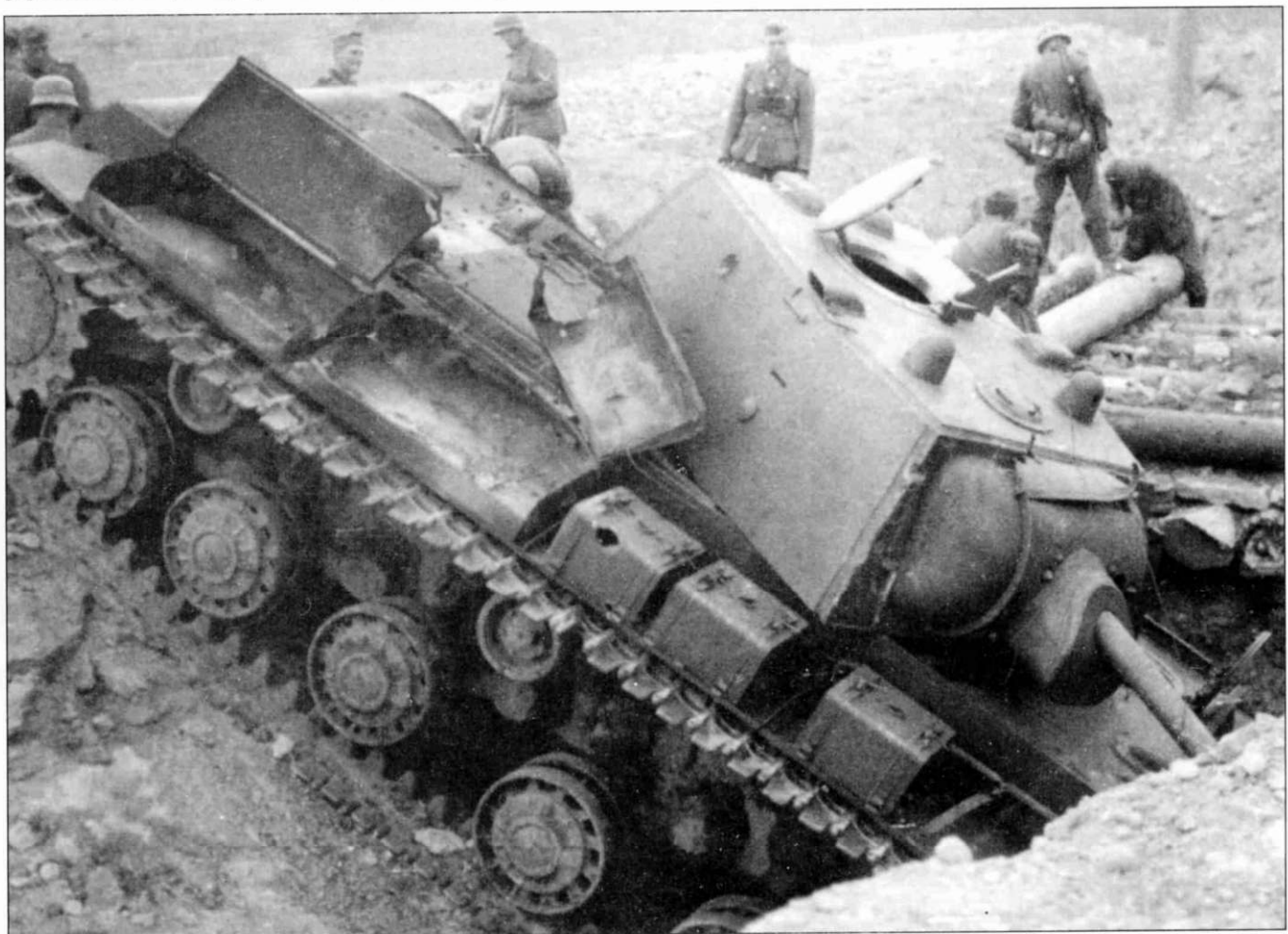
Имеется очень мало фотографий KV-1 с дополнительными бачками коробчатой формы сделанные в боевых условиях. Обычно в частях их снимали. Представленный здесь снимок позволяет более подробно изучить крепление бачков на надгусеничных полках, а также детали крыши сварной башни проекта 1941 г. Обратите внимание на люк командира танка и приборы наблюдения.
