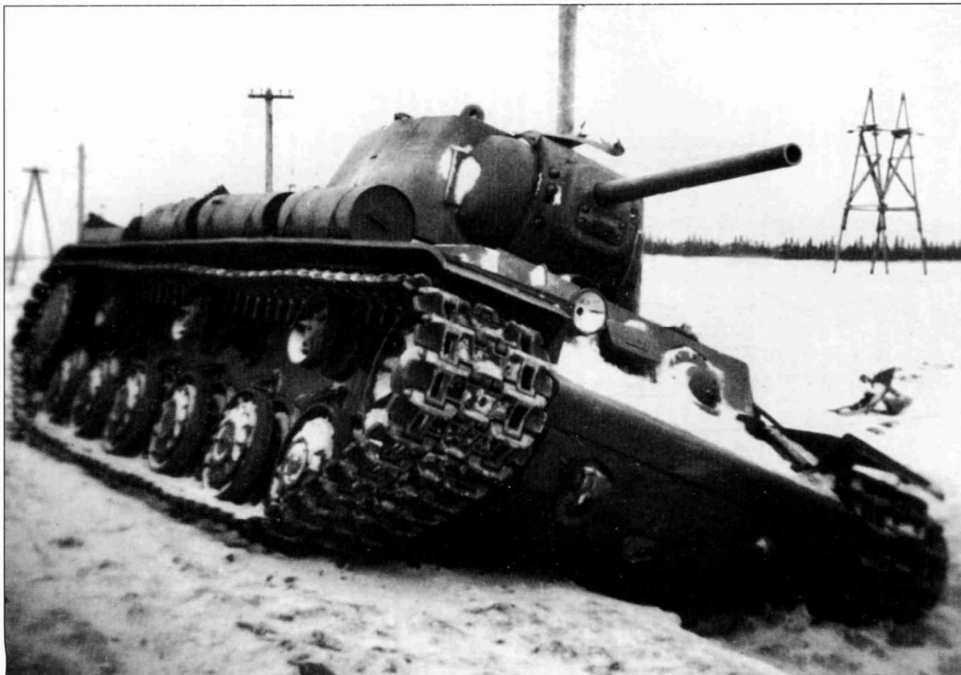
КВ-1 проекта 1940 г. производства ЧТЗ с двигателем М-17.
