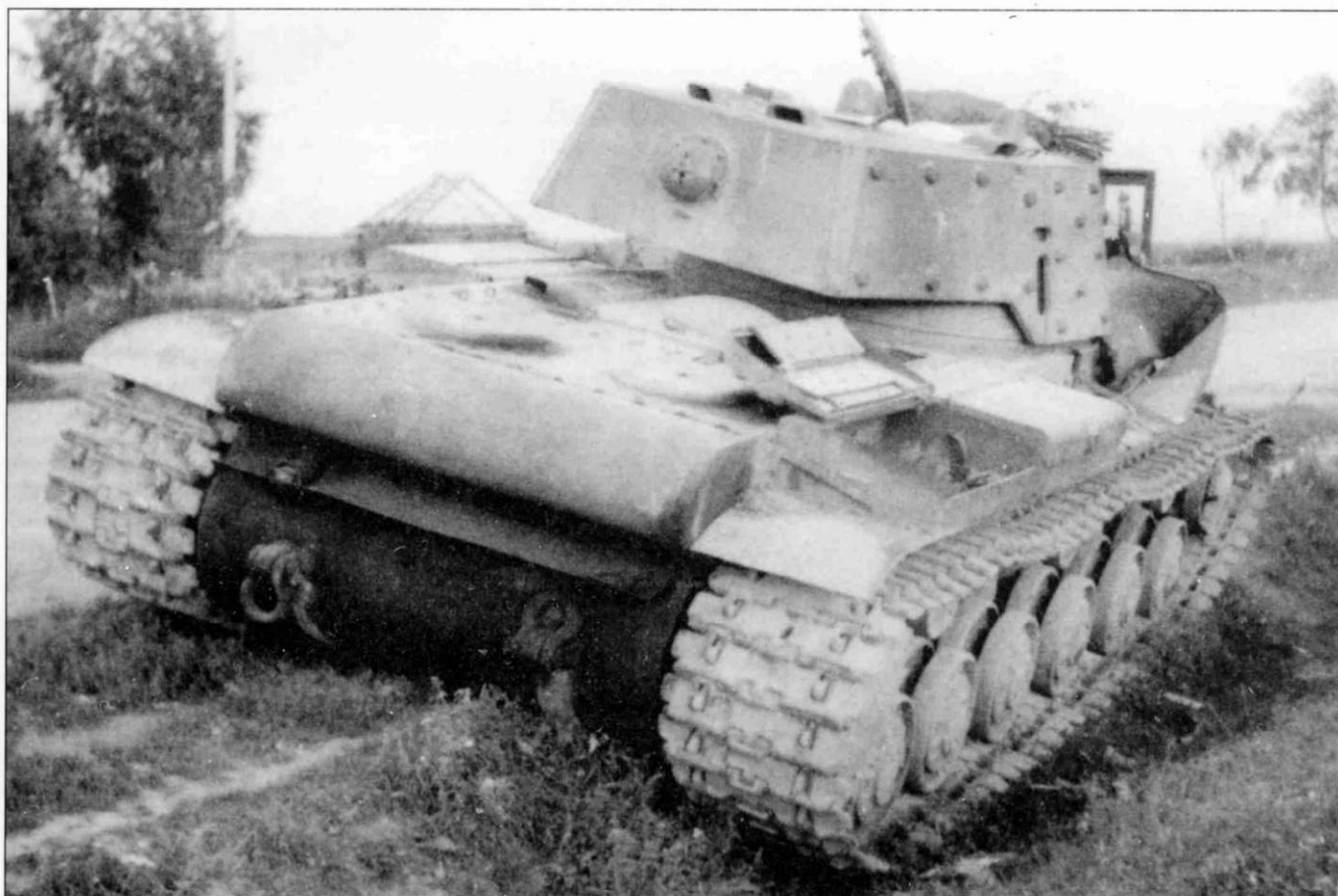
KV-1 проекта 1940 г. поздних производственных серий (дополнительная наварная броня) с экранами (на корпусе и башне). Крышка ящика укладки открыта.
