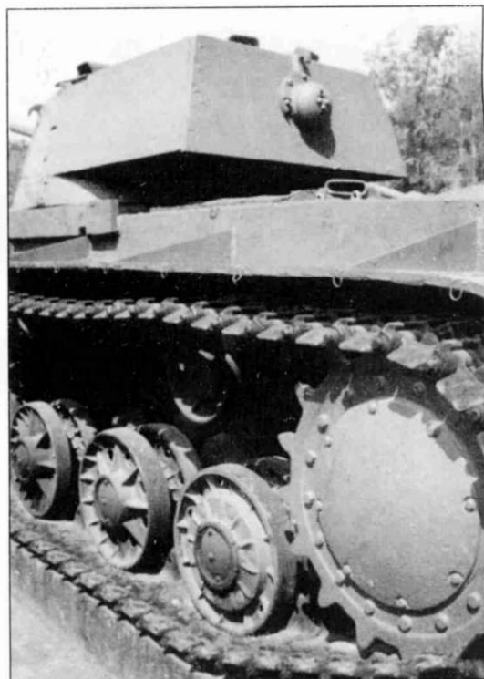
Кормовая часть корпуса с узлами ходовой части: ведущим колесом, опорными катками и поддерживающими роликами позднего типа. Обратите внимание на кронштейны для удаления грязи с ведущего колеса.
