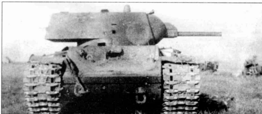
Конструкция обоих вариантов танка KB-1 проекта 1939 г. ЛКЗ, за исключением наличия или отсутствия курсового пулемета в шаровой установке, идентична. В отличие от опытных машин, на серийных танках отсутствовал ряд из семнадцати крепежных болтов в месте стыка передних наклонных листов корпуса.
