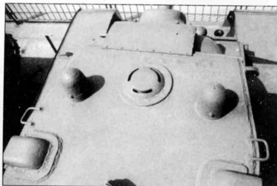
Крыша башни (вид спереди). Все неподвижные перископы на крыше башни и у механика-водителя имеют защитную бронировку, углы их обзора 250 по горизонтали и 20 по вертикали. Для всего экипажа находящегося в башне: командира, наводчика и заднего пулеметчика-заряжающего имелся только один посадочный люк!
