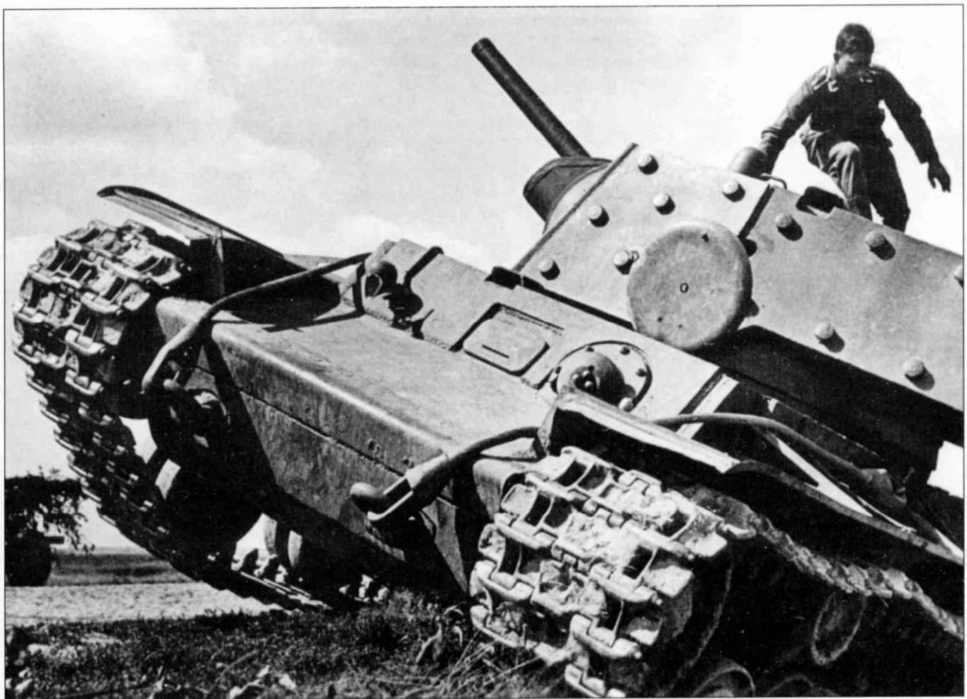
КВ-1 проекта 1940 г. поздних производственных серий (дополнительная наварная броня) с экранами (на корпусе и башне). Хорошо видны массивные болты, которыми экраны крепились к броне. Обратите внимание на вырезы в броневых экранах под перископы на крыше башни.
