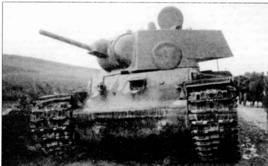
Первые серийные танки KB-1 проекта 1939 г. ЛКЗ, еще не имели пулемета в шаровой установке в лобовом листе корпуса, вместо этого здесь имелась амбразура для стрельбы из личного оружия, закрываемая круглой пробкой, которая хорошо видна на этой фотографии.
