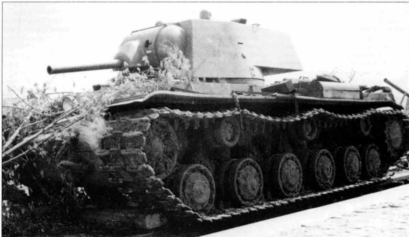
КВ-1 проекта 1939 г. ЛКЗ, во время транспортировки по железной дороге. Танки проекта 1939 г. имели довольно сложные в производстве технические решения, например маску орудия. На более поздних машинах многие узлы были значительно упрощены, чтобы уменьшить трудозатраты необходимые для их производства и обеспечить их массовое производство.
