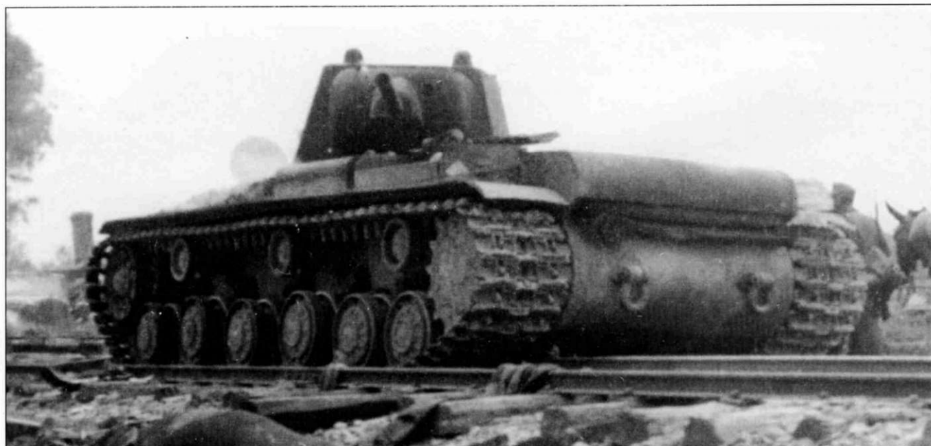
Танк KV-1 проекта 1939 г. ЛКЗ, с округлой формой кормовой части корпуса, типичной для всех моделей танка до конца 1941 года.
