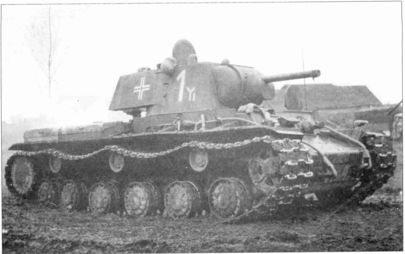
На следующих двух фотографиях танки Panzerkampfwagen KV-1A 753 (r) этого же подразделения, вероятно из состава 8-й Panzerdivision, во время обучения водителей на Восточном фронте. Обратите внимание на расположение установленных антенн немецкого образца и необычной формы листы брони в верхней части борта корпуса.
