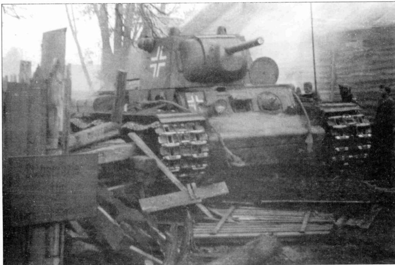
Трофейный КВ-1 проекта 1940 г. поздних производственных серий с уже наваренными листами дополнительной брони на лобовой части и бортах корпуса - Panzerkampfwagen KV-1A 753 (r). На башне и корпусе нанесены немецкие опознавательные знаки увеличенного размера.
