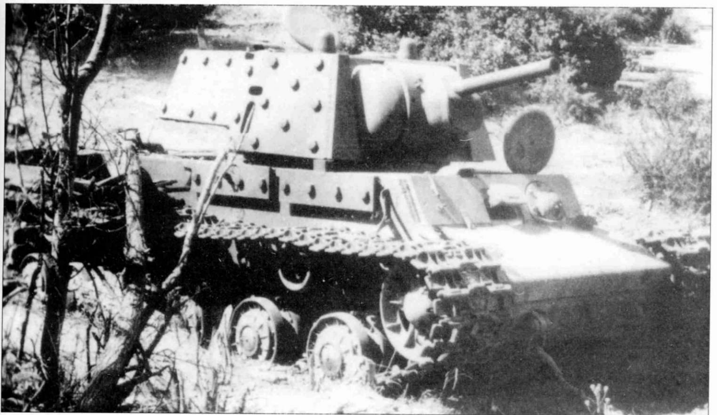
Благодаря сорванной надгусеничной полке хорошо видны экраны, установленные на корпусе и башне этого танка КВ-1 проекта 1940 г.
