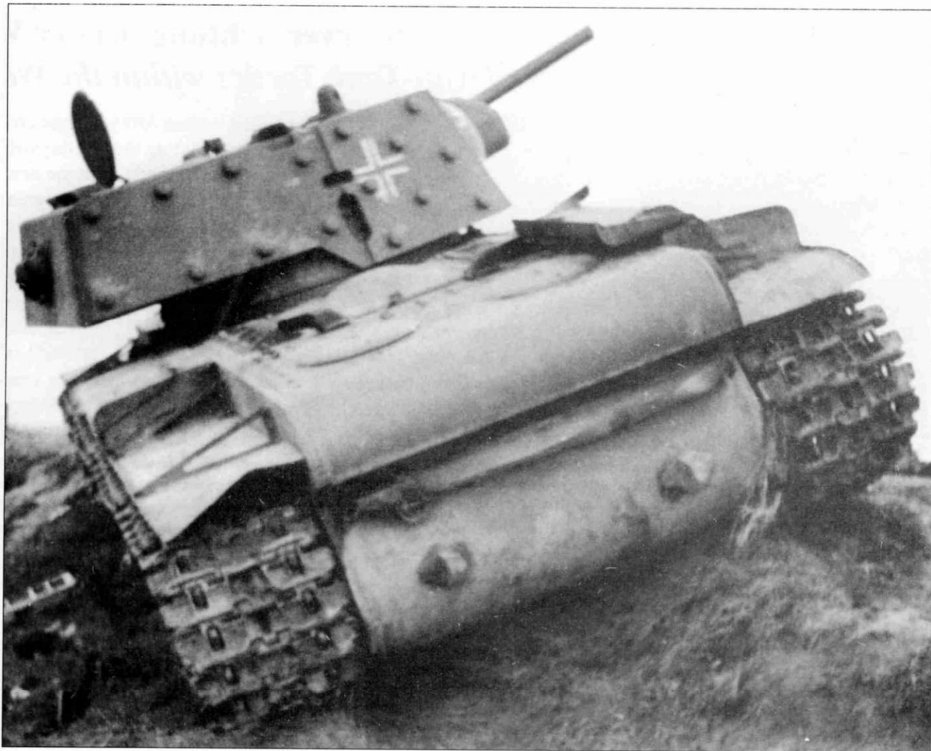
На данной, хотя немного и не резкой фотографии, виден Panzerkampfwagen KV-IB 755 (r) неизвестного немецкого подразделения (вид с кормы). Это советский танк KB-1 с экранами на базе танка проекта 1940 г. Дополнительные экраны установлены как на башне, так и на корпусе машины. Обратите внимание, что эта машина не имеет опознавательных знаков сзади!
