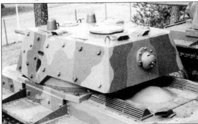
Левая сторона корпуса с деталями броневых «воротника» вокруг погона башни и дополнительная броня в верхней части корпуса. Обратите внимание на новое ограждение установленное финнами над воздухозаборниками.
