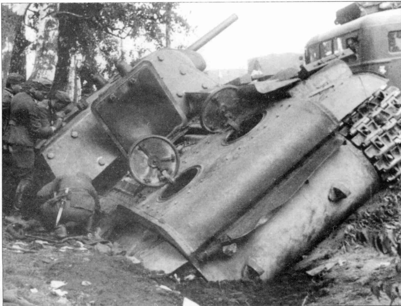
На этой фотографии KV-1 с экранами хорошо видны внутренние детали двух открытых круглых люков для обслуживания и прямоугольного люка над двигателем.
