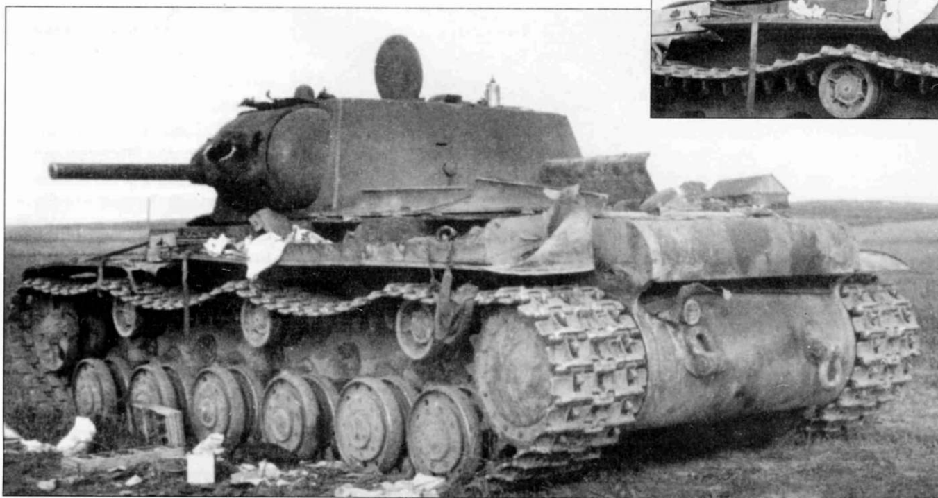
Подбитый KB-1 проекта 1939 г. ЛКЗ. Обратите внимание на пробитую маску орудия. Пробитины такого типа в 1941 году могли нанести только зенитные орудия Flak 36 калибра 88 мм.
