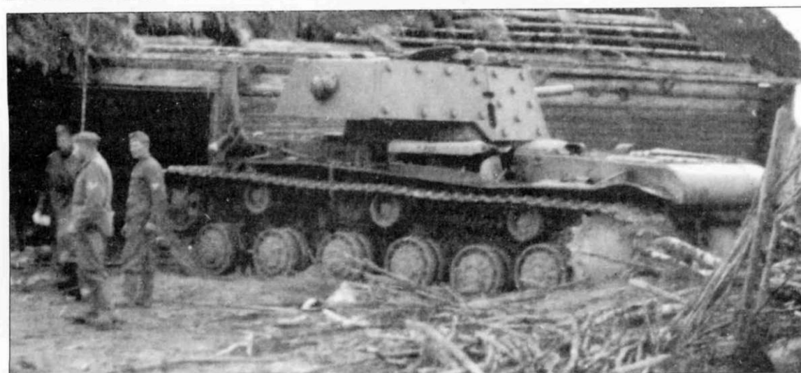
Три снимка танка KV-1 проекта 1940 г., ранних производственных серий с экранами (дополнительно бронирована только башня). Машина была подбита и остановилась около сарая. Согласно доступным фотодокументам, экранировались только KV-1 проекта 1940 г., вооруженные пушкой Ф-32.
