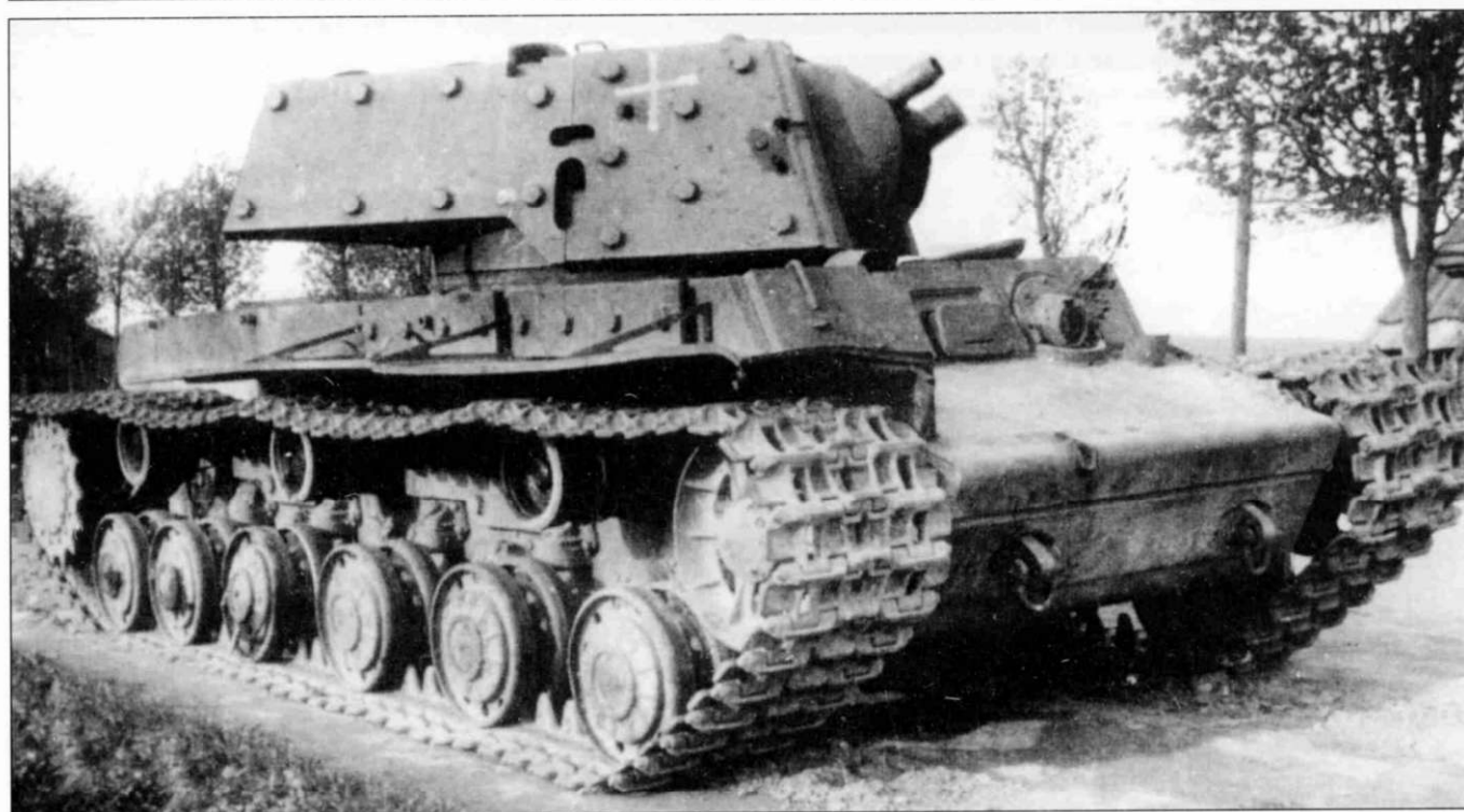
Три фотографии танков KV-1 проекта 1940 г. поздних производственных серий (дополнительная наварная броня) с экранами (на корпусе и башне). Здесь хорошо видны экраны, установленные в нижней части бортов корпуса. Форма экранов часто варьировалась из-за возникавших проблем с материальным снабжением в процессе их производства.
