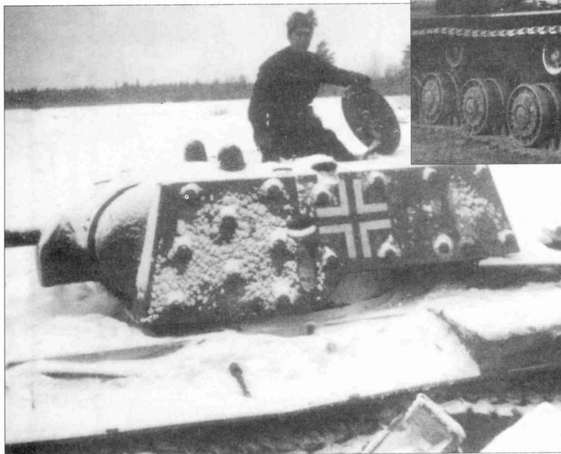
Panzerkampfwagen KV-IB 755 (r) - танк КВ-1 с экранами на базе танка проекта 1940 г. Дополнительные экраны установлены как на башне, так и на корпусе машины. Нанесение изображения Valkenkreuz на наклонных лобовых листах корпуса довольно необычно для захваченных немцами КВ.
