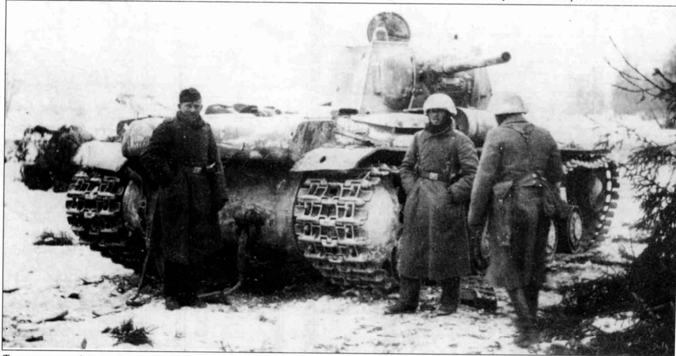
Только на самой ранней стадии производства Челябинский завод строил КВ-1 проекта 1940 г. ЛКЗ/ЧТЗ с пушкой Ф-32. Вскоре она была заменена пушкой ЗиС-5. КВ-1 вооруженные пушкой ЗиС-5 можно идентифицировать только по небольшому лючку для обслуживания орудия в маске пушки, а также по более длинному стволу. Остальные узлы корпуса и башни были идентичны другим КВ производства ЧТЗ.
