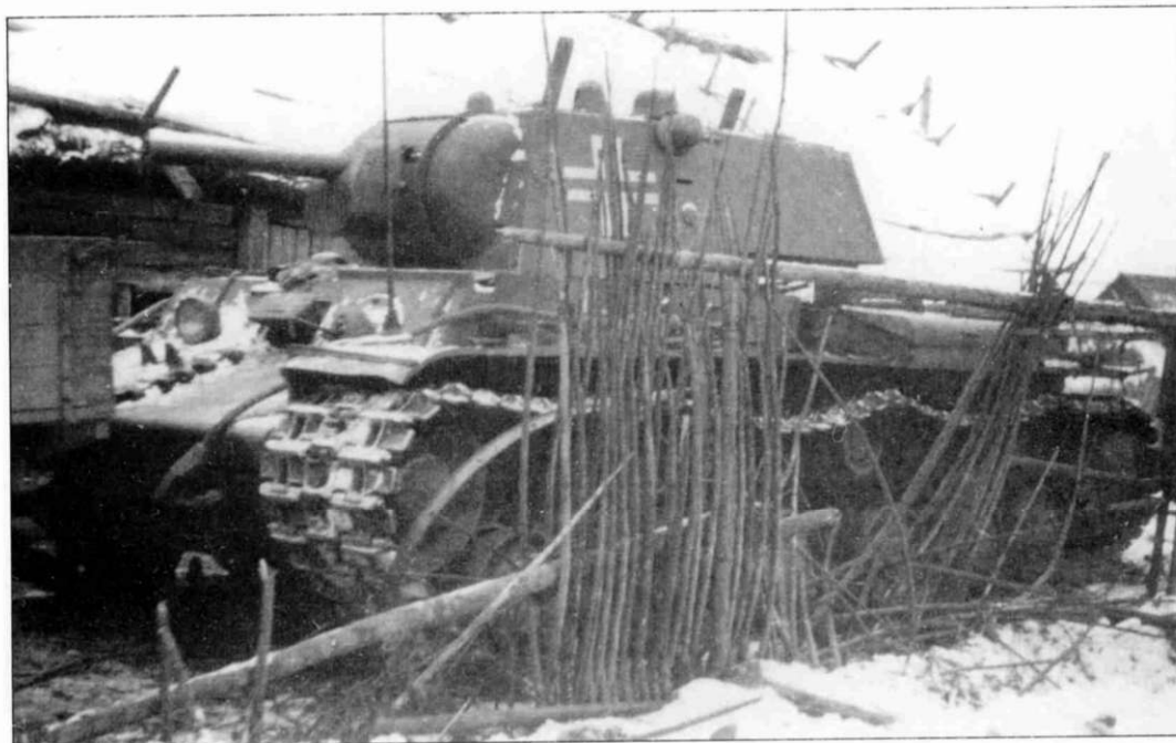
Panzerkampfwagen KV-1A 753 (r) - KB-1 проекта 1940 г., поздних производственных серий. На нем видны остатки зимнего камуфляжа, нанесенного легко смываемой белой краской (при помощи кисти). Обратите внимание на Balkenkreuz увеличенного размера, гусеничные траки закрепленные на лобовом листе корпуса и немецкие стальные каски, висящие на башне.
