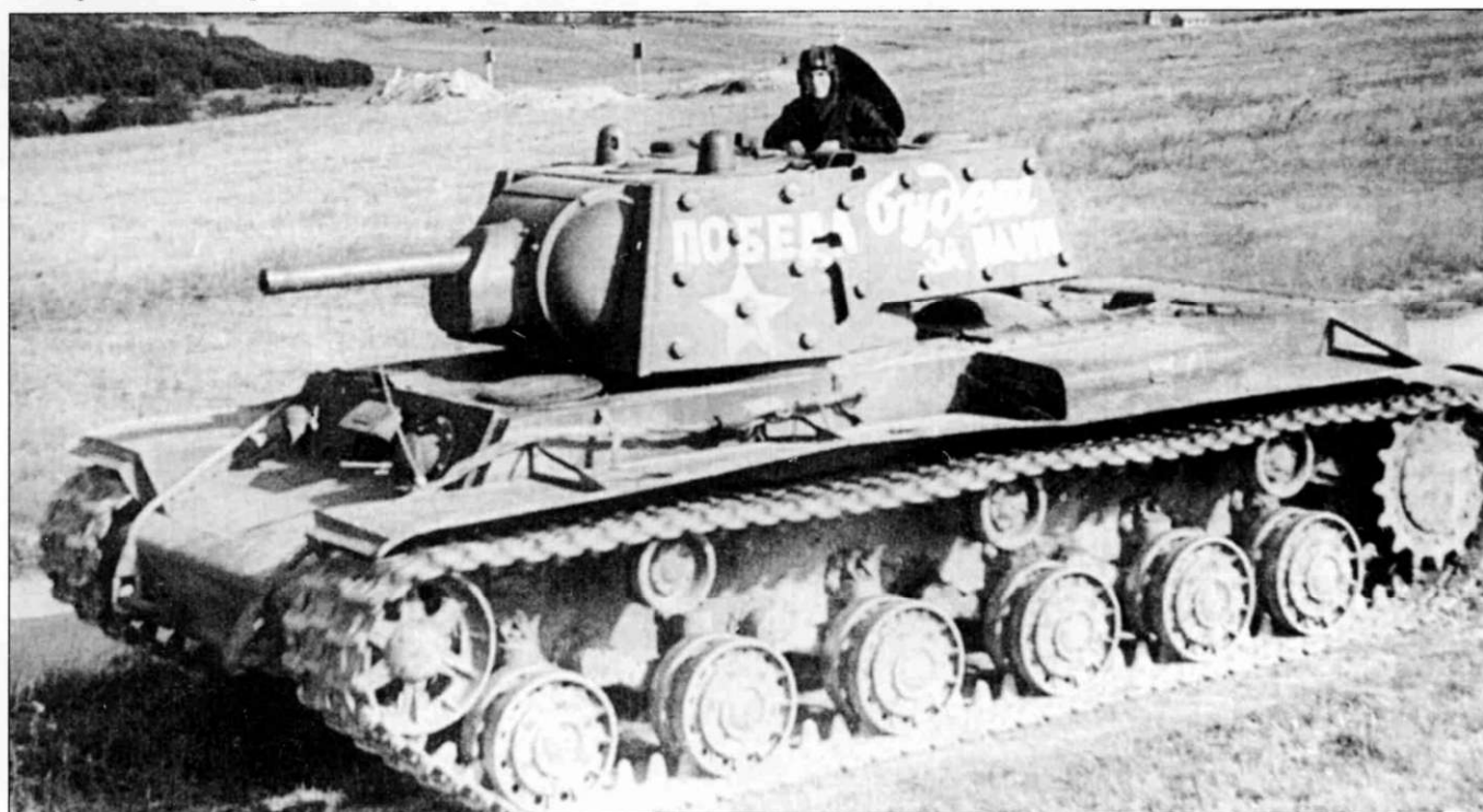
КВ-1 проекта 1940 г. производства ЧТЗ с двигателем М-17.
