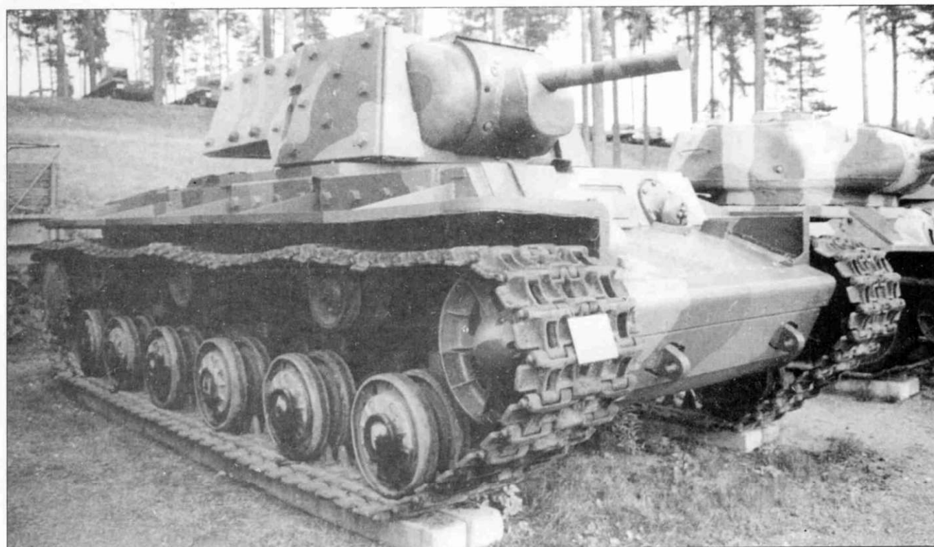
Единственный сохранившийся до настоящего времени KV-1 с экранами можно найти в танковом музее Parola, Финляндия. Машина на базе танка проекта 1940 г. с экранами на башне и корпусе был захвачен на Финском фронте и позже активно использовался Финской армией. В этот период на танке было сделано несколько местных модификаций.
