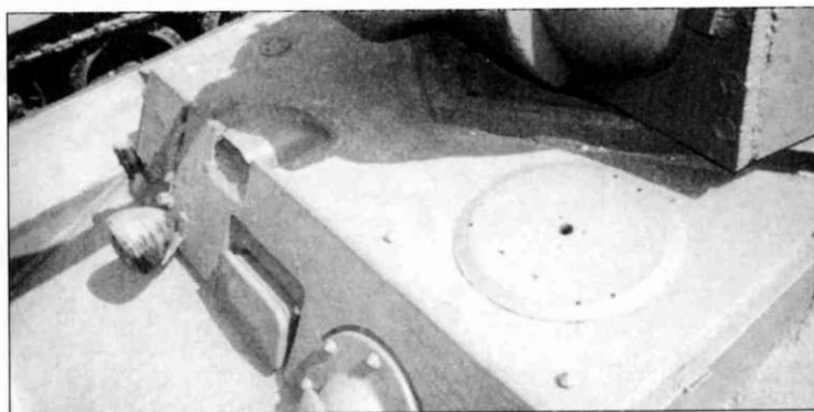
Передняя часть корпуса танка, здесь размещались механик-водитель (с правой стороны) и стрелок-радист (слева, под посадочным люком). Механик-водитель наблюдал за местностью через смотровую щель со стеклоблоком «триплекс» в люке-пробке, а также при помощи подвижного перископа на крыше корпуса.
