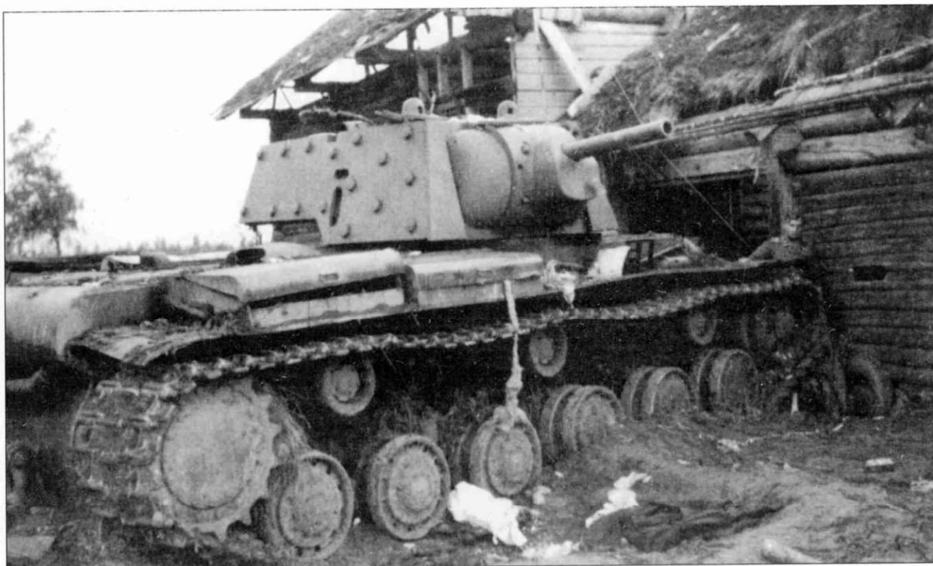
Три снимка танка KV-1 проекта 1940 г., ранних производственных серий с экранами (дополнительно бронирована только башня). Машина была подбита и остановилась около сарая. Согласно доступным фотодокументам, экранировались только KV-1 проекта 1940 г., вооруженные пушкой Ф-32.
