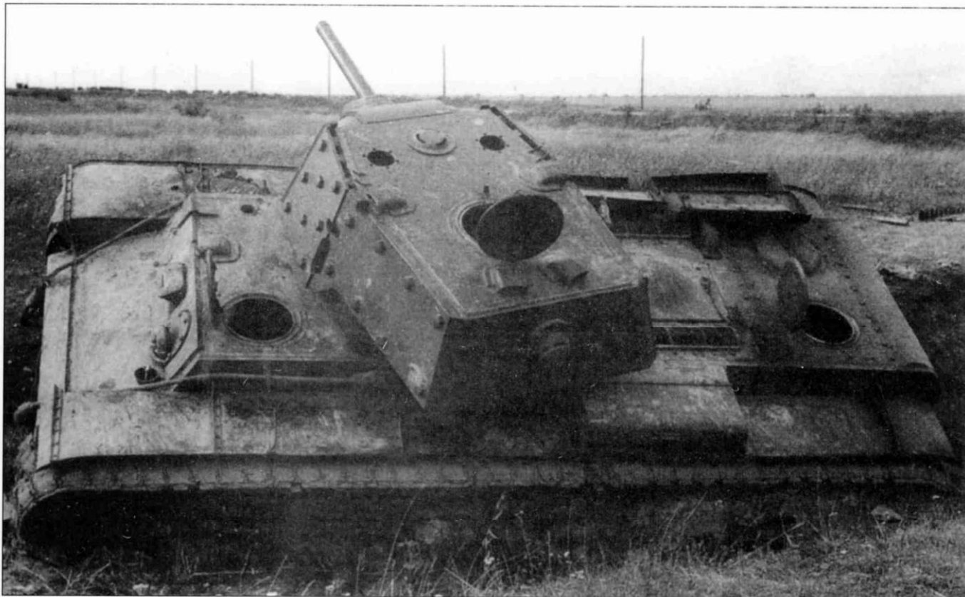
Вид сверху на KV-1 проекта 1940 г. поздних производственных серий (дополнительная наварная броня) с экранами (на корпусе и башне) позволяет хорошо рассмотреть толщину брони экранов башни, а также размер промежутка, на который отстояли экраны от поверхности основной танковой брони.
