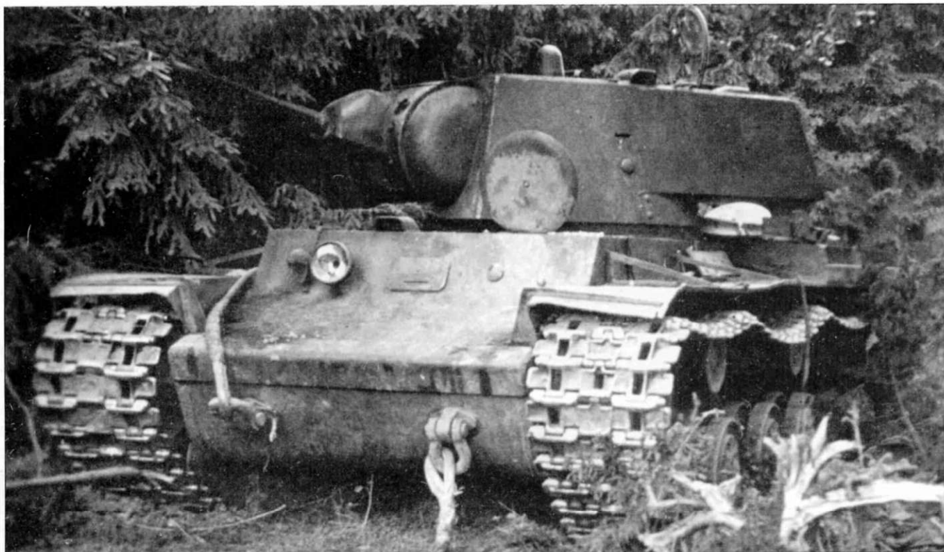
КВ-1 проекта 1939 г. ЛКЗ; обследуется солда- тами германской армии. Обратите внимание на амбразуру для стрельбы из личного оружия.
