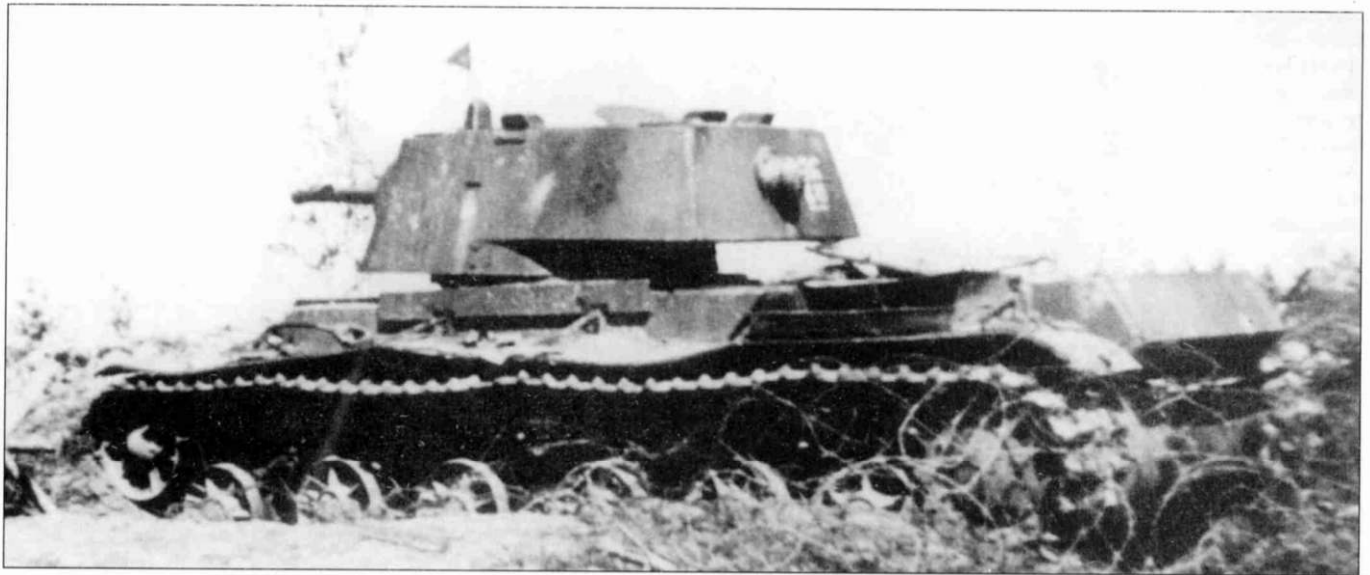
КВ, на которых устанавливались узлы от машин различных производственных серий не были редкостью. Тем не менее, то, что у этого КВ-1 башня проекта 1940 г. установлена на корпус проекта 1942 г. с угловатой кормовой частью довольно необычно.
