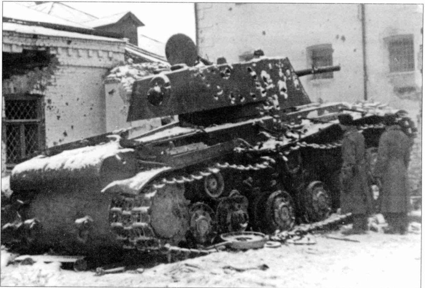
Данный танк также весьма необычен. На первый взгляд он напоминает обычный КВ-1 проекта 1940 г. производства ЛКЗ с округлой кормой корпуса раннего типа, сварной башней с длинной кормовой нишей и опорными катками раннего типа. Однако при ближайшем рассмотрении становится очевидно, что вокруг шарового крепления кормовой пулеметной установки на броневом листе башни имеется броневое кольцо. Использование конструкции такого типа до настоящего времени относилось только к поздним экранированным башням танков КВ-1 проекта 1942 г. производства ЧКЗ!
