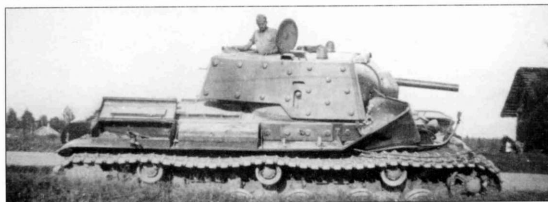
Три фотографии танков KV-1 проекта 1940 г. поздних производственных серий (дополнительная наварная броня) с экранами (на корпусе и башне). Здесь хорошо видны экраны, установленные в нижней части бортов корпуса. Форма экранов часто варьировалась из-за возникавших проблем с материальным снабжением в процессе их производства.
