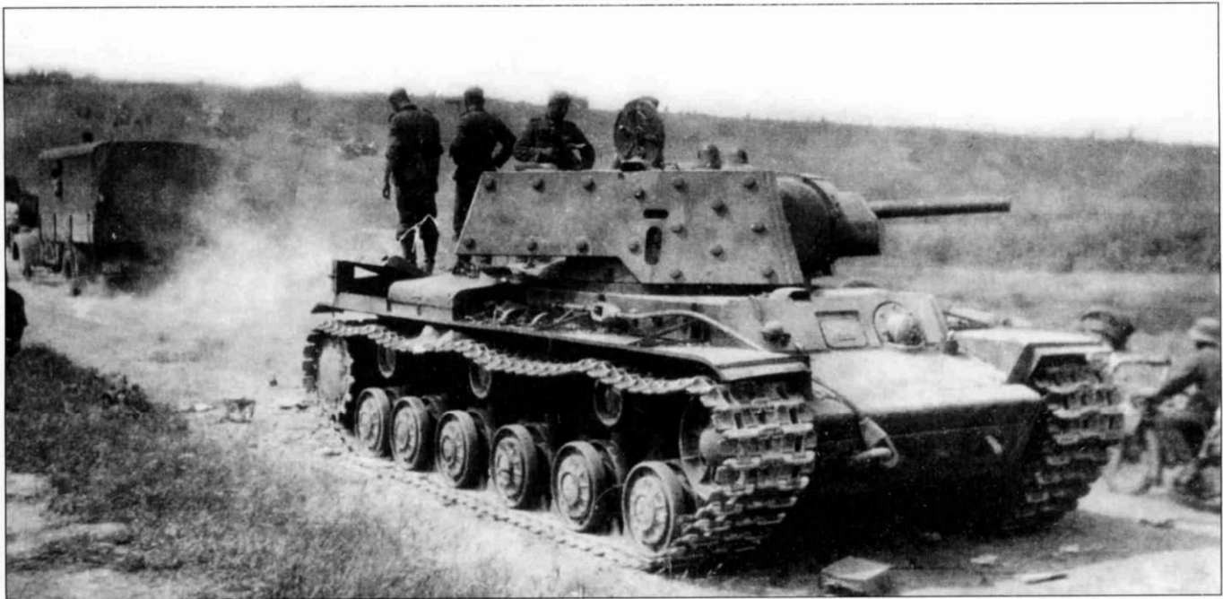
Немецкие солдаты осматривают подбитый КВ-1 проекта 1940 г. поздних производственных серий (дополнительная наварная броня) с экранами (на корпусе и башне), стоящий прямо на проселочной дороге. Дополнительные броневые экраны еще больше затруднили немцам борьбу с этими танками.
