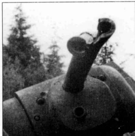
Несколько танков KV-1 проекта 1940 г., с непонятным отверстием в маске пушки (ниже основания ствола). Возможно это отверстие для доступа при установке другого орудия (не Ф-32). Нужно заметить, что монтаж в этом месте пулемета практически невозможен.
