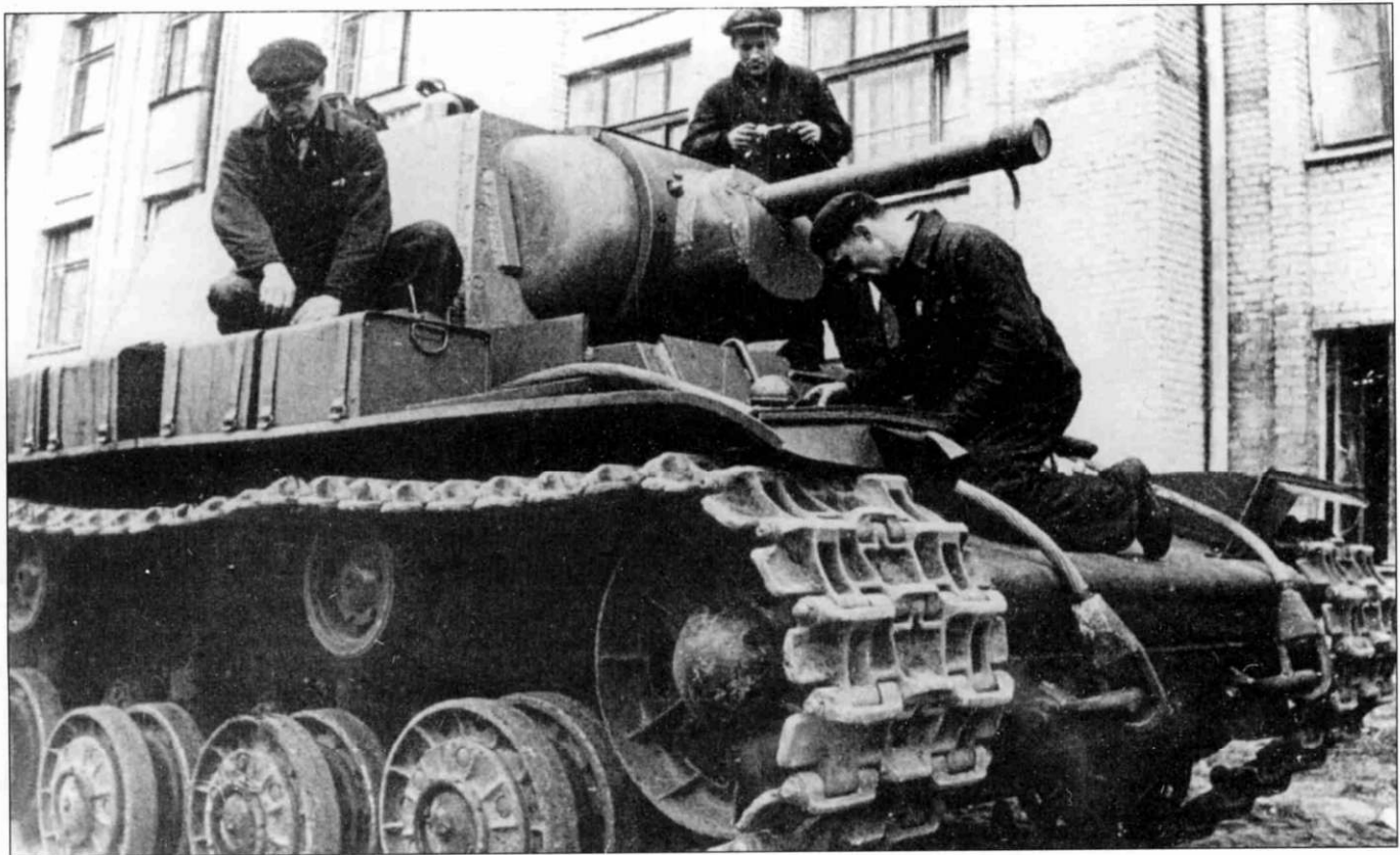
На надгусеничных полках танков KV-1 проекта 1940 и 1941 гг. устанавливались дополнительные бачки (канистры) коробчатой формы. На этой фотографии видно, как их монтируют на заводе.
