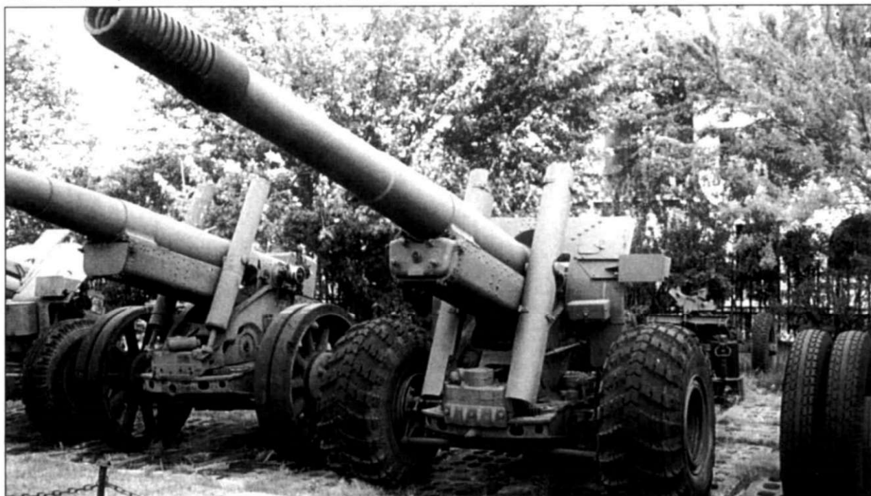
На снимке 152-мм гаубица с тремя разными типами колес: слева - литые грузозвонки, применявшиеся до 1941 г., справа видны двойные автомобильные колеса, ставившиеся после 1943 г., гаубица в центре - на арочных колесах послевоенного периода.
