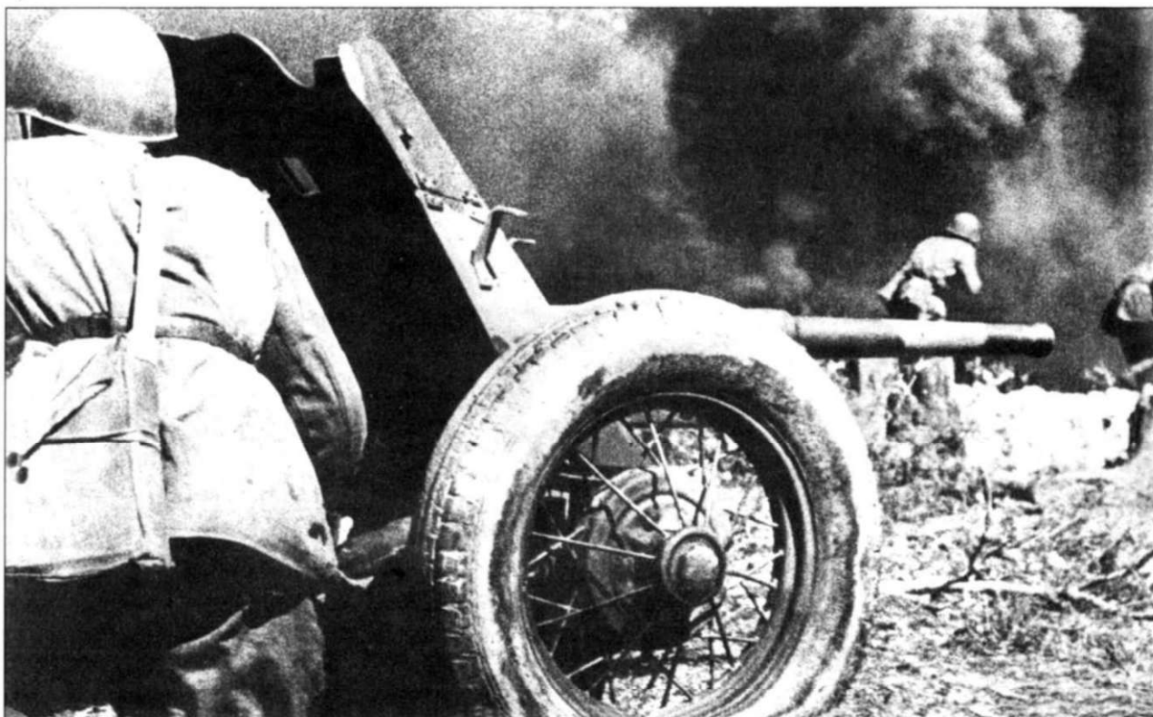
1941 г. 45-мм противотанковая пушка 53-К поддерживает контратаку. Хорошо видно тангентное колесо от ГАЗ-А. Интересны различные камуфляжные пятна на щите и стволе.
